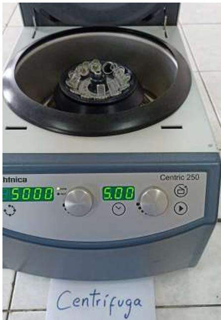
Fig. 10: Inicio de la centrifugación
