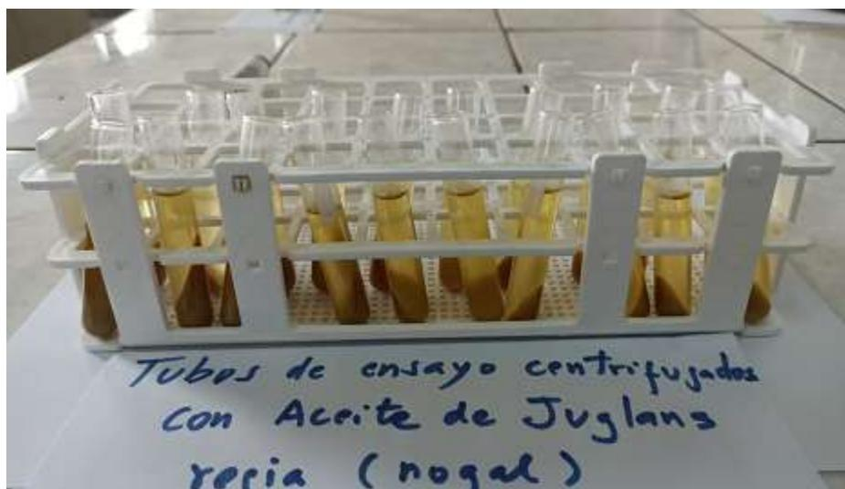
Fig. 11: Aceite después de la centrifugación
