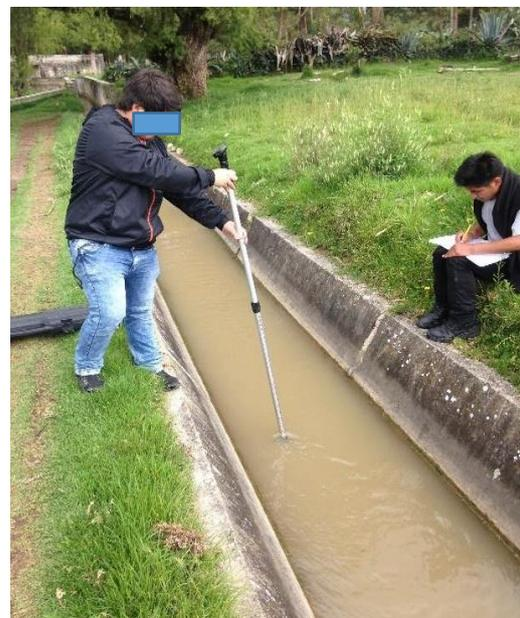
**Figura 6.** Aforo con Correntómetro, en canales
