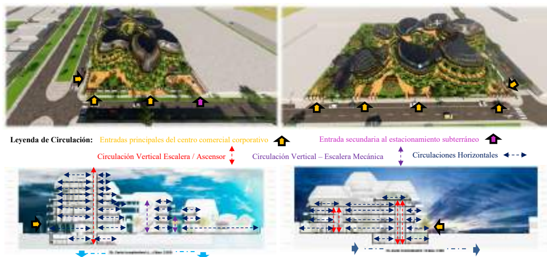
Figura 60. Planos de cortes y renders de circulaciones funcionales del centro comercial corporativo.
