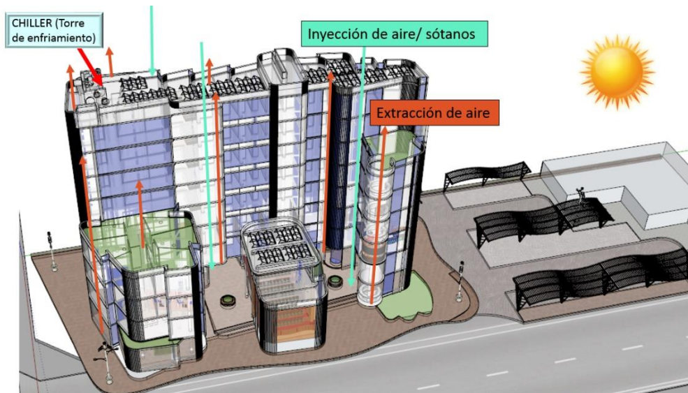
Figura N° 40 Ventilación mecánica con sistema de HVAC
