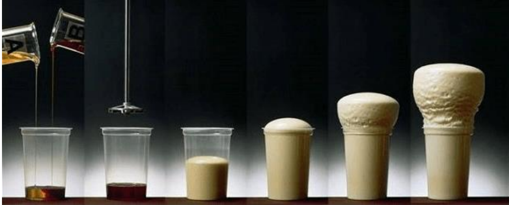
Figura N° 31 Proceso de espumación del poliuretano proyectado
