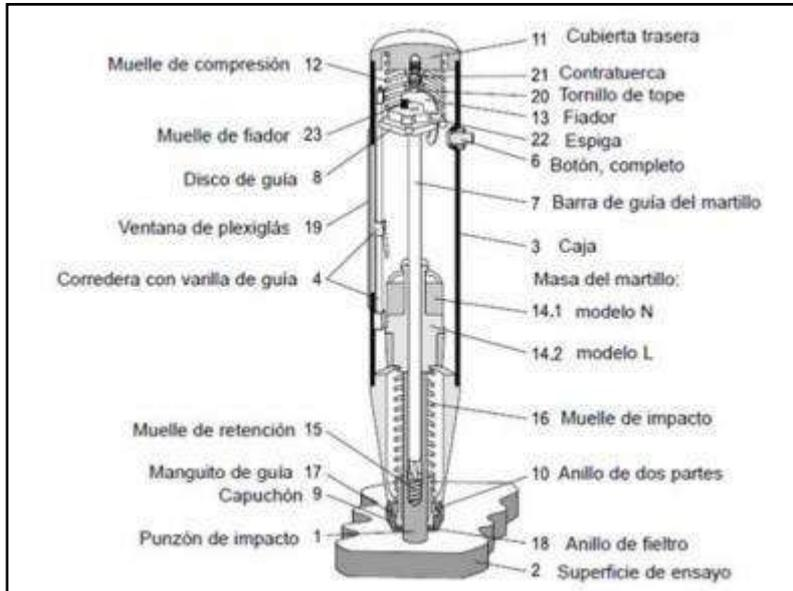
Fig.4: Componentes del esclerómetro
