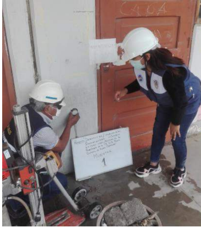
Figura 81: Extracción del corazón diamantino M-1
