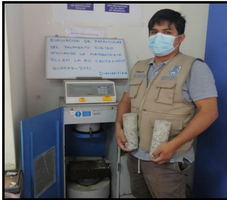
**Figura 41.** Las diamantinas listas para ser ensayados en la máquina de compresión simple.
