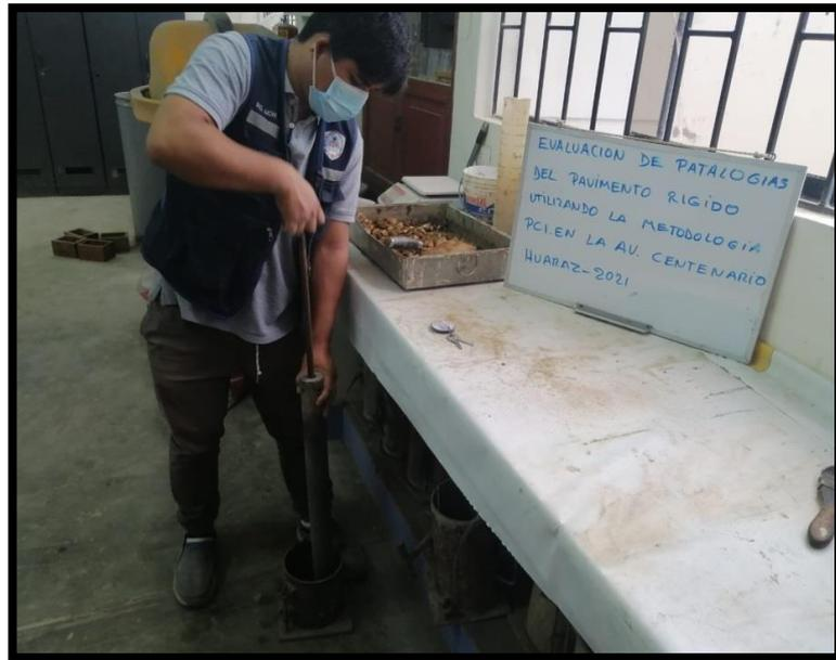
**Figura 47.** Realizando el ensayo de proctor modificado de la base granular y terreno natural.
