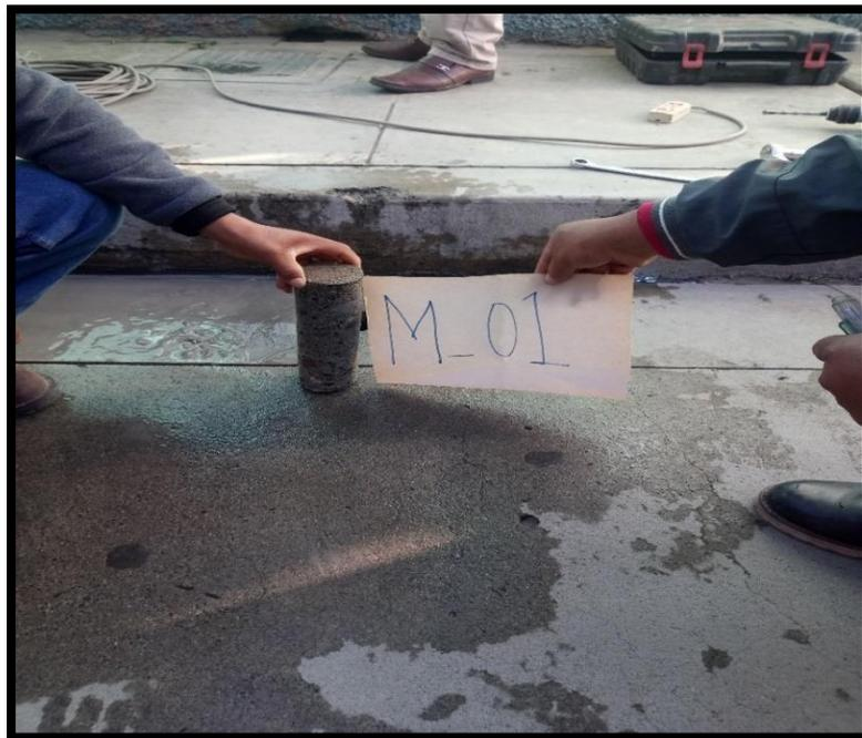
**Figura 36.** *Observación del primer testigo de concreto.*
