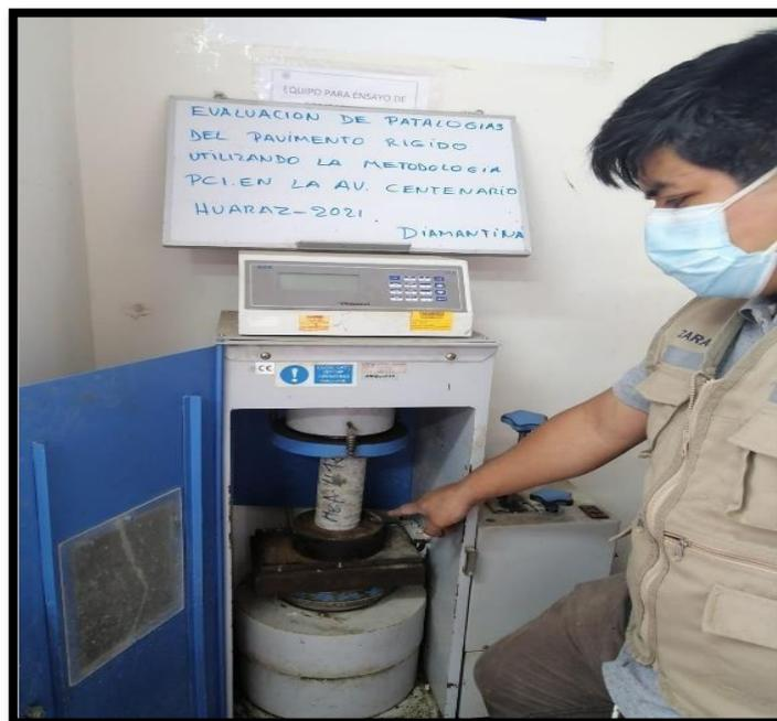
**Figura 42.** Realizando el ensayo de resistencia a la compresión simple.
