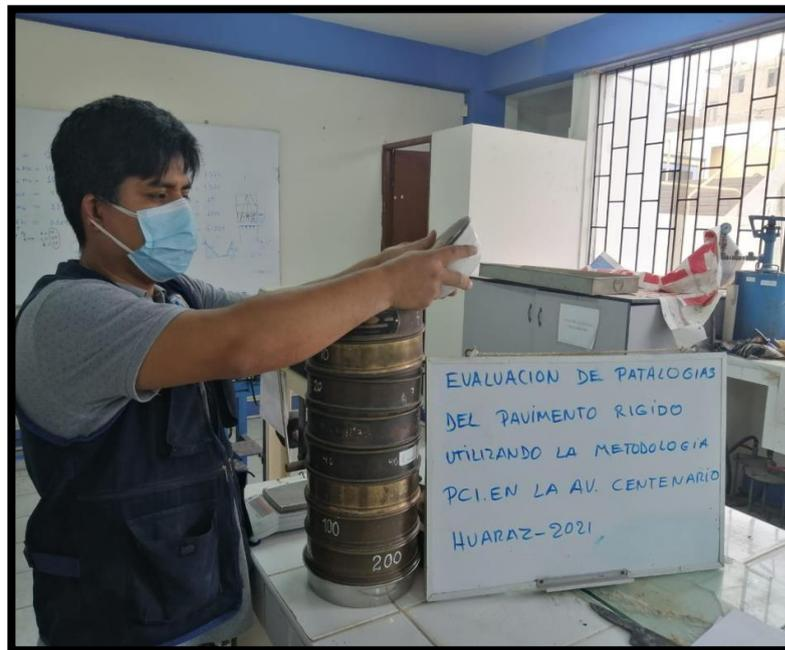
**Figura 44.** Realizando el ensayo de análisis granulométrico de la base granular y terreno natural.
