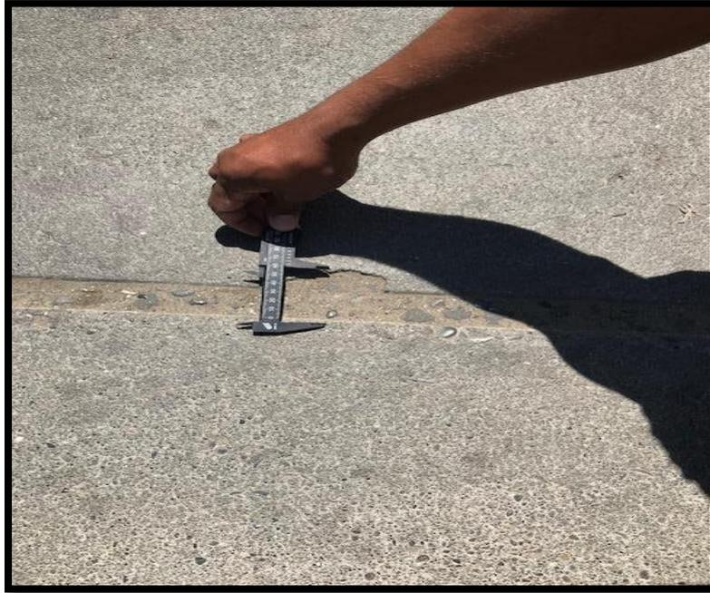
**Figura 29.** *Midiendo la junta de dilatación con vernier.*
