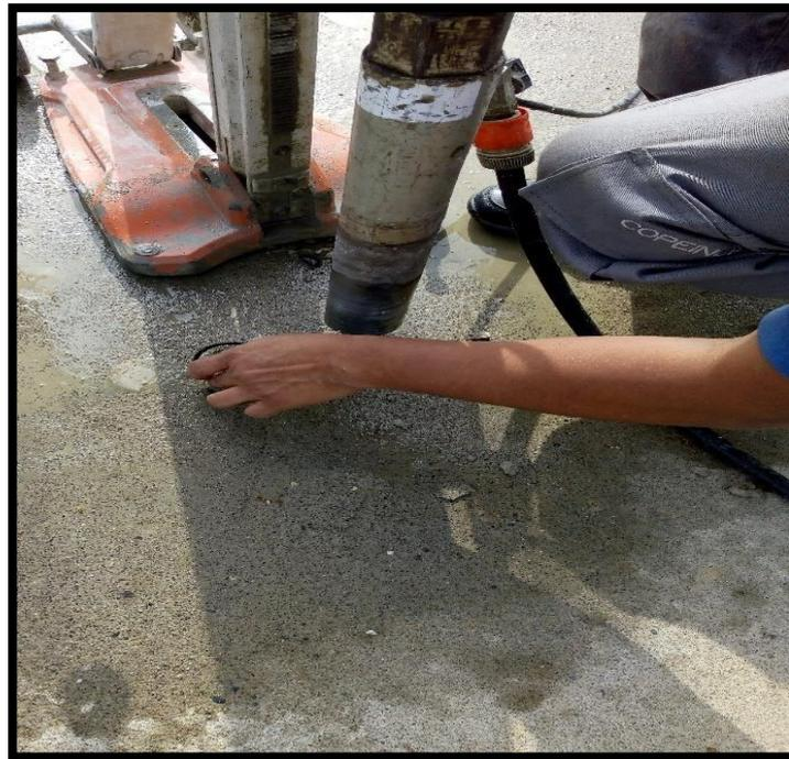
**Figura 39.** Retirando la segunda muestra.
