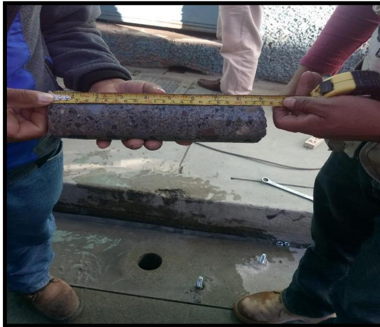
**Figura 37.** *Tomando medidas al testigo de concreto.*
