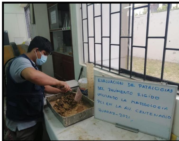
**Figura 46.** Mezclando el afirmado homogéneamente para realizar el ensayo de proctor de la base granular.
