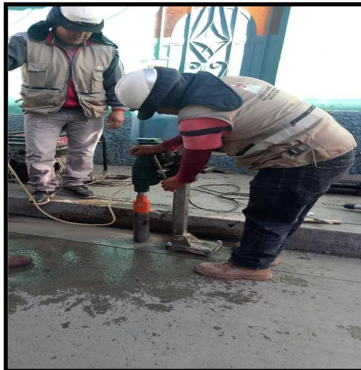
**Figura 38.** *Realizando la extracción de la segunda muestra.*
