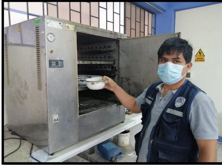
**Figura 43.** Realizando el ensayo de contenido de humedad de la base granular y terreno natural.
