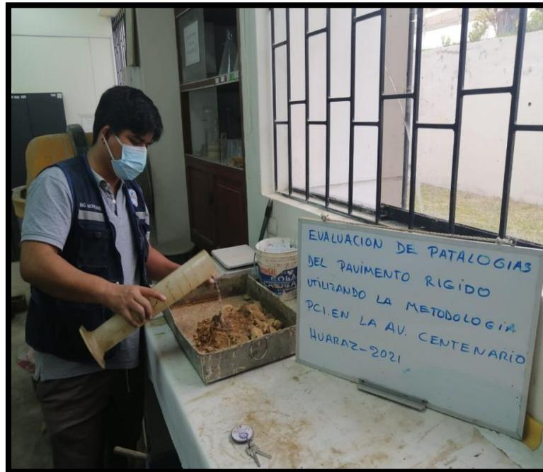
**Figura 45.** Realizando el ensayo de proctor de la base granular.
