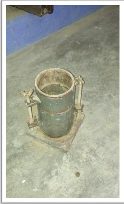
Foto N°45. Molde utilizado para el ensayo de CBR
