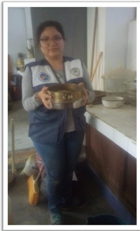
Foto N°11. Tamizando el material para realizar los ensayo de LL-LP.
