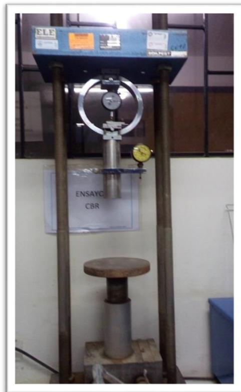
Foto N° 50. Prensa mecánica para ensayo a compresión tipo CBR
