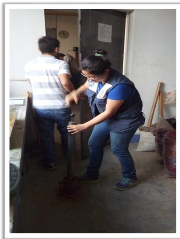
Foto N°48. Compactación del material.
