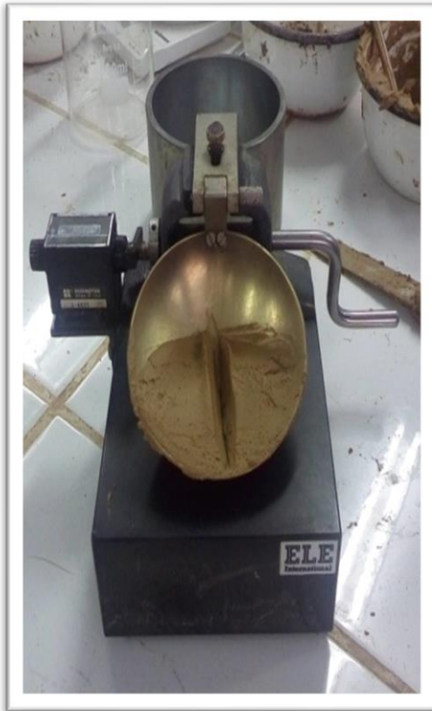
Foto N°14. Muestra ranurada para los respectivos golpes.
