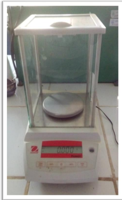
Foto. N°8. Balanza utilizada para realizar los ensayos de Límite Líquido y Limite Plástico.
