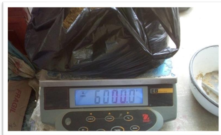
Foto N°36. Muestra de 6kg para ensayo de CBR.
