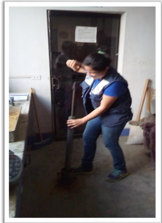
Foto N°39. Realizando los golpes con el pisón.
