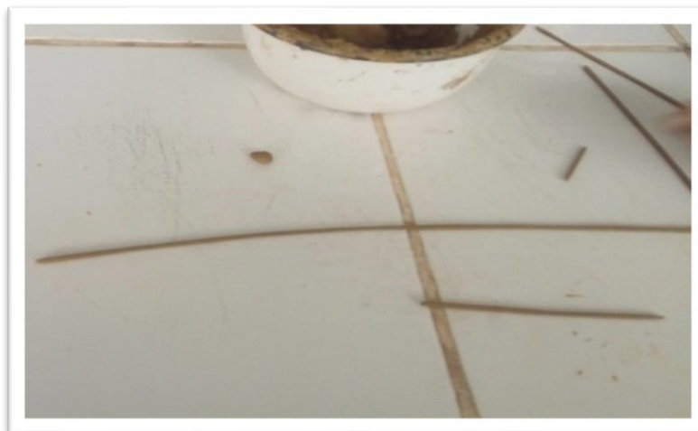
Foto N°20. Muestra enrollada del suelo en estudio.
