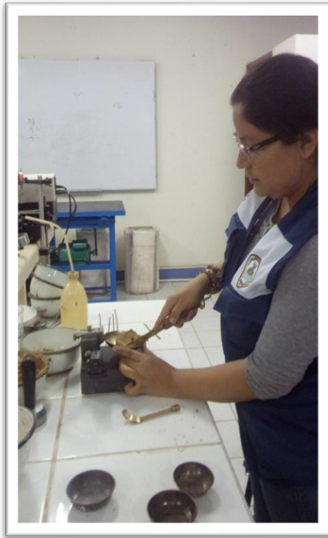
Foto N°12. Echamos la mezcla de agua con material tamizado en la copa de Casagrande.
