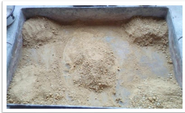
Foto N°47. Material Suelo más adicción de Concha de abanico.
