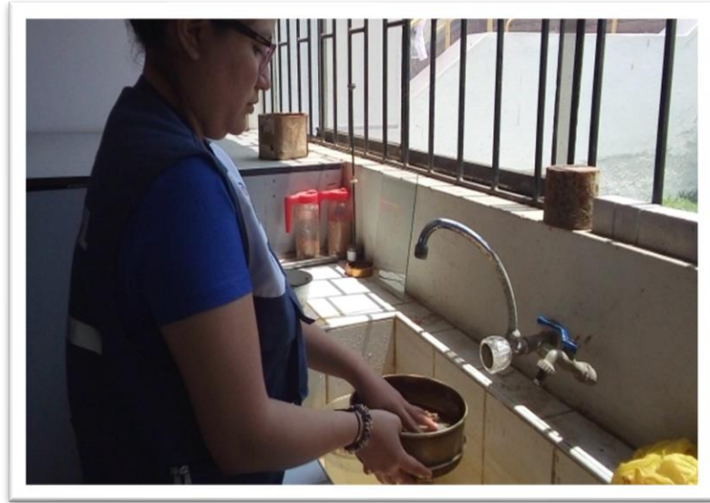
Foto N°25. Preparando el material para ensayo de Granulometría.
