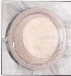
Figura 2. Fotografía de la Muestra pulverizada de concha de abanico
