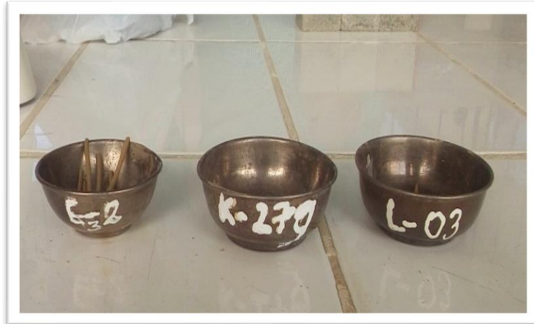
Foto N°21. Muestra del suelo enrollado.
