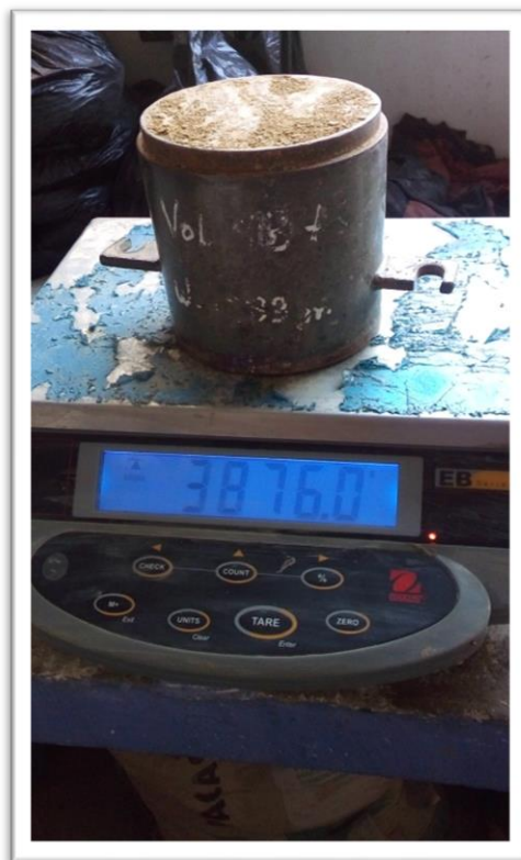
Foto N°43. Pesamos los moldes con el material para nuestro respectivo trabajo de gabinete.
