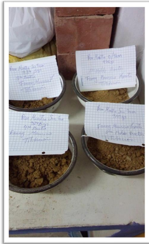
Foto N°44. Taras con el material con sus respectivos pesos listas para colocarlas dentro del horno.
