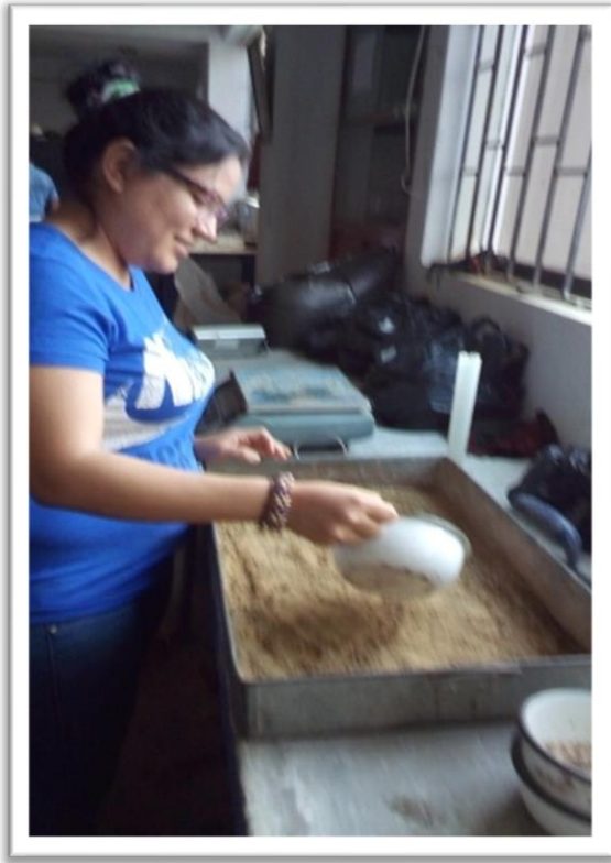
Foto N°38. Mezcla de material con agua en la proporción indicada según cálculos.
