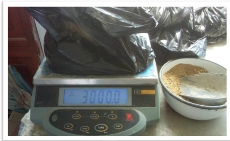
Foto N°35. Muestra de 3kg para ensayo De Proctor.
