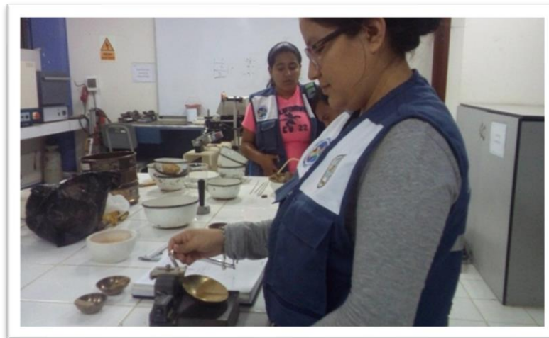
Foto N°15. Realizando los golpes para el ensayo de LL.
