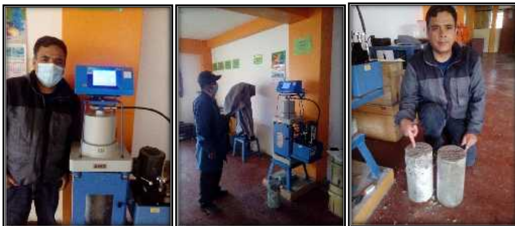
Foto 39: Proceso y rotura visible de las briquetas de la Resistencia del concreto.
