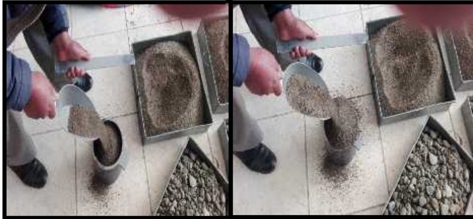
Foto 14: Soltamos el agregado grueso a la Olla hasta el límite de la Olla desde una altura de 15 cm, enrazamos con la varilla y los excedentes de los bordes los limpiamos con una brocha y pesamos la muestra y ese acto lo repetimos 3 veces.
