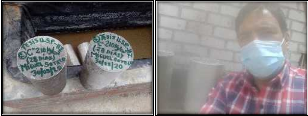
Foto 40: Sacando las probetas de concreto de la poza de curado a los 28 días.
