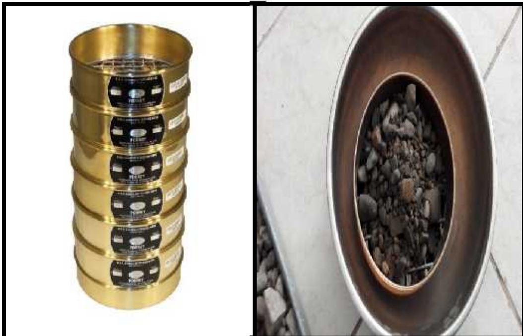
Foto 04: Se arma las mallas \frac{3}{4} , \frac{1}{2} , \frac{3}{8} , #4 en según la NTP 400.012, para luego introducir, nuestro espécimen de ensayo y se comienza a agitar los tamices para que así en estos solo quede el material que en verdad es retenido para ser pesados.
