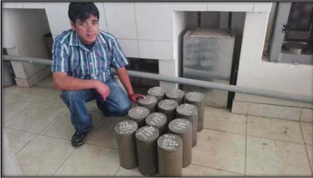
Foto 22: Preparando nuestras probetas de concreto para el respectivo curado.
