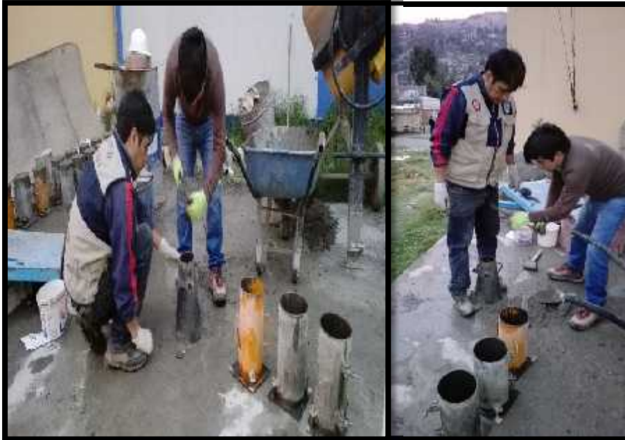
Foto 20: Se llena en Cono de Abrams en 3 capas, se chusea y se enraza, para luego levantar el molde y con la ayuda de la varilla se verifica que el asentamiento se encuentre dentro del margen.
