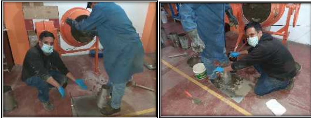
Foto 30: Preparando el Ensayo de Consistencia – SLUMP.
