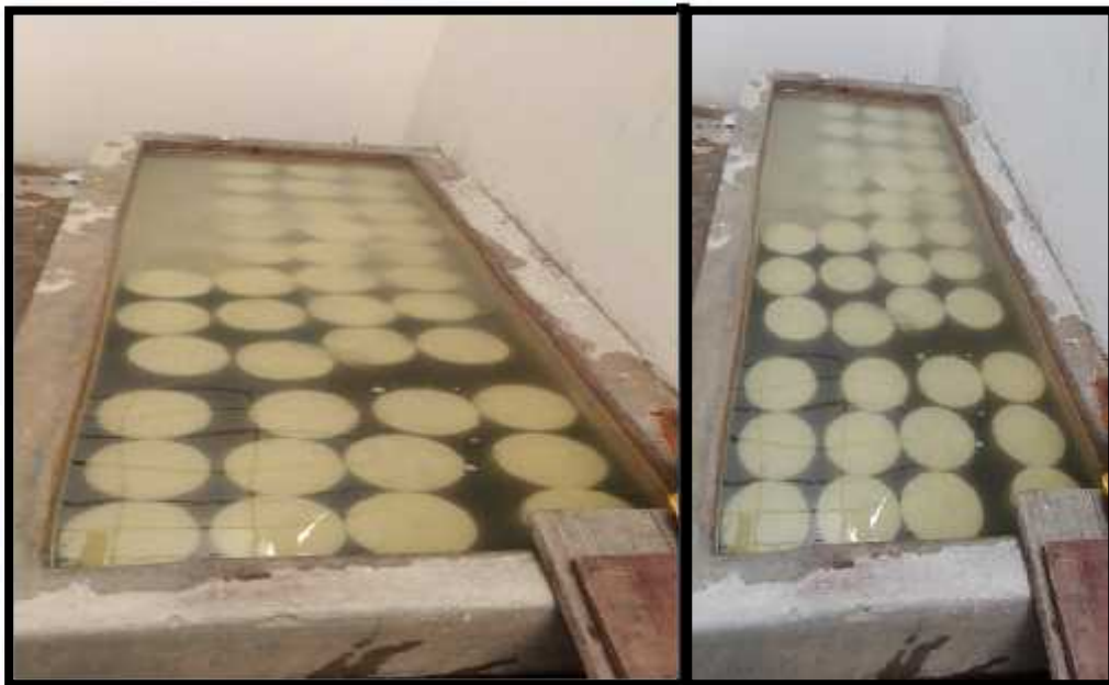
Foto 23: Curado del concreto en Laboratorio de Mecánica de Suelos y Ensayo de Materiales en la USP - Huaraz
