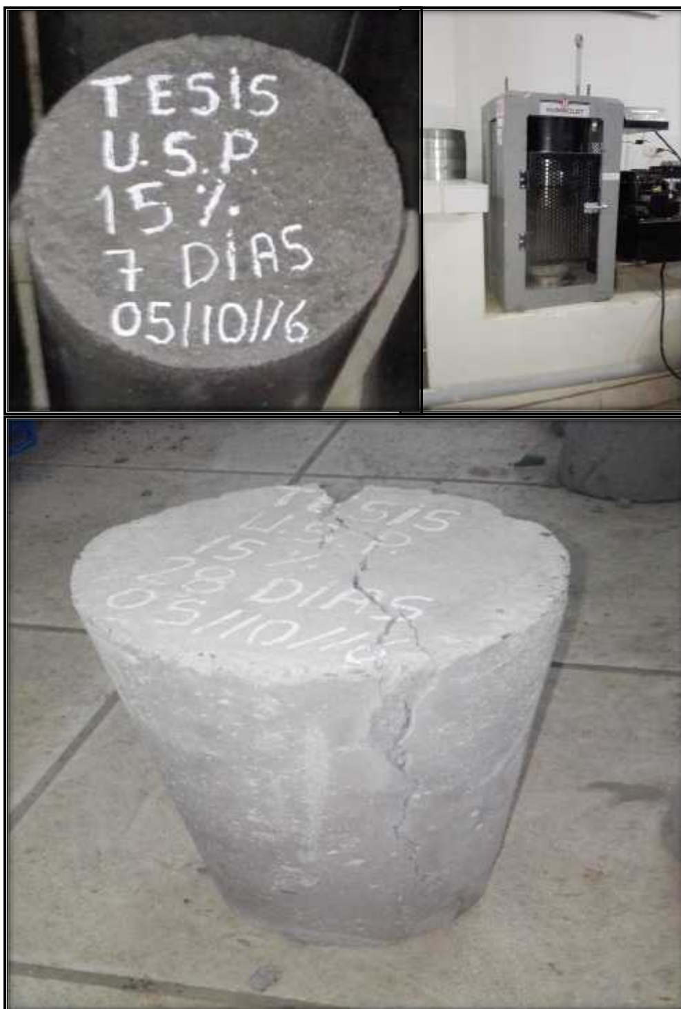
Foto 26: Rotura del Concreto con Sustitución del 15 % de Cemento por el Relave Minero “Huancapetí”, en el Laboratorio de Mecánica de Suelos y Ensayo de Materiales en la USP – Huaraz.
