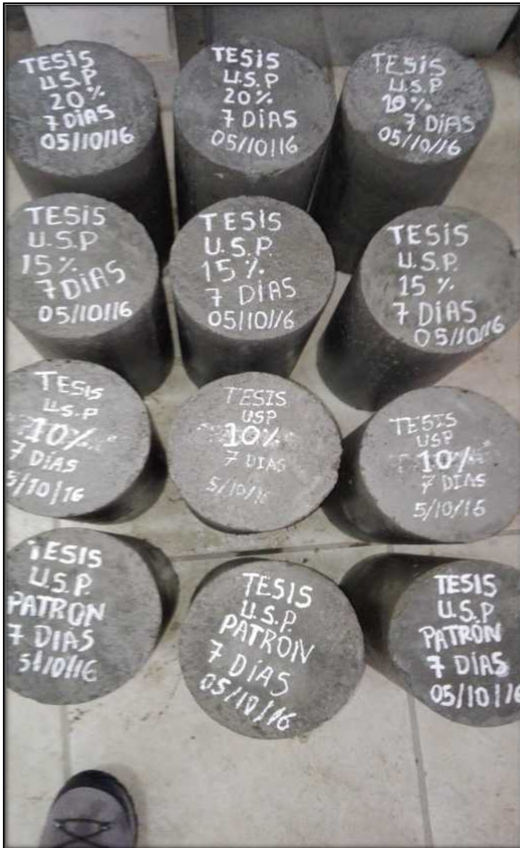
Foto 24: Concreto Patrón y Concreto con Sustitución de 10 % y 15 % del Cemento por el Relave Minero “Huancapetí” listos para la rotura en el Laboratorio de Mecánica de Suelos y Ensayo de Materiales en la USP – Huaraz.
