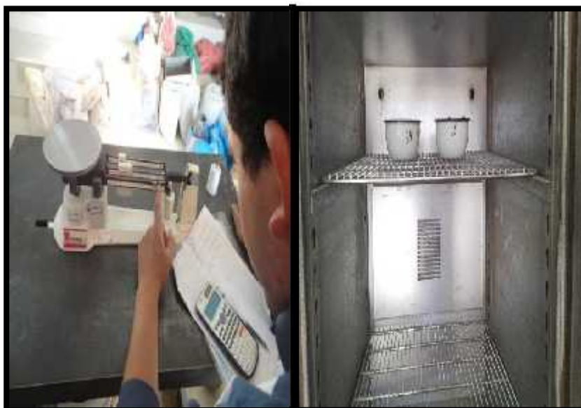
Foto 09: Hallamos el peso saturado y llevamos la muestra al horno por 24 horas, sacamos la muestra del horno y dejamos enfriar de 1 a 3 horas para hallar el peso seco final.
