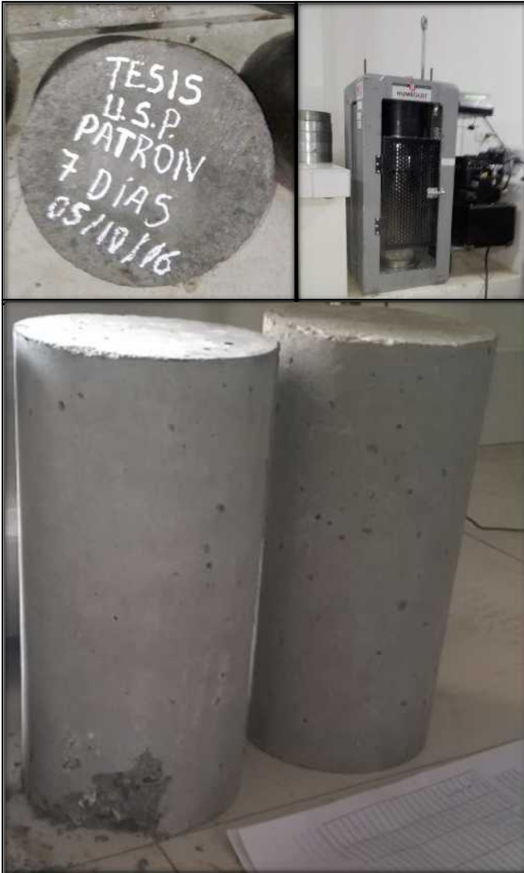
Foto 24: Rotura del Concreto Patrón en el Laboratorio de Mecánica de Suelos y Ensayo de Materiales en la USP – Huaraz.
