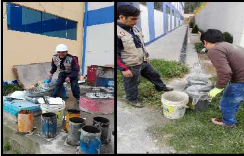
Foto 16: Se pesan los elementos según indique el diseño de mezcla.
