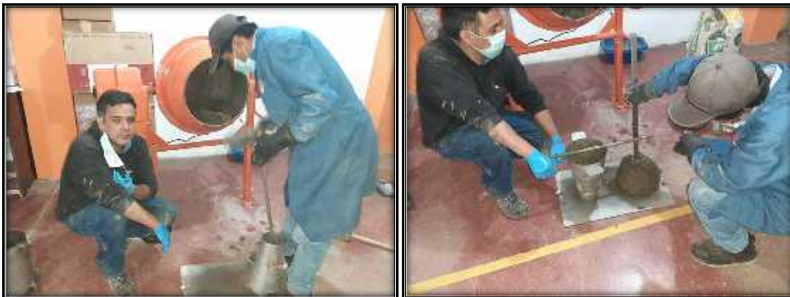
Foto 31: Chuzado y medición del Ensayo de Consistencia – SLUMP.
