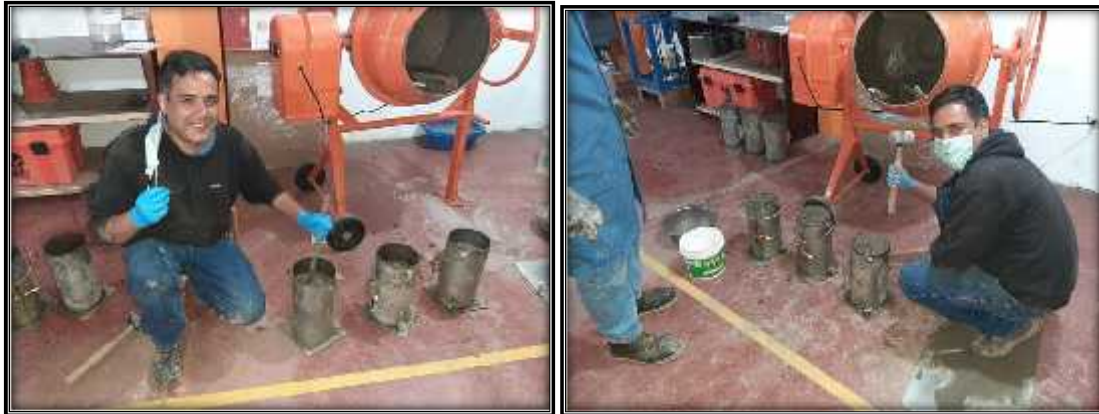
Foto 30: Chuzando las probetas cilíndricas del concreto.
