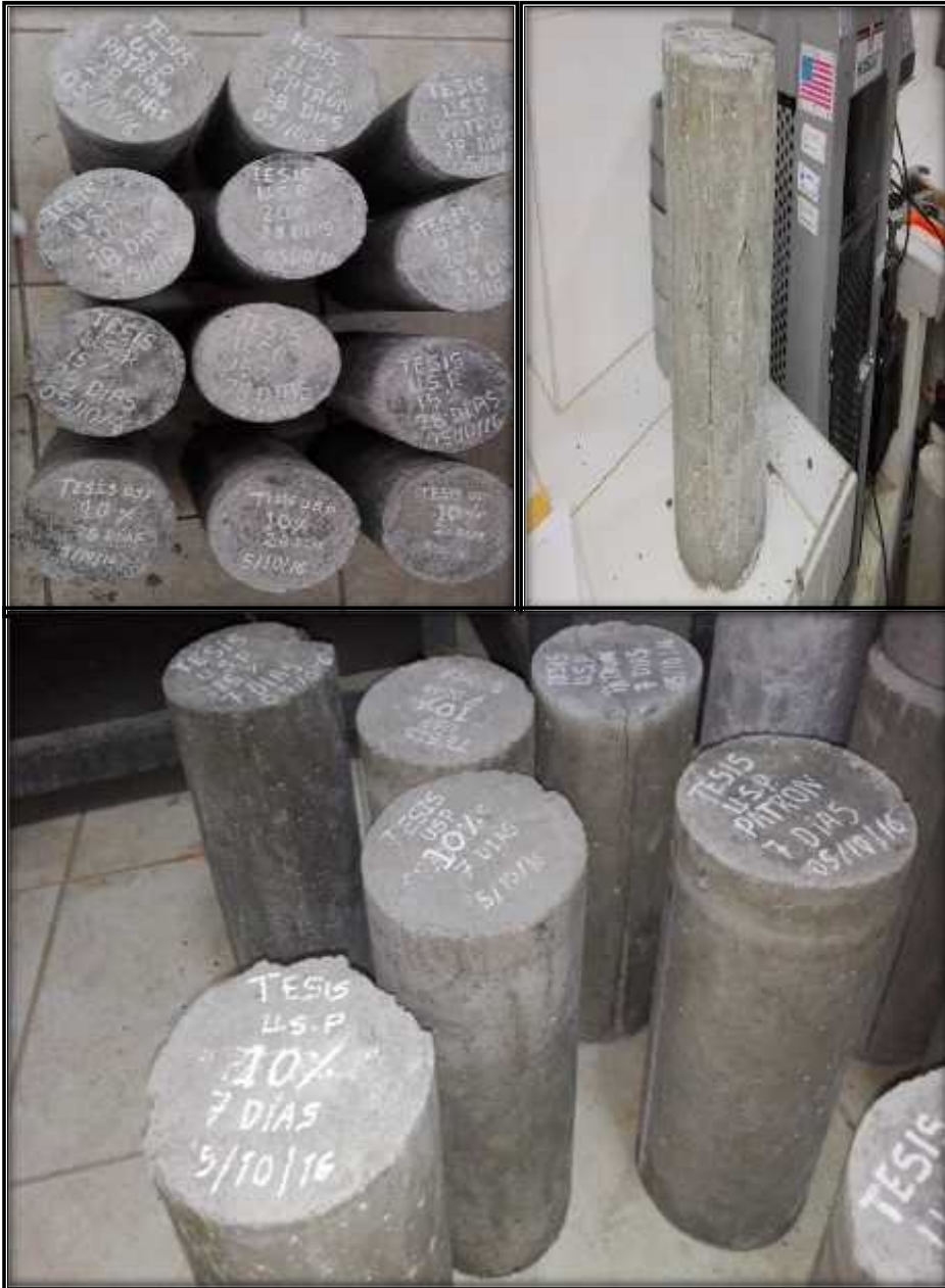
Foto 25: Rotura del Concreto con Sustitución del 10 % de Cemento por el Relave Minero “Huancapeti”, en el Laboratorio de Mecánica de Suelos y Ensayo de Materiales en la USP – Huaraz.
