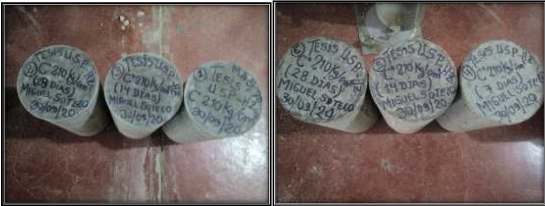
Foto 32: Las seis briquetas de concreto utilizados para el ensayo de compresión.
