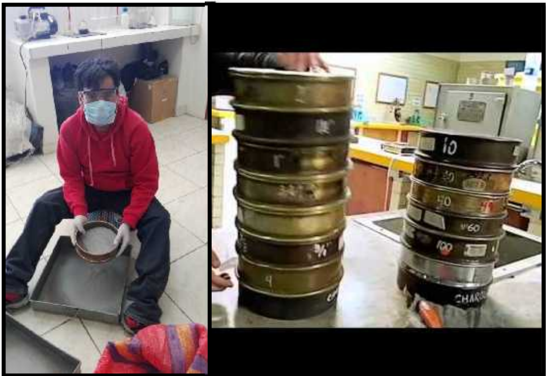
Foto 06: Se tamiza el agregado y se arma las mallas en según la NTP 400.012, para luego introducir, nuestro espécimen de ensayo y se comienza a agitar los tamices, para que así en estos solo quede el material que en verdad es retenido.
