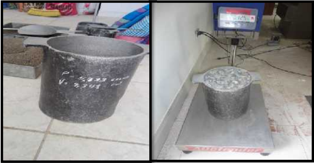
Foto 12: Soltamos el agregado grueso a la Olla hasta el límite de la Olla desde una altura de 15 cm, enrazamos con la varilla y los excedentes de los bordes los limpiamos con una brocha y pesamos la muestra y ese acto lo repetimos 3 veces.
