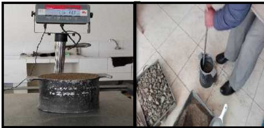
Foto 15: Echamos el agregado grueso a 1/3 de la altura total de la Olla a una altura 15 cm formando 3 capas y en cada capa se va compactar con 25 golpes con la varilla, enrazamos y los excedentes de los bordes los limpiamos con una brocha y pesamos la muestra y ese acto lo repetimos 3 veces.
