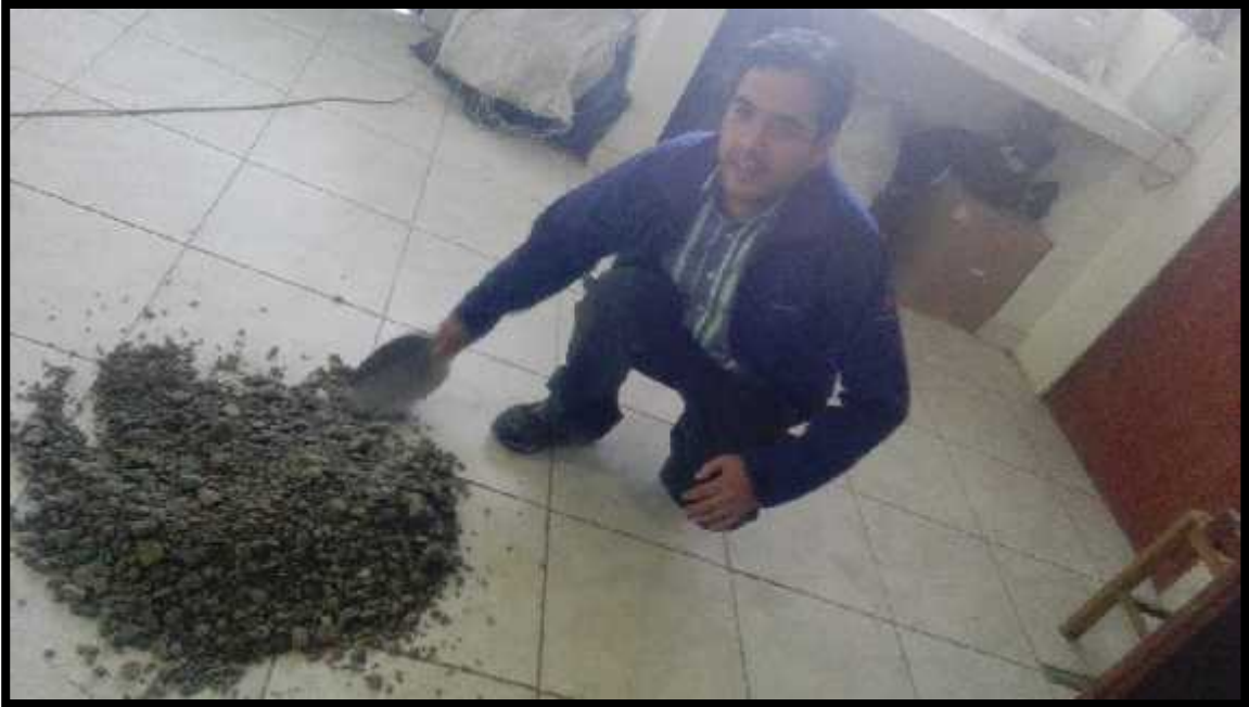
Foto 03: Tomamos la muestra de agregado grueso de \frac{1}{2} " y grava de \frac{3}{4} ", aproximadamente 10 kg de cada una, enseguida se mezclan. Se procede a cuartear la muestra, hasta obtener el espécimen.
