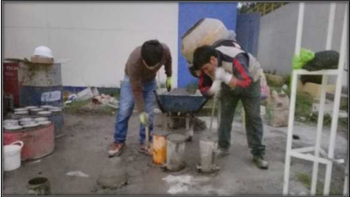
Foto 18: Haciendo el respectivo varillado en las Probetas de Concreto.
