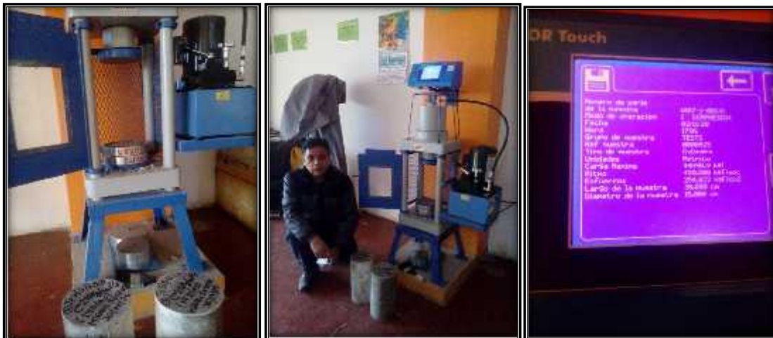
Foto 38: Colocación de las probetas del concreto para calcular su resistencia.
