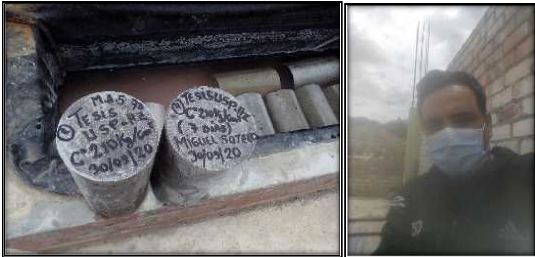
Foto 34: Sacando las probetas de concreto de la poza de curado a los 7 días.
