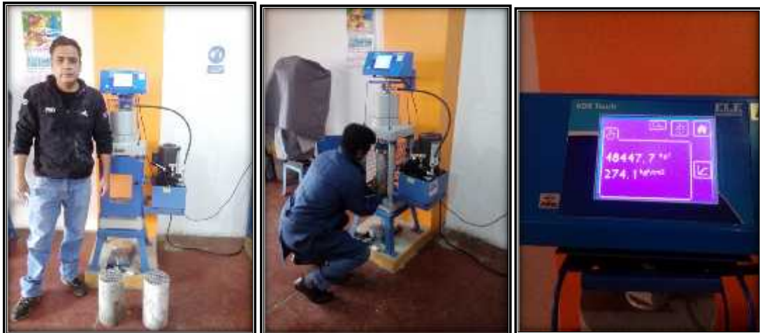
Foto 35: Colocación de las probetas del concreto para calcular su resistencia.
