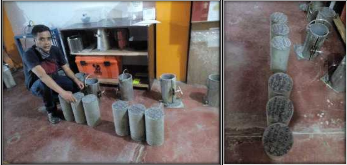
Foto 32: Sacando las briquetas de concreto de los moldes cilíndricos para el curado.
