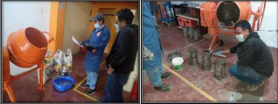
Foto 27: Pesando los agregados y el cemento utilizados en el diseño del concreto.
