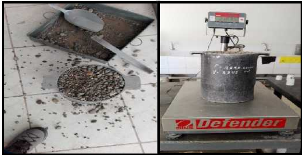
Foto 13: Agregamos el agregado grueso a 1/3 de la altura total de la Olla a una altura 15 cm formando 3 capas y en cada capa se va compactar con 25 golpes con la varilla, enrazamos y los excedentes de los bordes los limpiamos con una brocha y pesamos la muestra y ese acto lo repetimos 3 veces.
