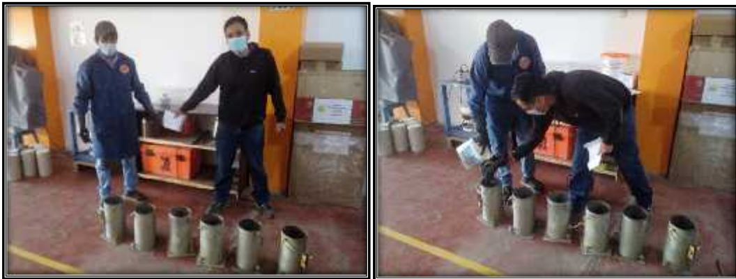
Foto 28: Alistando y echando petróleo a las probetas cilíndricas.
