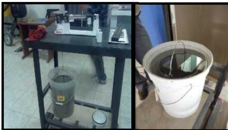
Foto 08: Colocamos la muestra de agregado saturado superficialmente en la canasta metálica para determinar el peso saturado.
