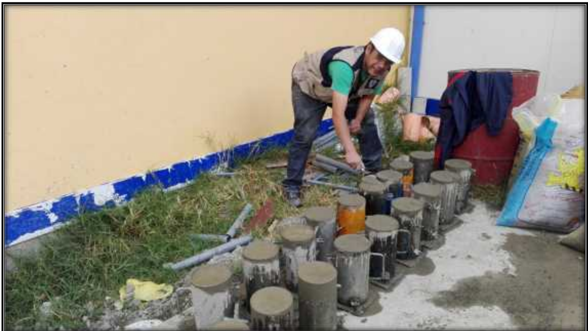
Foto 19: Preparando las Probetas de Concreto para el secado del mismo.
