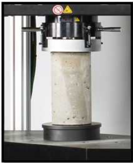
Imagen 2: Probeta de concreto sometida a carga.
