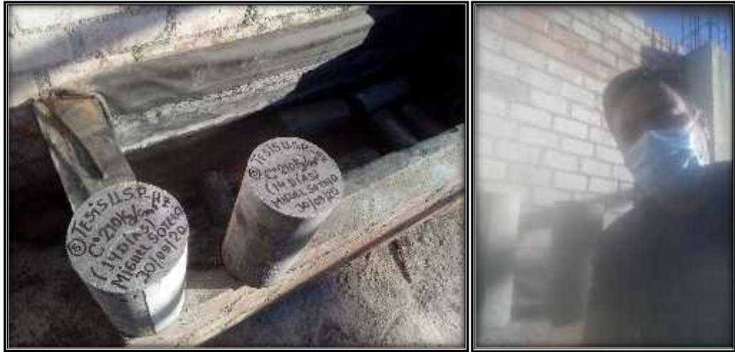
Foto 37: Sacando las probetas de concreto de la poza de curado a los 14 días.
