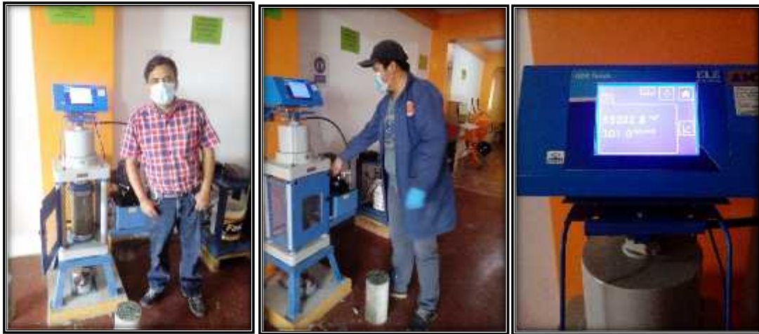
Foto 41: Colocación de las probetas del concreto para calcular su resistencia.
