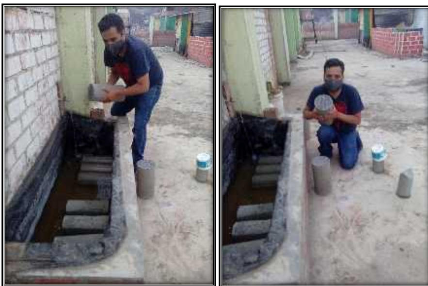
Foto 33: Colocando las briquetas de concreto en la poza de curado.
