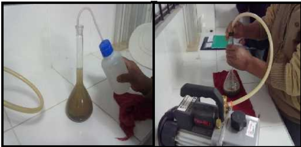
Foto 11: Inmediatamente se introduce en el picnómetro aforado 300 gramos del agregado fino y se le añade agua hasta aproximadamente 90% de su capacidad. Para eliminar el aire atrapado se rueda el picnómetro sobre una superficie plana e incluso agitando, manual, mecánica o invirtiendo si es preciso. Se determina su peso total del picnómetro, muestra, agua y así determinamos su peso seco.
