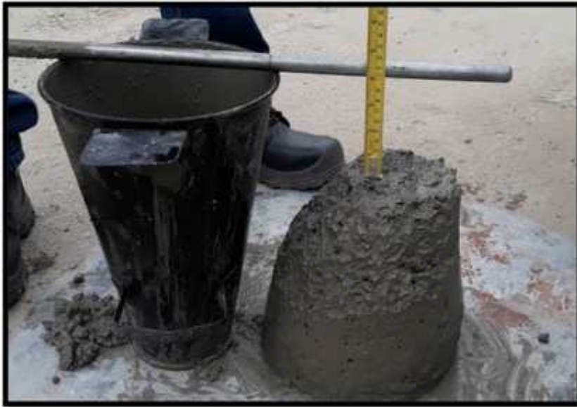
Imagen 1: Control de calidad del concreto (Prueba Slump).
