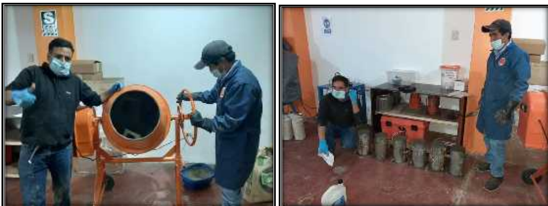
Foto 29: Mezclando los agregados y el llenado del mismo en las probetas cilíndricas.
