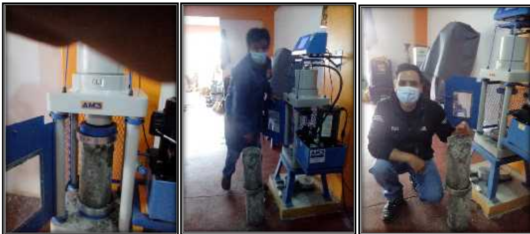
Foto 36: Rotura visible de las briquetas de la Resistencia del concreto.
