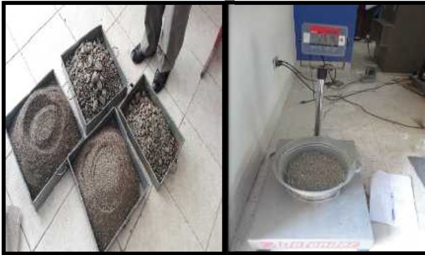
Foto 05: Tomamos la muestra del agregado fino, aproximadamente unos 10 kg. Luego se procede a cuartear la muestra, hasta obtener el espécimen de laboratorio de 2.315 kg.
