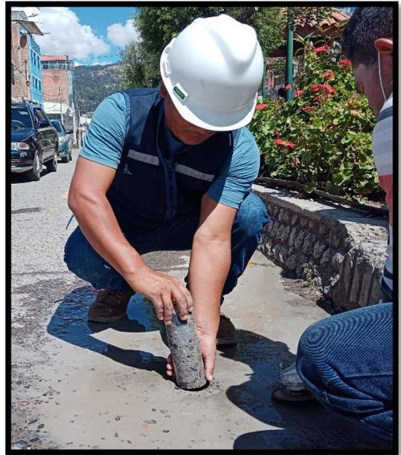
En las imágenes se puede apreciar rotura de las muestras extraídas en campo con equipo de diamantina de la av. raymondi- 2022.
