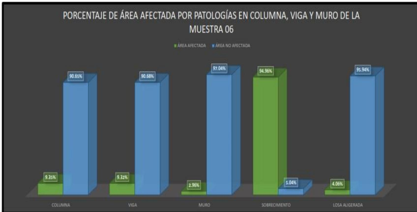
Figura 22. Porcentaje de área afectada por patologías en columnas, vigas y muro de la muestra 06.
