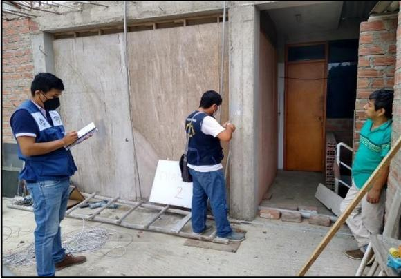
**Fotografía 22:** Prueba de Esclerometría en columna segundo nivel.
