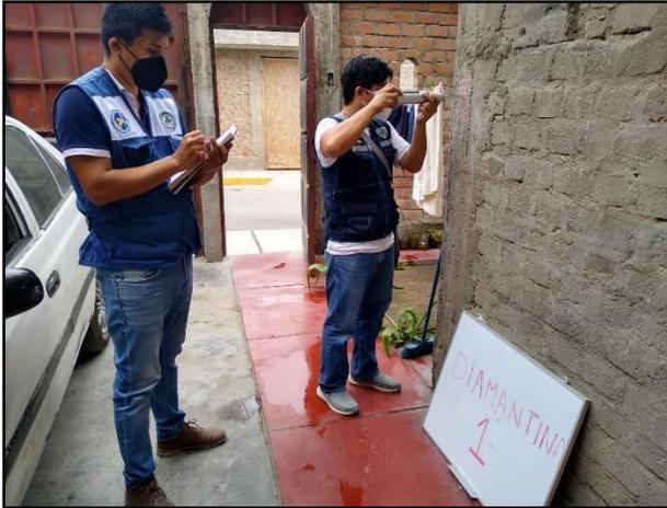
**Fotografía 14:** Prueba de Esclerometría en columna interior.
