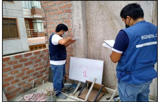
**Fotografía 23:** Prueba de Esclerometría en columna
