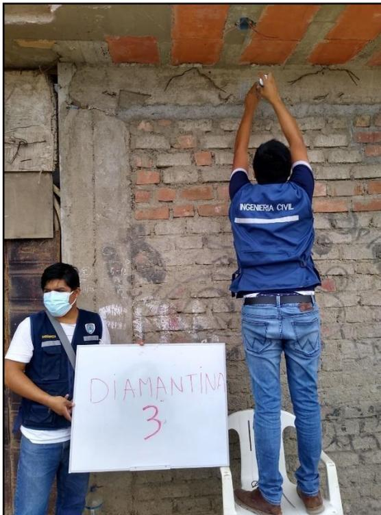
**Fotografía 21:** Prueba de Esclerometría en viga fachada.
