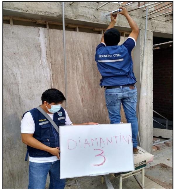
**Fotografía 24:** Prueba de Esclerometría en viga segundo nivel trazo de cuadrícula
