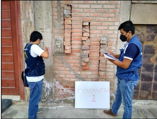
**Fotografía 20:** Prueba de Esclerometría en columna fachada.
