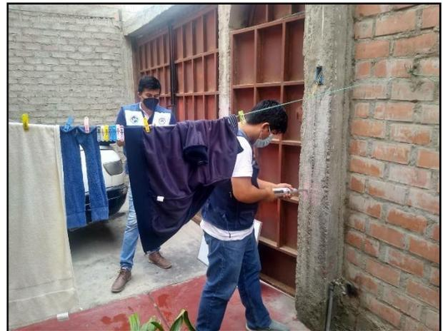
**Fotografía 17:** Prueba de Esclerometría en columna fachada observación de datos.
