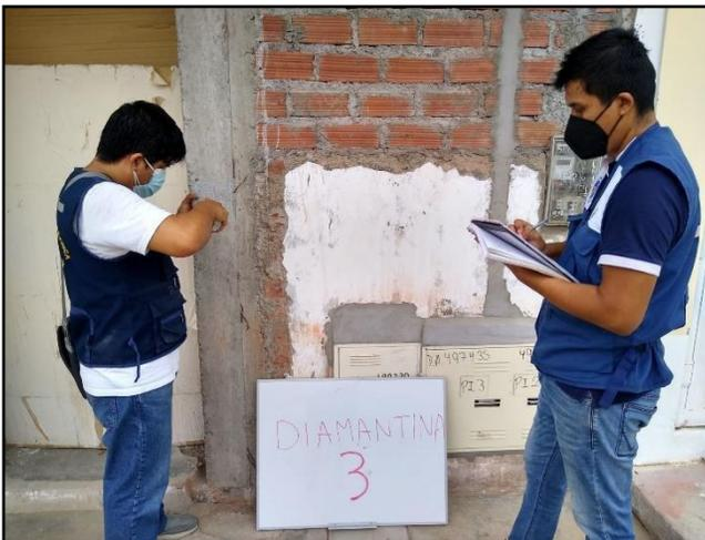
**Fotografía 13:** Prueba de Esclerometría en columna fachada observación de datos.
