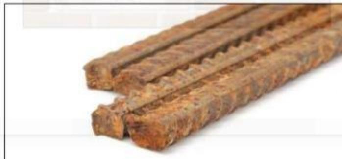
**Figura 22:** Oxidación de varillas de acero.
