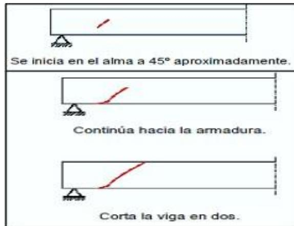
**Figura 38:** Evolución de una fisura de esfuerzo cortante.
