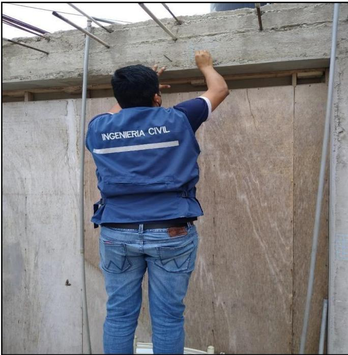
**Fotografía 24:** Prueba de Esclerometría en viga segundo nivel trazo de cuadrículas
