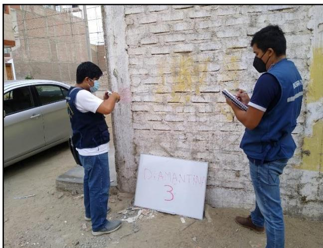
**Fotografía 08:** Prueba de Esclerometría en obtención de datos.
