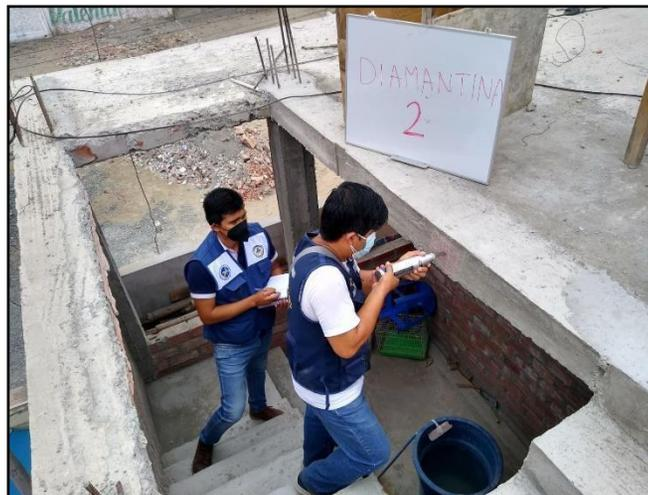
**Fotografía 10:** Prueba de Esclerometría en columna interior de vivienda.
