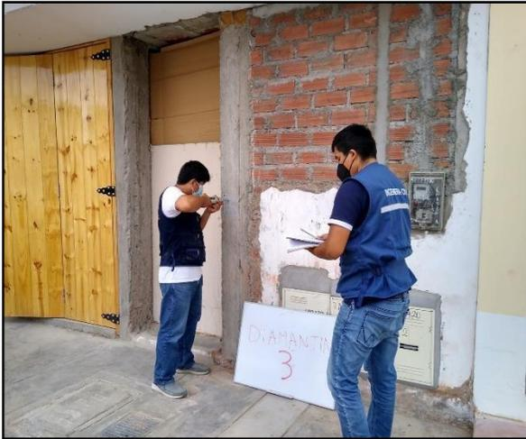
**Fotografía 12:** Prueba de Esclerometría en columna fachada.
