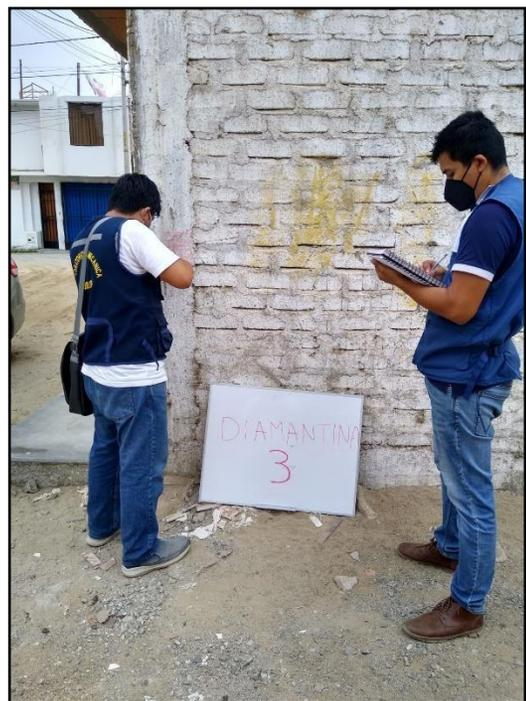
**Fotografía 09:** Prueba de Esclerometría columna Fachada.
