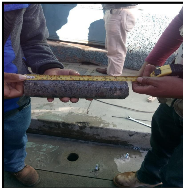
Figura 27: tomando medidas al testigo de concreto.
