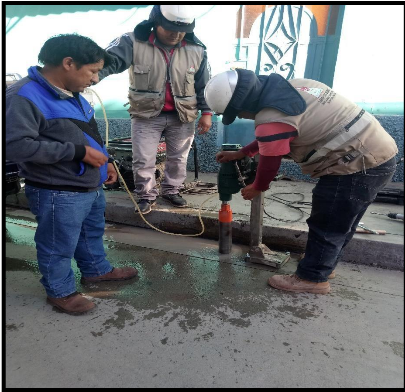
Figura 22: realizando la extracción de la 1° diamantina.
