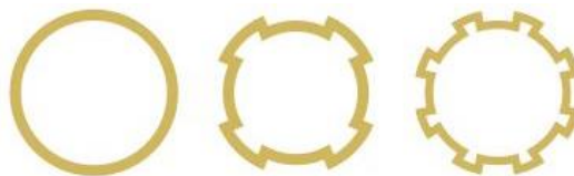
Figura 15. Compacidad de una edificación, 2020 Fuente: Serra Florensa, R. Coch Roura, H., 1995- Arquitectura y energía natural
