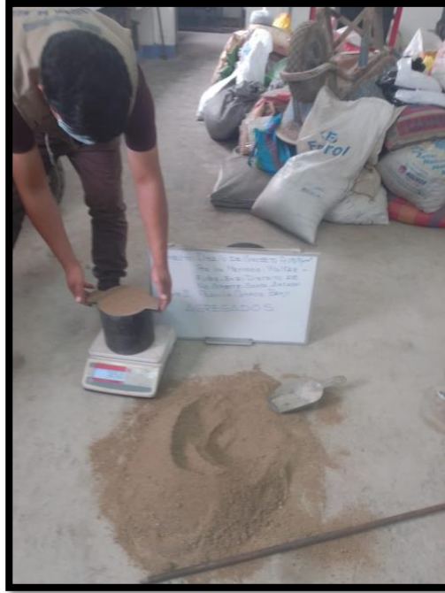
Figura 33. Pesaje del añadido espeso para la prueba de P.U. compactado y seco
