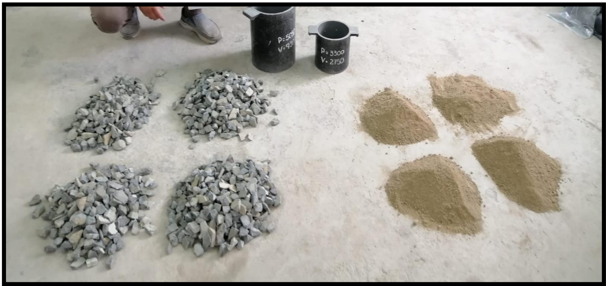
Figura 35. Cuarteo d ellos agregados fino y grueso listo para el ensayo
