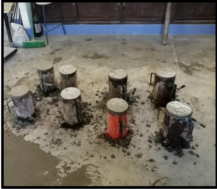
Figura 41. Dejando las probetas de concreto para su tiempo de fragua.
