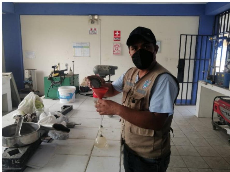
Figura 46. Se procedió a realizar el ensayo de peso específico del cemento, de la ceniza de huarango, de la arcilla y de la combinación.
