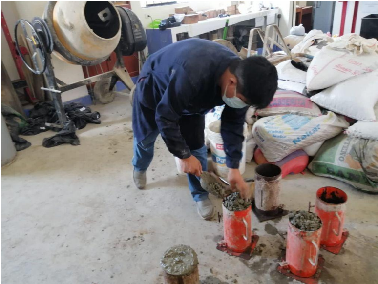
Figura 38. Vaciado de concreto a las probetas
