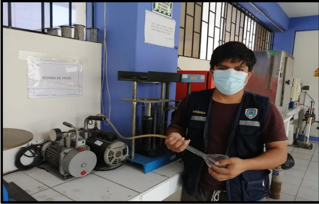
Figura 31. Absorviendo los vacios del fondo de la fiola.
