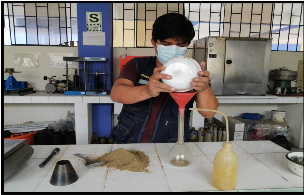
Figura 29. Agregando el agregado fino dentro de la fiola
