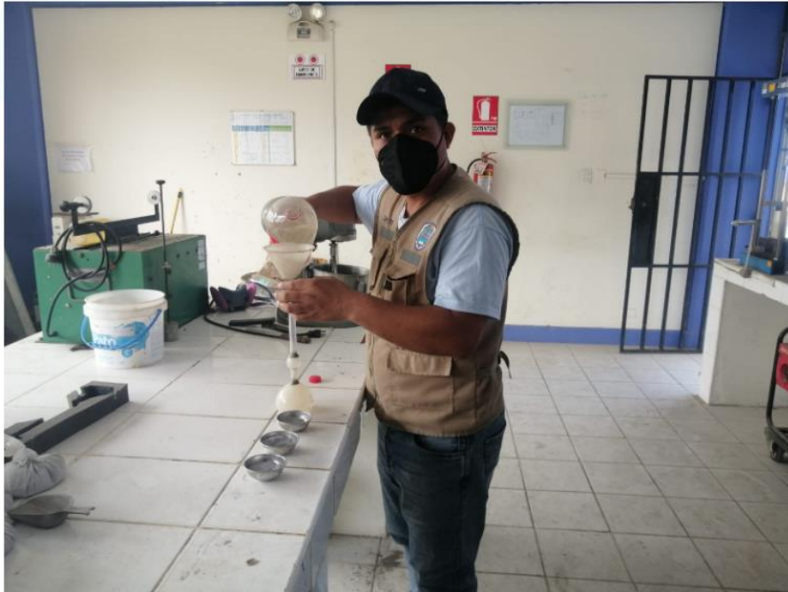
Figura 45. preparando las muestras para realizar el peso específico del cemento, de la ceniza de huarango, de la arcilla y de la combinación
