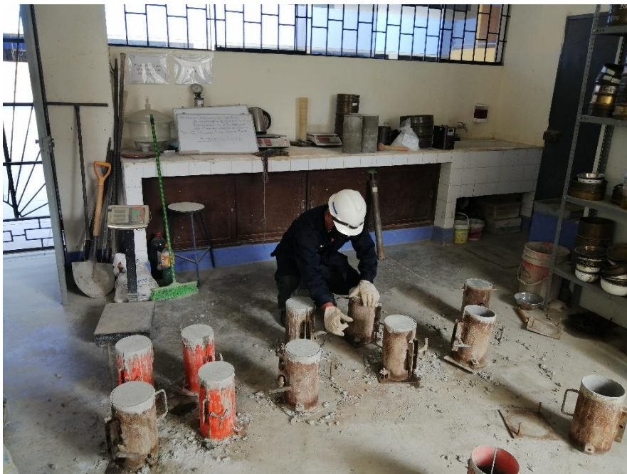
Figura 42. Desencofrando las probetas al día siguiente de su vaciado.
