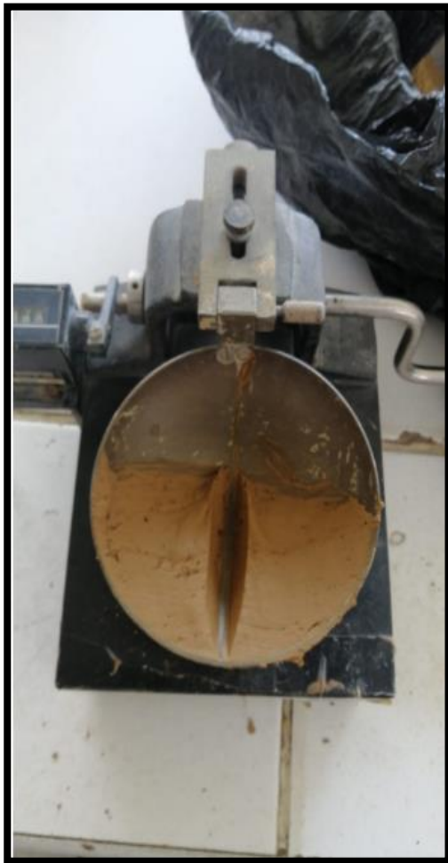
Figura 17. Moldeando la arcilla para realizar los limites de consistencia.
