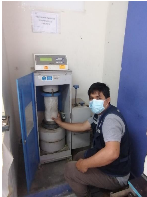
Figura 43. Realizando el ensayo a la compresión de las probetas de concreto endurecido patron.
