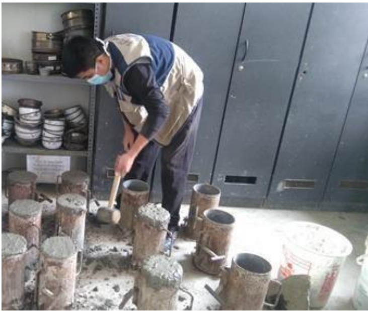
Figura 40 Golpes a la probeta con el martillo de goma
