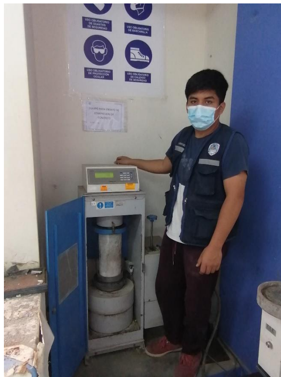
Figura 44. Realizando el ensayo a la compresión de las probetas de concreto endurecido experimental.
