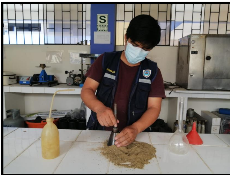
Figura 28. Realizando la prueba del cono del agregado fino.
