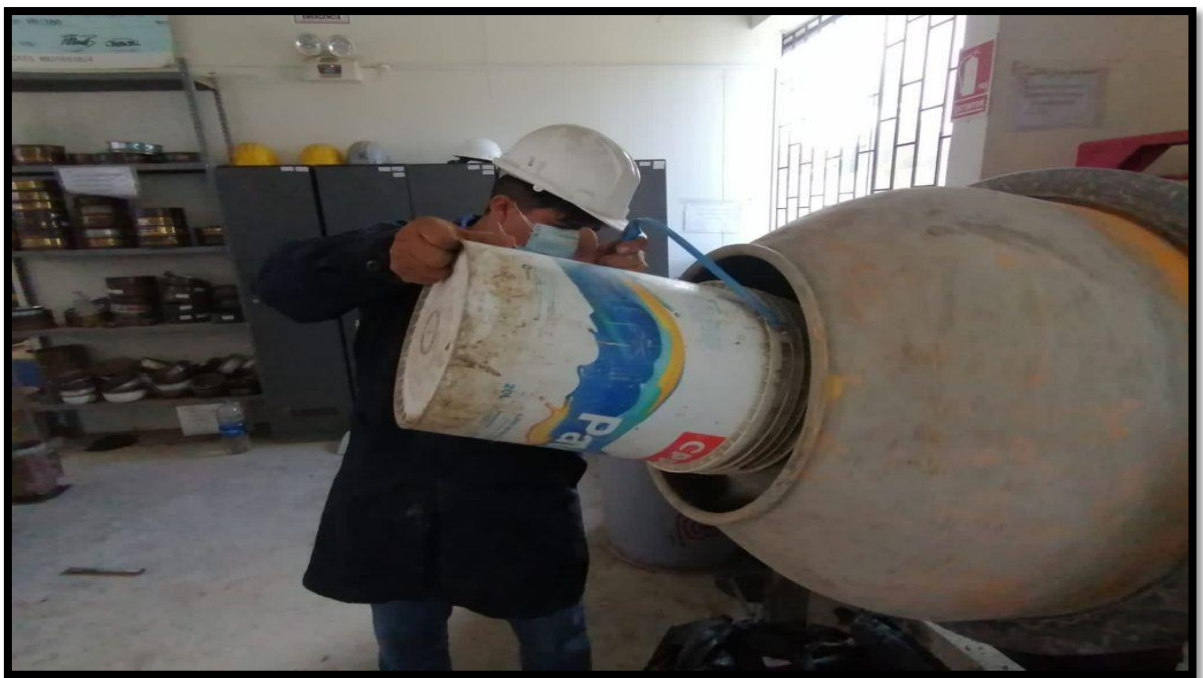
Figura 36. Vaciado del agregado fino al trompo
