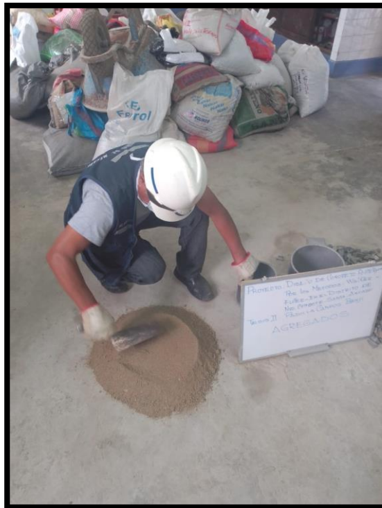
Figura 32. Cuarteo del añadido espeso para la prueba de P.U. compactado y seco
