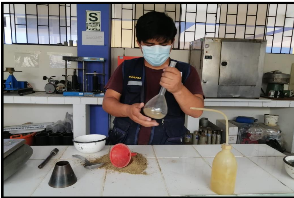
Figura 30. llenado con agua la fiola
