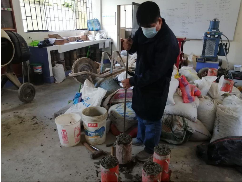
Figura 39. Chuseado del concreto para el concreto
