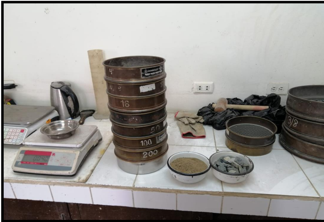
Figura 25. Muestras pasantes del tamizaje del añadido espeso y delgado
