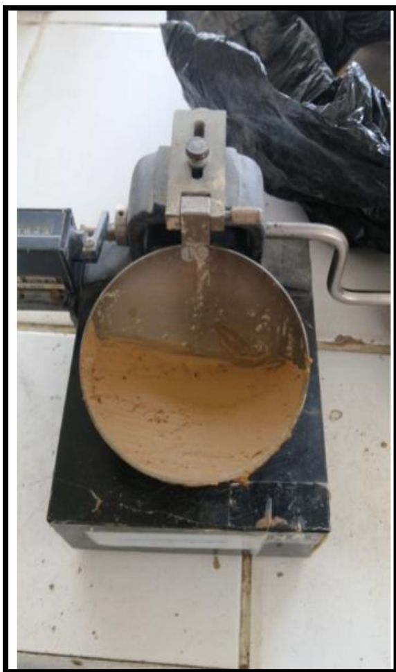
Figura 17. Moldeando la arcilla para realizar los limites de consistencia.
