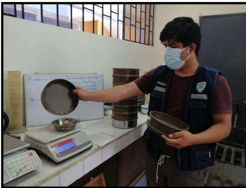
Figura 24. Pesaje del añadido delgado
