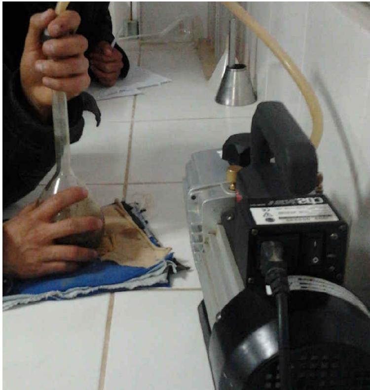
Figura N° 25: Ensayo del peso específico del agregado fino
