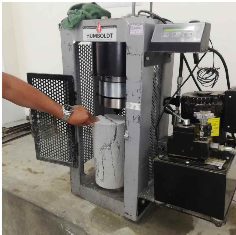
Figura N° 33: Falla del testigo de concreto con sustitución del agregado grueso en 10% por residuo de acrílico.
