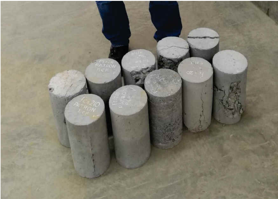
Figura N° 34: Testigos con ensayo de resistencia a la compresión
