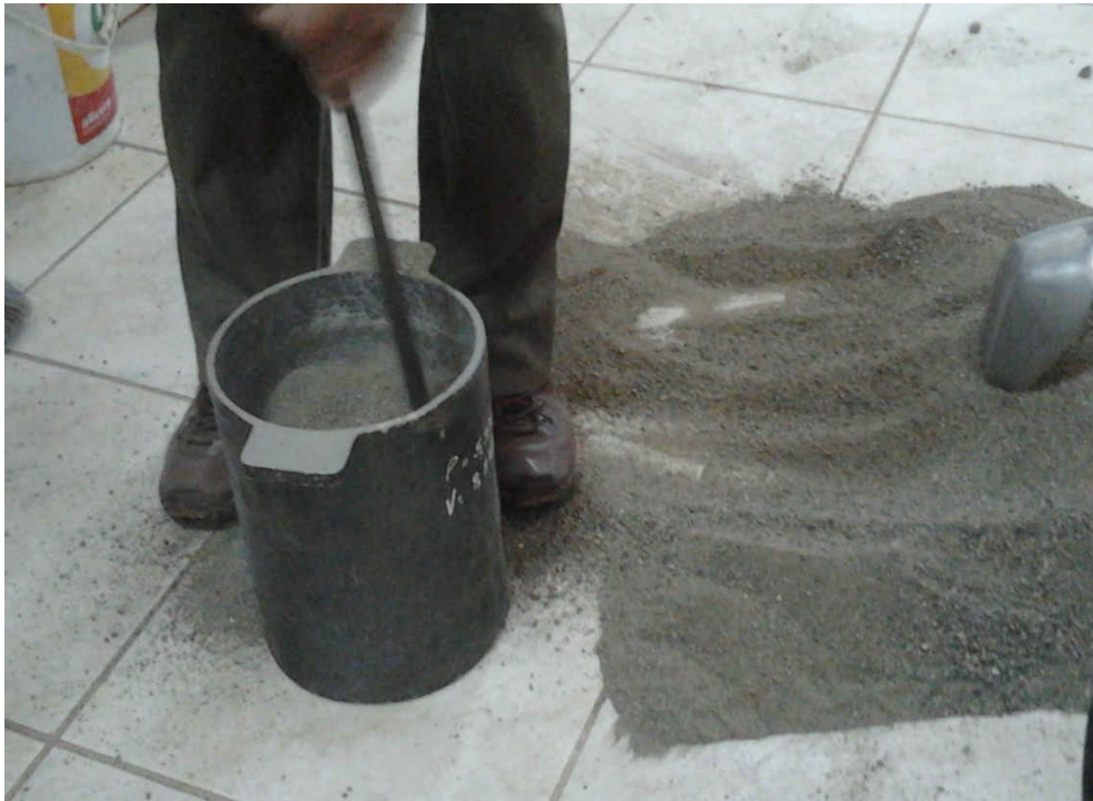
Figura N° 20: Ensayo de peso unitario compactado
