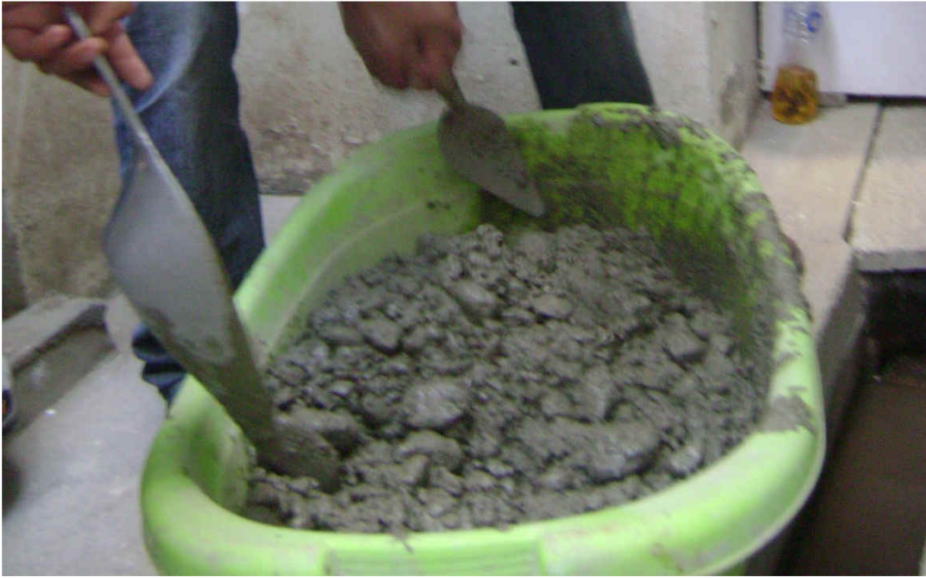
Figura N° 26: Concreto para elaboración de probetas
