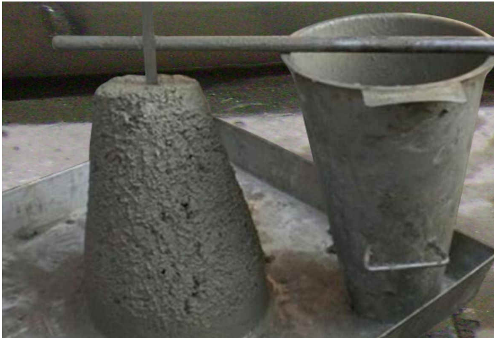
Figura N° 27: Medida del asentamiento de la mezcla
