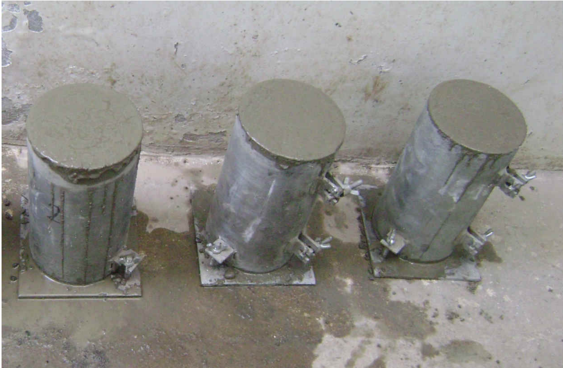
Figura N° 30: Moldes llenos con la mezcla de concreto
