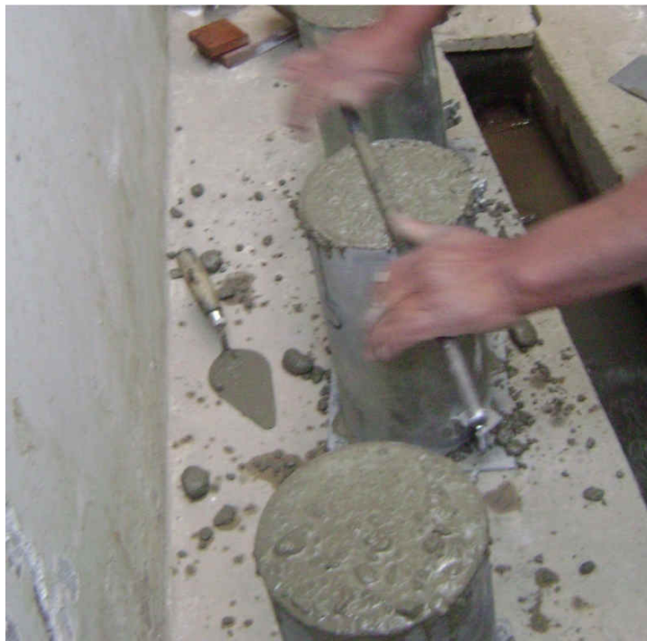
Figura N° 29: Enrazado del molde con mezcla de concreto
