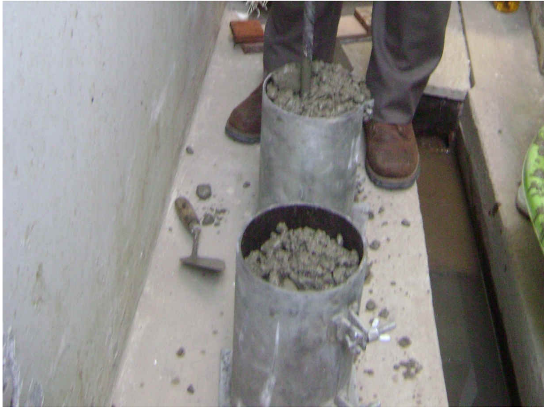
Figura N° 28: Colocación de la mezcla de concreto en el molde
