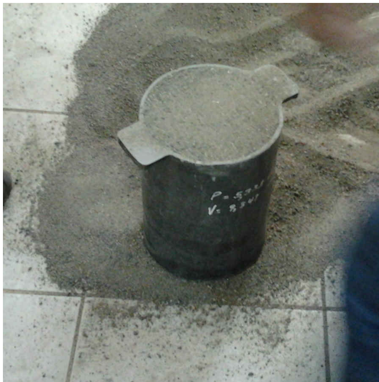
Figura N° 19: Ensayo de peso unitario suelto
