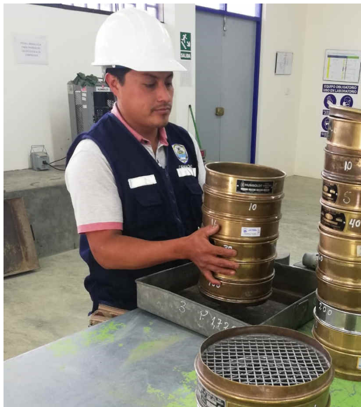
Figura N° 17: Análisis granulométrico de los agregados
