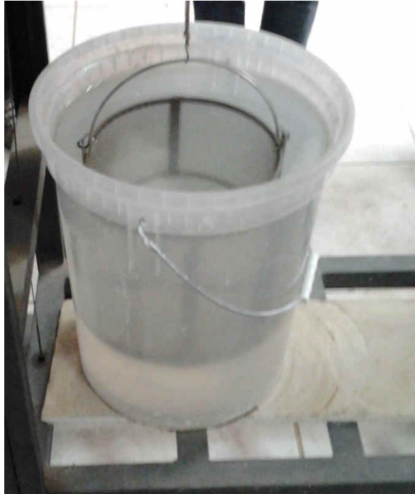
Figura N° 18: Ensayo de peso específico y absorción de los agregados.
