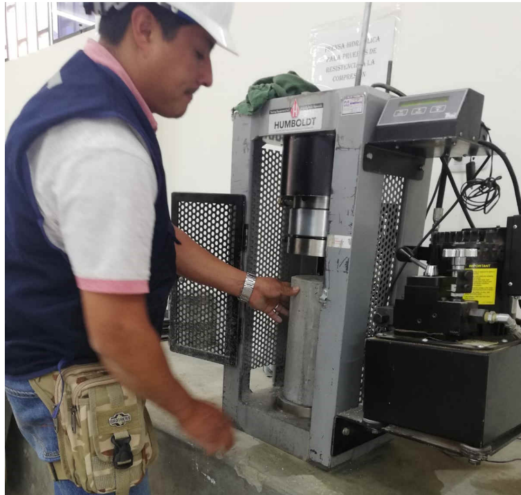
Figura N° 32: Ensayo de resistencia a la compresión
