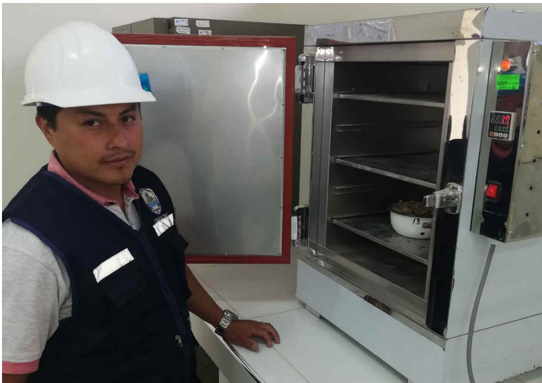
Figura N° 23: Muestra colocada en el horno para obtener el contenido de humedad
