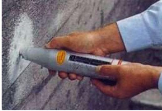
**Figura 32.** *Ensayo de Esclerometría aplicado a un muro de concreto*
