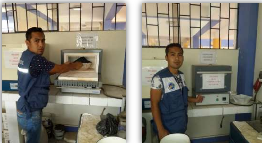
FIGURA N°15 y 16: Calcinación de las cenizas del rastrojo de maíz a una temperatura de 350°
