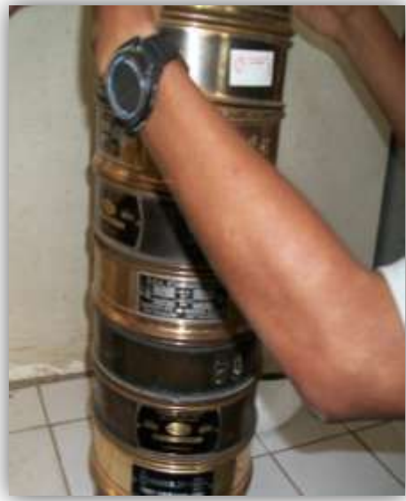
FIGURA N° 27: Tamizado de los Agregados
