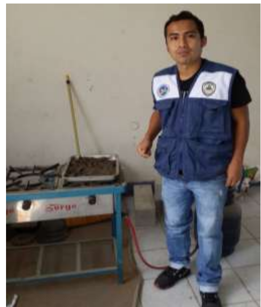
FIGURA N° 31: Secado de muestras para E. de Gravedad Específica y A
