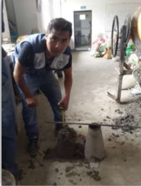
FIGURA N° 39: Tomando medida del asentamiento
