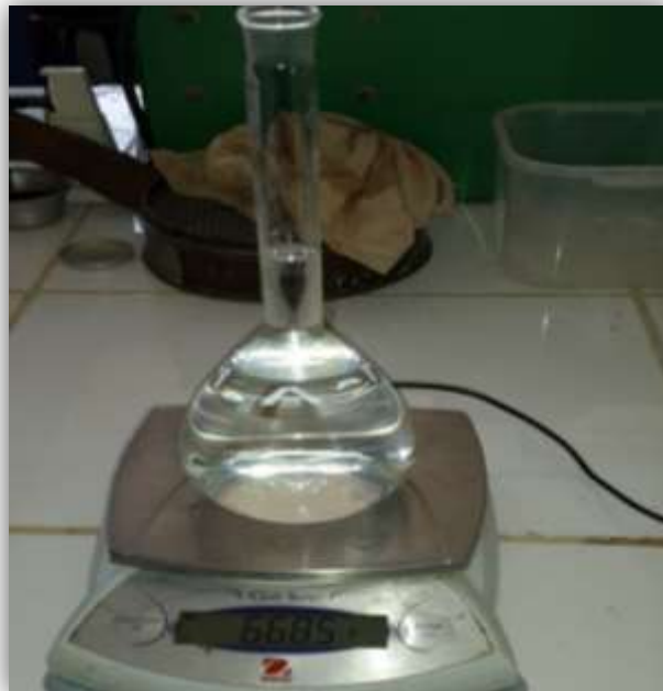
FIGURA N° 33: Pesado de Picnómetro con agua para Ensayo de Absorción
