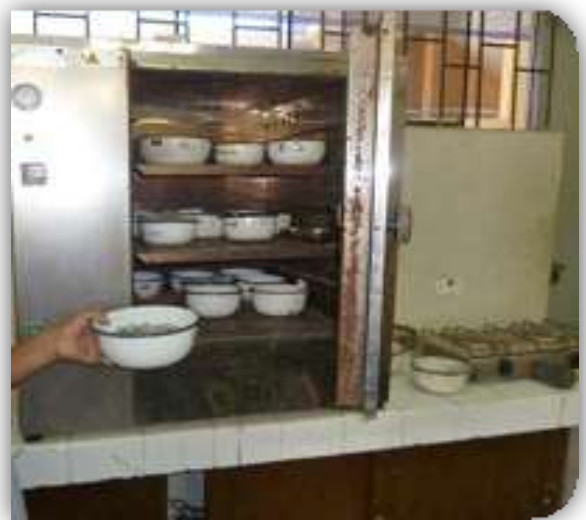
FIGURA N° 29: Ensayo de contenido de humedad.
