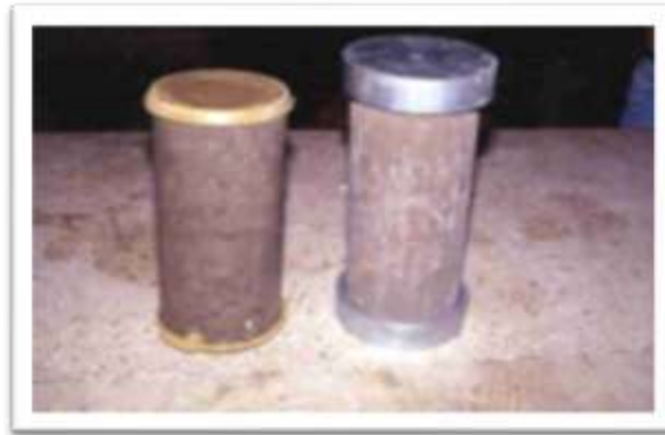
Refrentado de cilindros de concreto.
