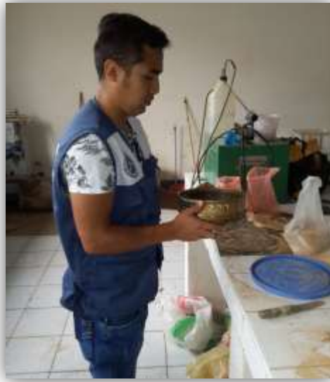
FIGURA N° 17: Tamizado de las cenizas del rastrojo de maíz por la malla N° 200
