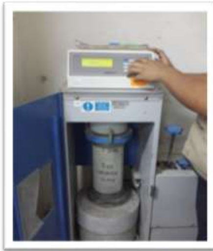
Ensayo de Resistencia a la compresión del concreto
