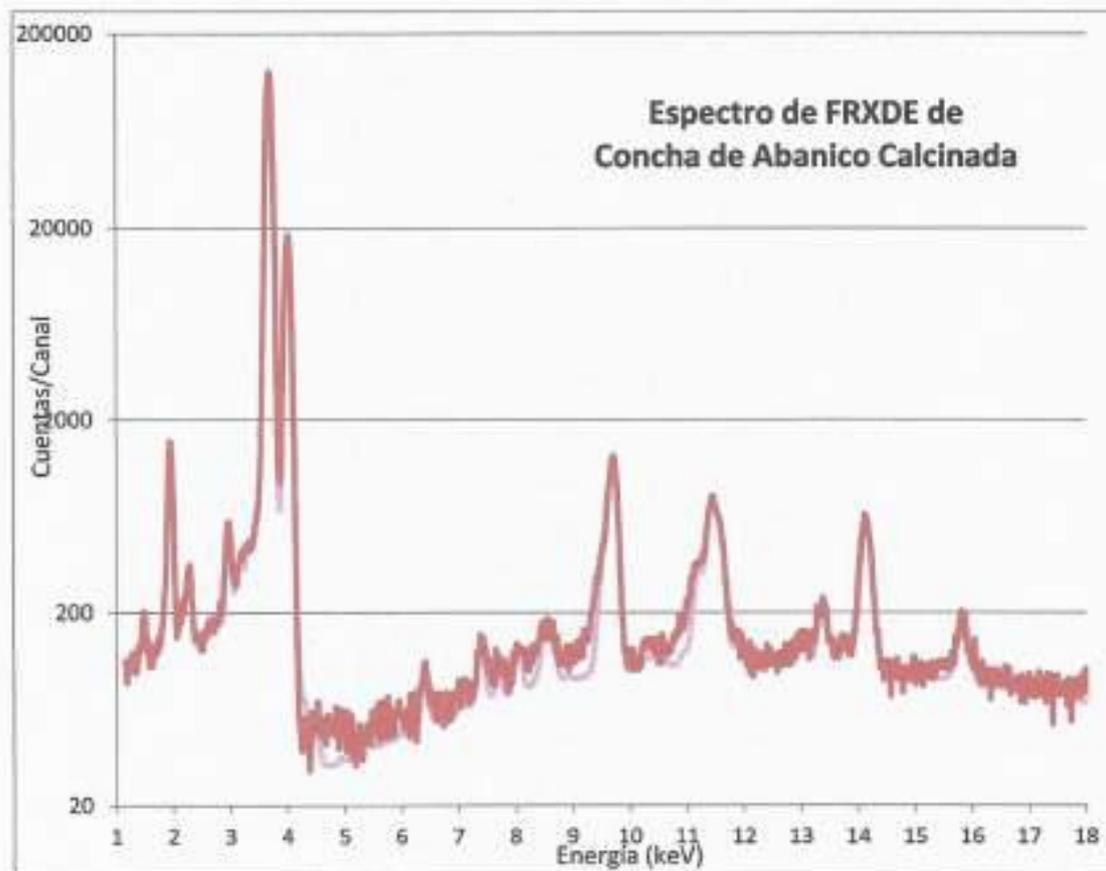
Figura 1. Espectro de FRXDE de una muestra de ceniza de concha de abanico en escala semi-logarítmica representado por una curva de color rojo. Incluye el pico de Ar del aire y los picos de rayos-X de Au dispersados por la muestra. La curva azul representa el espectro simulado.
