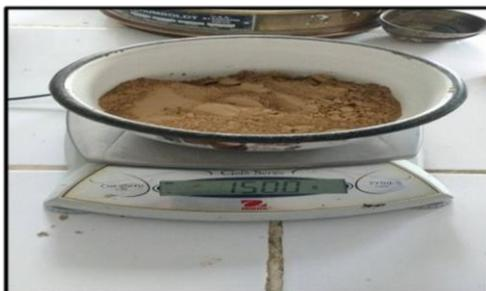
**Figura 5:** Arcilla lavada, Secada a 110°C, Molida y Tamizada por la malla organza y N° 200.
