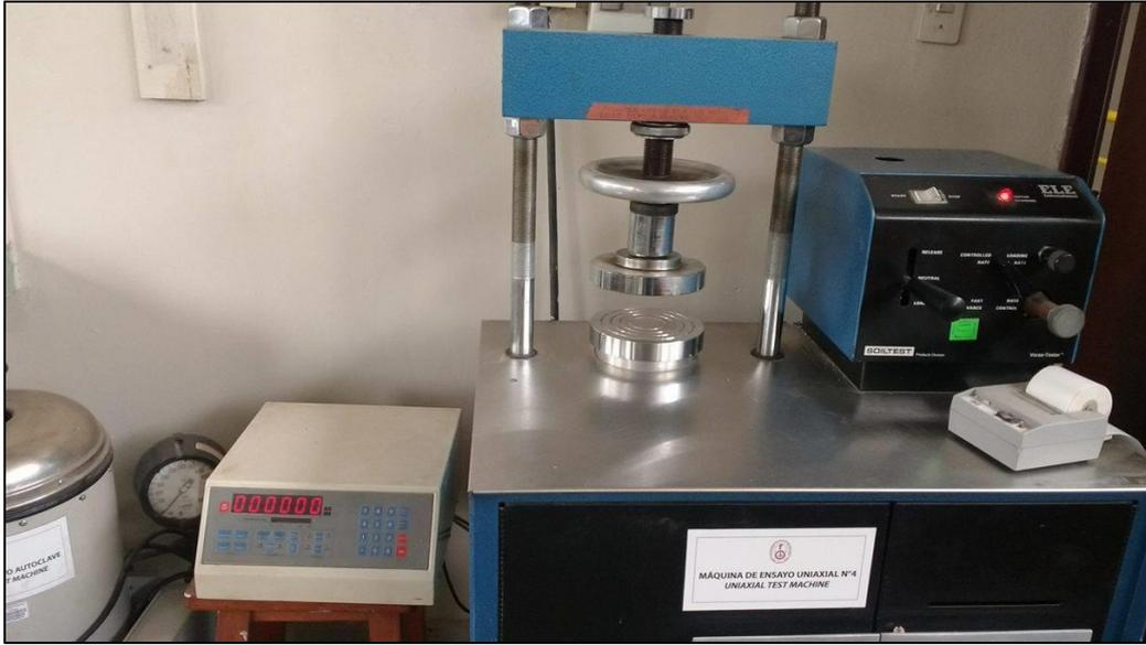
**ENSAYO A LA COMPRESION PARA MORTERO – LABORATORIO DE ENSAYO DE MATERIALES (UNI)**
