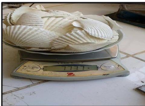
**Figura 10:** Muestra ya Calcinada a 900°C. Posteriormente se pesa para conocer la pérdida de masa. Luego sellar para evitar contaminación.
