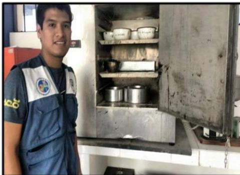
**Figura 9:** Posteriormente se pone a secar a 110°C durante 24 horas en la estufa de la Usp.
