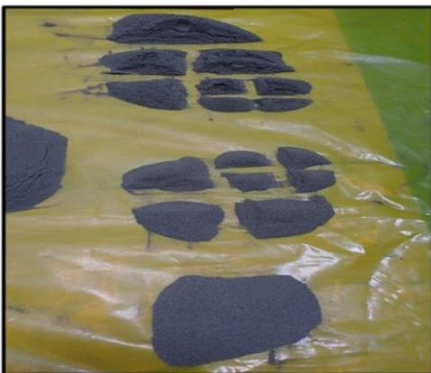
**Figura 14:** Cuarteo de cada peso retenido para tener una mezcla homogénea.
