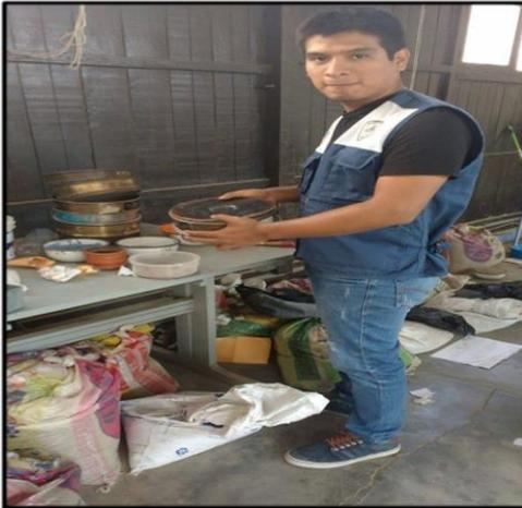
**Figura 12:** La arena es tamizada por la malla N°4, 8, 16, 30, 50, 100 y 200. Según la N.T.P. 400.037
