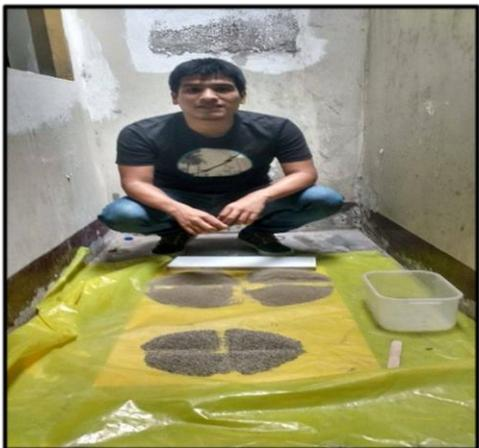
**Figura 13:** Una vez tamizada y pesada la arena según la Tabla 11. Procedemos a mezclar cada peso retenido
