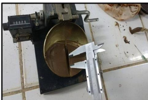
**Figura 6:** Ensayo de Límites de Atterberg:
