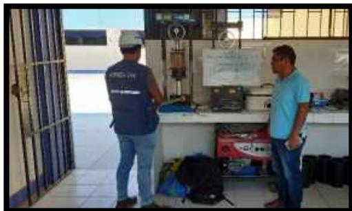
**Figura 87.** Continuando con el CBR procedí a hacer la penetración luego de haber sacado los moldes a arear aprox 30 min (05 - 02 - 2020) - en este día hice la penetración de mi C-, C-2, C-3 (56, 25,12 GOLPES) y extraer muestras en taras para ser colocadas al horno, en presencia del Ing. Miguel Jara Solar.
