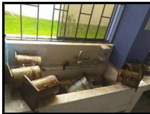
**Figura 46.** Continuando con el CBR procedí a hacer la penetración luego de haber sacado los moldes a orear aprox 30 min (28 - 01 - 2020) - en este día hice la penetración de mi C-1, C-2, C-3 (56, 25,12 GOLPES) y elabore el Proctor experimental a 8%.
