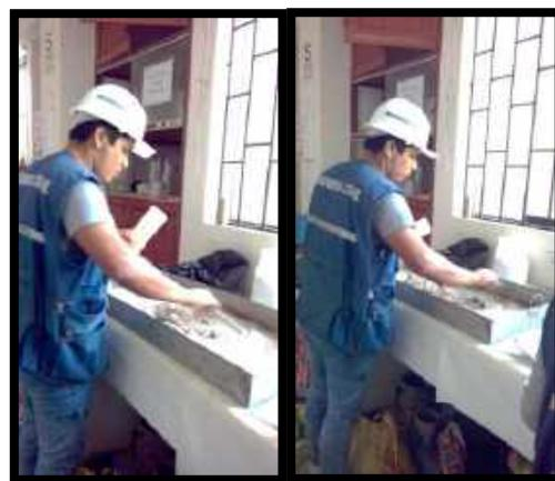
**Figura 75.** Una vez mezclado el material comencé a agregarle el agua obtenida del cálculo de mi Proctor – Este proceso se realizó para la (C1-C2-C3) (03/02/2020)
