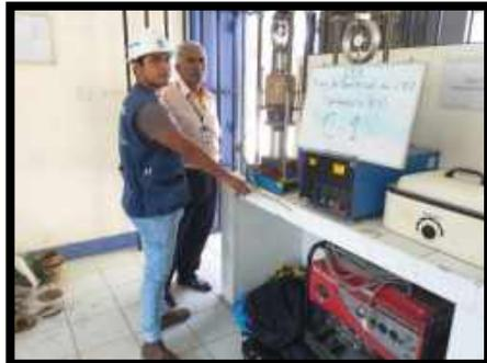
**Figura 86.** Continuando con el CBR procedí a hacer la penetración luego de haber sacado los moldes a arear aprox 30 min (05 - 02 - 2020) - en este día hice la penetración de mi C-1, C-2, C-3 (56, 25,12 GOLPES) y extraer muestras en taras para ser colocadas al horno, en presencia del Ing. Segundo Urrutia Vargas.
