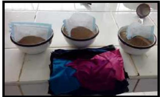
**Figura 24.** Una Vez Seco Nuestro Material Procedemos retíralo del Horno en las mismas Taras, esperamos que enfríe para luego ser pesadas y poder Hallar Nuestro Contenido de Humedad - (21 – 01 – 2020) – (Tara + Suelo Seco)
