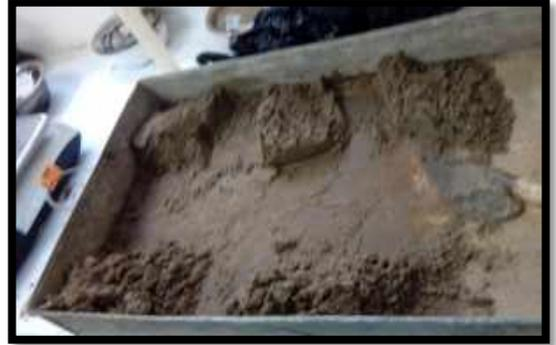
**Figura 26.** Luego de la Mezclado de Cada muestra a distinto porcentaje de H<sub>2</sub>O separamos en 05 partes para luego vaciar una por una hacia un Molde de Compactación en el cual será compactado por un Martillo Pistón mediante 26 Golpes- (21 – 01 – 2020) – El Mismo Proceso de Realizo para las Calicatas C2 y C3
