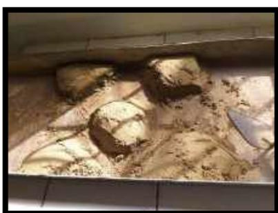
**Figura 91.** Una vez Mezclado la arena con la ceniza de concha de lapicero y procedemos a vaciar el agua, volvemos a mezclar y luego partimos la mezcla en 5 partes - (05/02/2020) - El mismo proceso se realiza para la C-2 y c-3
