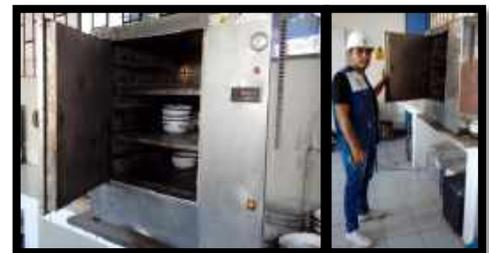
**Figura 58.** Del paso anterior procedemos a ingresar las taras + Suelo Húmedo al Horno para el respectivo secado durante 24 horas- (28/01/2020) - El mismo proceso se realiza para la C-2 y c-3
