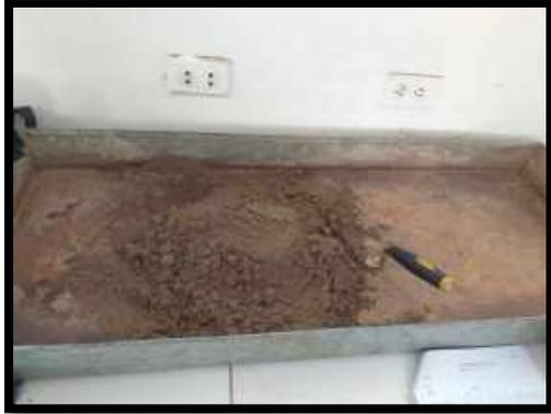
**Figura 25.** Para realizar este ensayo por Cada Calicata Se Utilizó 3 Bolsas de 3 Kg, La preparación de la muestra se realiza: para a Bolsa N°01 a un 3% de H<sub>2</sub>O que equivale al 90 ml, Bolsa N°02 a un 6% de H<sub>2</sub>O que equivale al 180 ml y Bolsa N°03 a un 9% de H<sub>2</sub>O que equivale al 270 ml - (21 – 01 – 2020) – El Mismo Proceso de Realizo para las Calicatas C2 y C3
