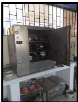
**Figura 45.** Las Taras con las Muestras Húmedas fueron colocadas en el Horno para el secado, al día siguiente fueron pesadas se separó por la compactación dada por un Martillo Pisón mediante 56 Golpes por parte para la 1° Bolsa, 25 Golpes por parte para la 2° Bolsa y 12 Golpes por parte para la 3° Bolsa - (24 - 01 - 2020) - El Mismo Proceso de Realizo para las Calicatas C2 y C3
