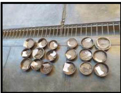
**Figura 96.** Al día siguiente se procedió a retirar las muestras del horno dejarlas enfriar y pesarlas (06/02/2020), 9 Taras para hallar la Absorción de la Penetración de CBR Experimental a 8% y 9 Taras de la Elaboración de CBR a un 13%.
