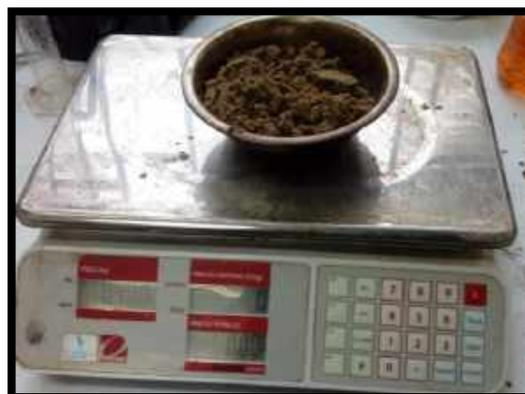
**Figura 48.** Luego de Haber realizado la penetración de extrajo 500 gr de muestra (Tara + Muestra) para luego ser colocadas al Horno (28 - 01 - 2020) - en este día hice la penetración de mi C-1, C-2 y C-3 (56, 25,12 GOLPES)
