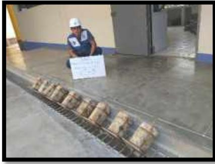
**Figura 97.** Continuando con el CBR procedí a hacer la penetración luego de haber sacado los moldes a arear aprox 30 min (07-02-2020) – en este día hice la penetración de mi C-1, C-2, C-3 (56, 25,12 GOLPES).
