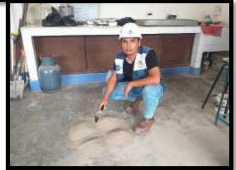
**Figura 18.** Llevamos las Muestras al Laboratorio, me encuentro Tamizando con el Tamiz N°04 para luego separar las cantidades de material que se utilizaran para los ensayos de Proctor y CBR (20 – 01 – 2020)
