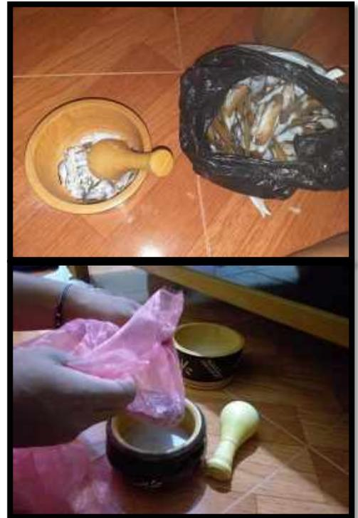
**Figura 6.** En esta Imagen observamos que se seleccionó una pequeña cantidad de Material Lavado y secado para proceder a Molerlo en Mortero y pasarlo por la Tela Organza para realizar el Ensayo ATD en la Ciudad de Trujillo – (16/01/2020)
