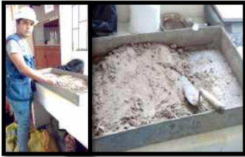
**Figura 76.** Proceso de mezclado de la muestra de suelo + concha de Lapicero + H<sub>2</sub>O - Este proceso se realizó para la (C1-C2-C3) (03/02/2020)
