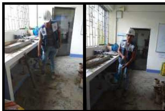
**Figura 92.** Luego de la Mezcla de Cada muestra a distinto porcentaje de H2O por Calicata, separamos en 05 partes para luego vaciar una por una hacia un Molde de Compactación en el cual será compactado por un Martillo Pisón mediante 56 Golpes por parte para la 1° Bolsa, 25 Golpes por parte para la 2° Bolsa y 12 Golpes por parte para la 3° Bolsa - Este proceso se realizó para la (C1-C2-C3) (05/02/2020)
