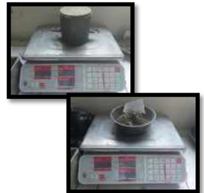
**Figura 68.** Se retiró y peso el Molde con la Muestra Húmeda - y se extraen muestras en taras para ponerlas al horno durante 24 horas, (30/01/2020) - El mismo proceso se realiza para la C-2 y c-3.
