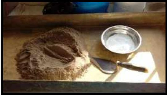
**Figura 63.** Se utilizaron 3 Bolsas de 3kg al cual se le adiciono 390gr de Ceniza de Concha de Lapicero pasada por el Tamiza N°100 por cada Bolsa (30/01/2020) – El mismo proceso se realiza para la C-2 y c-3
