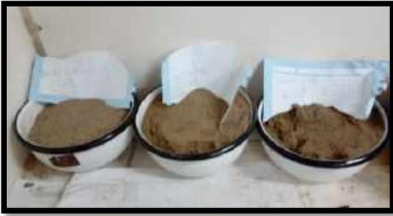
**Figura 21.** Realizado el paso anterior separamos una Muestra en una Tara por cada calicata para Hacer Nuestro Ensayo de Contenido de Humedad- se procedió a pesar para luego ponerlo a secar en el Horno (20 – 01 – 2020)
