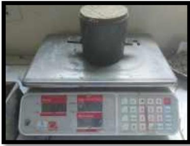
**Figura 55.** Realizado el paso anterior se retiró y peso el Molde con la Muestra Húmeda - (28/01/2020) - El mismo proceso se realiza para la C-2 y c-3
