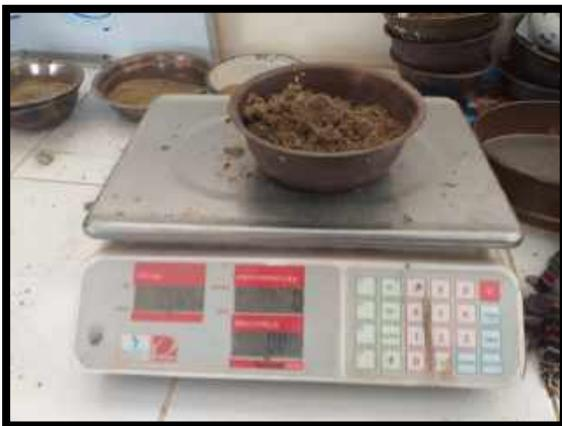
**Figura 31.** Tenemos en la Imagen los 500 gr obtenidos del paso anterior + los 65 gr del peso de la Tara Sola - (21 - 01 - 2020) - El Mismo Proceso de Realizo para las Calicatas C2 y C3
