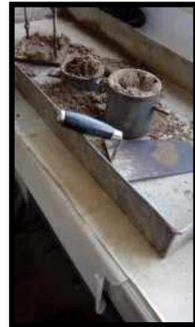
**Figura 30.** Procedí a Extraer en una Tara parte de Muestra compactada del Molde Grande (Muestra sin Tara 500 gr)- (21- 01 - 2020) - El Mismo Proceso de Realizo para las Calicatas C2 y C3
