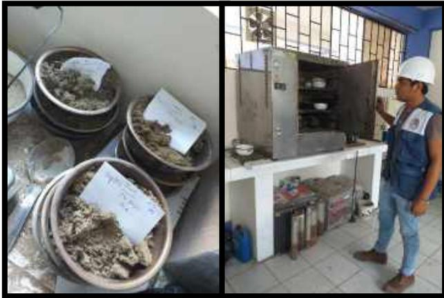
**Figura 94.** De cada molde obtuve muestras representativas para luego ser ingresadas al horno, por Bolsa y Por Cada Calicata - Este proceso se realizó para la (C1-C2-C3) (05/02/2020)
