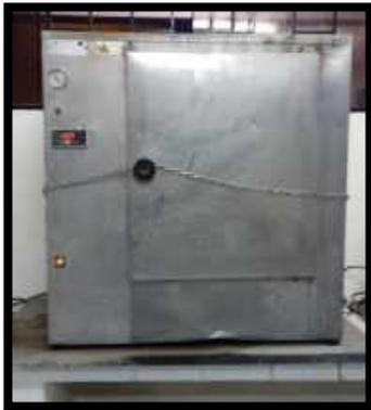
**Figura 33.** Procedí a colocar mis muestras al Horno y esperara al día siguiente para poder pesarlas (21 – 01 – 2020)
