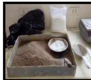
**Figura 73.** Comencé con el peso de la concha de lapicero calcinada y pasada por el Tamiz N°100 (480gr por Bolsa) + muestra de suelo (6Kg) – este paso se realizó por Bolsa (cada calicata contiene 03 bolsas de 6kg) – Este proceso se realizó para la (C1-C2-C3) (03/02/2020)
