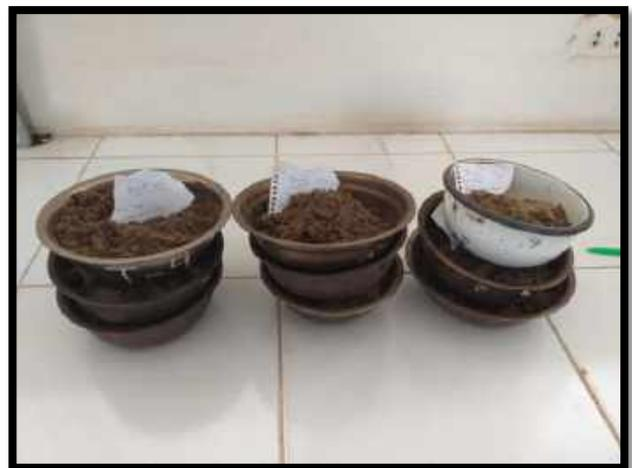
**Imagen 32.** Tenemos en la Imagen los 500 gr obtenidos del paso anterior + los 65 gr del peso de la Tara Sola - (21 - 01 - 2020) - El Mismo Proceso de Realizo para las Calicatas C2 y C3
