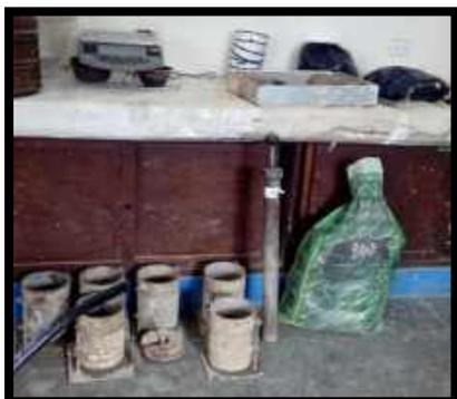
**Figura 89.** Procedí a la preparación de la mezcla de mi material para realizar mi CBR experimental al día Siguiente – Este proceso se realizó para la (C1-C2-C3) (05/02/2020)
