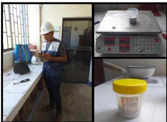
**Figura 62.** En este día realice el tamizado en el Laboratorio a Tamizarlo (Malla N°200) para realizar el ensayo de FRX en la UNI en la Ciudad de Lima (30/01/2020)
