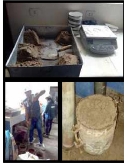
**Figura 77.** Luego de la Mezcla de Cada muestra a distinto porcentaje de H<sub>2</sub>O por Calicata, separamos en 05 partes para luego vaciar una por una hacia un Molde de Compactación en el cual será compactado por un Martillo Pisón mediante 56 Golpes por parte para la 1° Bolsa, 25 Golpes por parte para la 2° Bolsa y 12 Golpes por parte para la 3° Bolsa - Este proceso se realizó para la (C1-C2-C3) (03/02/2020)
