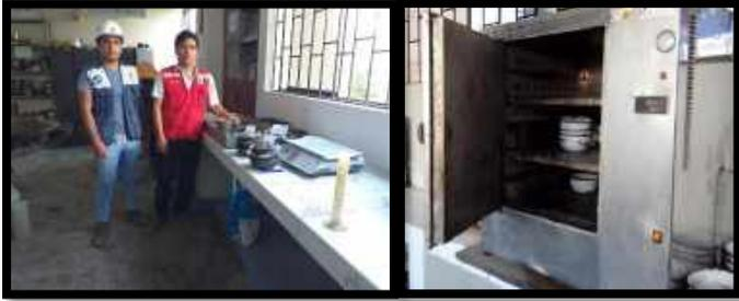
**Figura 69.** Del paso anterior procedemos a ingresar las taras + Suelo Húmedo al Horno para el respectivo secado durante 24 horas- (30/01/2020)
