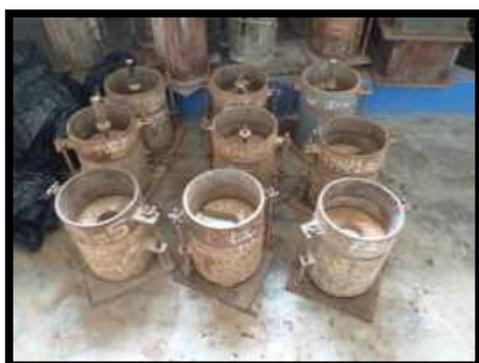
**Figura 43.** Proceso de Trabajo: Luego se procedió a invertir el molde grande, se le coloco el molde pequeño en la parte superior, la colocación de filtro y se separó por la compactación dada por un Martillo Pistón mediante 56 Golpes por parte para la 1° Bolsa, 25 Golpes por parte para la 2° Bolsa y 12 Golpes por parte para la 3° Bolsa - (24 – 01 – 2020) – El Mismo Proceso de Realizo para las Calicatas C2 y C3
