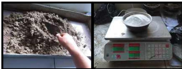
**Figura 90.** Comencé con el peso de la concha de lapicero calcinada y pasada por el Tamiz N°100 (780gr por Bolsa) + muestra de suelo (6Kg) – este paso se realizó por Bolsa (cada calicata contiene 03 bolsas de 6kg) – Este proceso se realizó para la (C1-C2-C3) (05/02/2020)
