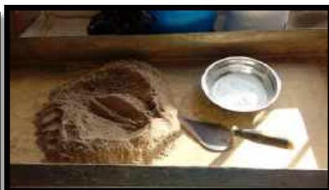
**Figura 50.** Se utilizaron 3 Bolsas de 3kg al cual se le adiciono 240gr de Ceniza de Concha de Lapicero pasada por el Tamiza N°100 por cada Bolsa (28/01/2020) – El mismo proceso se realiza para la C-2 y c-3
