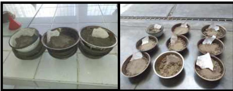
**Figura 34.** Procedí a sacar mis muestras del Horno y espere a que enfríen para poder pesarlas (22- 01 – 2020)
