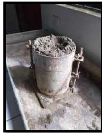
**Figura 40.** Procedemos a retirar el molde superior para enrazar y pesar el molde grande, esto se realiza por Bolsa y Por Cada Calicata (24 – 01 – 2020) – Para la C-1 Se utilizó 450 ml de H<sub>2</sub>O, Para la C-2 Se utilizó 440 ml de H<sub>2</sub>O, Para la C-3 Se utilizó 480 ml de H<sub>2</sub>O
