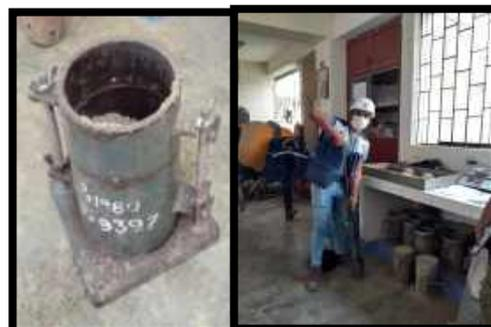
**Figura 54.** Una vez que se ha partido la mezcla en 5 partes se procede a vaciar parte por parte a un Molde de Compactación y se golpea por medio de un Pisón 25 veces - (28/01/2020) - El mismo proceso se realiza para la C-2 y c-3
