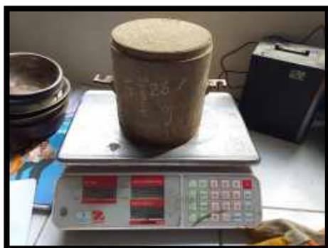
**Figura 41.** Nos encontramos pesando el (Molde + Muestra Húmeda compactada) por Bolsa y Por Cada Calicata (24 – 01 – 2020) – Para la C-1 Se utilizó 450 ml de H<sub>2</sub>O, Para la C-2 Se utilizó 480 ml de H<sub>2</sub>O, Para la C-3 Se utilizó 440 ml de H<sub>2</sub>O
