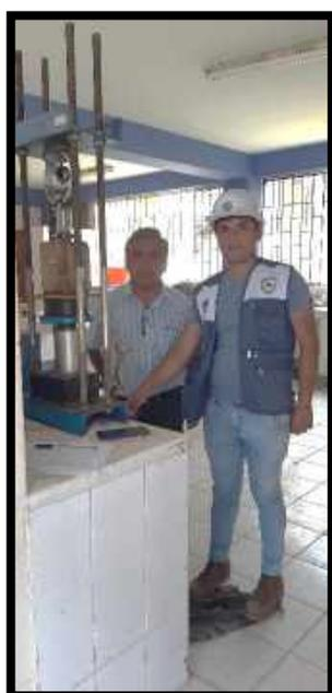
**Figura 47.** Continuando con el CBR procedí a hacer la penetración luego de haber sacado los moldes a orear aprox 30 min (28 - 01 - 2020) - en este día hice la penetración de mi C-1, C-2, C-3 (56, 25,12 GOLPES) en presencia del Ing. Rogelio Castañeda Gamboa.
