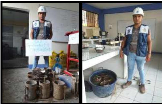
**Figura 95.** Se siguió con la colocación de los Moldes compactados en un Lavadero con agua y se separó por la compactación dada por un Martillo Pistón mediante 56 Golpes por parte para la 1° Bolsa, 25 Golpes por parte para la 2° Bolsa y 12 Golpes por parte para la 3° Bolsa este proceso duraría 4 días = 96h pero como mi material es arena me recomendaron que solo lo dejara 3 días = 72 horas, Este proceso se realizó para la (C1-C2-C3) (05/02/2020)
