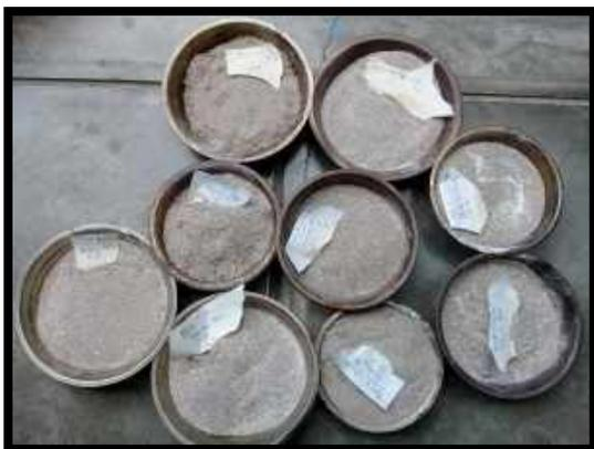
**Figura 60.** Por la Tarde Procedí a retirar mis muestras del Horno dejar enfriar y proceder a pesarlas (29/01/2020)
