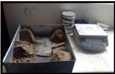
**Figura 66.** Una vez Mezclado la arena con la ceniza de concha de lapicero y procedemos a vaciar el agua, volvemos a mezclar y luego partimos la mezcla en 5 partes - (30/01/2020) - El mismo proceso se realiza para la C-2 y c-3
