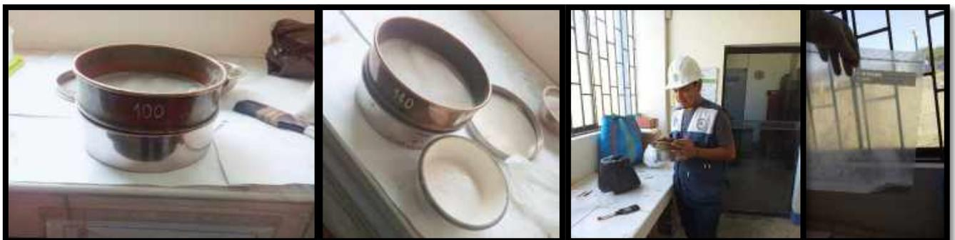
**Figura 7.** Obtenido el material en Polvo, procedemos a pasar por el tamiz N° 100, 140, 200 para llevar al Laboratorio de Materiales de la UNT para realizar el Ensayo ATD - (16/01/2020)
