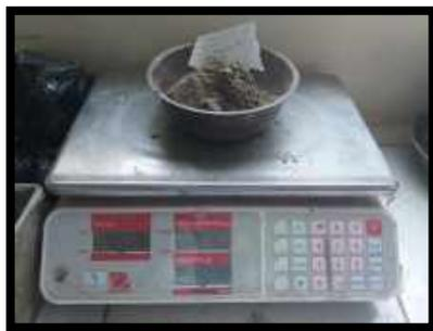
**Figura 57.** Tara + Muestra Húmeda extraída del molde de compactación - (28/01/2020) - El mismo proceso se realiza para la C-2 y c-3
