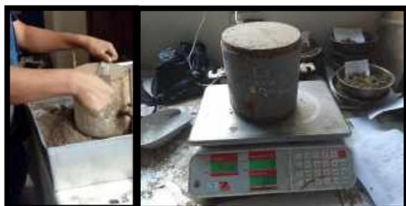
**Figura 93.** Nos encontramos pesando el (Molde + Muestra Húmeda compactada) por Bolsa y Por Cada Calicata, la Para la c-1 Se utilizó 570 ml, C-2 Se utilizó 600 ml de H2O, Para la C-3 Se utilizó 570 ml de H2O (05/02/2020)
