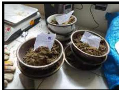
**Figura 42.** De cada molde obtuve muestras (Tara + Muestra Húmeda = 400gr) representativas para luego ser ingresadas al horno, por Bolsa y Por Cada Calicata (24 – 01 – 2020) – Para la C-1 Se utilizó 450 ml de H<sub>2</sub>O, Para la C-2 Se utilizó 480 ml de H<sub>2</sub>O, Para la C-3 Se utilizó 440 ml de H<sub>2</sub>O
