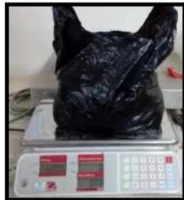
**Figura 20.** Una vez Tamizado por la N°04 procedemos a separar el material: 3 bolsas de 6kg para CBR - Por Cada Calicata (20 – 01 – 2020)
