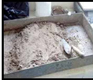
**Figura 64.** Me encuentro preparando mi Mezcla para realizar mi ensayo de Proctor Experimental a 13% de Concha de Lapicero (30/01/2020)
