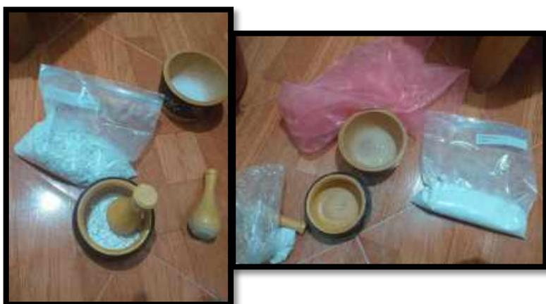
**Figura 61.** Por la Noche Procedí a Moler mi material calcinado pasándolo por la Tela Organza y luego llevarlo al Laboratorio a Tamizarlo (Malla N°200) para realizar el ensayo de FRX en la UNI en la Ciudad de Lima (29/01/2020)
