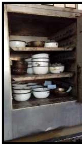
**Figura 79.** De cada molde obtuve muestras representativas para luego ser ingresadas al horno, por Bolsa y Por Cada Calicata - Este proceso se realizó para la (C1-C2-C3) (03/02/2020)
