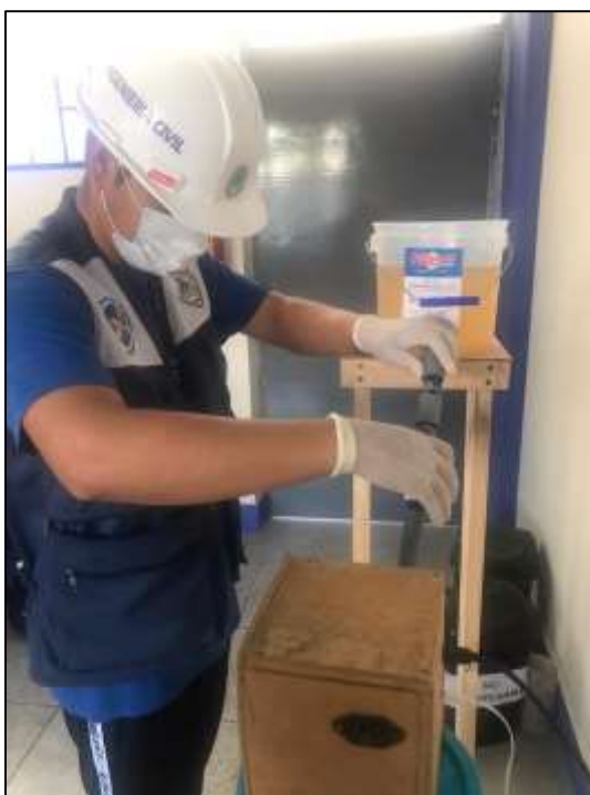
Figura 34. Muestra de agua contaminada en primer balde (captación).
