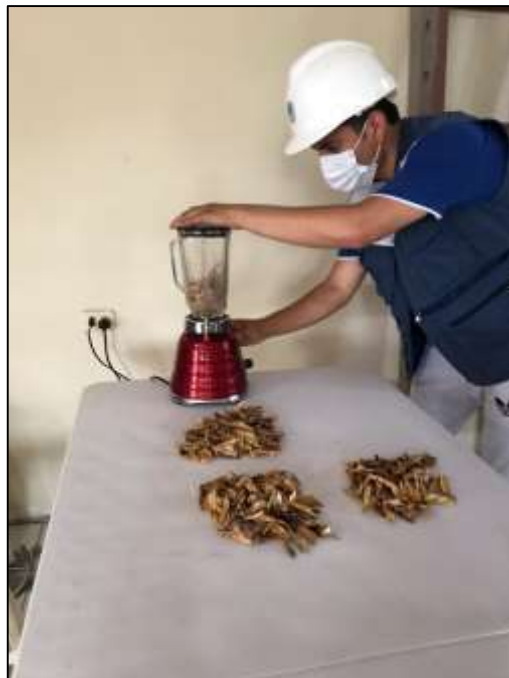
Figura 24. Triturado de muestra de vaina de arveja seca con ayuda de una licuadora, la cual fue desinfectada para evitar contaminación del material.
