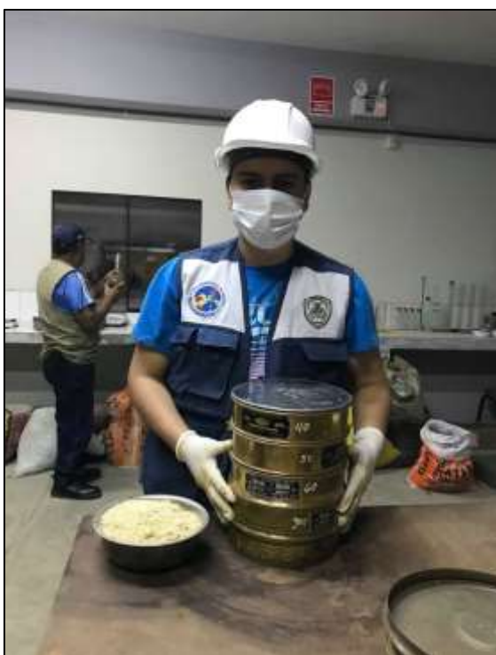
Figura 25. Tamizado de muestra de vaina de arveja seca y triturada (Mallas N°40, N°60 y N°200).
