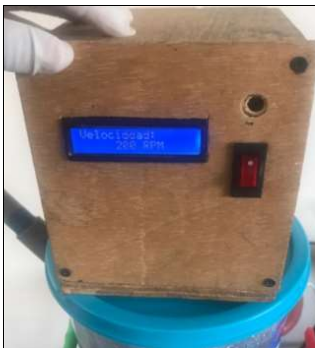
Figura 37. Velocidad de 200 rpm indicadas en la pantalla LED de la caja del motor.
