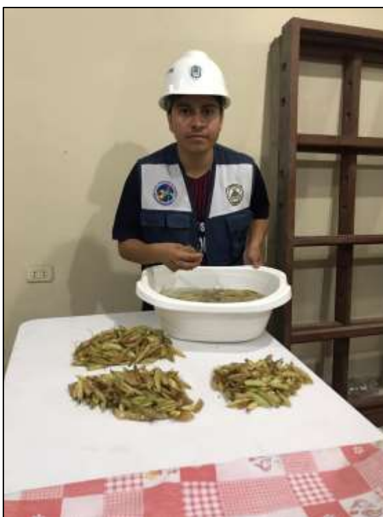
Figura 19. Cuarteo y limpieza con agua destilada de muestra de vaina de arveja.
