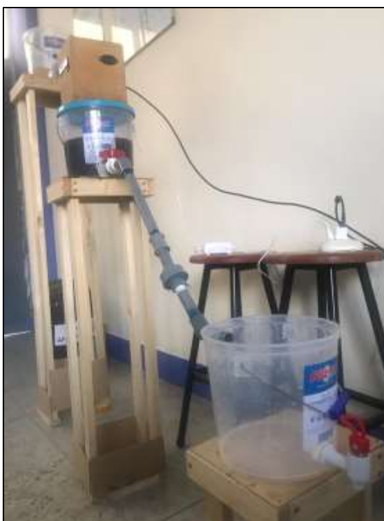
Figura 33. Biofiltro culminado, en pleno proceso de remoción.
