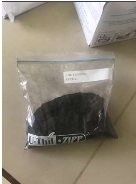
Figura 28. Muestra de ceniza de vaina de arveja, resultado de activación a temperatura de 800°C durante 1 hora con pérdida de 89% de material (peso inicial: 1000gr – peso final: 103gr).
