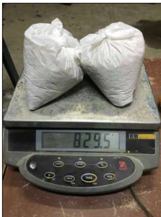
Figura 26. Pesado de muestra tamizada, luego se le sumó 170.5gr y se llegó a pesar 1Kg de muestra tamizada.
