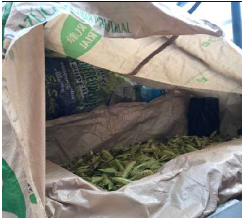
Figura 21. Acondicionamiento y esparcimiento de muestra para secado a temperatura ambiente (La muestra fue cubierta para evitar contaminación con sólidos o aguas de garuas, lluvias, etc.).
