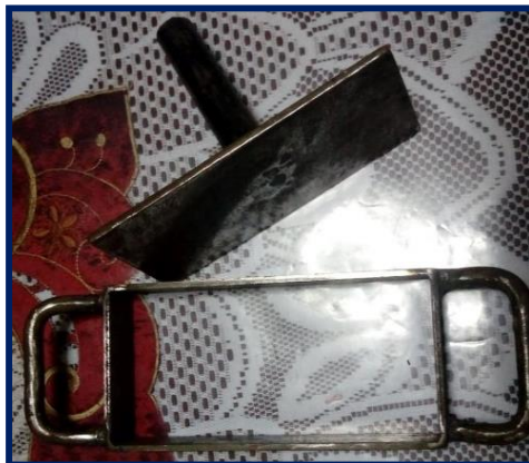
FIGURA N°09: MOLDE DE ACERO PARA UN ADOQUIN PEATONAL
