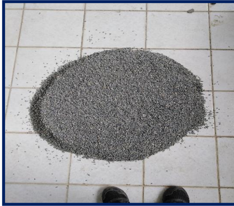
FIGURA N°13: REALIZACIÓN PARA EL CUARTEO DEL CONFITILLO
