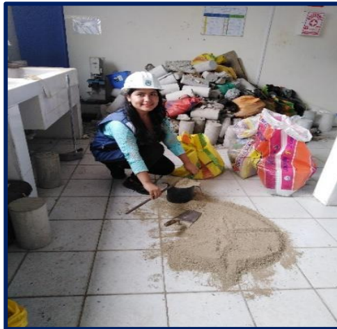
FIGURA N°47: ENRASADO DE LA ARENA GRUESA
