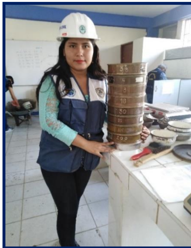
FIGURA N°15: TAMIZADO DEL AGREGADO GRUESO
