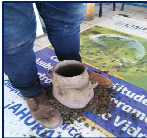
FIGURA N°50: COLOCACIÓN DEL MATERIAL AL CONO DE ABRAMS
