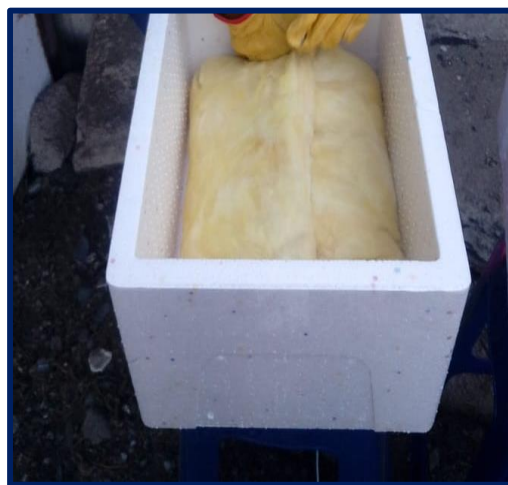
FIGURA N°65: ADOQUIN DE CONCRETO ENVUELTO CON EL MATERIAL TERMICO
