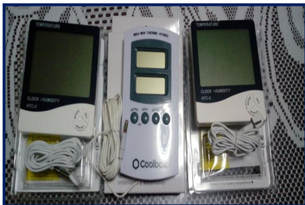
FIGURA N°06: TERMOHIDROMETRO CON SENSOR MEDIDOR DE TEMPERATURA Y HUMEDAD INTERIOR
