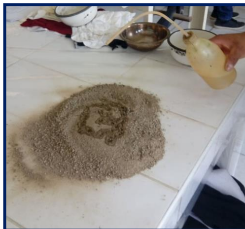
FIGURA N°27: ESPARCIMIENTO DEL AGREGADO FINO POR LA MALLA N°4
