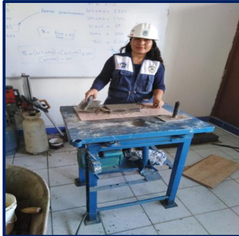
FIGURA N°55: COLOCACION DEL CONCRETO AL MOLDE
