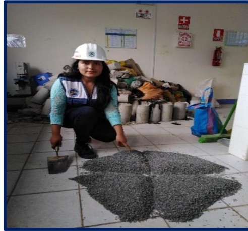
FIGURA N°37: COLOCACIÓN DEL MATERIAL POR 3 CAPAS.
