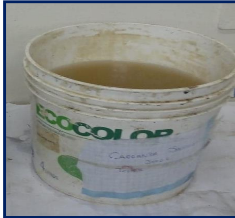
FIGURA N°25: AGREGAGO FINO SUMERGIDO EN AGUA
