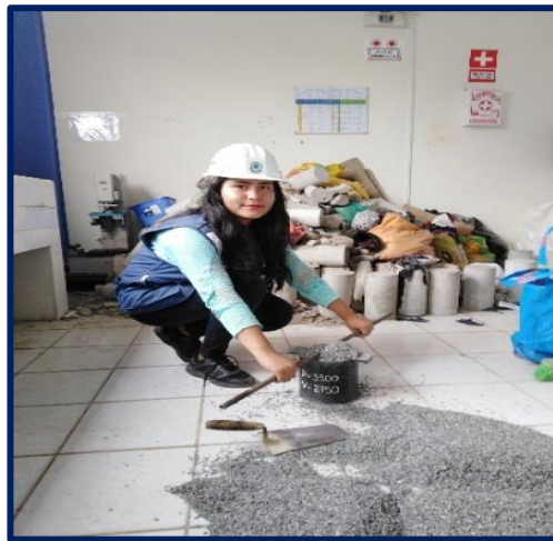
FIGURA N°35: ENRASADO DEL MATERIAL
