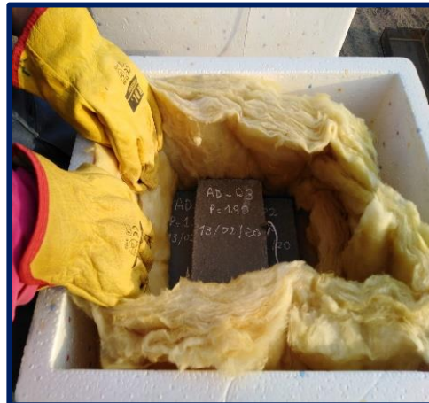
FIGURA N°61: MATERIAL TERMICO COLOCADA EN EL COOLER
