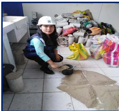
FIGURA N°45: COLOCACIÓN DEL MATERIAL DE AGREGADO FINO POR 3 CAPAS.
