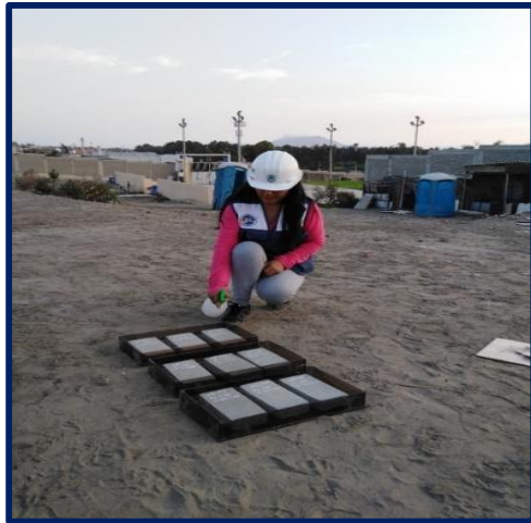
FIGURA N°73: APLICACIÓN DEL LIQUIDO CURADOR SIKACEM
