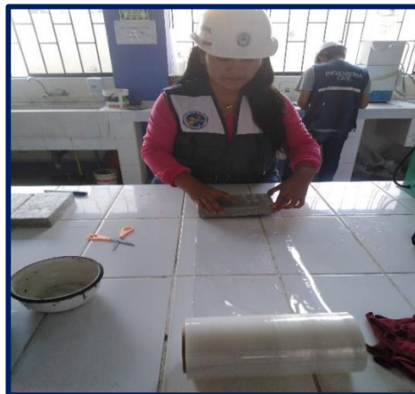
FIGURA N°67: ENVOLTURA DEL ADOQUIN CON LA PELICULA PLASTICA
