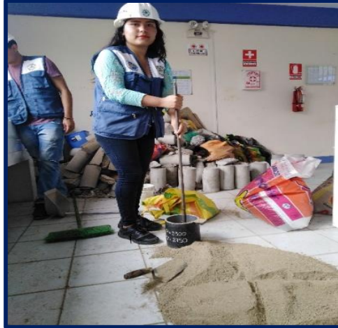
FIGURA N°46: COMPACTADO DE 25 GOLPES POR CAPAS
