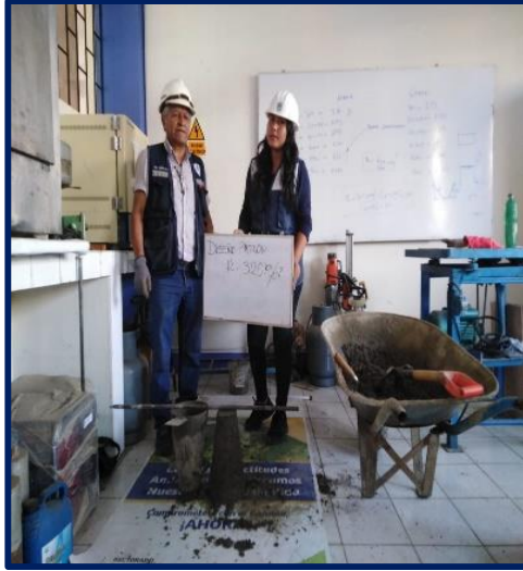
FIGURA N°52: VERIFICACIÓN DEL CONCRETO PARA EL CONO DE ABRAHAMAS
