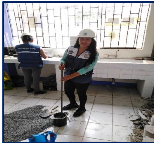
FIGURA N°38: CHUSEADO DE 25 GOLPES POR CAPAS
