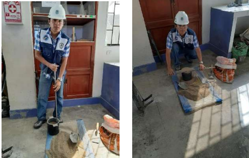
Figura N° 23. Peso unitario compactado del agregado fino
