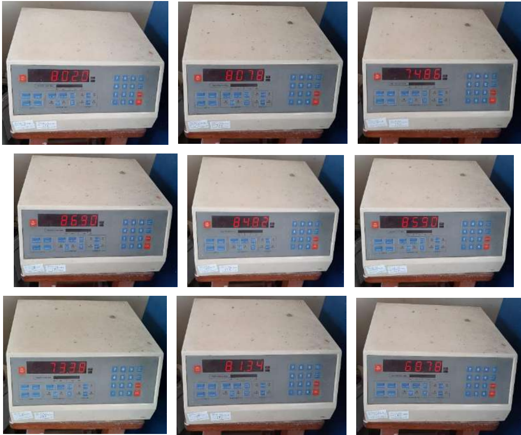
Figura N° 37. Lecturas de carga en kilonewton (kN) para mortero patrón, experimental al 10% y experimental al 15% a los 28 días de curado
