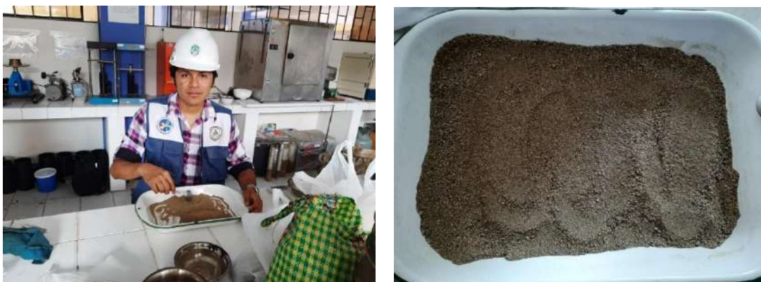
Figura N° 16. Homogenización de arena gradada
