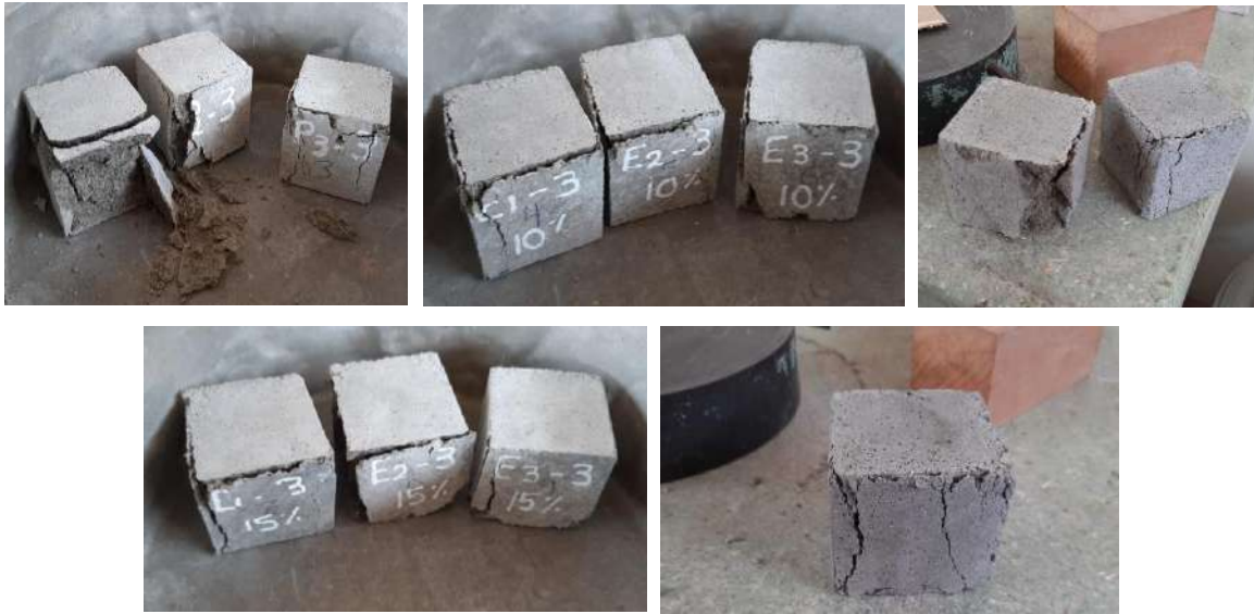
Figura N° 35. Modos de falla en mortero patrón, experimental al 10% y experimental al 15% a los 3 días de curado
