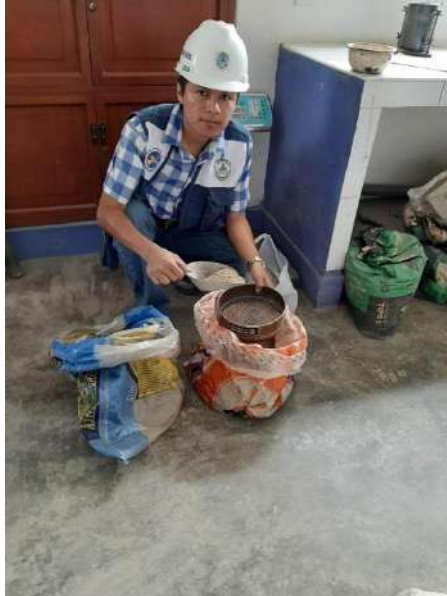
Figura N° 19. Tamizado de arena natural por la malla # 4 para el ensayo de agregado fino
