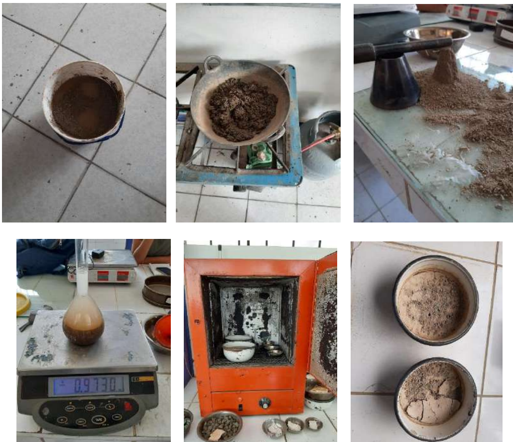
Figura N° 24. Gravedad específica y absorción del agregado fino
