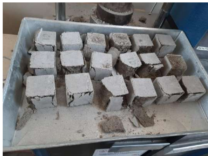
Figura N° 38. Modos de falla en mortero patrón, experimental al 10% y experimental al 15% a los 7 y 28 días de curado
