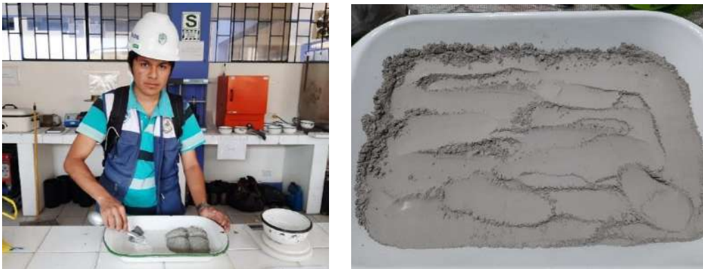
Figura N° 26. Homogenización de cemento + polvo de concha de abanico + ceniza de cola de caballo
