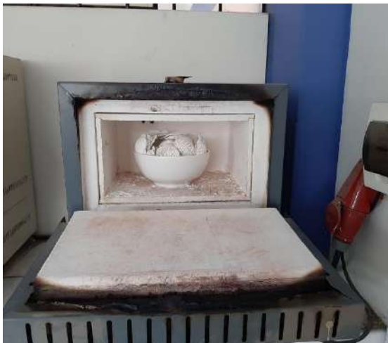
Figura N° 08. Calcinación de la concha de abanico
