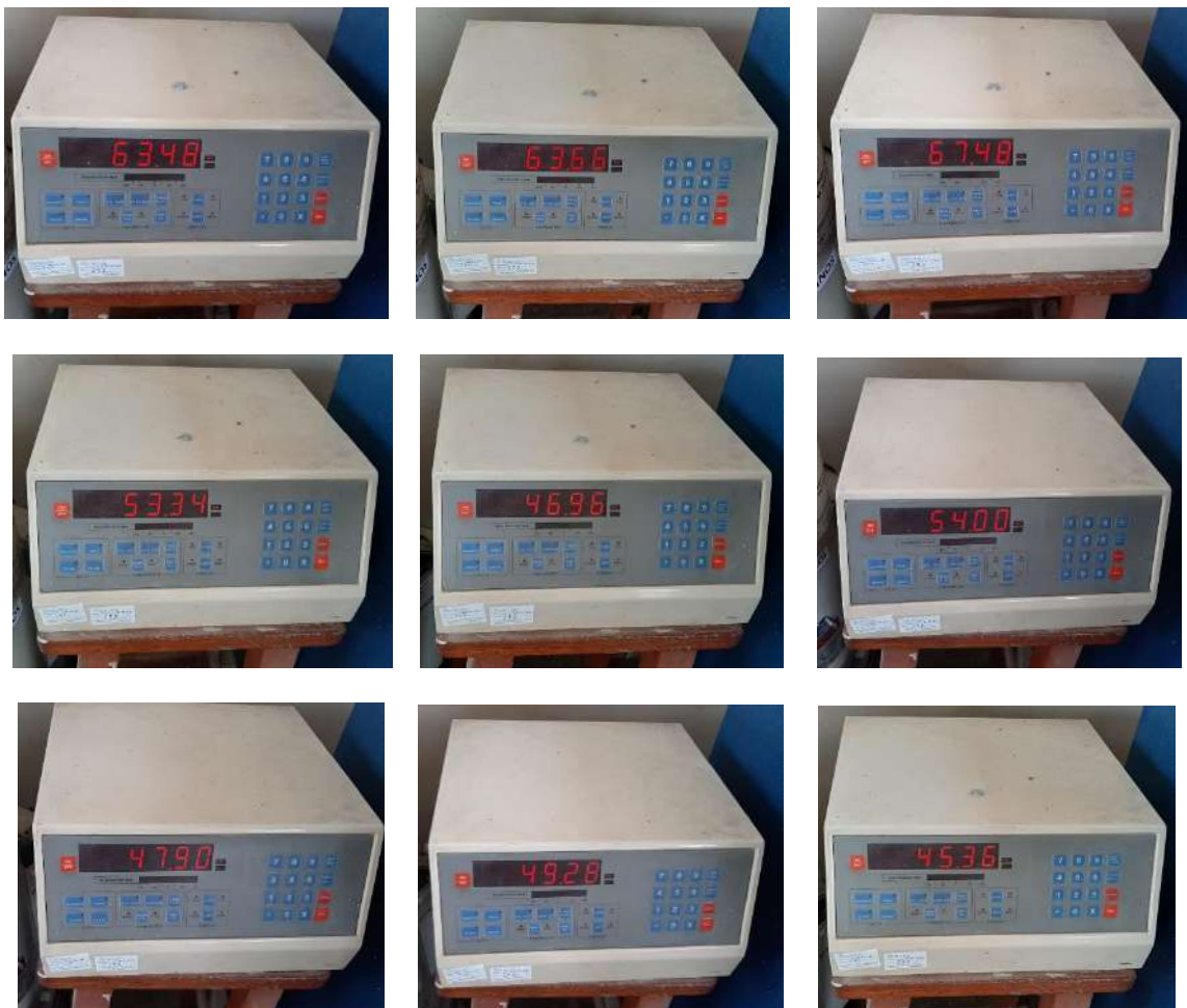
Figura N° 34. Lecturas de carga en kilonewton (kN) para mortero patrón, experimental al 10% y experimental al 15% a los 3 días de curado
