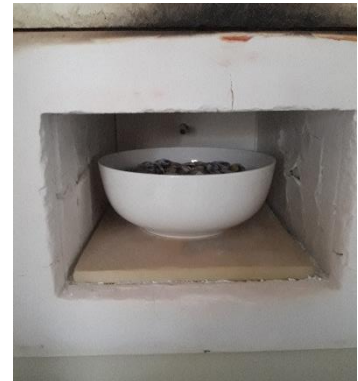
FIGURA 7: Calcinación a 800°C de la Marucha
