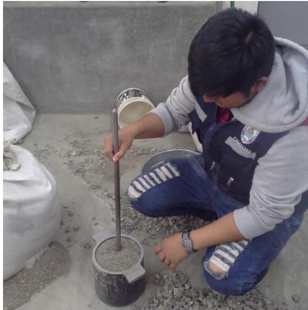
Imagen 8: chucear tres capas, erasando y tomando el peso de la arena fina
