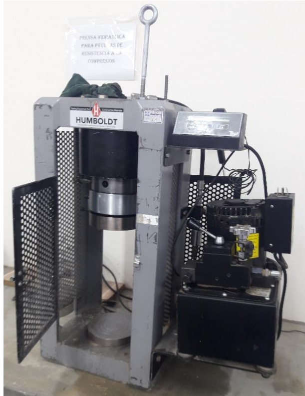
Imagen 12: prensa hidráulica para pruebas de resistencia a la compresión
