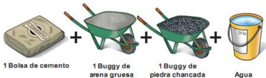
Figura 1. Concreto: cemento Portland + agregados + aire + agua, "Diseño de mezcla" - 2000
