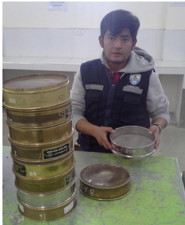
Imagen 11: se realiza la granulometría escogiendo los pesos retenidos en cada malla
