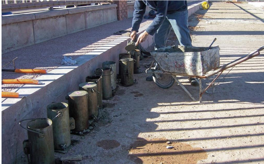
Figura 6. Ensayos para determinar la compresión del concreto – “Diseño de mezcla” - 2000
