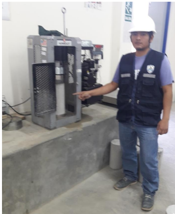
Imagen 13: realizando las pruebas de compresión de cada probeta desencofrada
