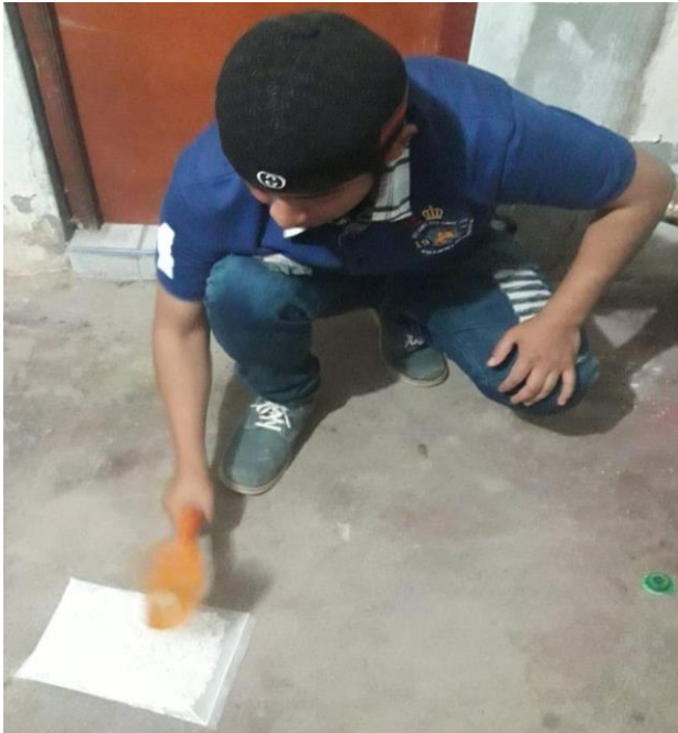
Imagen 7: pulverización de la concha de abanico
