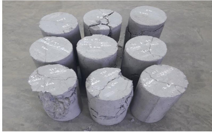
Imagen 14: resultado de probetas de los primeros 7 días
