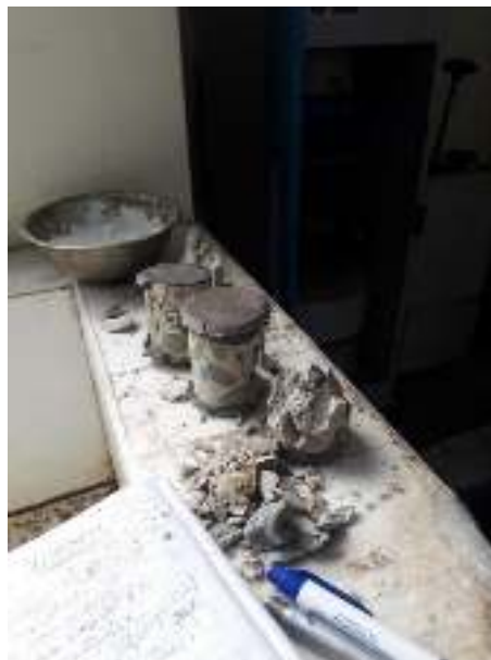
Ruptura de las muestras de concreto extraídas
