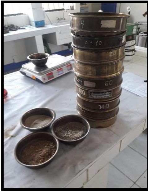
Figura N°32: Colocación de tamices – Ensayo de granulometría
