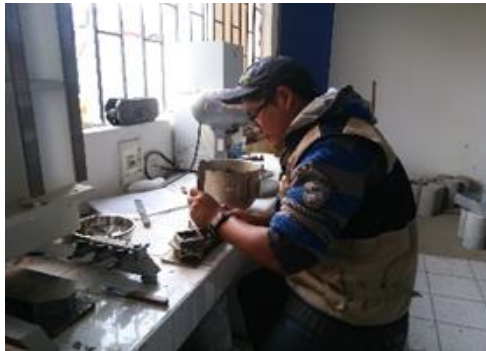
Figura 46. Se procedió a vaciar el mortero y con el apisonador de madera se compactó 64 veces que se hizo en 2 partes cada una con 32 golpes en sentido horizontal y vertical alternando uno luego de otro.
