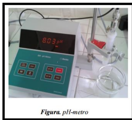
Figura 20. Electrométrico de Potenciométrico en el que se emplea un pH-metro.
