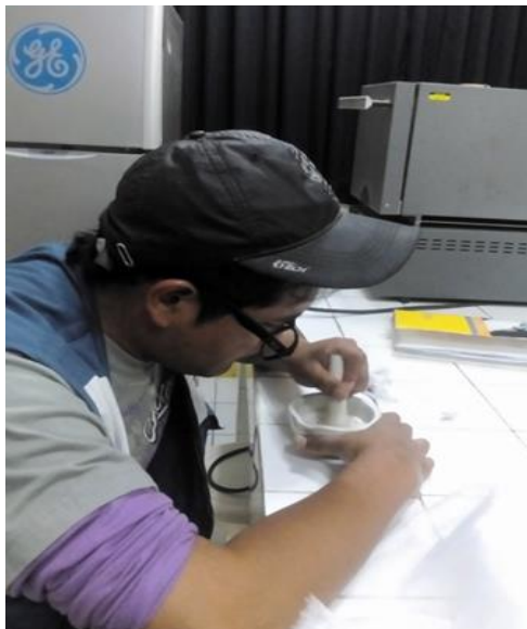
Figura 36. Recoger el material calcinado en la mufla se procedió a pesar y a moler la concha de coquina. Fecha (29/05/2017)
