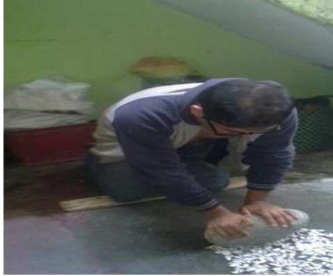
Figura 30. Se empezó a moler la concha de coquina con un batan para reducir a trozos muy pequeños hasta volverlo polvo y asimismo incrementar su área efectiva. Fecha (18/05/2017)
