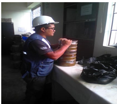
Figura 39. Se tuvo que pasar por las mayas n° 4, n° 8, n° 16, n° 30, n° 50, n° 100 hasta la n° 200 como indica la norma (NTP.399.607) que fue llevado a cabo en el laboratorio de mecánica de suelos de la (USP). Fecha (05/11/2018)
