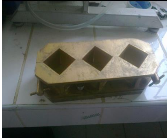
Figura 43. Se encinto los 3 moldes y se procedió a ármalos hasta que ya estaban listas para el vaciado del mortero.
