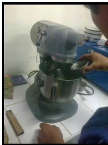
Figura 27. ASTM C 305, (1999). Mezcla mecánica de pastas de cemento y mortero de consistencia plástica
