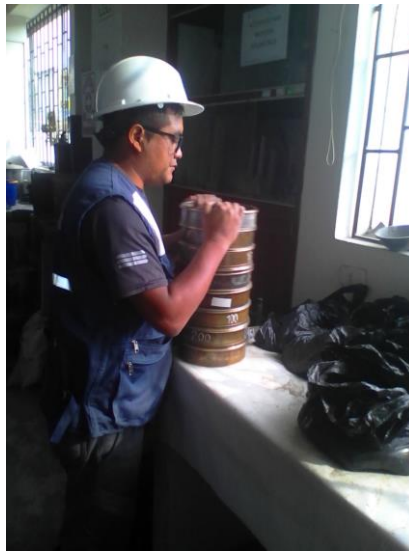
Figura 15. Procedimiento de gradación del agregado fino o arena, entre malla N° 4” y el tamiz N°200(74um) según (NTP 399.607, 2013).
