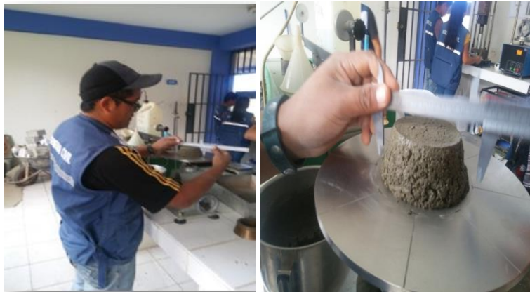
Figura 42. Se realizó el siguiente ensayo para determinar la fluidez del mortero de Patrón como de los experimentales.
