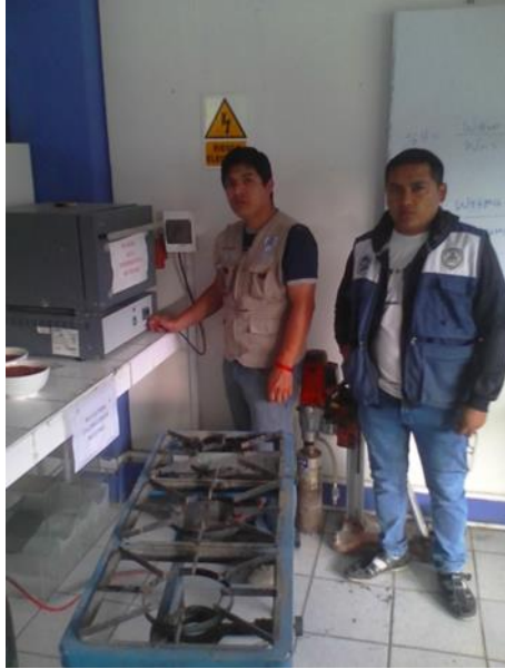
Figura 35. Se llevó a calcinar la muestra de concha de coquina y se pesó la cantidad de 361.17 y se llevó a la mufla eléctrica a calcinarse a 800 °C durante 4 horas en el Laboratorio de química de la universidad san pedro. Fecha (28/05/2017)
