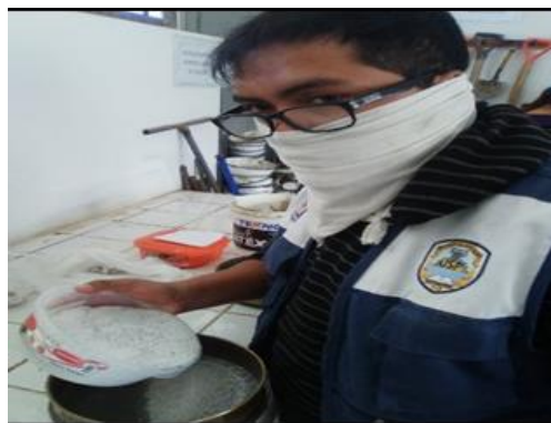
Figura 31. Recogiendo el material concha de coquina en un recipiente para llevarlo al lavotatorio de mecanica de suelos de la universidad san pedro y pasarlo en la malla nº 200. Fecha (18/05/2017)
