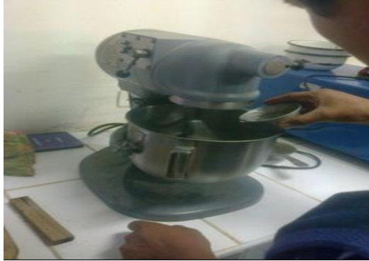
Figura 45. Se procedió a mezclar los agregados, durante 4 min.
