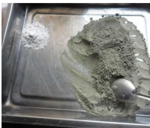
Figura 40. Se mezclan el polvo concha de coquina con el cemento hasta homogenizar todo el material para el 5% 10% y 15% de sustitución.
