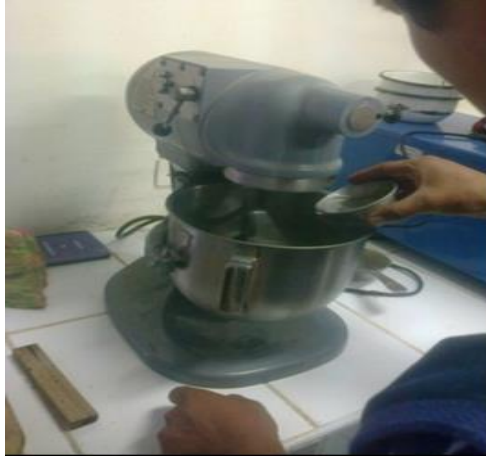
Figura 41. Se observa el proceso de elaboración de la mezcla del mortero.
