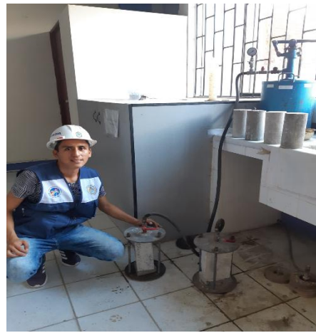
FIGURA N°42 Ensayo de permeabilidad de ladrillo experimental al 10% con el equipo Permeámetro.
