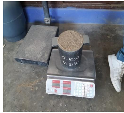
FIGURA N°19: Prueba con el Peso unitario del Agregado Fino
