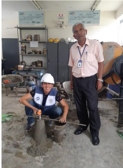
FIGURA N°28: Verificación del Asentamiento A mano salió slump 0.5”.
