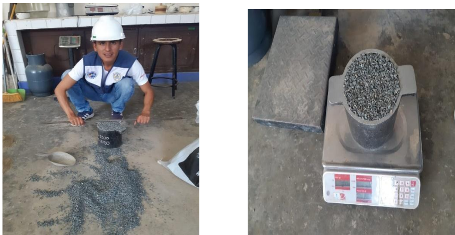
FIGURA N°18: Prueba con el Peso unitario del Agregado Grueso
