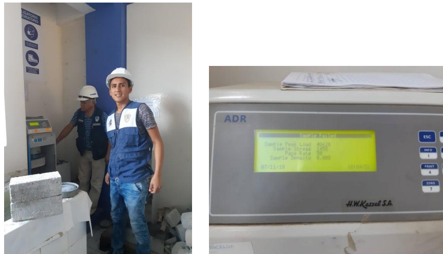
FIGURA N°32: Prueba con la resistencia a la compresión a los 7 días de curado.
