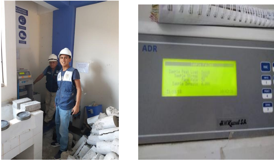
FIGURA N°32: Prueba con la resistencia a la compresión a los 7 días de curado.
