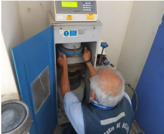
FIGURA N°45: Prueba de resistencia a la compresión a los 7 días de curado de los ladrillos experimentales al 20 %.
