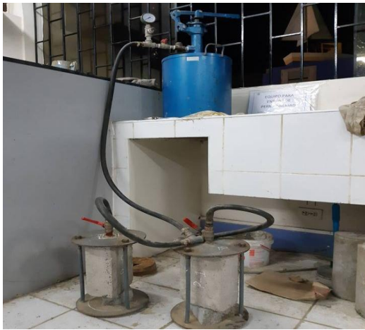
FIGURA N°42 Ensayo de permeabilidad de ladrillo experimental al 10% con el equipo Permeámetro.
