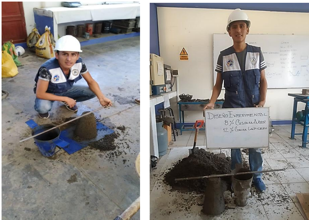
FIGURA N°43: Ensayo de asentamiento para concreto experimental al 20% obteniendo un slump de 0”.
