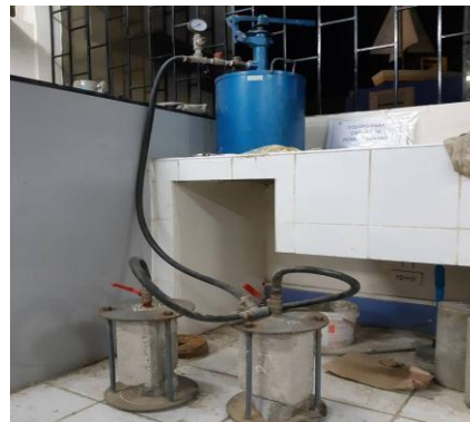
FIGURA N°35: Ensayo de Permeabilidad de Ladrillo Patrón con el Equipo Permeámetro
