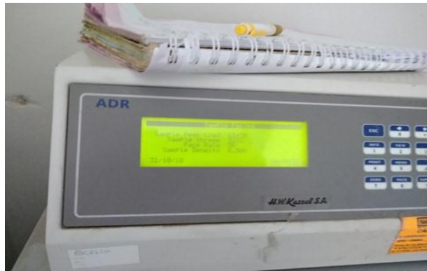
FIGURA N°46: Prueba de resistencia a la compresión a los 14 días de curado de los ladrillos Experimentales 20 %.
