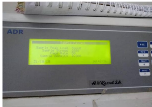
FIGURA N°39: Prueba de resistencia a la compresión a los 7 días de curado de los ladrillos experimentales al 10 %.
