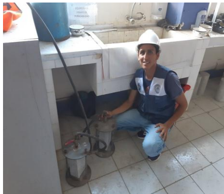
FIGURA N°35: Ensayo de Permeabilidad de Ladrillo Patrón con el Equipo Permeámetro
