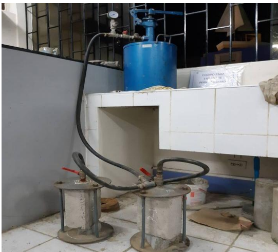
FIGURA N°48: Ensayo de permeabilidad de ladrillo experimental al 20% con el equipo Permeámetro.
