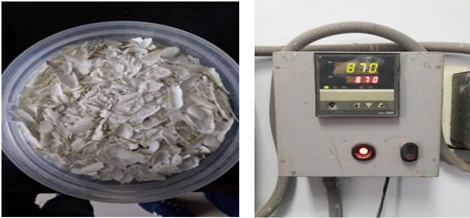
FIGURA N°16: Proceso de calcinación de las conchas de lapicero.
