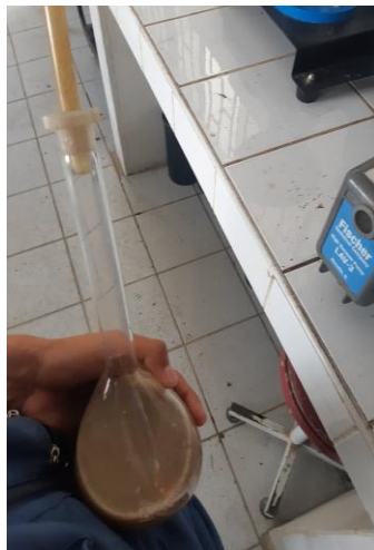
FIGURA N°26: Prueba de Peso Específico y Absorción del Agregado Fino
