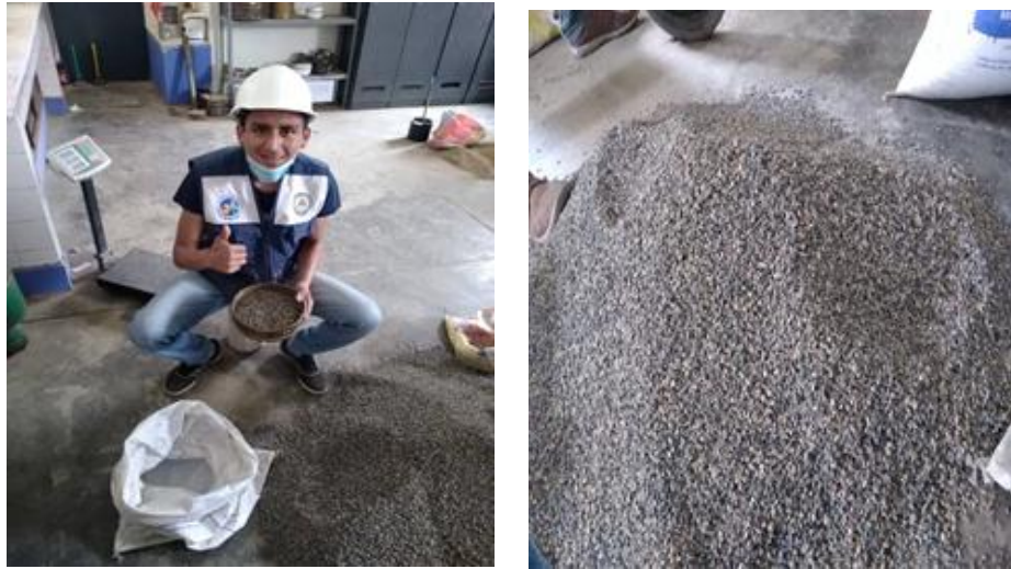
FIGURA N°17: Gradación de los agregados por el tamiz # 16 para el agregado grueso.
