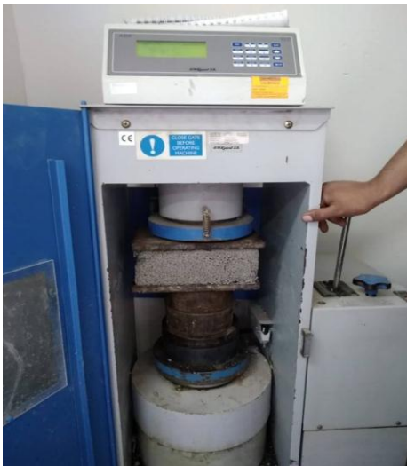
FIGURA N°40: Prueba de resistencia a la compresión a los 14 días de curado de los ladrillos Experimentales 10 %.
