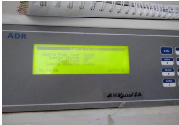
FIGURA N°41: Prueba de resistencia a la compresión a los 28 días de curado de los ladrillos experimentales al 10%.
