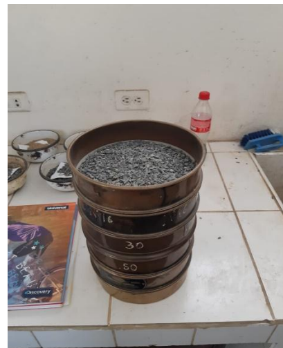
FIGURA N°20: Prueba de Granulometría de los agregados
