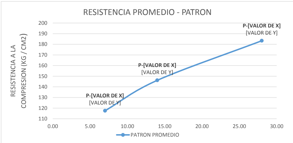
Grafico 1. Ensayo sobre la Resistencia respecto a la Compresión Patrón Promedio a los 7, 14, 28 días de curado.
