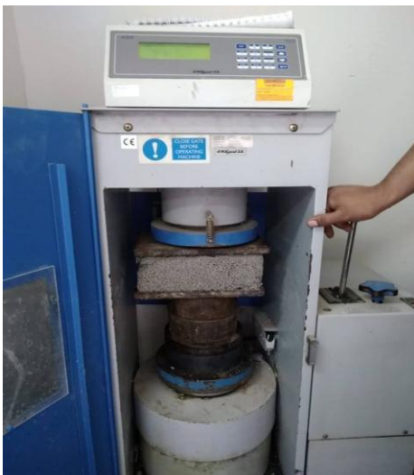
FIGURA N°46: Prueba de resistencia a la compresión a los 14 días de curado de los ladrillos Experimentales 20 %.
