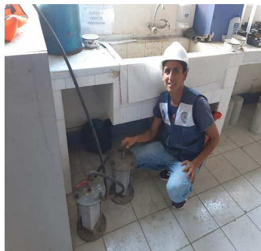
FIGURA N°48: Ensayo de permeabilidad de ladrillo experimental al 20% con el equipo Permeámetro.
