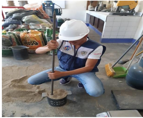
FIGURA N°19: Prueba con el Peso unitario del Agregado Fino
