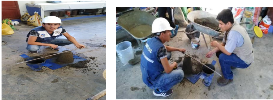
FIGURA N°37: Ensayo de asentamiento para concreto experimental al 10% obteniendo un slump de 0”.
