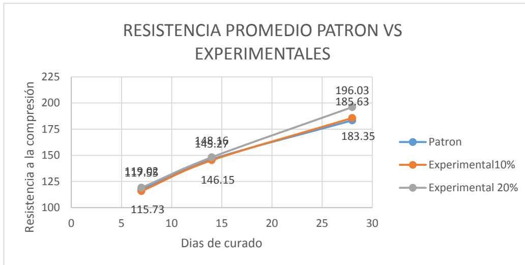
Grafico 6: Ensayo sobre la Resistencia respecto a la Compresión Promedio Patrón vs Experimental a los 7, 14 días Y 28 días de curado.
