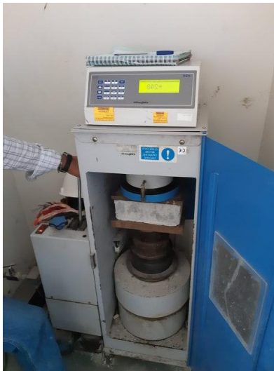
FIGURA N°39: Prueba de resistencia a la compresión a los 7 días de curado de los ladrillos experimentales al 10 %.
