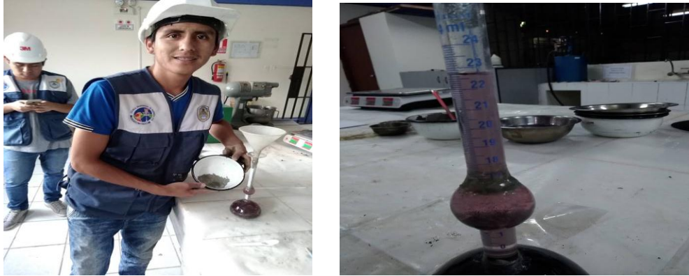
FIGURA N°36: Ensayo de Peso Específico del Cemento Hidráulico.
