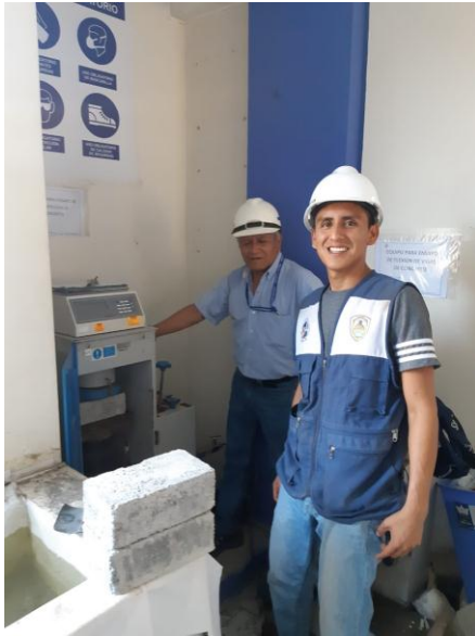
FIGURA N°47: Prueba de resistencia a la compresión a los 28 días de curado de los ladrillos experimentales al 20 %.
