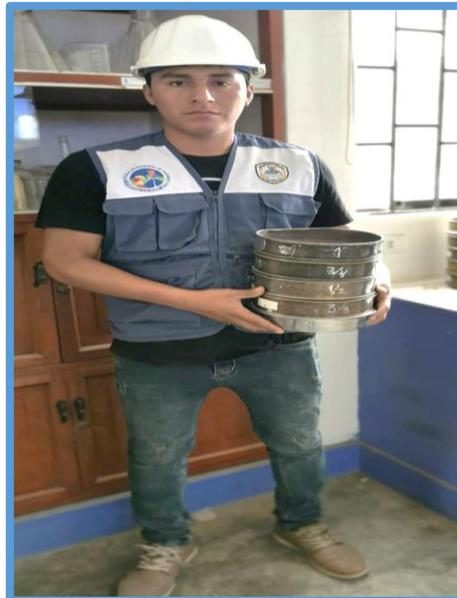
*Figura 33.* Del Cuarteo Realizado se Toma una Muestra de Piedra y se pasa a Realizar la Granulometría, Tomando los Pesos Retenidos en Cada Malla
