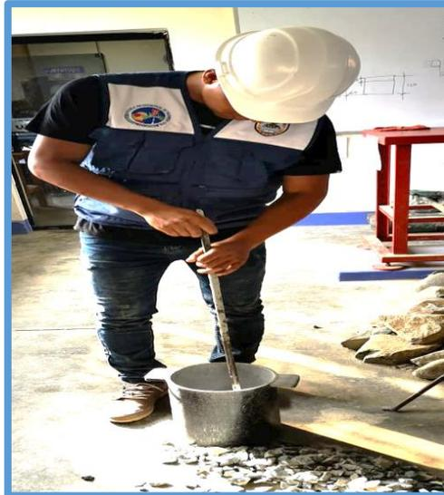
*Figura 30.* La piedra se deja caer a una altura determinada compactando así como chuceando en tres iguales capas, enrasando y pesando la muestra
