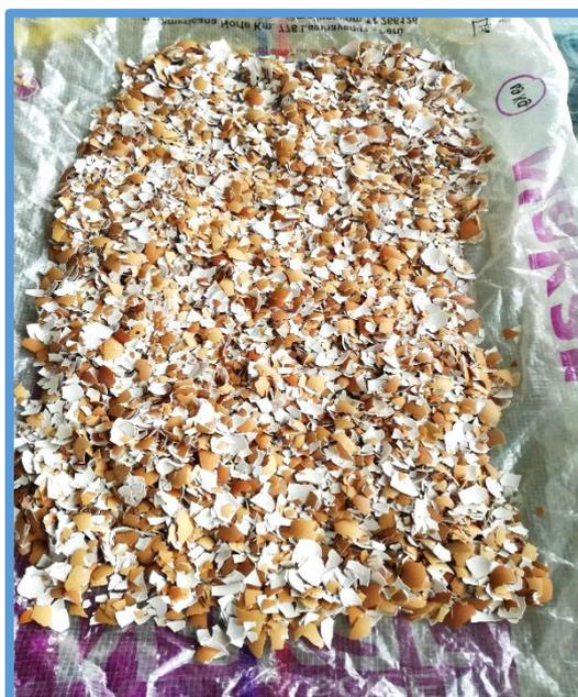
*Figura 19.* Cascara de Huevo Limpias y Secadas a Cielo Abierto
