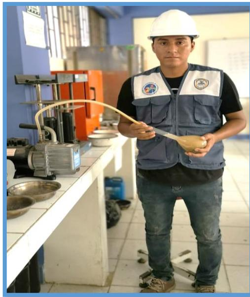
**Figura 27.** Secado de la Arena y a continuación los Ensayos con la Fiola y se toma su peso
