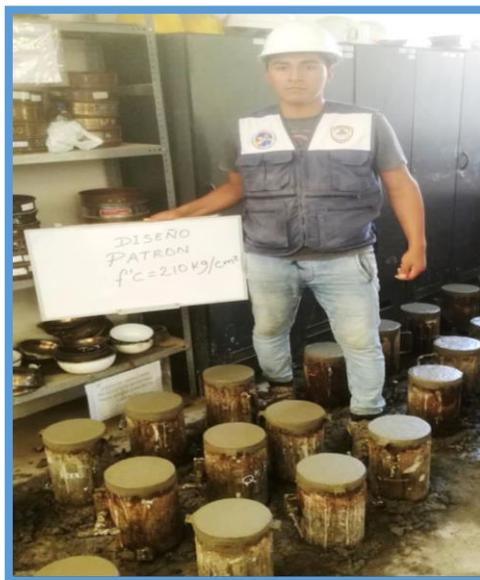
*Figura 35.* Llenado de las Probetas Patrón
