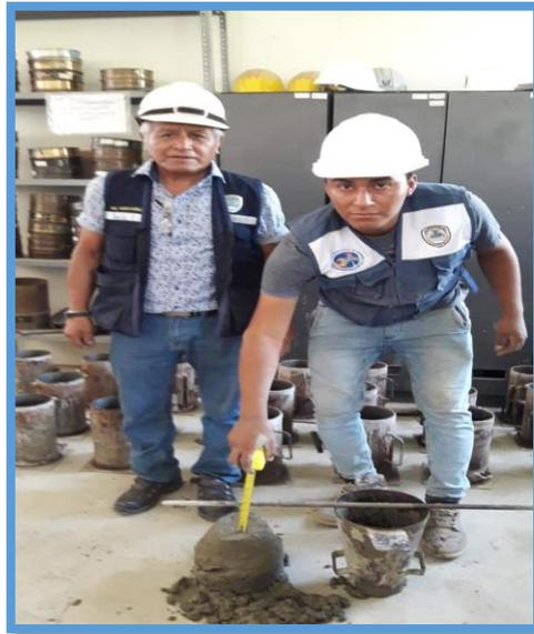
*Figura 34.* Elaboración del Slump para la Mezcla Patrón
