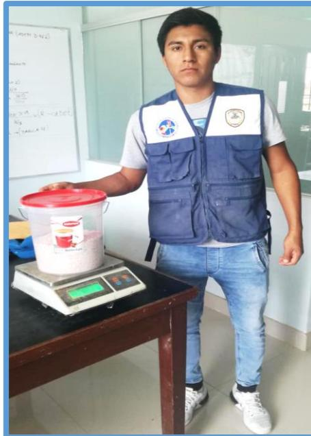
**Figura 21.** Muestra de Cascara de Huevo Pesada y Puesta a Calcinar
