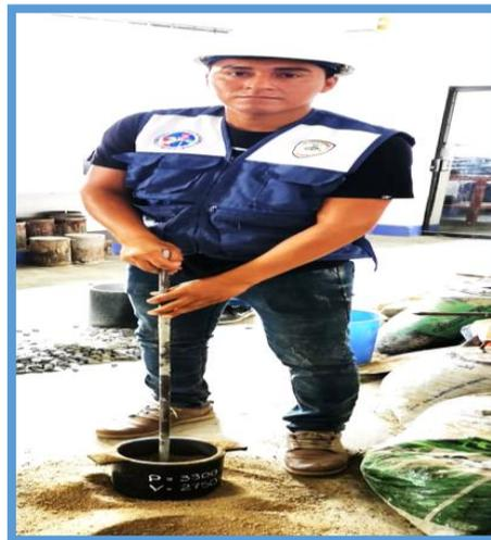
*Figura 23.* La Arena a cierta altura ha de caer en tres capas iguales compactando y chuceando, enrasando y pesando la muestra
