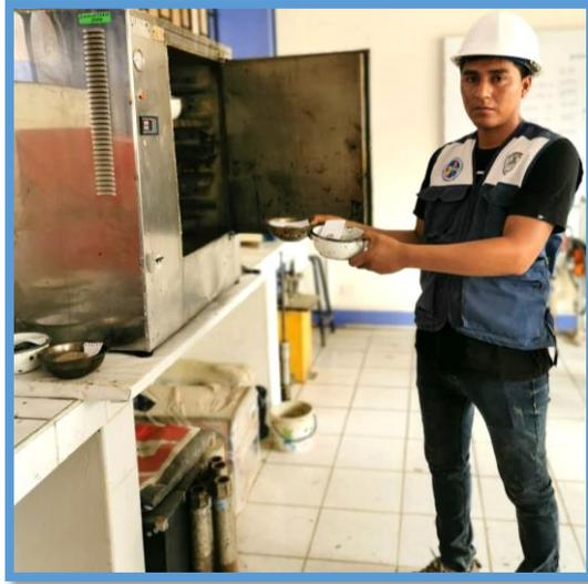
*Figura 24.* Se realiza el debido cuarteo del pesado material y luego se toman las muestras con el fin de ser conducidos al horno
