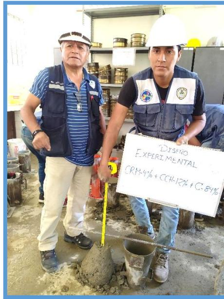
*Figura 40.* Elaboración del Slump para la Mezcla Experimental 16%
