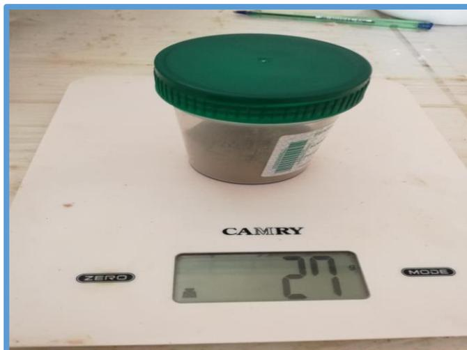
*Figura 15.* Muestra de Rastrojo de Maíz Pesado y Enviada a Realizar Ensayo de ATD
