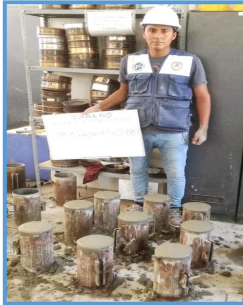
*Figura 38.* Llenado de las Probetas Experimentales 12%
