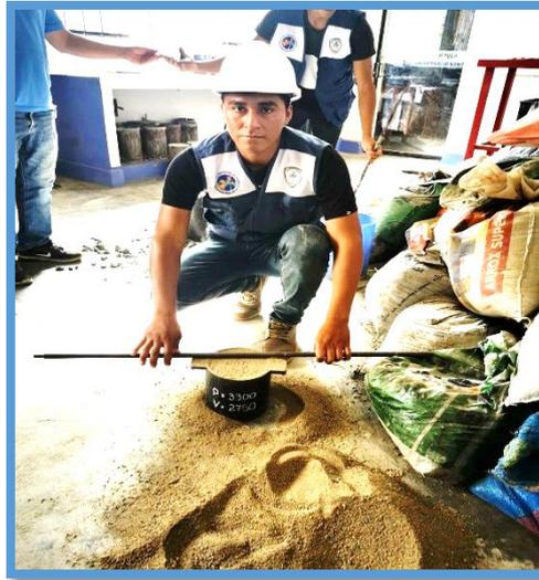
*Figura 22.* La Arena a cierta altura ha de caer sin compactar, enrasando así como pesando la muestra
