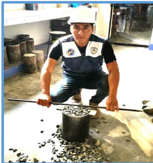
*Figura 29.* A cierta altura sin compactar la piedra se deja caer enrasando y pesando la muestra
