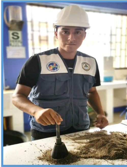
**Figura 26.** Se realiza la prueba de Consistencia de la Arena
