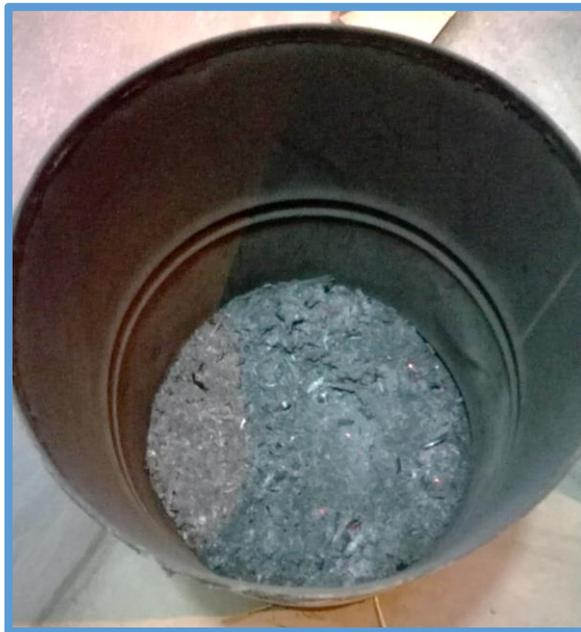
**Figura 17.** Rastrojo de Maíz al Término del Pre-Quemado
