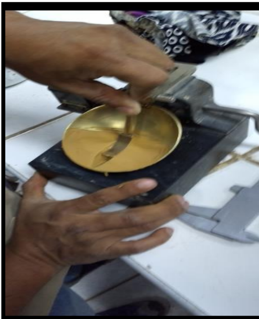
Figura 13: Se pasa el acanalador por el centro
