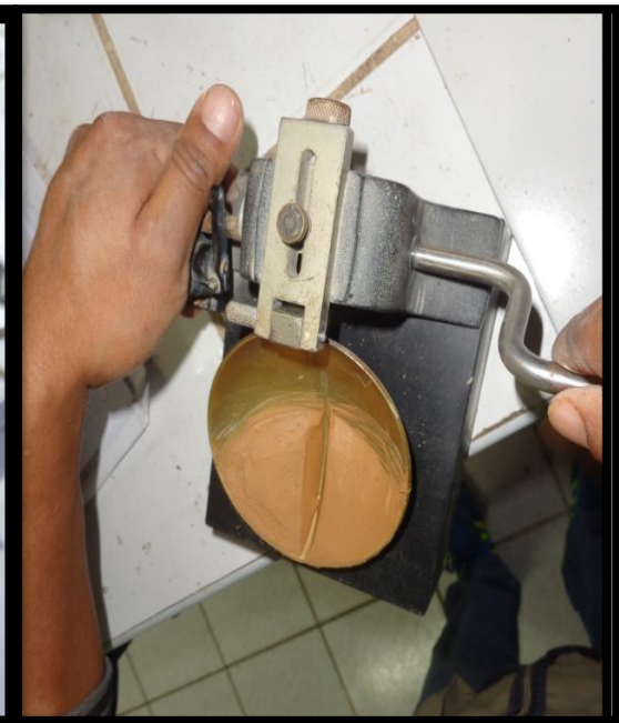
Figura 14: Se suministra los golpes hasta cerrar la ranura
