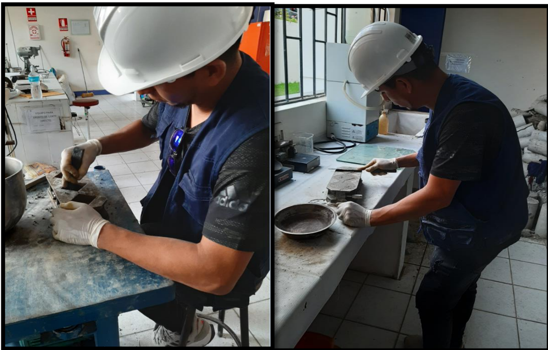
Figura 28: Se apisonó con 32 golpes y se alisó de la superficie con la ayuda de una espátula
