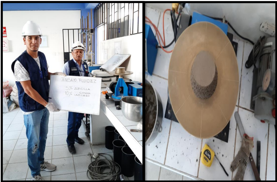
Figura 24: Ensayo de fluidez en el fluidímetro electrónico
