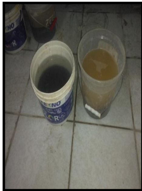
Figura 18. Agregados sumergidos en agua para el ensayo de absorción.
