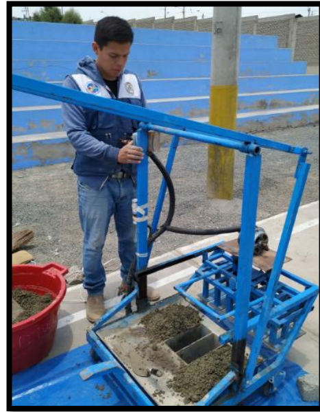
Figura 40. Una vez colocada la mezcla en la maquina se procede a hacer la primera vibración para uniformizar la mezcla.
