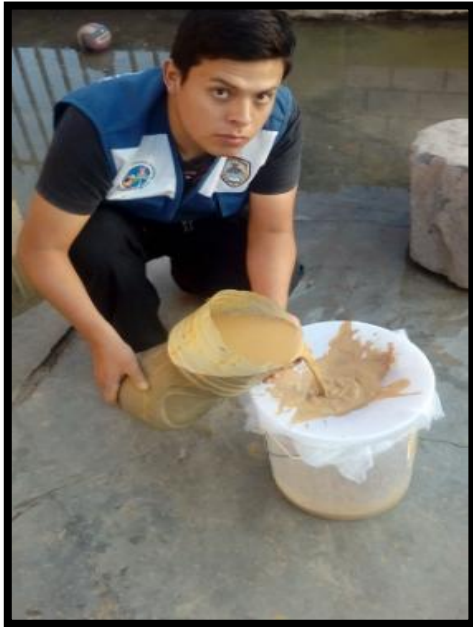
Figura 23. Pasamos la arcilla disuelta a un recipiente por la organza y dejarla reposar por 2 días.
