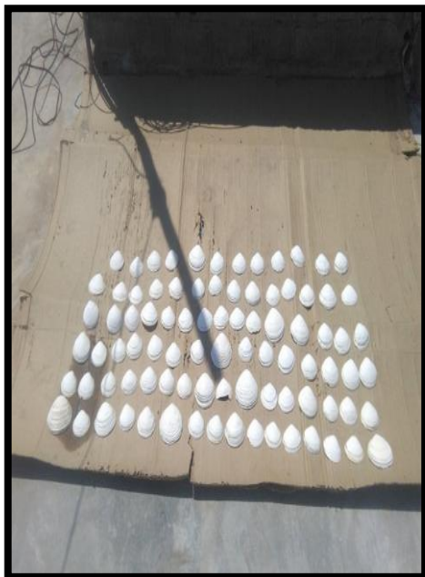
Figura 29. Luego de ser lavada la dejamos secando al sol por 2 horas cada uno de las caras de la concha de Almeja.
