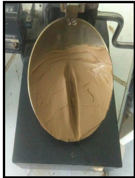
Figura 26. Después tamizar la arcilla la humedecemos y con ayuda de la cuchara Casa Grande recolectamos los datos para hallar el límite líquido.
