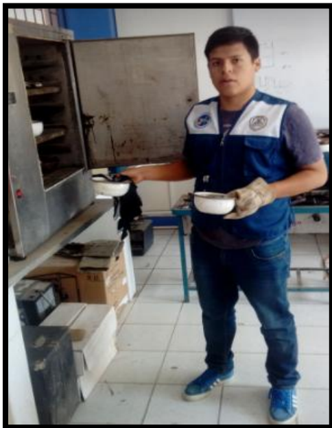
Figura 17. Ensayo de contenido humedad de los agregados.
