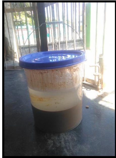
Figura 24. Después de reposar por dos días se aprecia la separación del agua de la arcilla.
