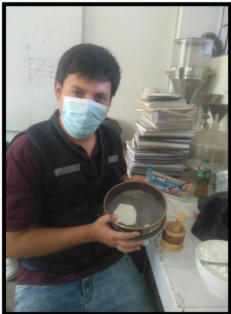
Figura 33. Tamizaje de concha de almeja calcinada por la malla n°200.
