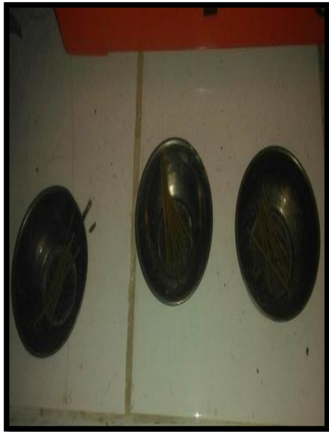
Figura 27. Haciendo una especie de palitos con la arcilla semi-húmeda se busca hallar el Límite Plástico.
