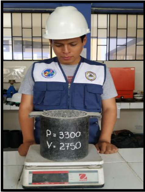
Figura 15. Peso unitario del agregado grueso (confitillo).
