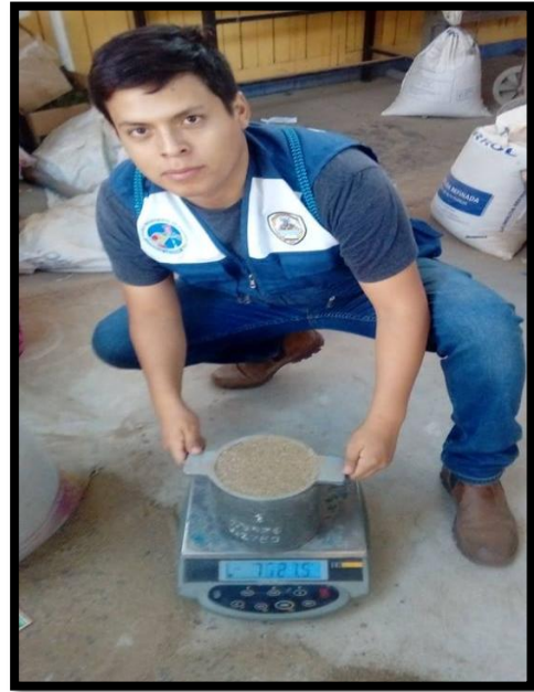
Figura 16. Peso unitario del agregado fino (arena).
