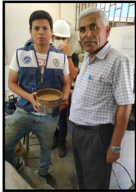
Figura 32. Tamizaje de arcilla calcinada por malla n° 200, Ing. Milquisider Urrutia verificando el correcto procedimiento.
