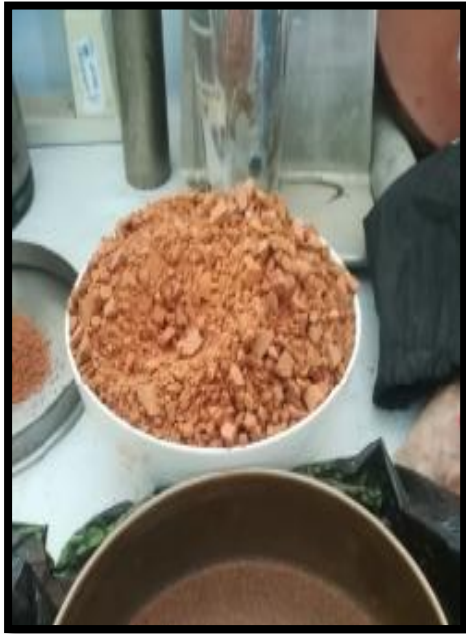
Figura 31. Arcilla calcinada por 550°C por 1 hora y 30 minutos.
