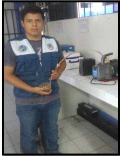
Figura 20. Ensayo de gravedad específica del agregado fino con pícmetro.
