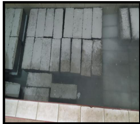
Figura 46. Curado sumergido en agua de ladrillos de concreto experimental N°02.
