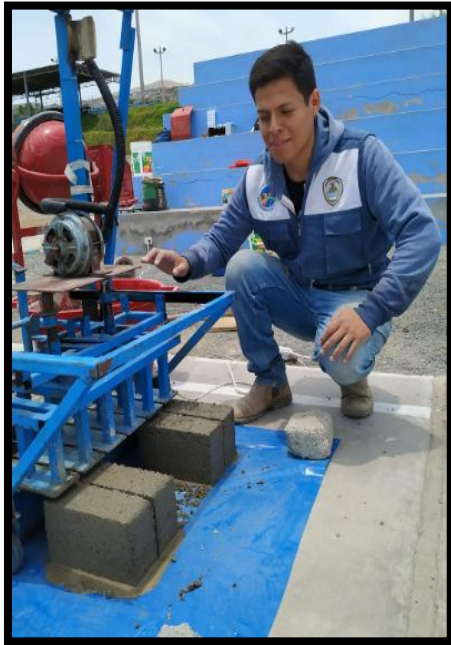
Figura 43. Los ladrillos de concreto desmoldados.
