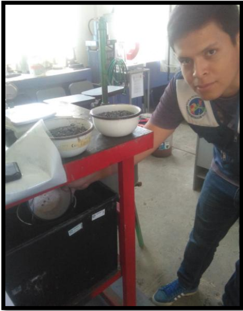
Figura 19. Ensayo de gravedad específica del agregado grueso.
