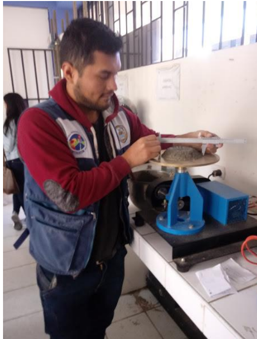
Figura 37. Medición del diámetro de mortero para ver si es óptimo
