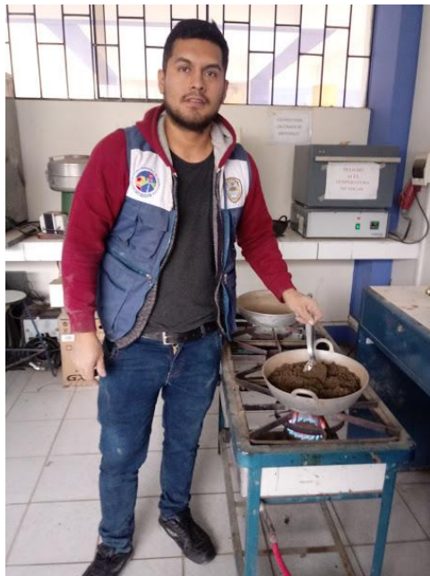
Figura 34. Ensayo de contenido de humedad del agregado
