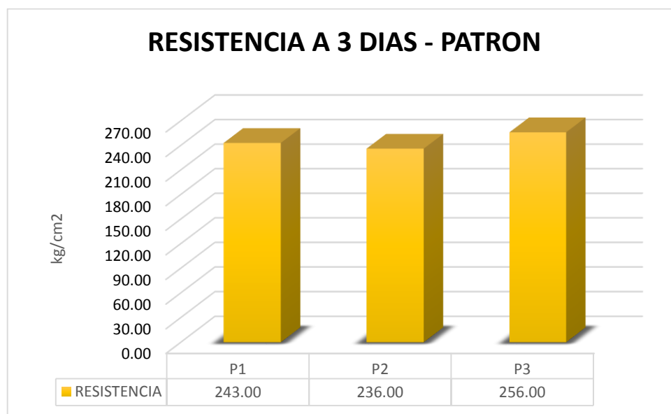
Figura 13. Ensayo de Resistencia a la Compresión Patrón a los 3 días
