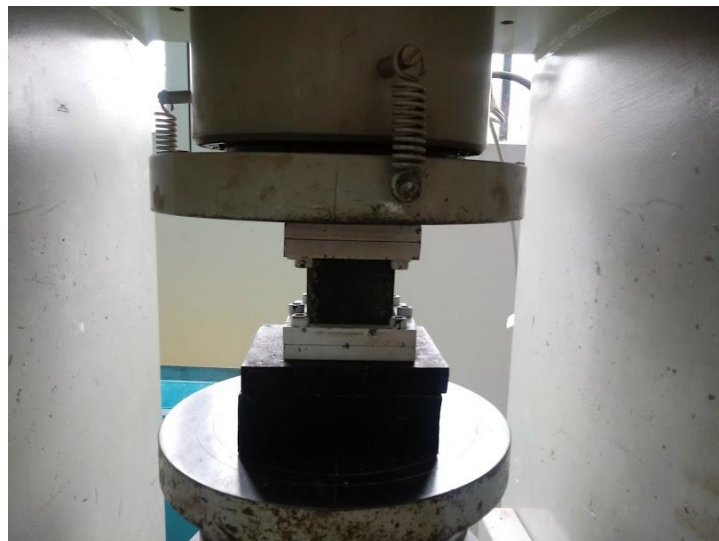
Figura 42. Rotura de los Moldes de Concreto para Morteros en el Laboratorio de Concreto y reciclado de la Universidad Nacional de Trujillo
