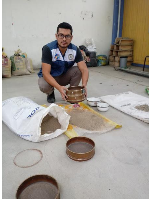
Figura 31. Separación de los agregados de acuerdo al tipo de malla
