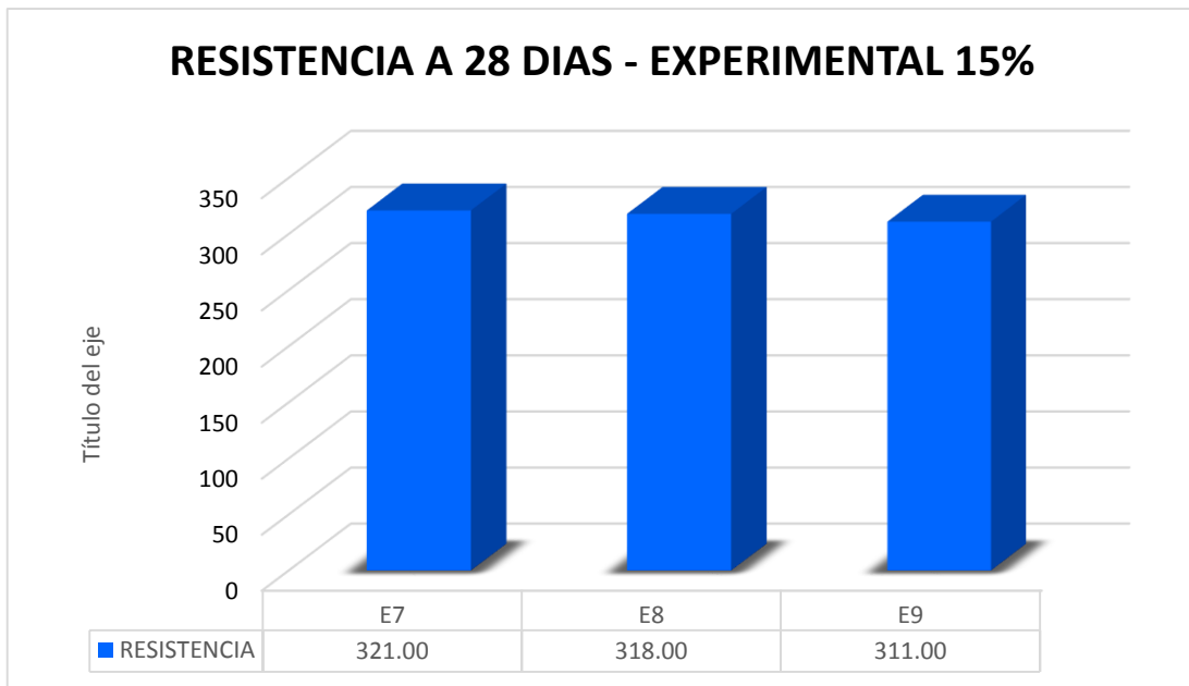
Figura 23. Ensayo de Resistencia a la Compresión Experimental 15% a los 28 días
