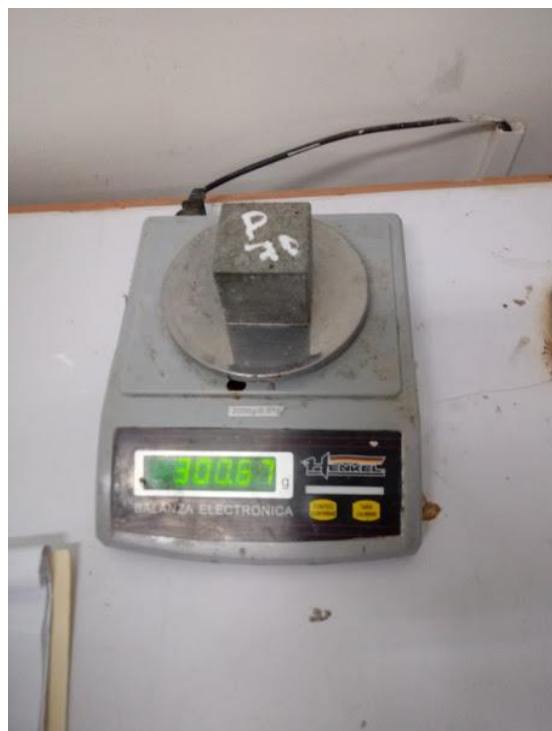
Figura 40. Pesos de los cubos de concreto después de los 7 días
