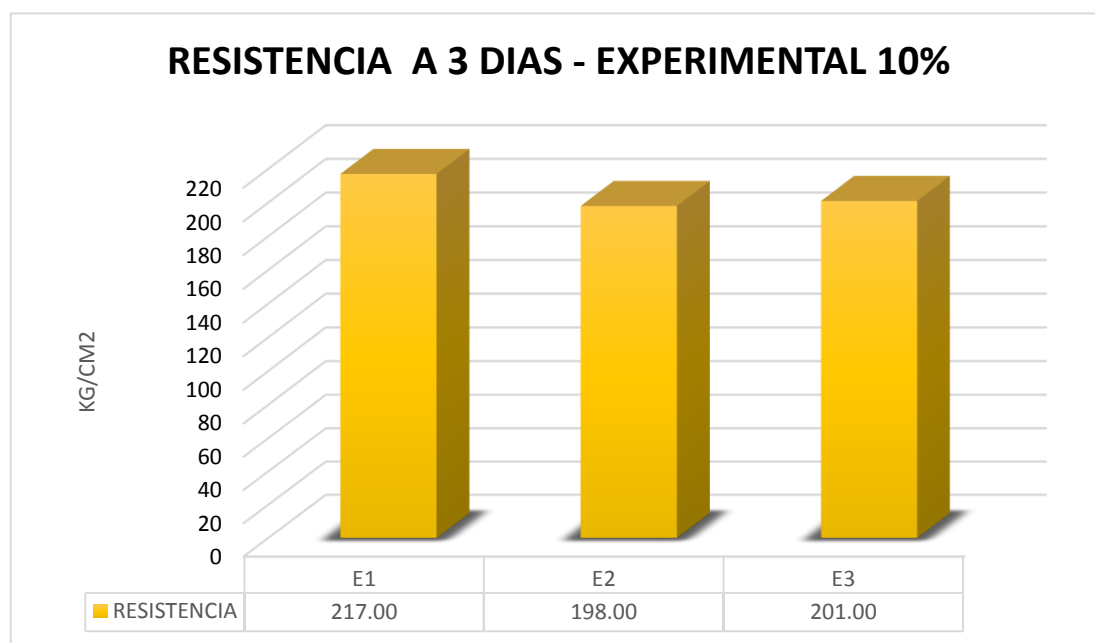
Figura 17. Ensayo de Resistencia a la Compresión Experimental 10% a los 3 días
