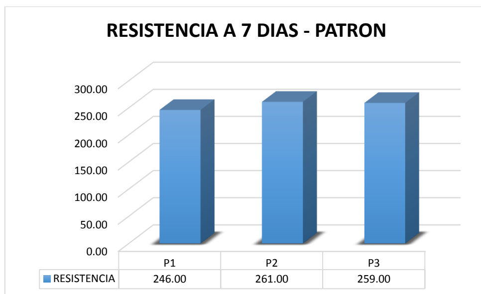
Figura 14. Ensayo de Resistencia a la Compresión Patrón a los 7 días
