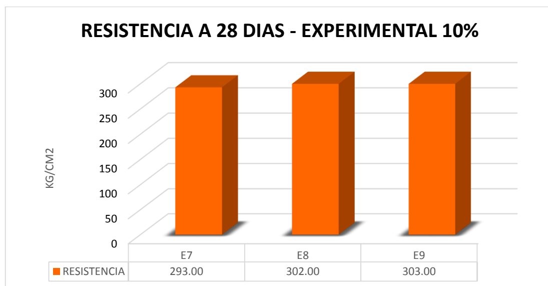
Figura 19. Ensayo de Resistencia a la Compresión Experimental 10% a los 28 días
