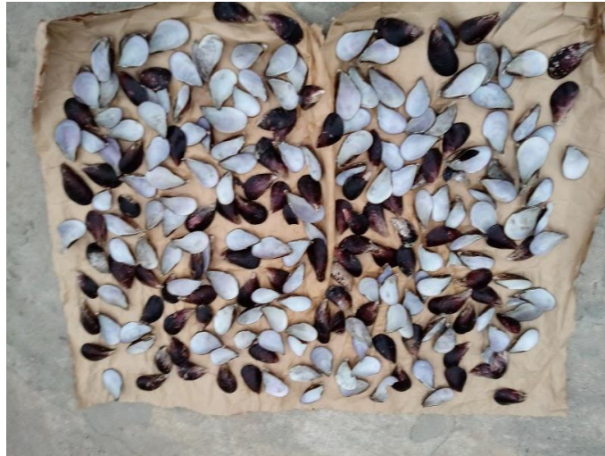
Figura 30. Secado del material de las conchas de mejillón al aire libre
