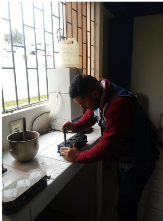
Figura 38. Llenado y chuceado del concreto en los moldes para morteros
