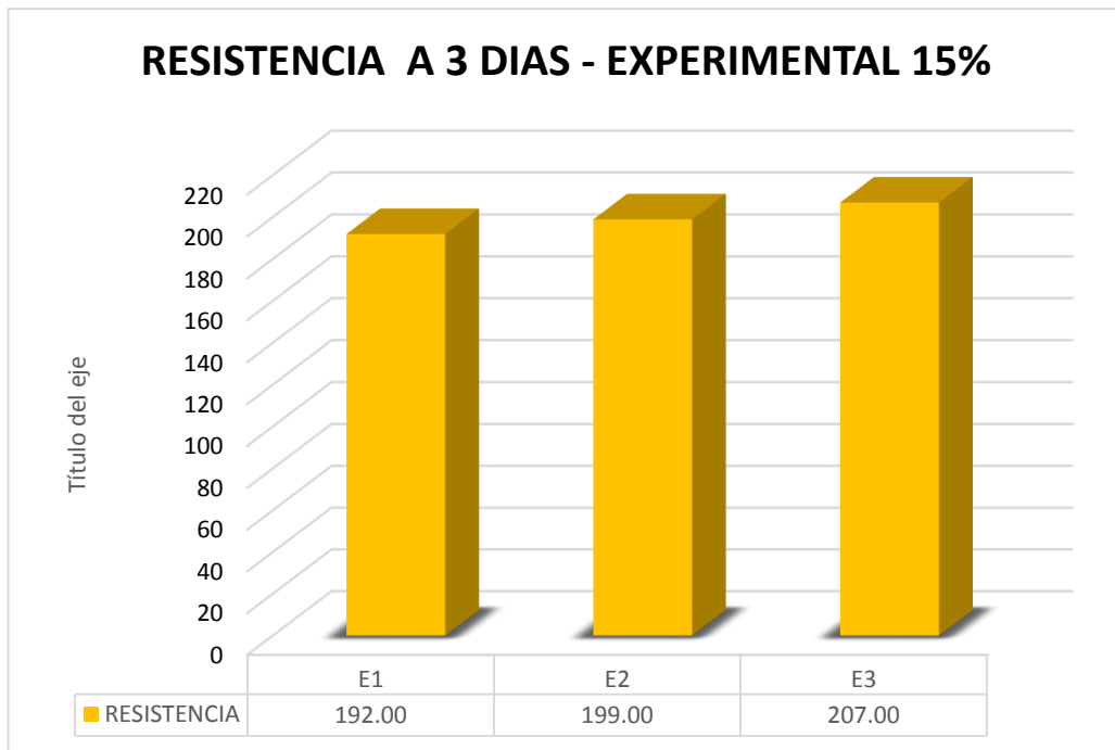
Figura 21. Ensayo de Resistencia a la Compresión Experimental 15% a los 3 días
