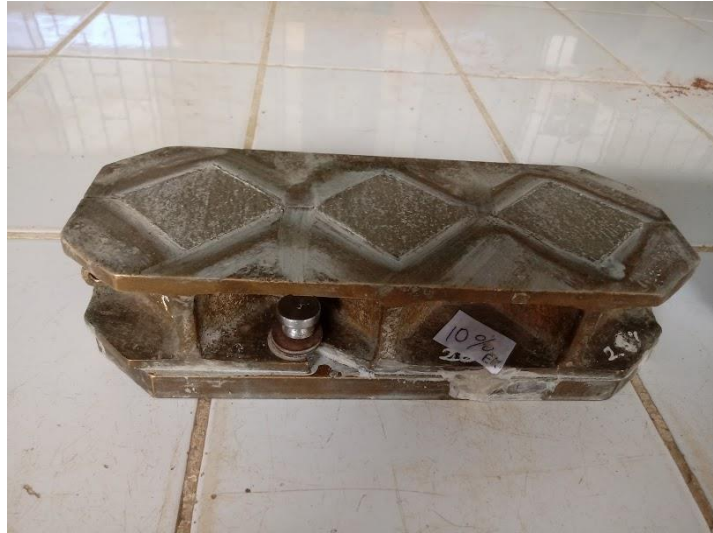
Figura 39. Cubos de concreto para mortero finalizado
