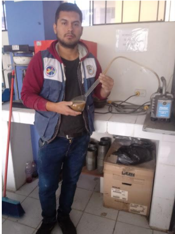
Figura 35. Ensayo del Gravedad Especifica y Absorción Agregado Fino
