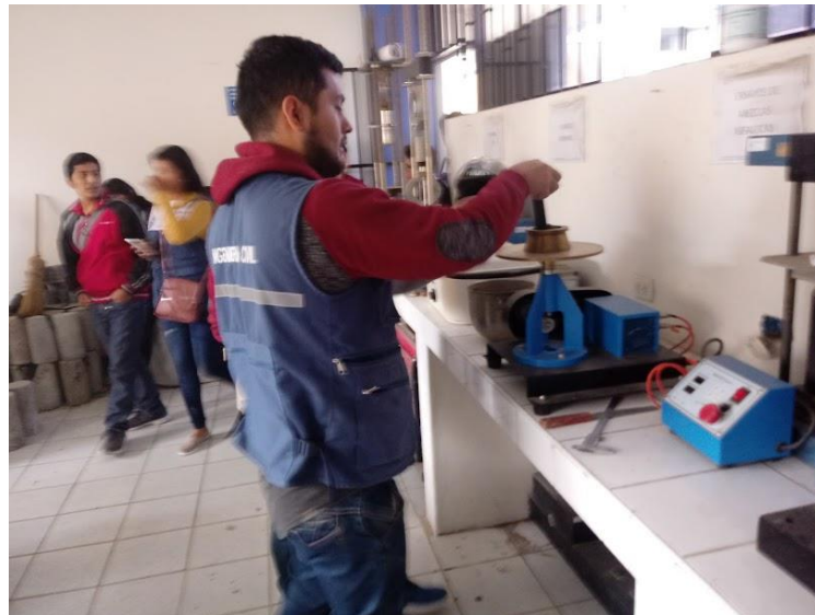
Figura 36. Ensayo para calcular la Fluidez del Mortero Patrón
