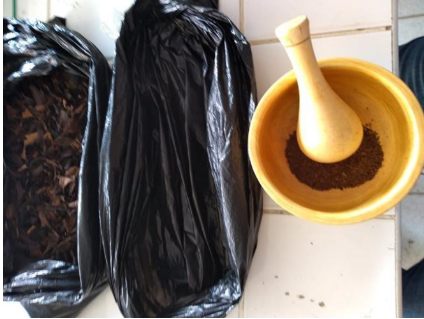
Figura 33. Luego de secado en la estufa, procedemos a triturar la cáscara con nuestro mortero.
