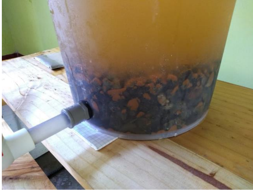
Figura 51. Dejamos reposar por espacio de 30 minutos la muestra de agua y nos percatamos que los sólidos empiezan a descender quedando retenidas en los estratos de piedras colocados.
