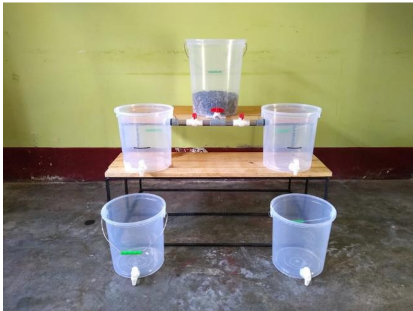
Figura 42. Armado del biofiltro sobre la estructura escalonada.
