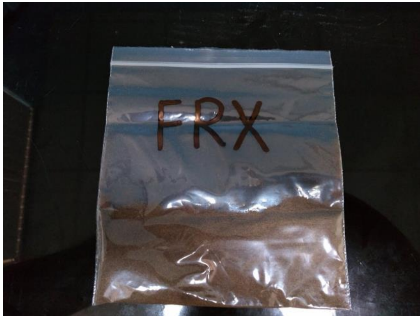
Figura 38. Pesamos 20 gr de polvo de cáscara de plátano pasado por el tamiz n° 100, esto con el fin de determinar su composición química.
