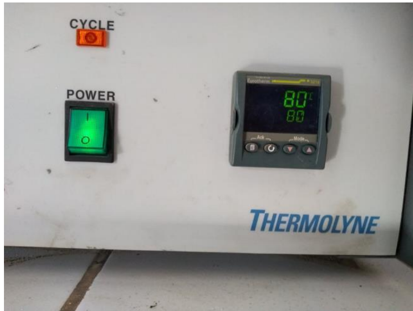
Figura 31. La cáscara permaneció en la estufa por un tiempo de 24 horas a 80 °C.
