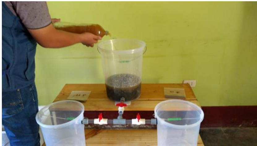
Figura 49. Vertimos la muestra de agua en nuestro biofiltro.
