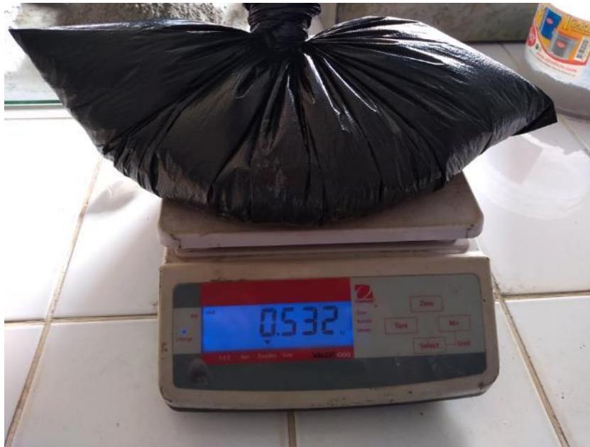
Figura 32. El peso de la cáscara luego de terminado el secado en la estufa fue de 532 gr.
