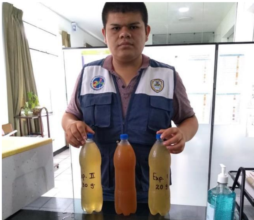
Figura 53. Luego que el agua entra en contacto con ambas dosis se deja reposar por espacio de 1 hora, finalizado este tiempo procedemos a abrir los caños y recoger el agua libre de metales.
