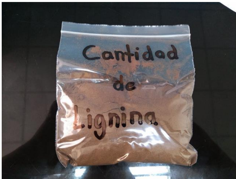
Figura 40. Pesamos 150 gr de polvo de cáscara de plátano pasado por el tamiz nº 100, esto con el fin de determinar su cantidad de lignina.
