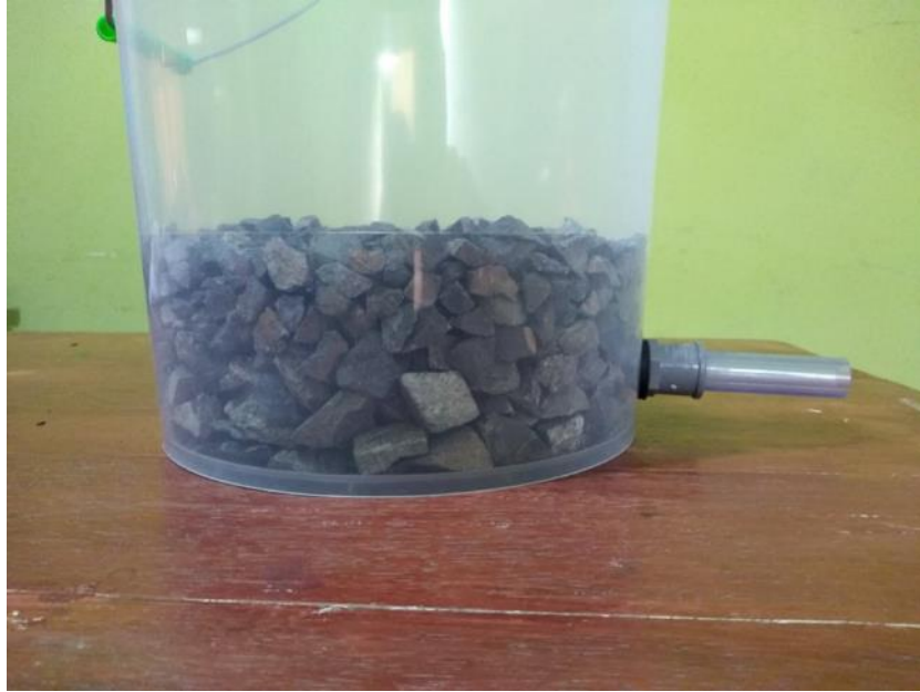
Figura 43. Apreciamos los estratos de piedra chancada colocados para la retención de sólidos.
