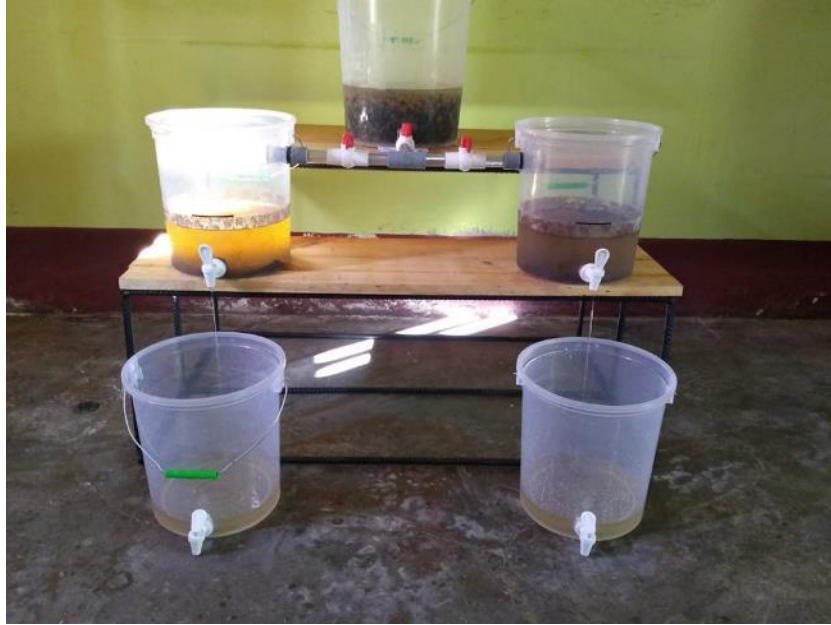
Figura 53. Luego que el agua entra en contacto con ambas dosis se deja reposar por espacio de 1 hora, finalizado este tiempo procedemos a abrir los caños y recoger el agua libre de metales.
