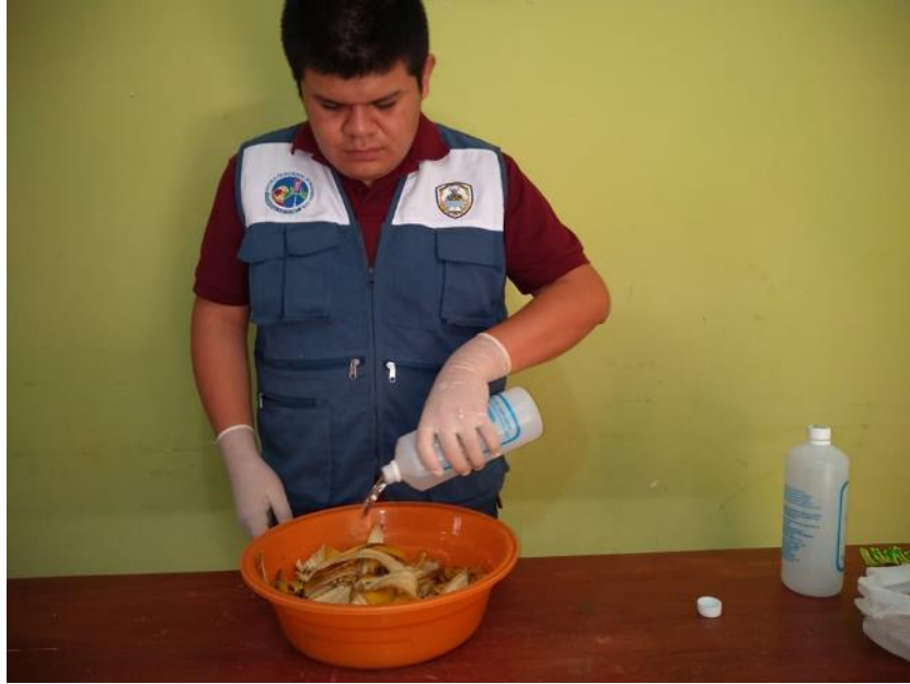
Figura 23. Lavamos las cáscaras con abundante agua destilada para eliminar restos de pulpa y cualquier impureza.
