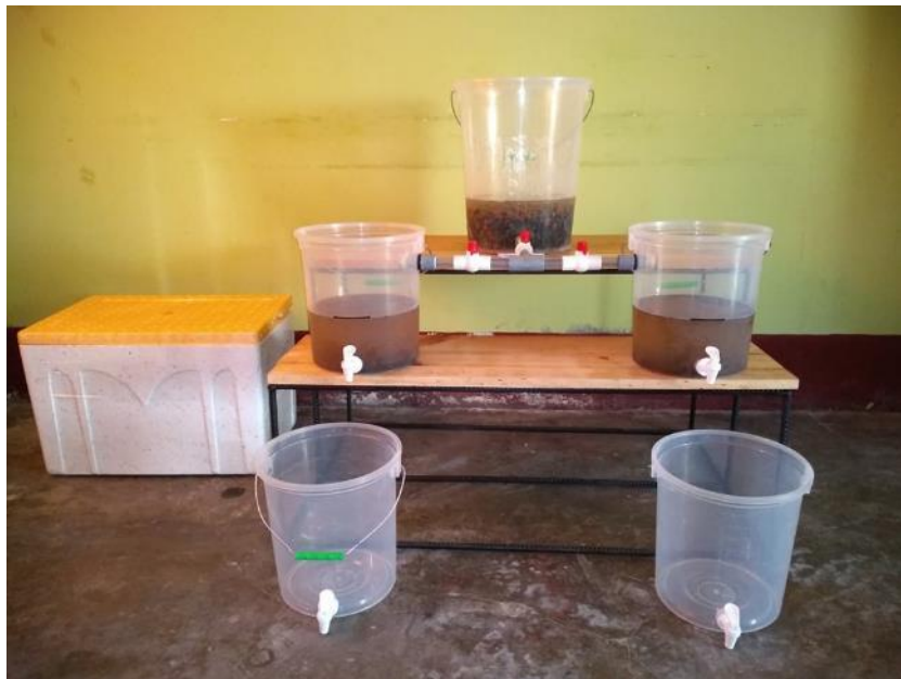
Figura 52. Luego del tiempo de reposo, procedemos a abrir las válvulas permitiendo que el agua continúe su recorrido hasta llegar a entrar en contacto con ambas dosis de polvo de cáscara de plátano.
