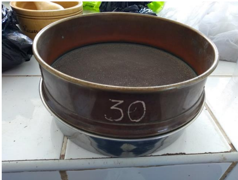
Figura 34. La cascara triturada lo pasamos por el tamiz n° 30 (abertura 0.59 mm).
