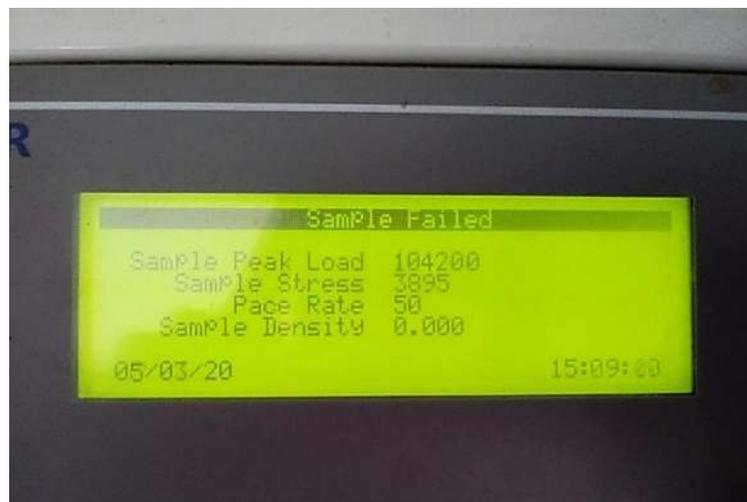
Foto n°27: Resultado resistencia a la compresión sust. 16% a los 28 días
