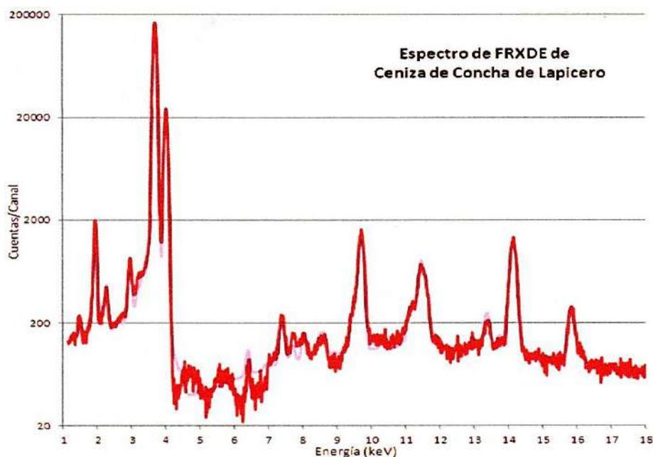
**Figura N° 08:** Espectro de FRXDE de ceniza de concha de lapicero en escala semi-logarítmica. Incluye el pico de Ar del aire y los picos de rayos-X de Au dispersados por la muestra. La curva en azul muestra el espectro simulado.
