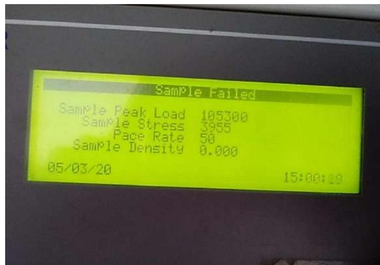
Foto n°28: Resultado resistencia a la compresión sust. 16% a los 28 días.
