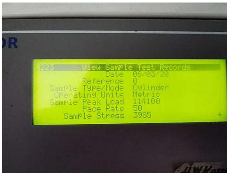
Foto n°31: Resultado resistencia a la compresión sust. 28% a los 28 días.
