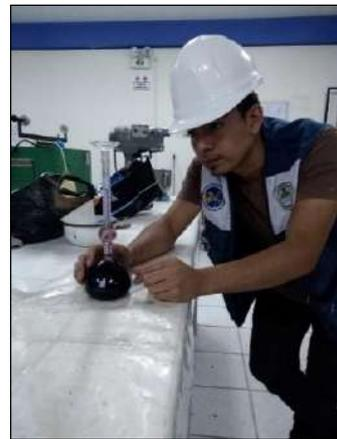
**Foto n°17:** Ensayo Peso específico
