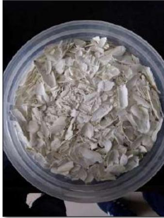
**Foto n°11:** Resultado del material en CCL calcinado a 870°
