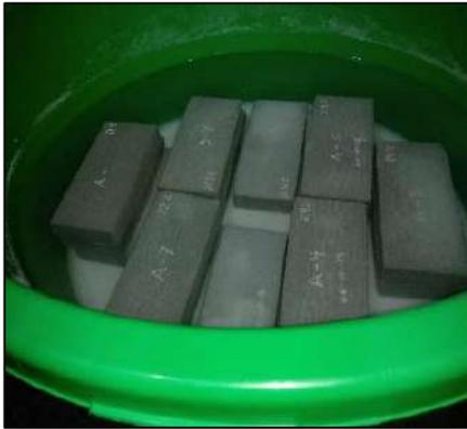
**Foto n°23:** Curado de los adoquines convencionales/experimentales
