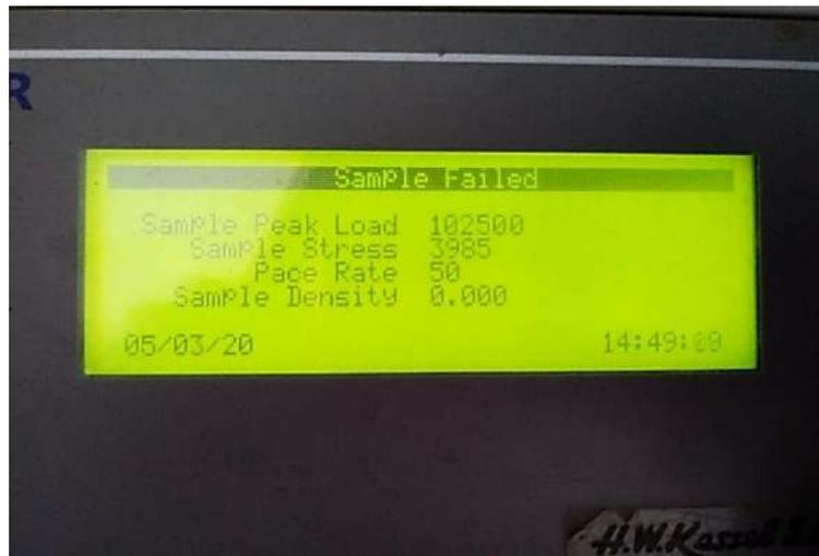
Foto n°26: Resultado resistencia a la compresión sust. 16% a los 28 días.
