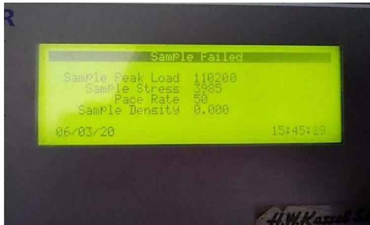
Foto n°29: Resultado resistencia a la compresión sust. 28% a los 28 días.
