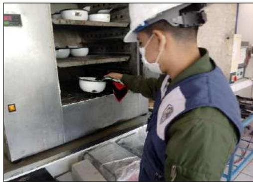
**Foto n°12:** Ingresando muestras al horno/ contenido de humedad
