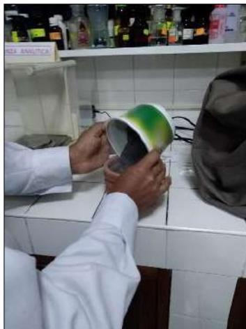
**Foto n°7:** Colocación del material pre-quemado en el horno en un recipiente resistente a altas temperaturas
