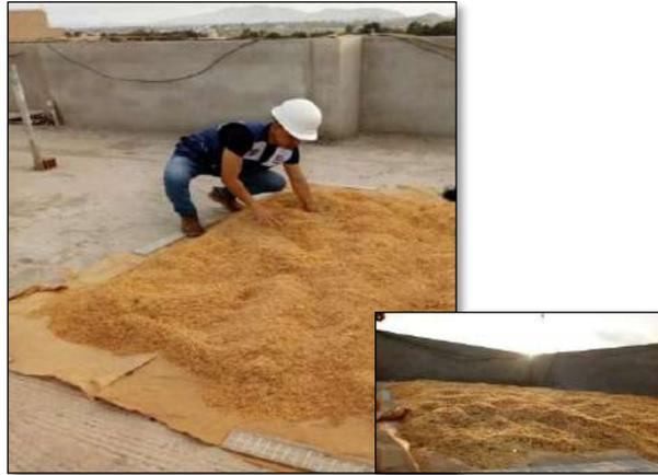
**Foto n°3:** Tendido de la y secado de la Cascara de arroz.
