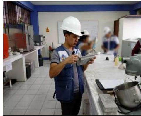
**Foto n°24:** Control y verificación de las dimensiones de los adoquines
