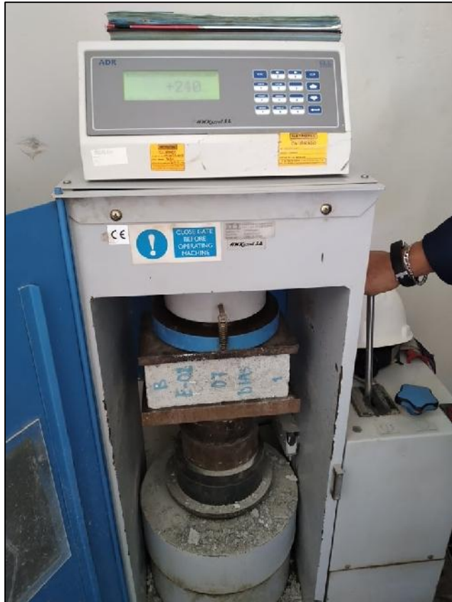
FIGURA N°19: Ensayo de Resistencia a Compresión del ladrillo.
