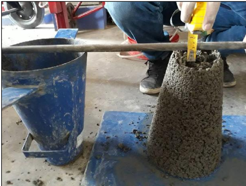
FIGURA N°06: Prueba de Slump
