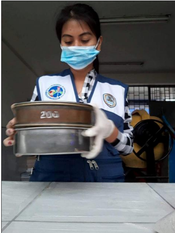
FIGURA N°05: Tamizado del polvo de cenizas de bagazo de caña de azúcar y polvo de concha de abanico por la malla N° 200
