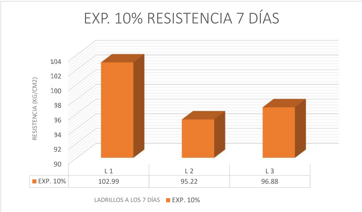
GRAFICO N°05: Gráfico de Ensayo de Resistencia a la Compresión del ladrillo Experimental 10% a los 7 días.
