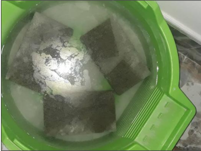
FIGURA N°17: Curado de los ladrillos patrones y experimentales mediante sumersión.
