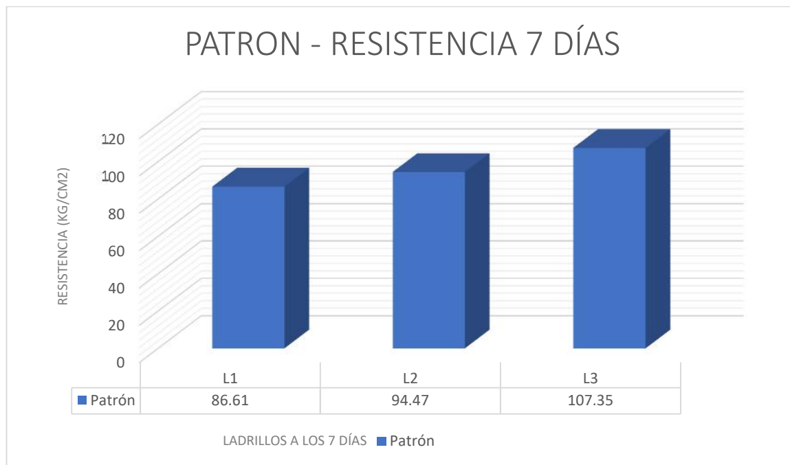
GRAFICO N°01: Gráfico de Ensayo de Resistencia a la Compresión del ladrillo patrón a los 7 días.
