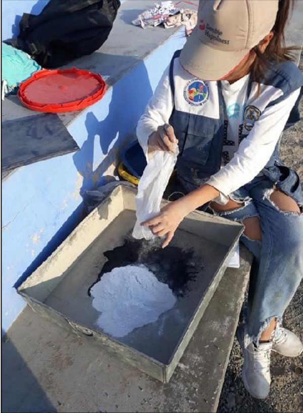
FIGURA 09 y 10: Mezclando en un recipiente el cemento, cenizas de bagazo de caña de azúcar y polvo de concha de abanico.
