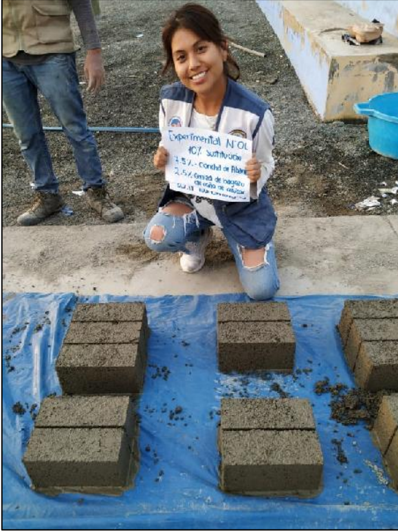
FIGURA N°15: Ladrillos Experimentales 10% obtenidos artesanalmente.
