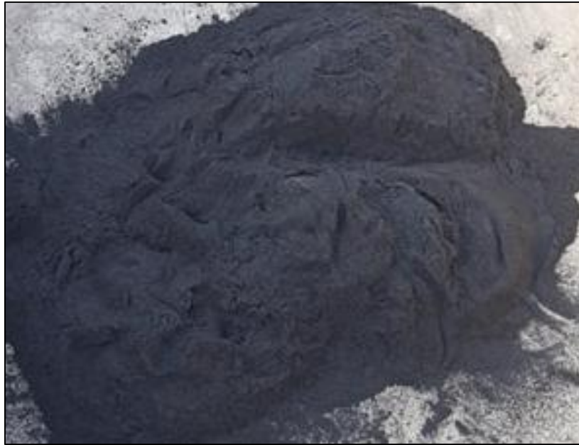
FIGURA N°03: Calcinación del bagazo de caña de azúcar Fuente: Elaboración Propia.
