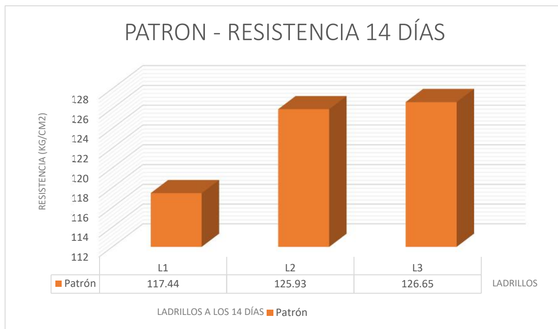
GRAFICO N°02 Gráfico de Ensayo de Resistencia a la Compresión de Ladrillo Patrón a los 14 días.
