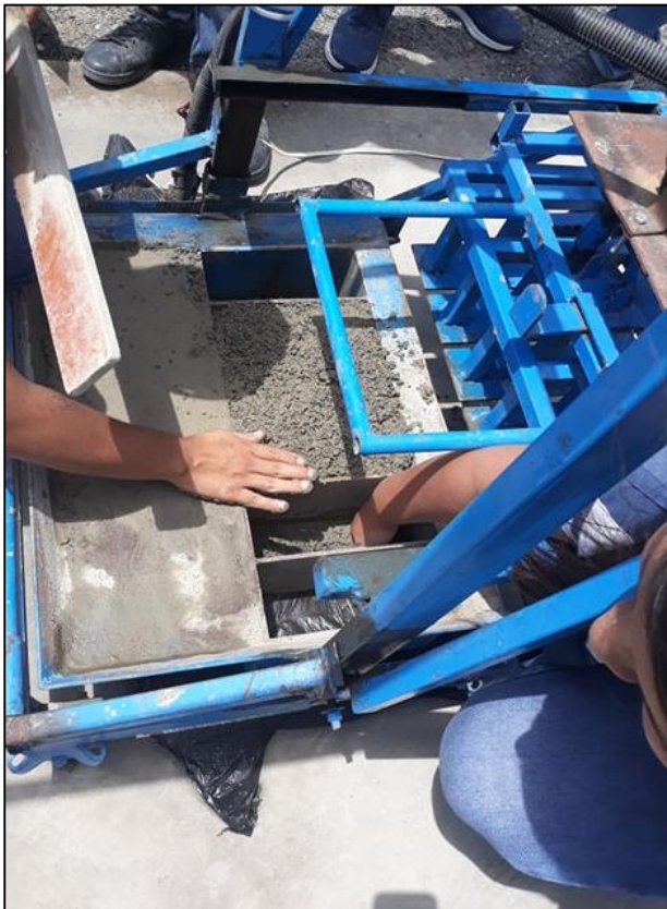
FIGURA N°12: Vertiendo la mezcla en el molde de la maquinaria mecánica con un vibrado de 20 segundos.
