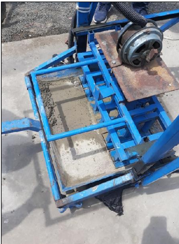
FIGURA N°14: Vibrado con las tapas colocadas durante 10 segundos.
