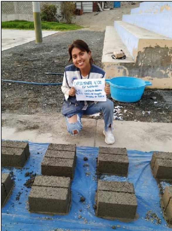
FIGURA N°16: Ladrillos Experimentales 15% obtenidos artesanalmente.
