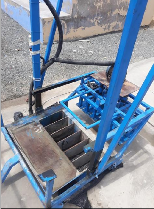
FIGURA N°11: Maquinaria mecánica donde se elaboraron los ladrillos.
