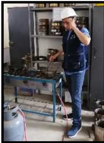
Figura 18: Secado de arena en estufa para su posterior pesado
