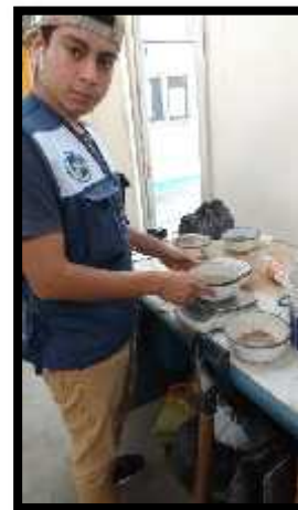
Figura 23: Para el ensayo de gravedad específica pesamos la tara y nuestra arena
