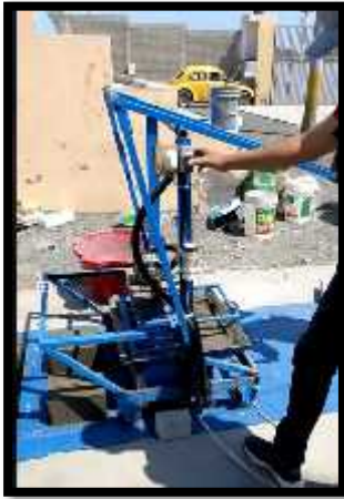
Figura 56: Luego se colocó la tapa y se vibró por 10 seg. mas.
