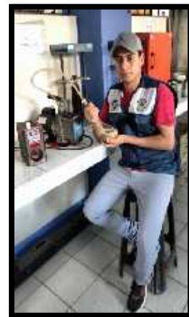
Figura 39: Uso de picnómetro para obtener un peso del material sin vacíos.
