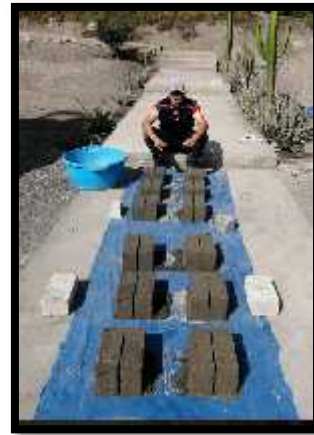
Figura 57: Se desmoldó con éxito los 24 ladrillos
