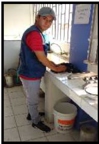
Figura 30: Se retiró el agua y se procedió a secar superficialmente el confitillo.
