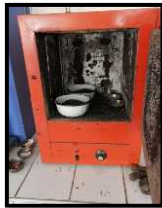
Figura 27: De igual manera de secará en horno la escoria.
