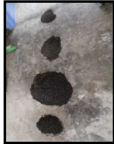
Figura 21: Luego del tamizado y proporcionado, se procede a mezclar.
