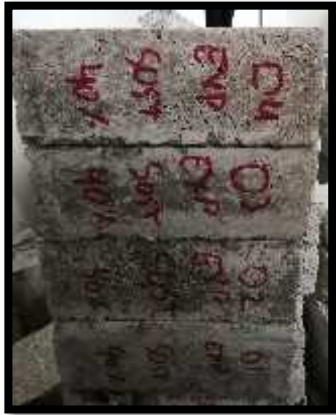
Figura 64: Fallas en los ladrillos al 40% sometidos a cargas.
