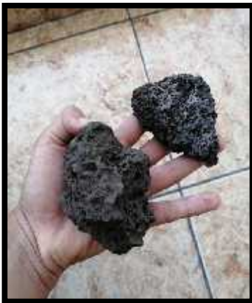
Figura 10: Estado inicial de la escoria, como se obtiene
