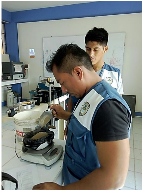
Foto 5. Pesaje de la arena por gradación.
