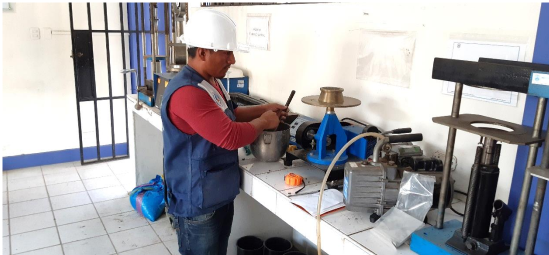
Foto 7. Determinación del límite de fluidez. Laboratorio de mecánica de suelos de la Universidad San Pedro - CHIMBOTE.
