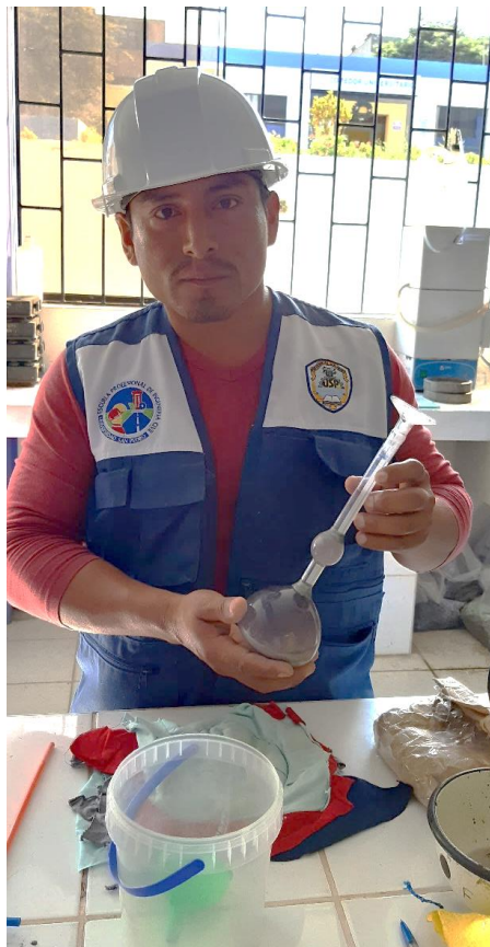
Foto 8. Determinación del peso específico de la ceniza de caracol y del cemento sustituido. Laboratorio de mecánica de suelos de la Universidad San Pedro - CHIMBOTE.
