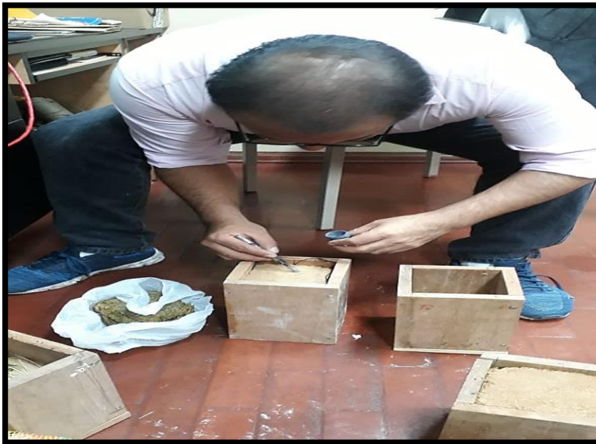
Figura 46. Ensayo de Conductividad Térmica para el piso patrón y experimental Bajo la norma ASTM D-7984, realizado en la Universidad Nacional Ingeniería.
