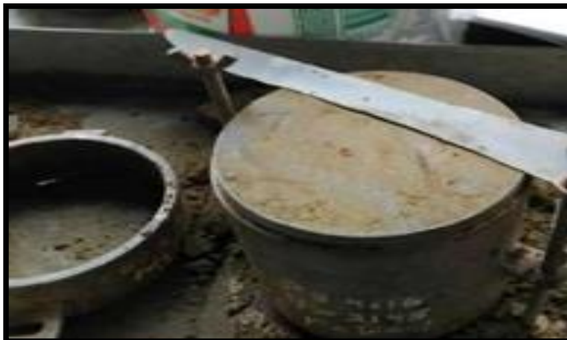
Figura 40. En proceso de moldeado se retira el collar y se empareja en la parte superior del molde.
