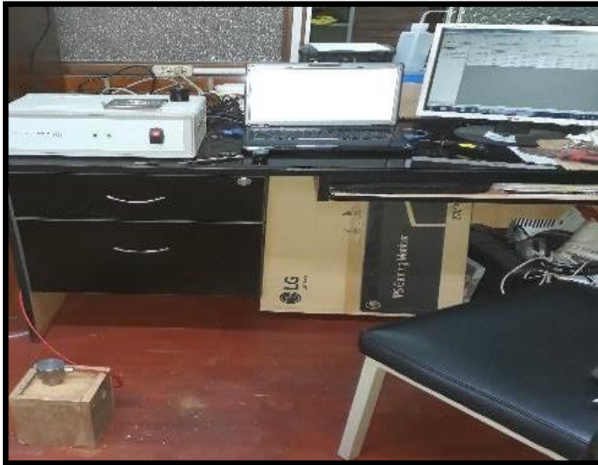
Figura 47. Ensayo de Conductividad Térmica para el techo patrón y experimental Bajo la norma ASTM D-7984, realizado en la Universidad Nacional Ingeniería
