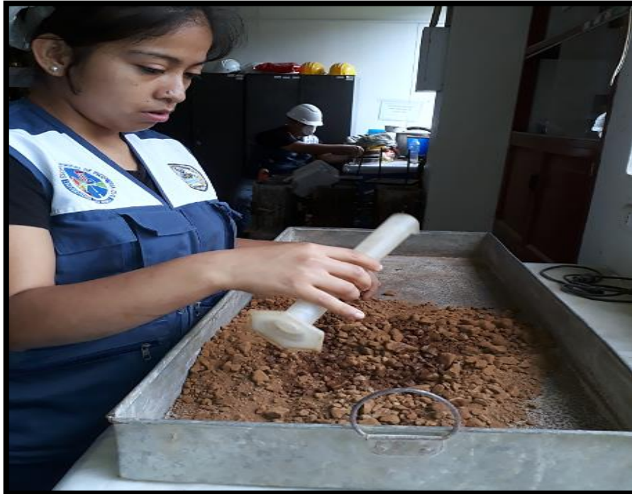
Figura 34. Proceso de adición de agua en porcentaje en peso de la muestra suelo (2%,5%,8%,11%).
