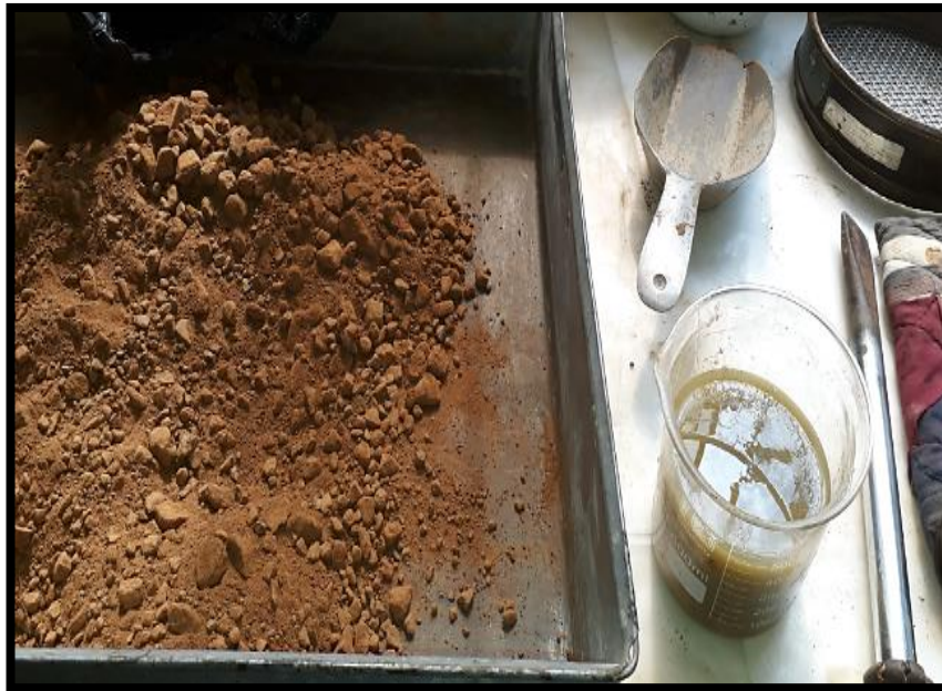
Figura 36. Humedecimiento de la muestra del suelo Experimental con Mucilago de Nopal.
