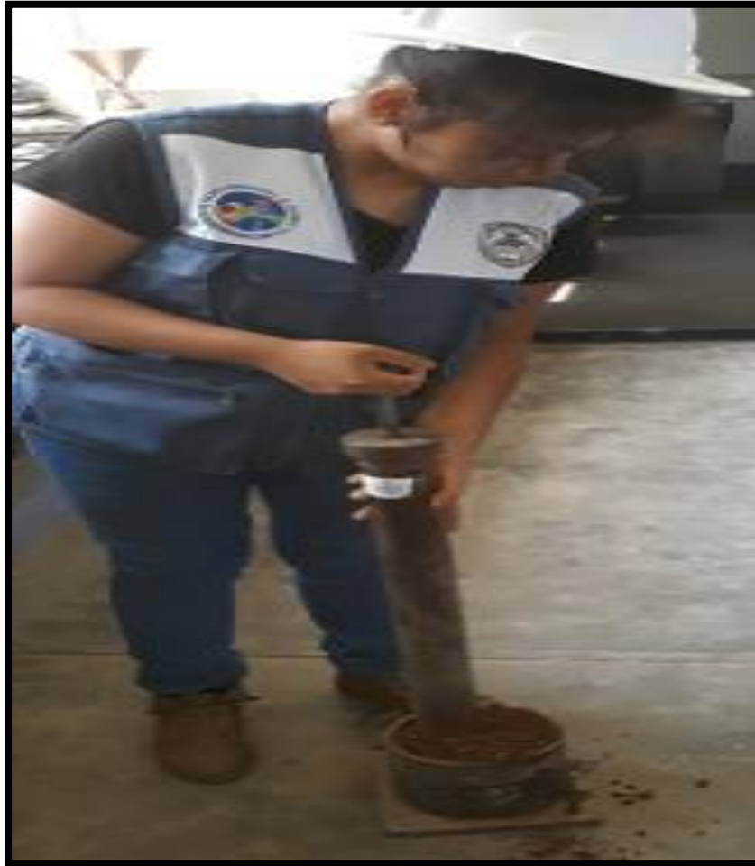
Figura 39. Proceso de compactado.
