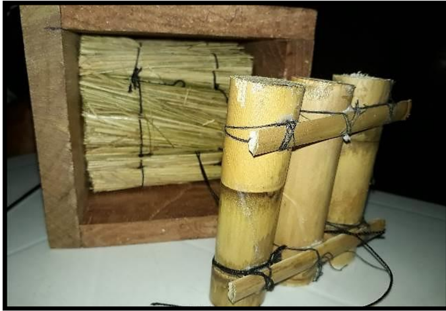
Figura 45. Estructuración de la muestra de techo que contiene cana brava, Stipa ichu y Bloque de tierra compactada.
