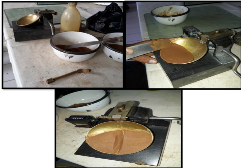
Figura 29, 30,31. Ensayo de Atterberg- Límite Líquido.
