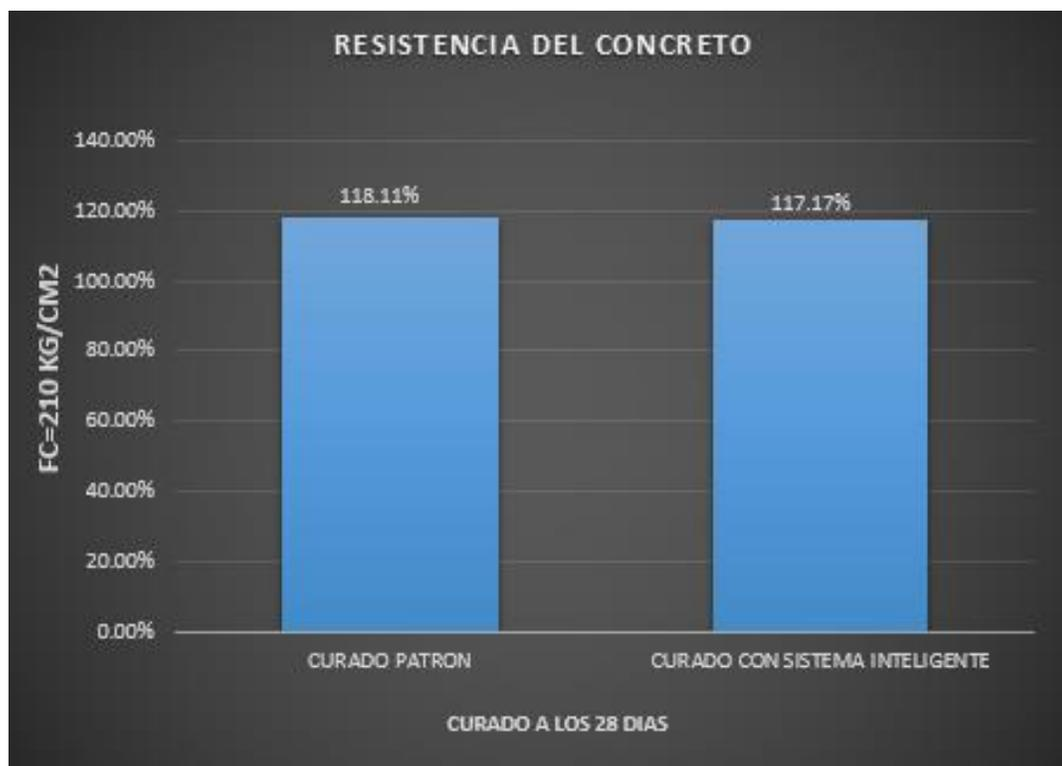
**Figura 19:** Resistencia Del Concreto A Los 28 Días Porcentaje
