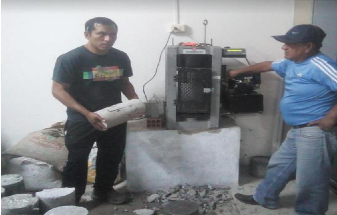
Figura N°9: Prueba de rotura de la probeta
