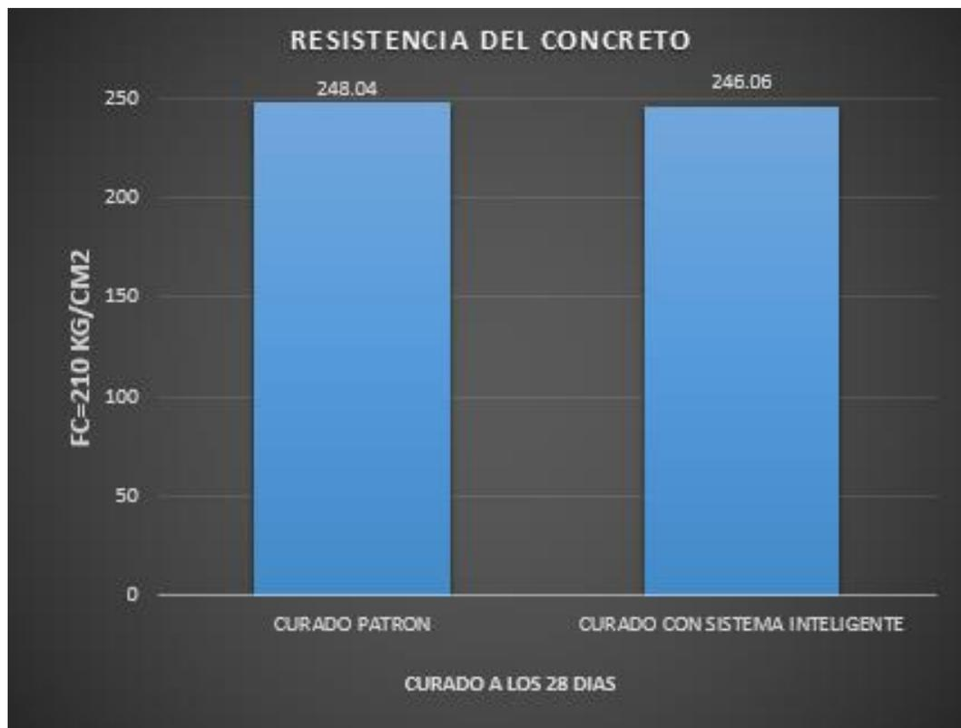
**Figura 18:** Resistencia del Concreto A Los 28 Días En Promedio
