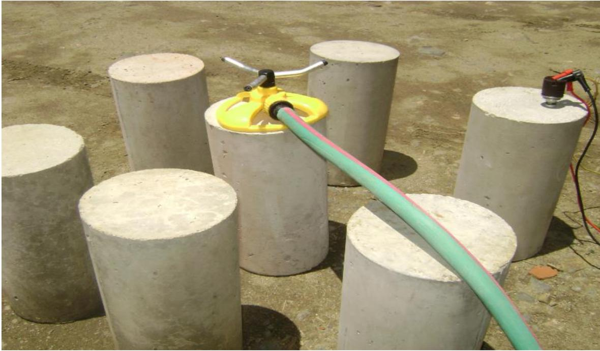
Figura N°7: Preparación para el curado del concreto con el sistema de curado inteligente
