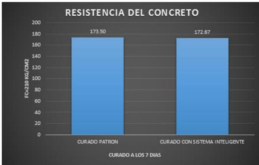
Figura 9: *Resultado promedio del curado patrón y curado inteligente*
