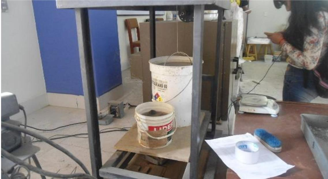
Figura N°3: peso del agregado grueso para el peso específico
