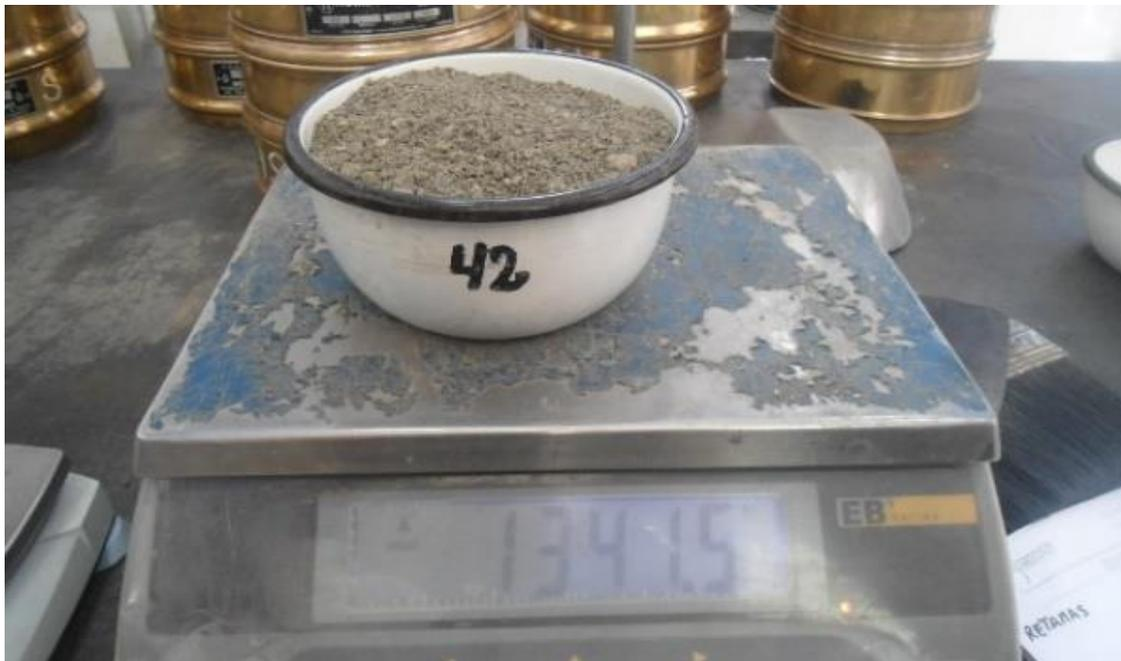
Figura N°02: Peso del material para contenido de humedad del agregado fino
