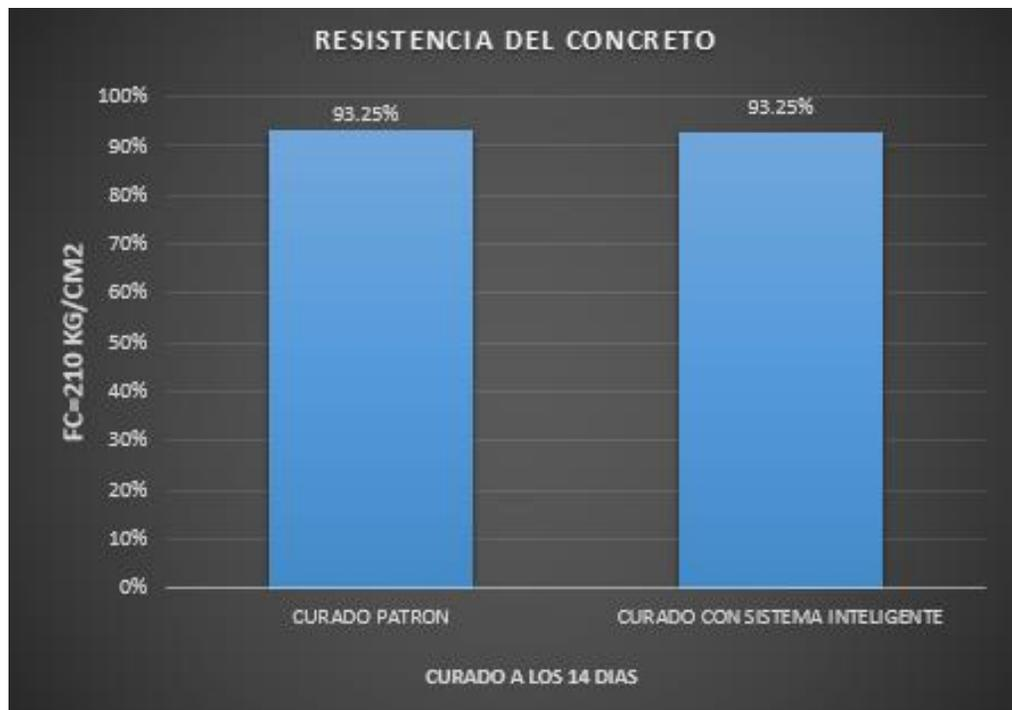
**Figura 15:** Resistencia A La Compresión A Los 14 Días En %
