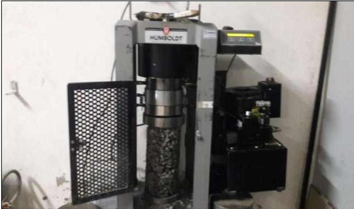
Imagen 19. Ensayos de resistencia a la compresión del diseño patrón.
