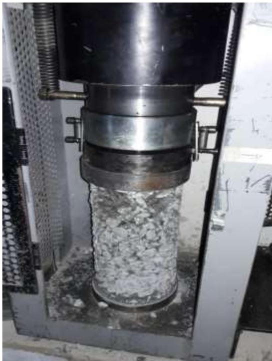
**Imagen 26.1.- Ensayo de la resistencia a la compresión del diseño experimental N° 03**
