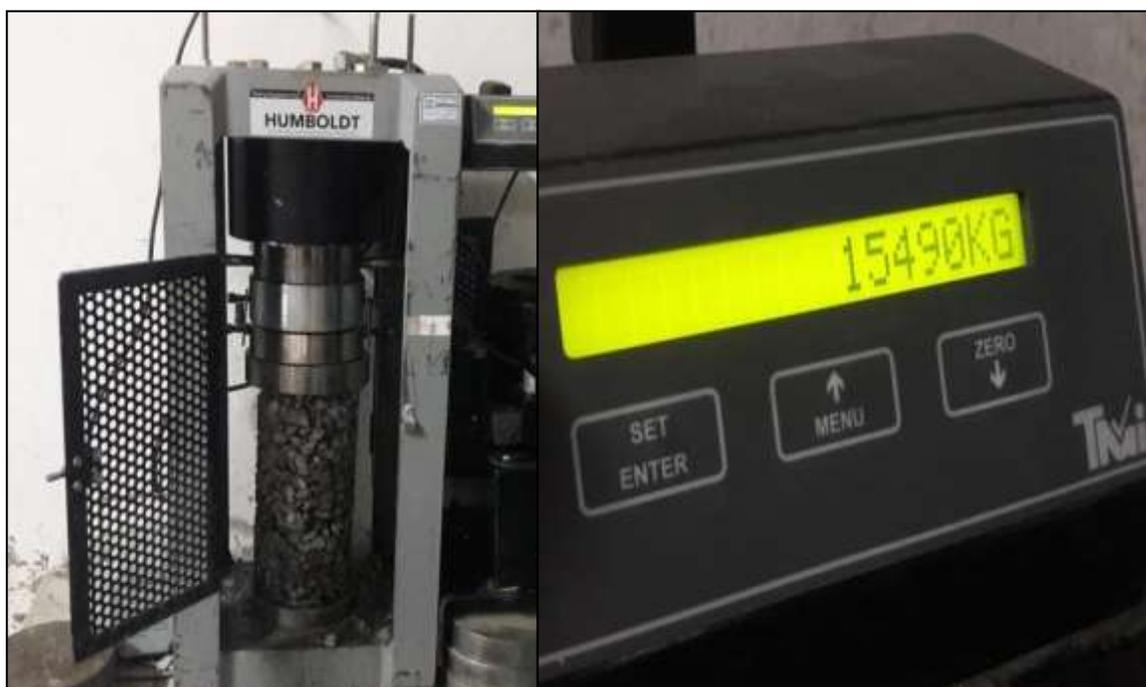
Imagen 28.- Toma de lectura del ensayo de la resistencia a la compresión.
