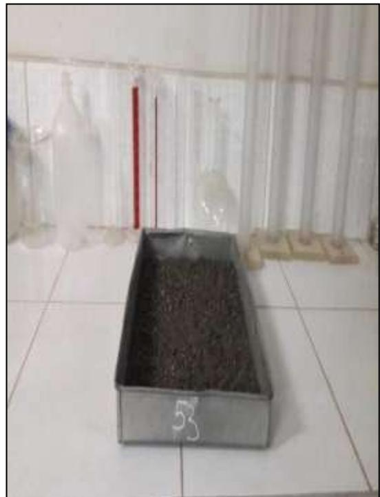
*Imagen 4.- Ensayo de peso unitario del agregado fino.*
