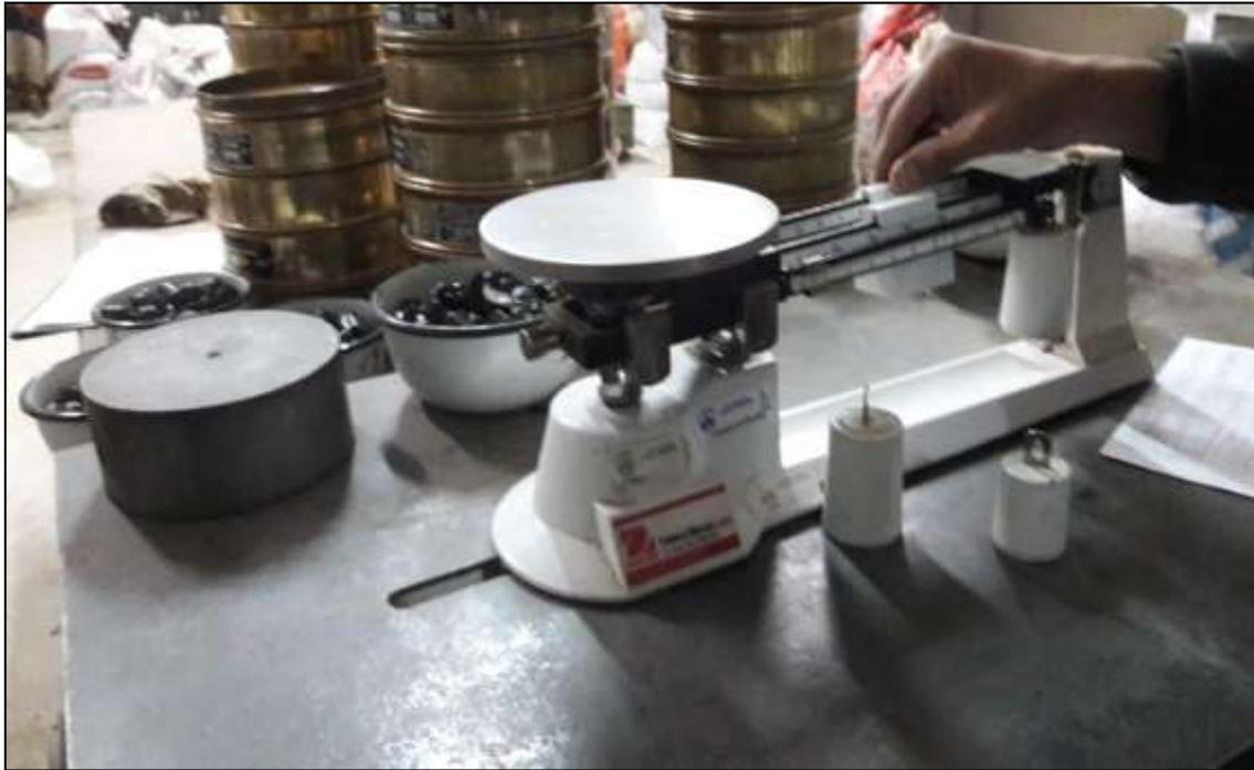
*Imagen 9.- Balanza para realizar el ensayo de absorción.*
