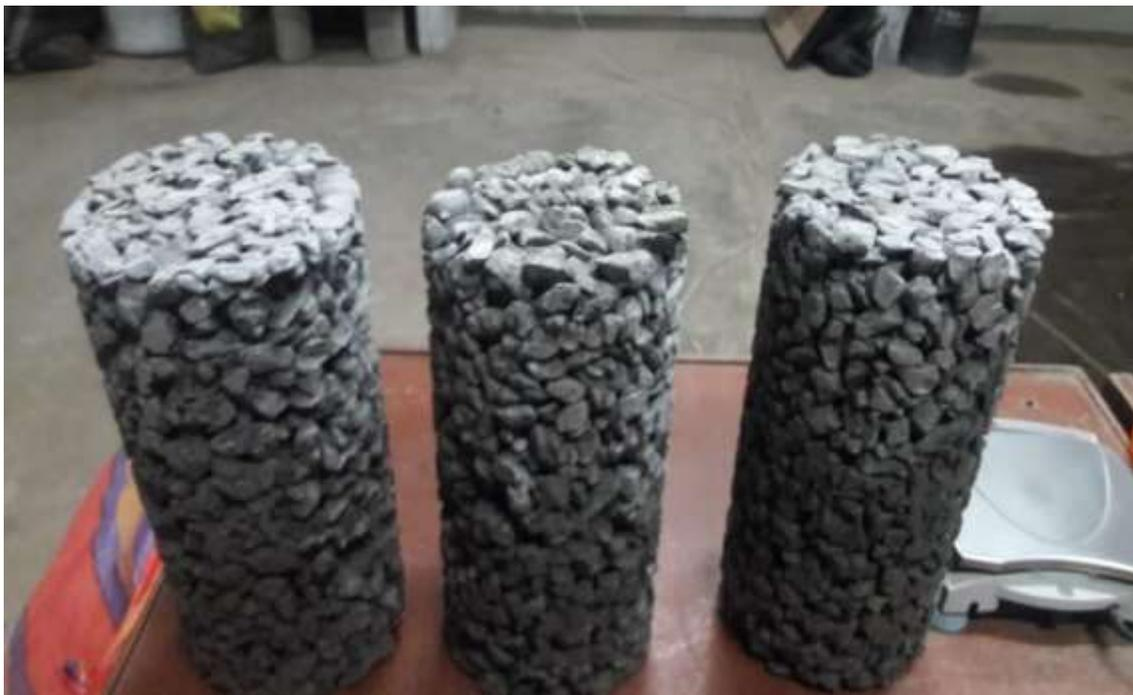
*Imagen 22.- Secado de la muestra experimental N° 02, 20% de agregado fino x 24 horas antes del ensayo a la compresión.*
