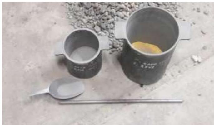
*Figura 2: Herramientas utilizadas para el ensayo de peso unitario del material Fuente: Autor*
