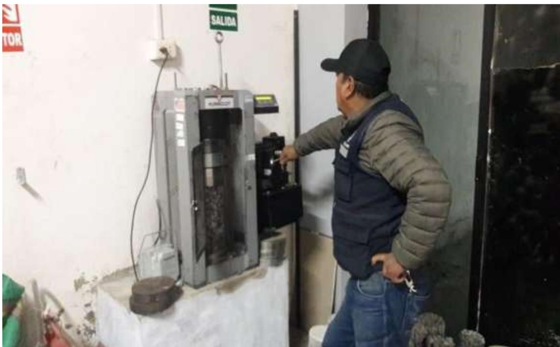
Imagen 27. Ensayo de resistencia a la compresión de las muestras experimentales N° 03 con las indicaciones del técnico de laboratorio de la USP.
