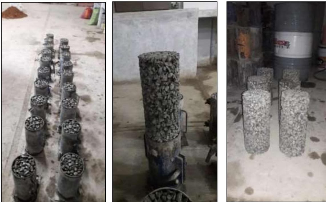
Imagen 16. Colocación de mezcla y desencofrado
