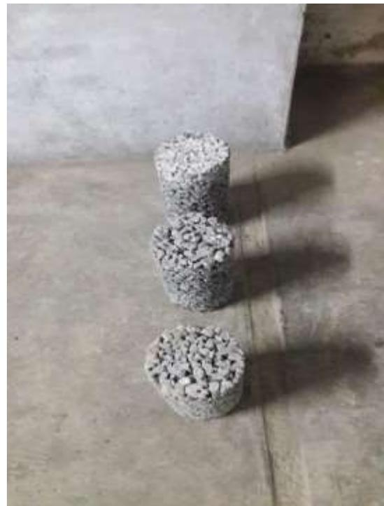
**Imagen 26.2.- Muestras de especímenes a los 28 días de curado para realizarse el ensayo de la resistencia a la compresión del diseño experimental N° 03**
