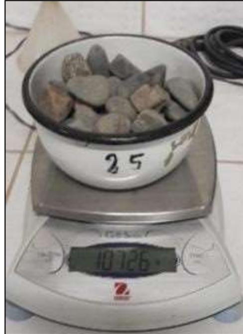
Imagen 7. Ensayo de peso unitario de agregado grueso.
