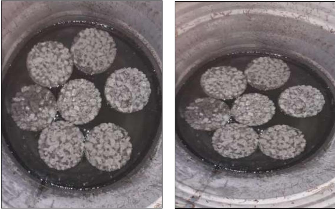
**Imagen 47. Curado de los especímenes en el laboratorio.**
