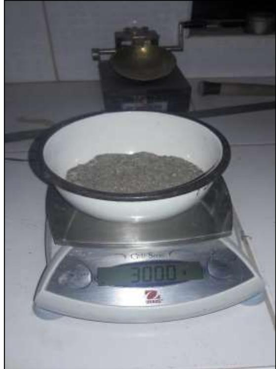
Imagen 13.2. Peso del agregado fino.
