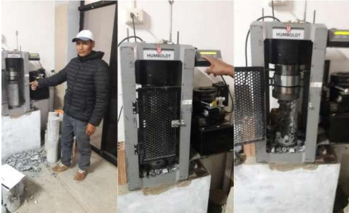
Imagen 23.- Ensayo de resistencia a la compresión del diseño experimental N° 02 (agregado fino 20%).
