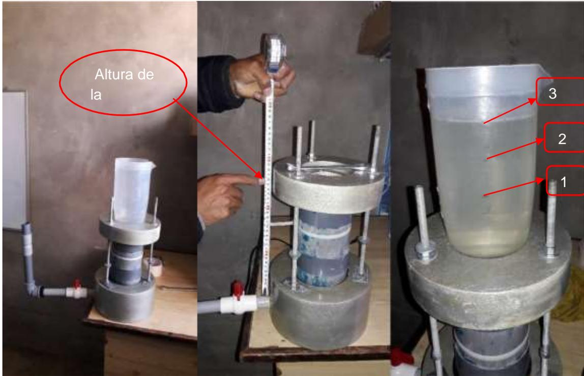
Imagen 31. Ensayo de permeabilidad de los especímenes del concreto permeable.
