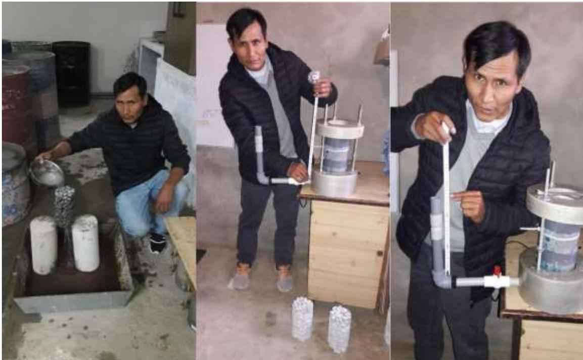
Imagen 30.- Elaboración del permeámetro según la guía del ACI.
