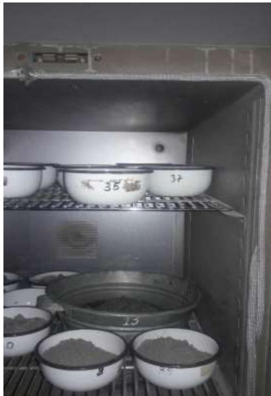
*Imagen 22.- Materiales secado en el horno para sus respectivos ensayos*
