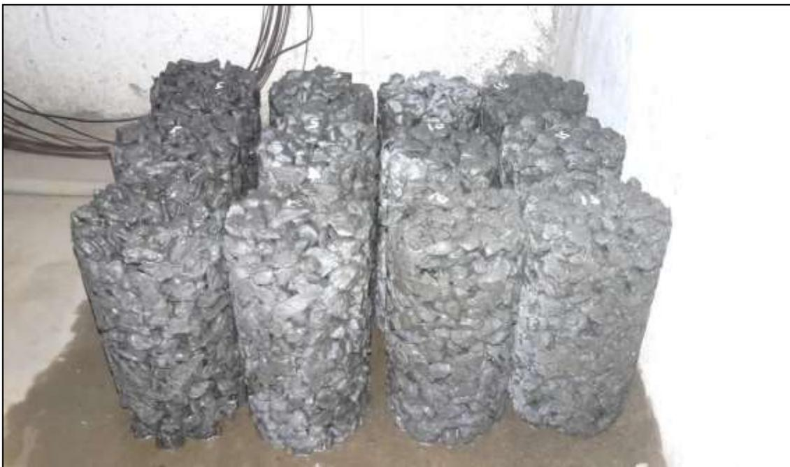
Imagen 24.- Secado de especímenes del diseño experimental N° 03 añadido el 30% de agregado fino.
