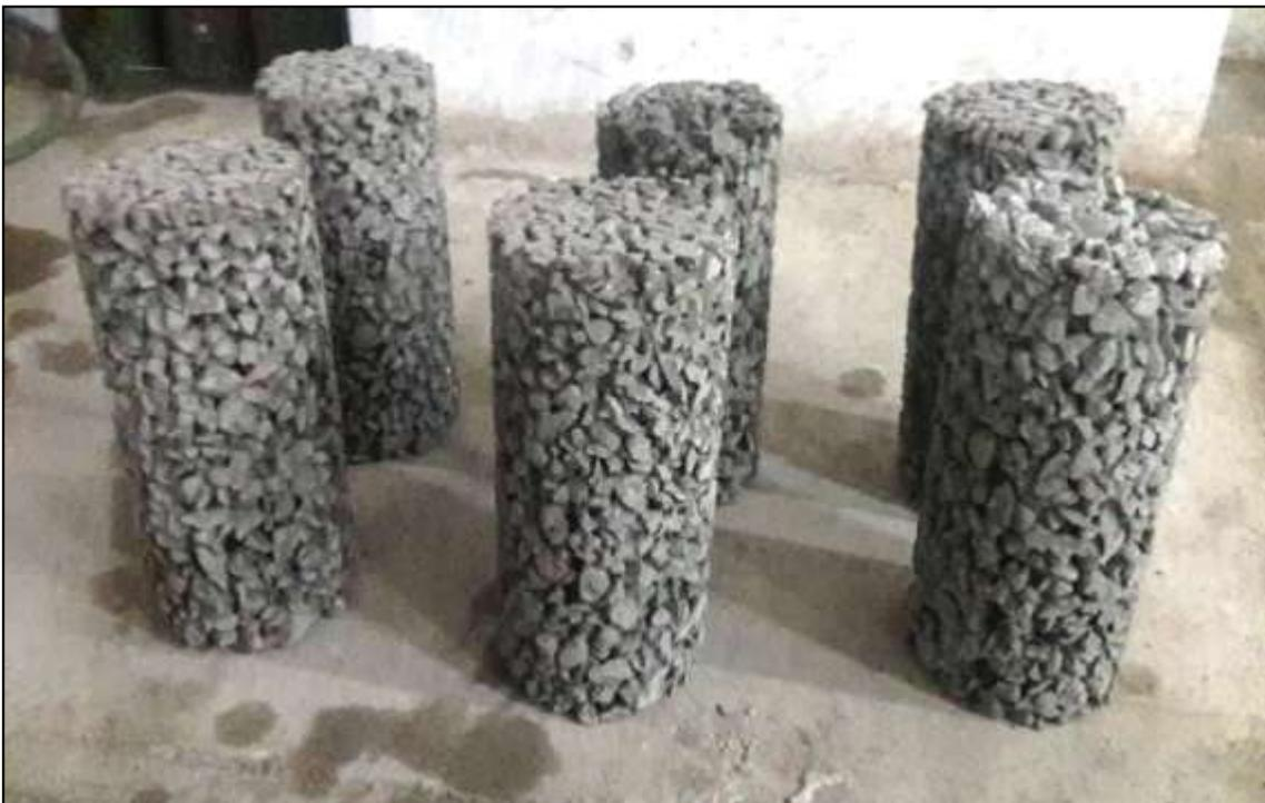
**Imagen 48. Secado mínimo de 24 horas de especímenes antes del ensayo de compresión, diseño patrón.**
