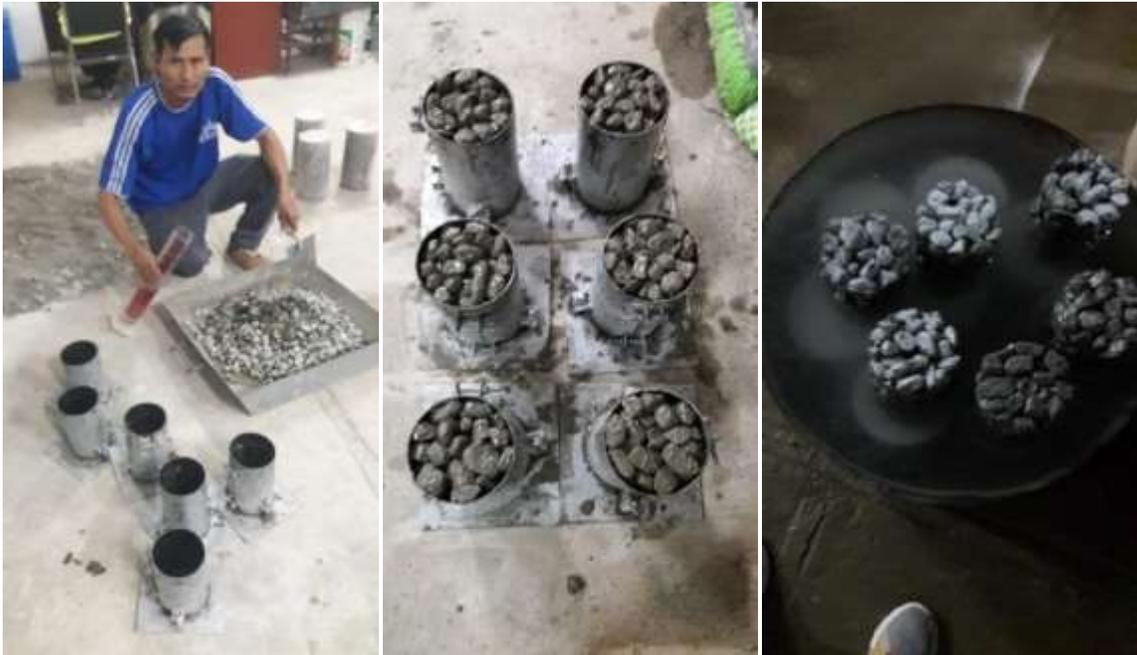
Imagen 29.- Preparación, colocación de la mezcla y curado para el ensayo de permeabilidad.
