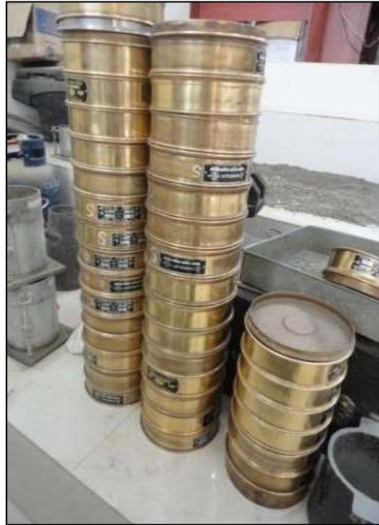
Imagen 5. Tamices utilizados en el Laboratorio.
