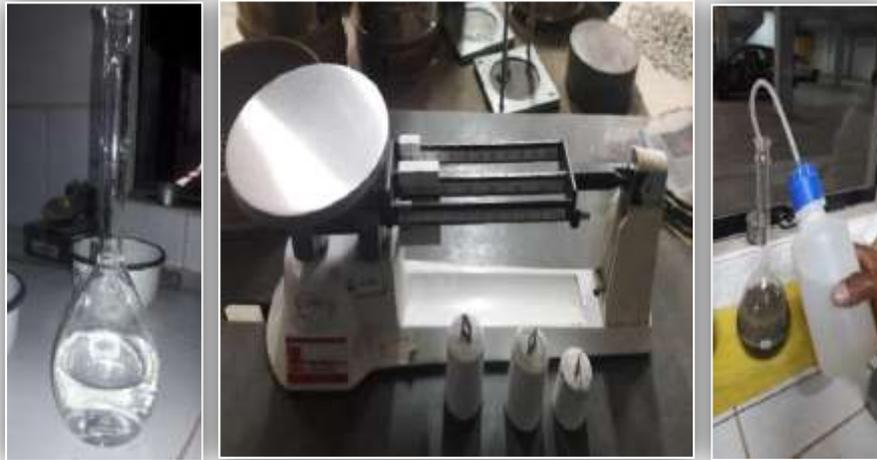
*Figura 3: Equipos de ensayo de peso específico y absorción Fuente: Autor.*
