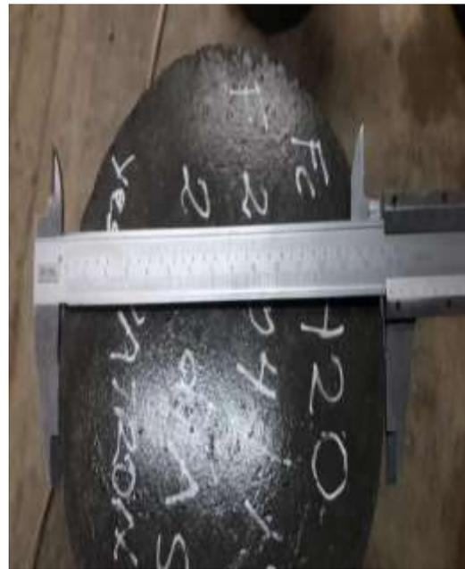
Imagen 32.- Toma de medida de los diámetros de las muestras para el cálculo de áreas.
