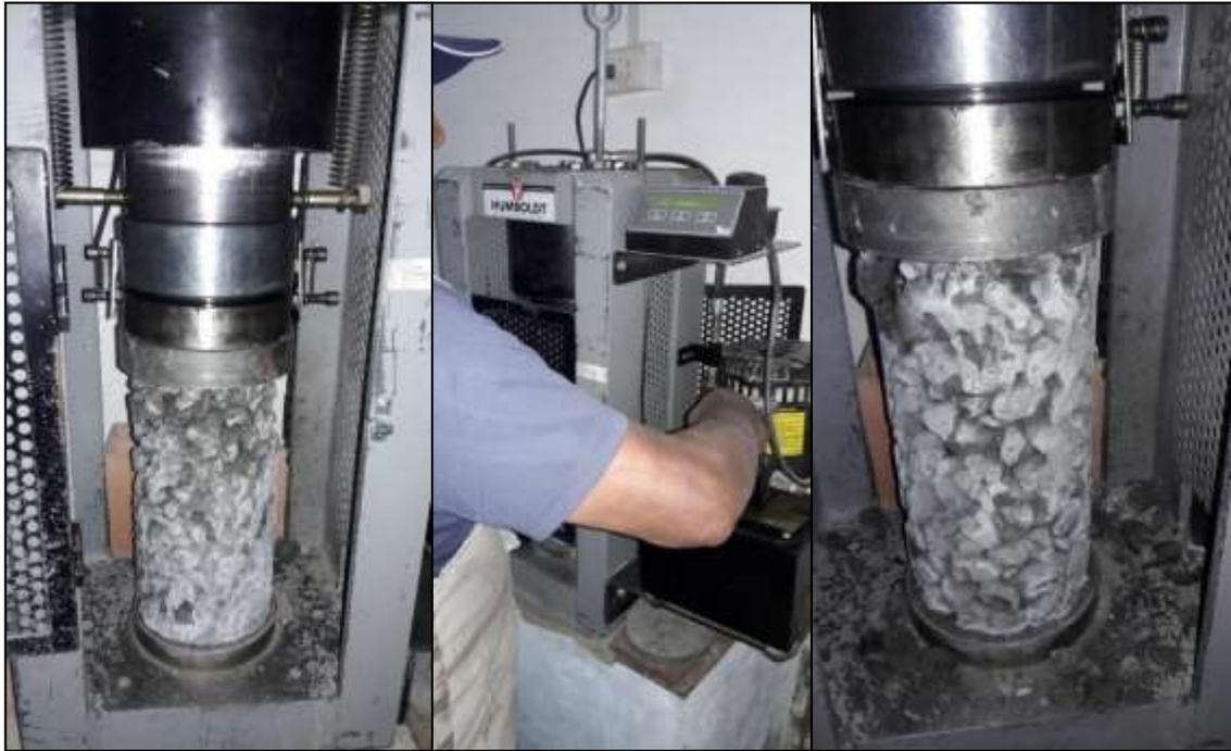
**Imagen21.- Ensayos de Resistencia a la compresión del diseño experimental (10% de agregado fino).**
