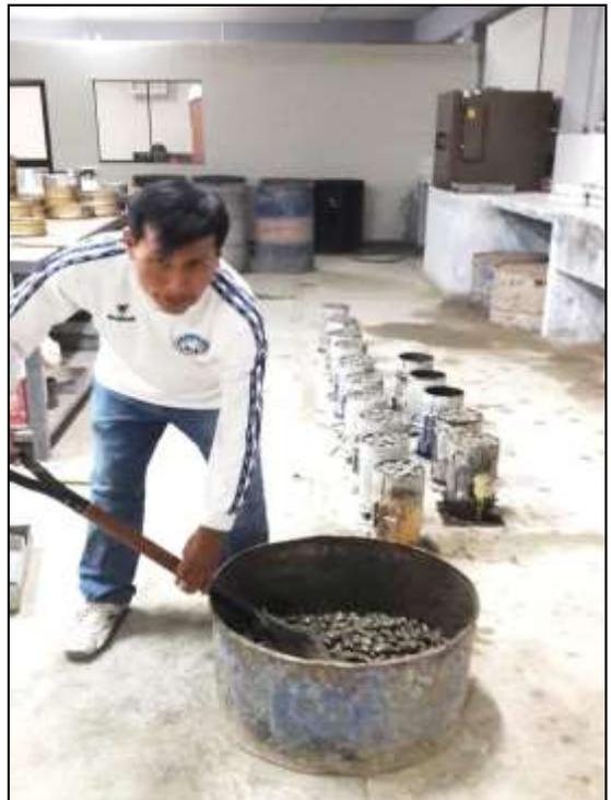
Imagen 14. Preparado de la mezcla de concreto para la colocación en probetas.
