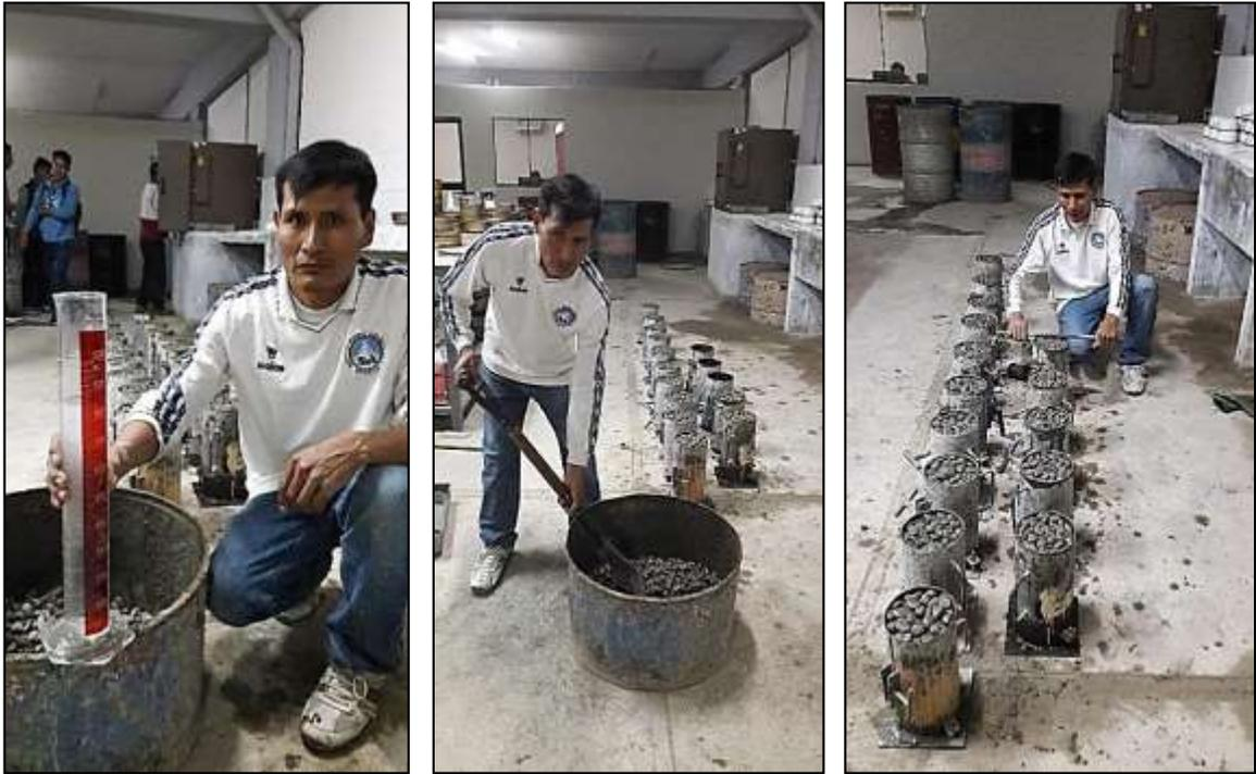
Imagen 15.- Preparación y colocación de mezcla en probetas.
