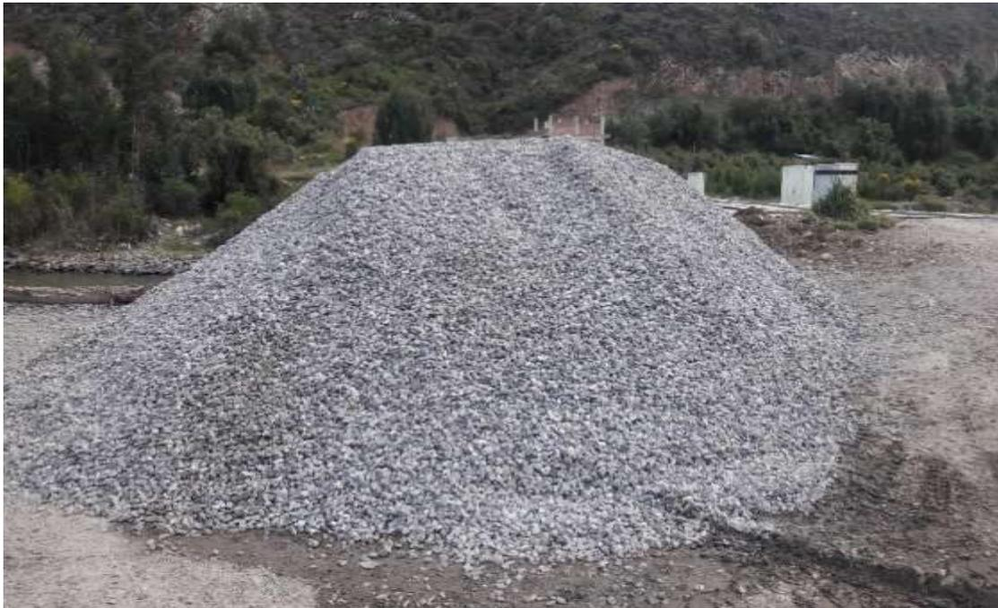
*Imagen 1.- Agregado grueso ½ utilizado de la cantera - Pariahuanca - Taricá”*
