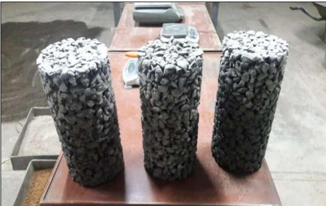
Imagen 20.- Secado de especímenes x 24 horas antes de la rotura, diseño experimental 10% de agregado fino.
