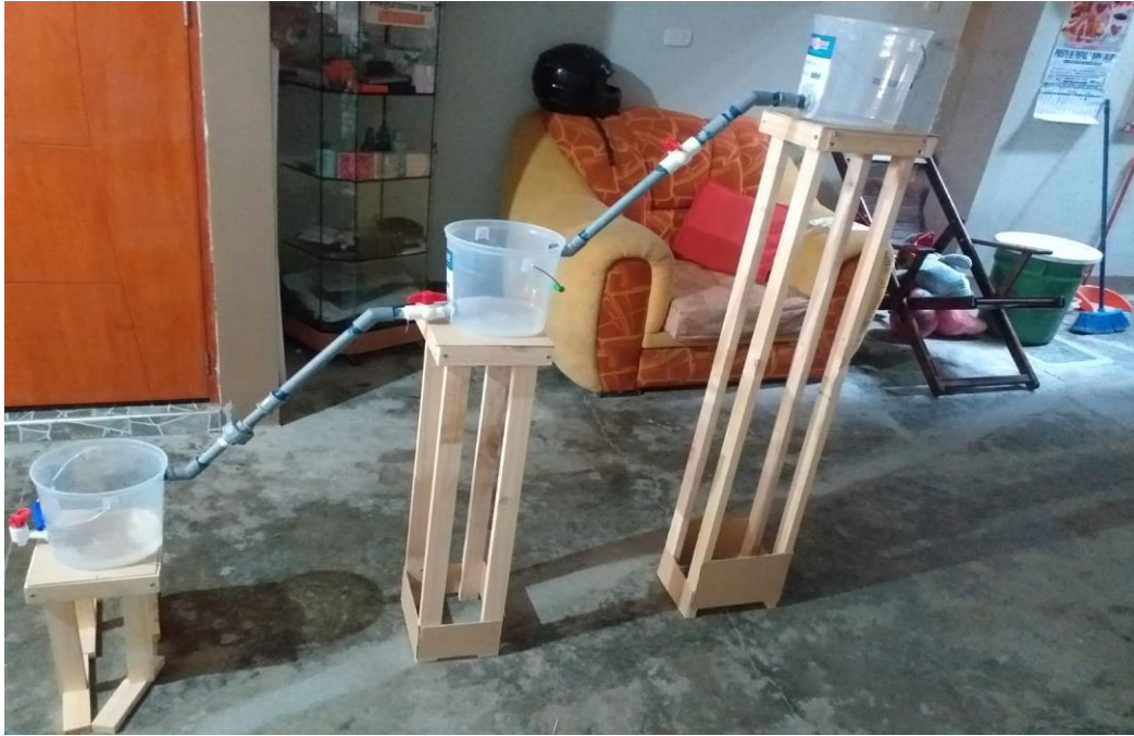
Figura 23. Armado estructural del biofiltro.
