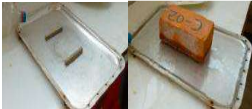
Figura 39. Prueba de succión de unidad en 1 minuto.
