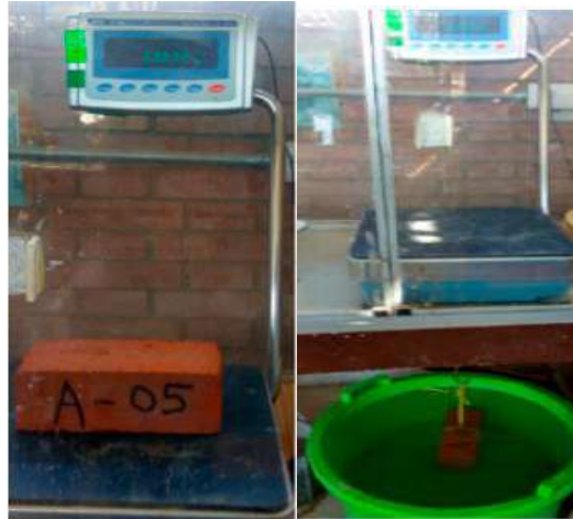
Figura 42. Peso saturado en ebullición y peso sumergido.
