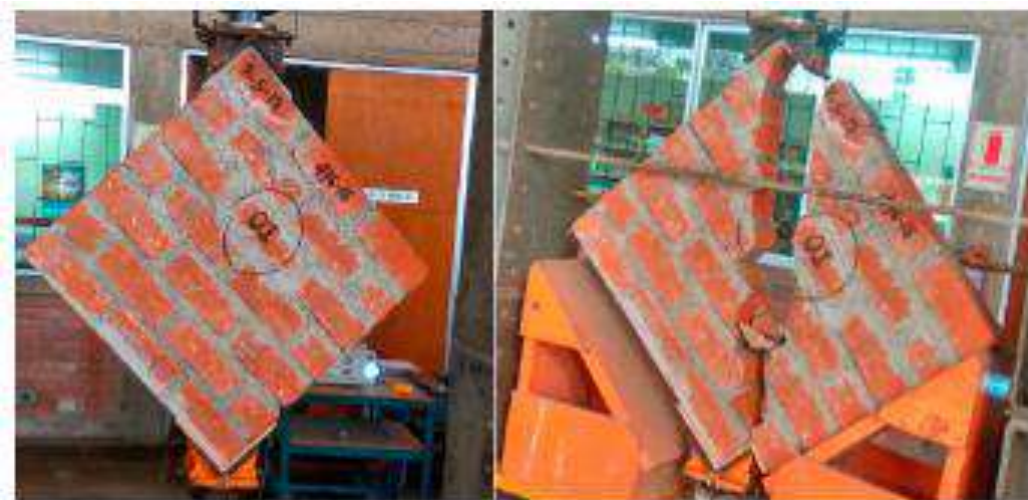
Figura 51. Falla típica del murete 01
