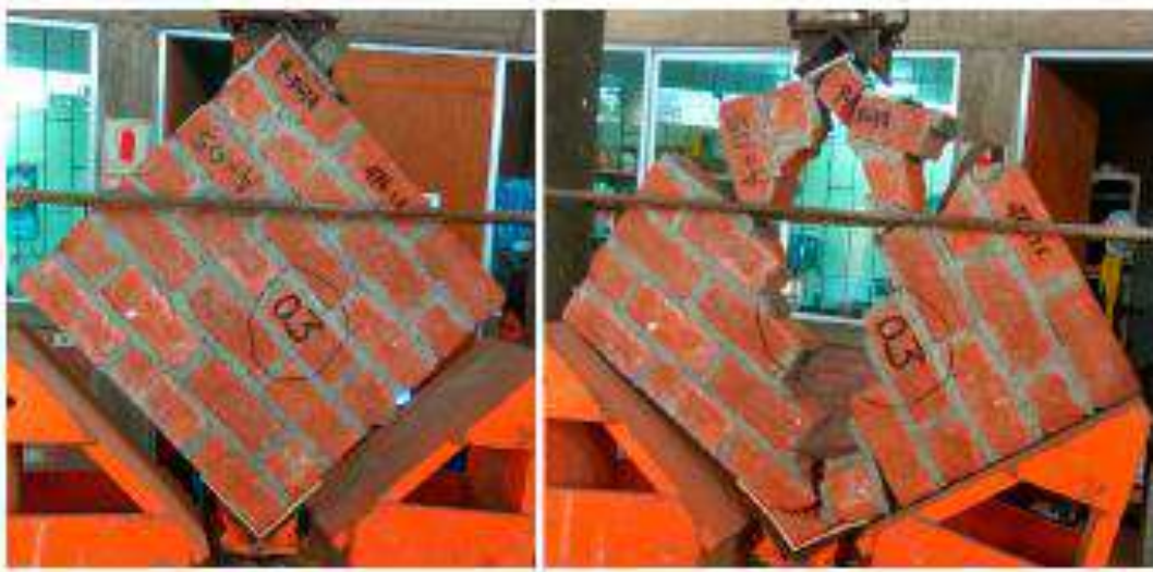
Figura 53. Falla típica del murete 03
