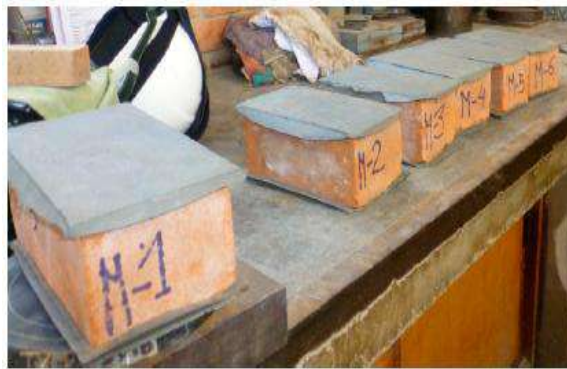
Figura 37.- Preparación de capping.
