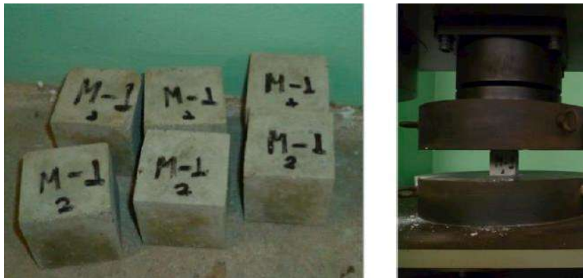
Figura 43.- Especímenes de mortero y Ensayo de compresión en cubos de mortero.
