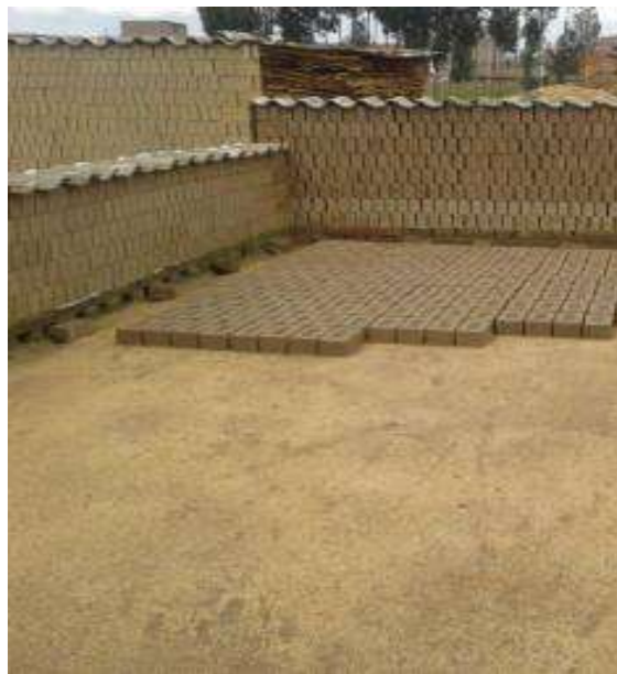
Figura 32. Secado de ladrillos.
