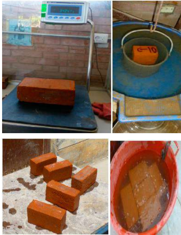
Figura 40.- Ensayo de absorción, peso de la unidad saturado y sumergido.
