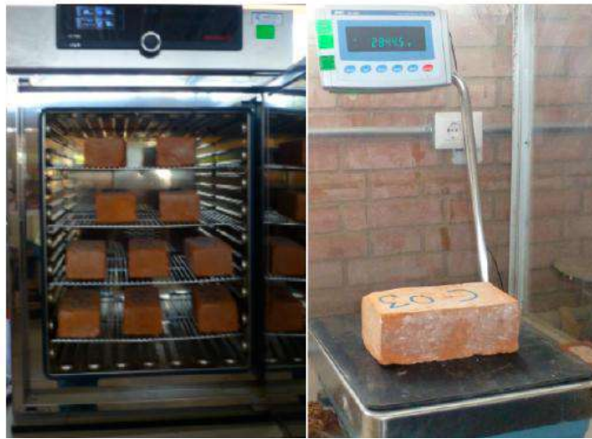
Figura 38.- Secado en horno eléctrico y pesado de unidades.
