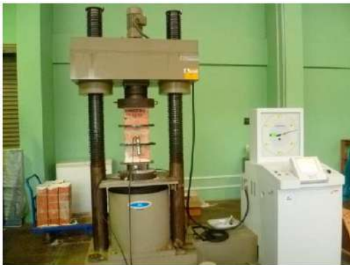
Figura 45. Máquina de compresión y Sistema de adquisición de datos.
