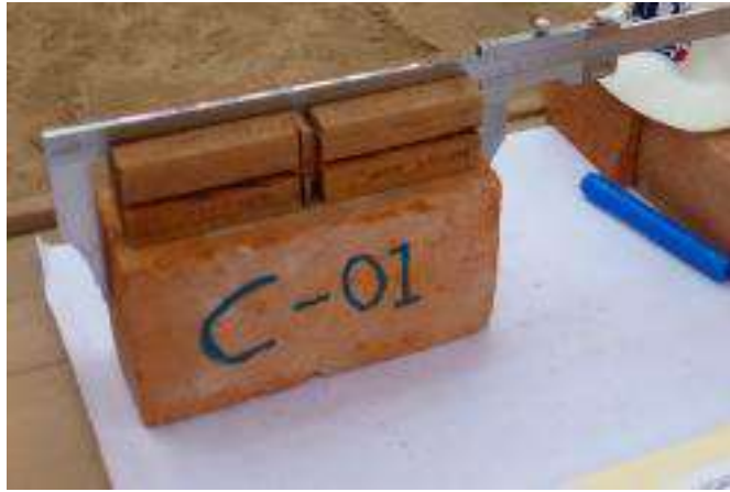
Figura 35.- Prueba de Variación Dimensional.
