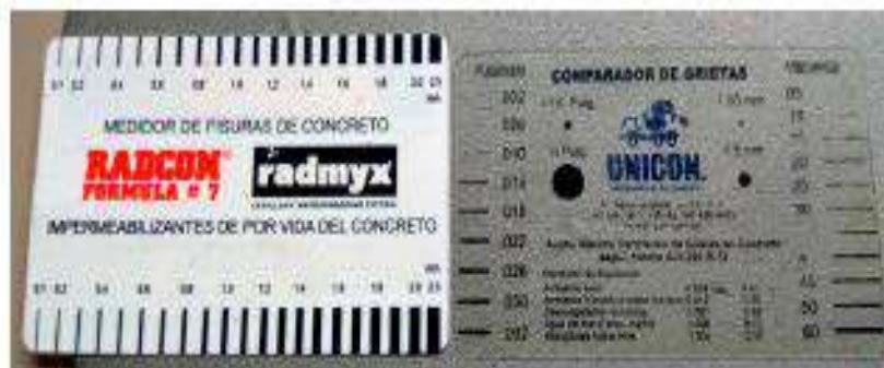
Figura 71: Grietometro para medir fisuras.
