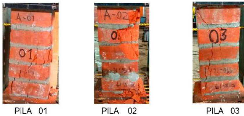
Figura 47. Pilas de albañilería ensayadas.
