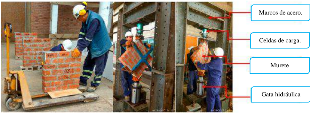
Figura 49. Traslado, colocación y ensayo de muretes.
