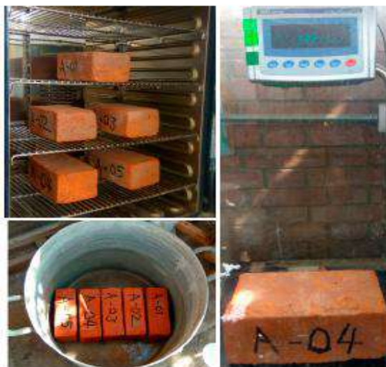
Figura 41. Ensayo de absorción máxima saturado en ebullición de 5 horas
