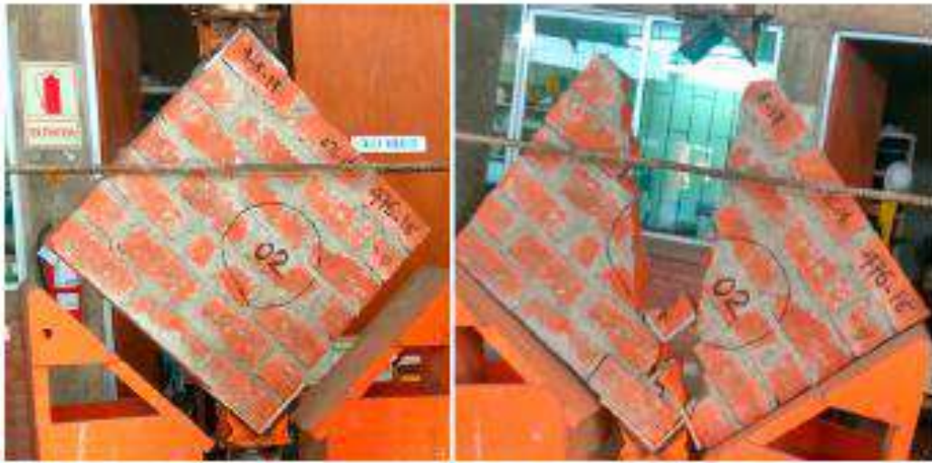
Figura 52. Falla típica del murete 02
