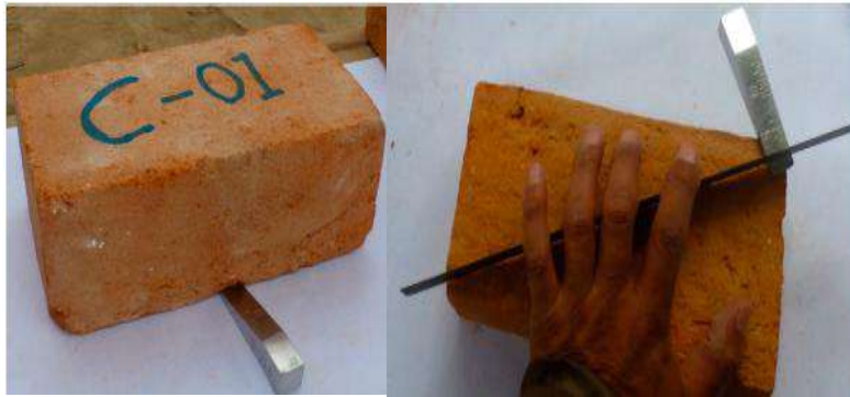
Figura 36.- Prueba de Alabeo.
