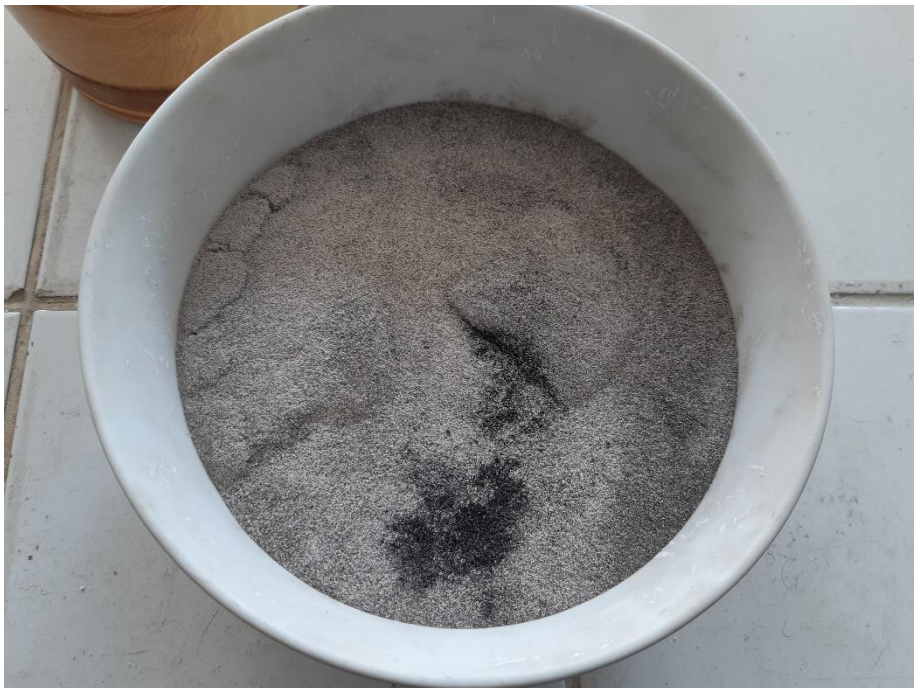
Retiro de las cenizas de cáscara de arroz luego del tiempo de calcinación
