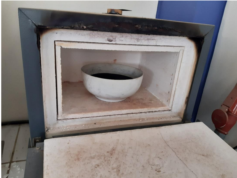
Colación de las cáscaras de arroz previa calcinación al aire libre al horno tipo mufla a 400°C por 2 horas
