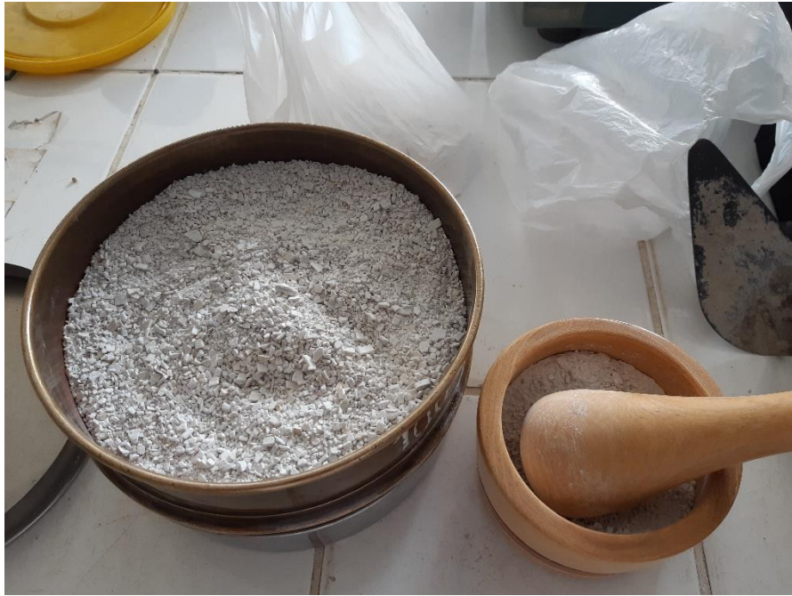
Molienda y tamizado de las cenizas de las conchas de almeja
