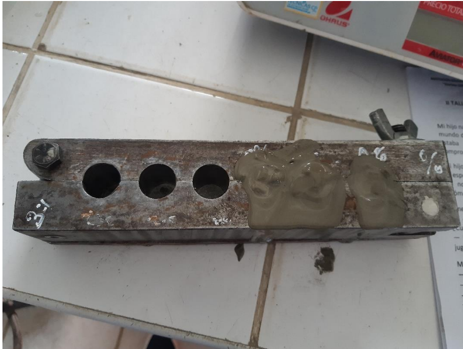
Vaciado de la pasta en los moldes cilíndricos 2cm diámetro por 4 cm de altura
