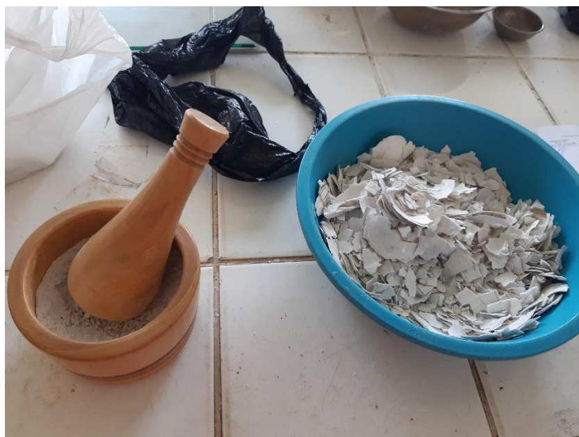
Trituración de las conchas de almeja después de 24 horas de haberse calcinado
