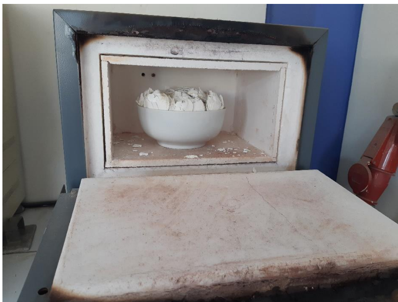
Proceso de calcinación de las conchas de almejas a 750°C
