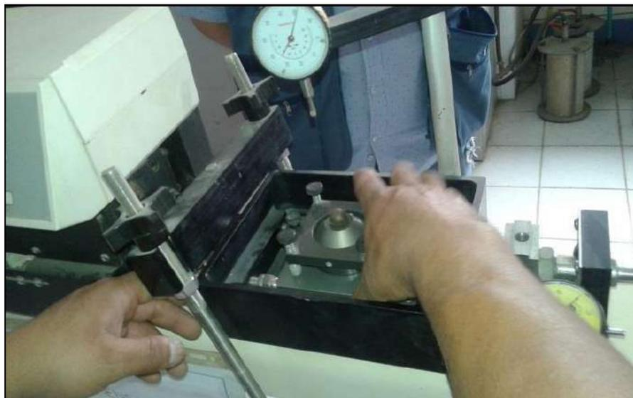
*Figura.* Colocación de celda en equipo de corte directo.
