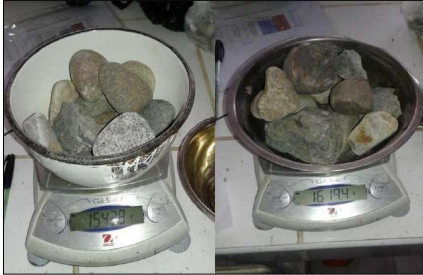
**Figura.** Pesaje de las dos muestras en balanza electrónica y finalización del ensayo de Gravedad Específica y Absorción de Roca Arenisca.
