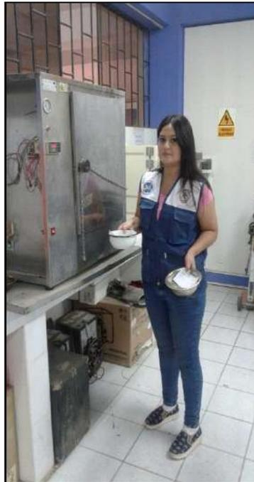
**Figura.** Luego llevamos las dos muestras al horno durante 24 horas, para al día siguiente realizar un nuevo pesaje.
