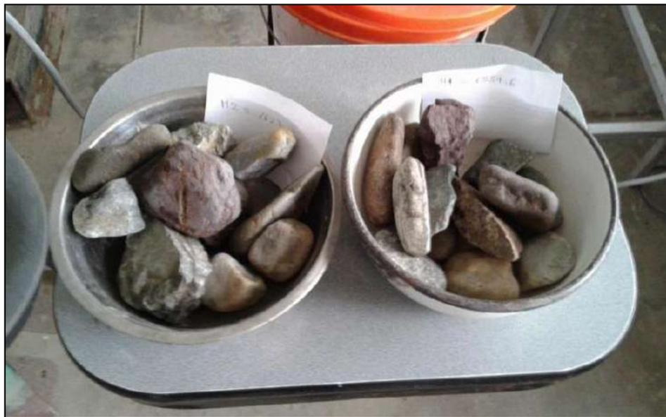
*Figura.* Ya secas las piedras, las dividiremos en dos taras aproximadamente de 1 kg y luego las pesaremos en balanza electrónica.
