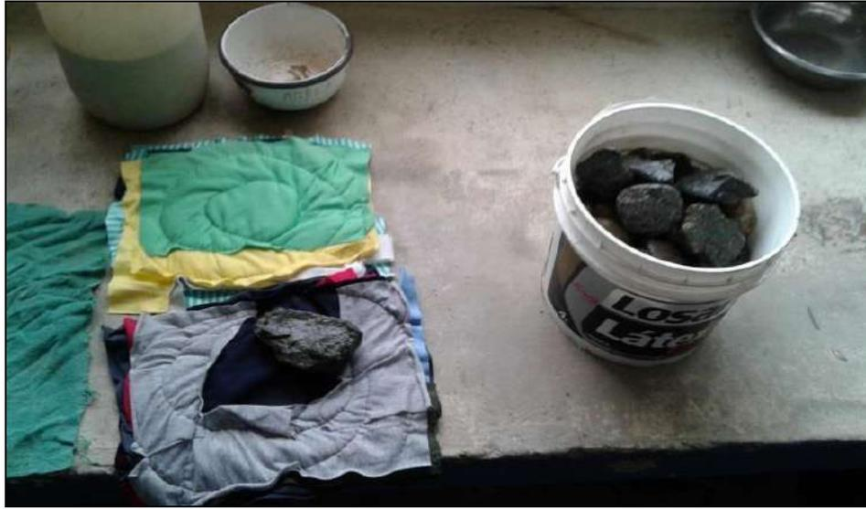
*Figura.* Luego de haber cumplido las 24 horas, retiramos el agua y secamos cada piedra con un trapo, hasta que este deje de brillar.
