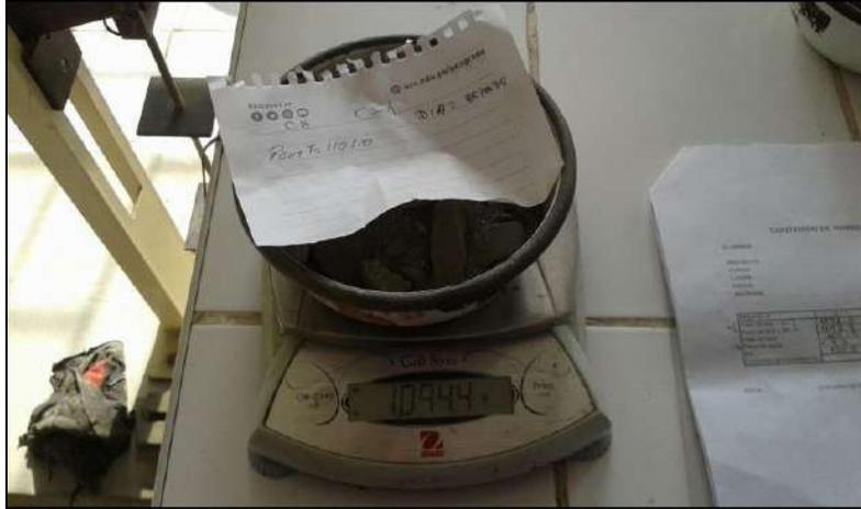
*Figura.* Llevamos a balanza electrónica y pesamos cada tara de muestra húmeda.
