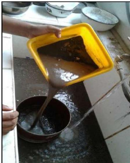
*Figura.* Con ayuda de la malla N° 200, realizamos el lavado y colado de las dos muestras.
