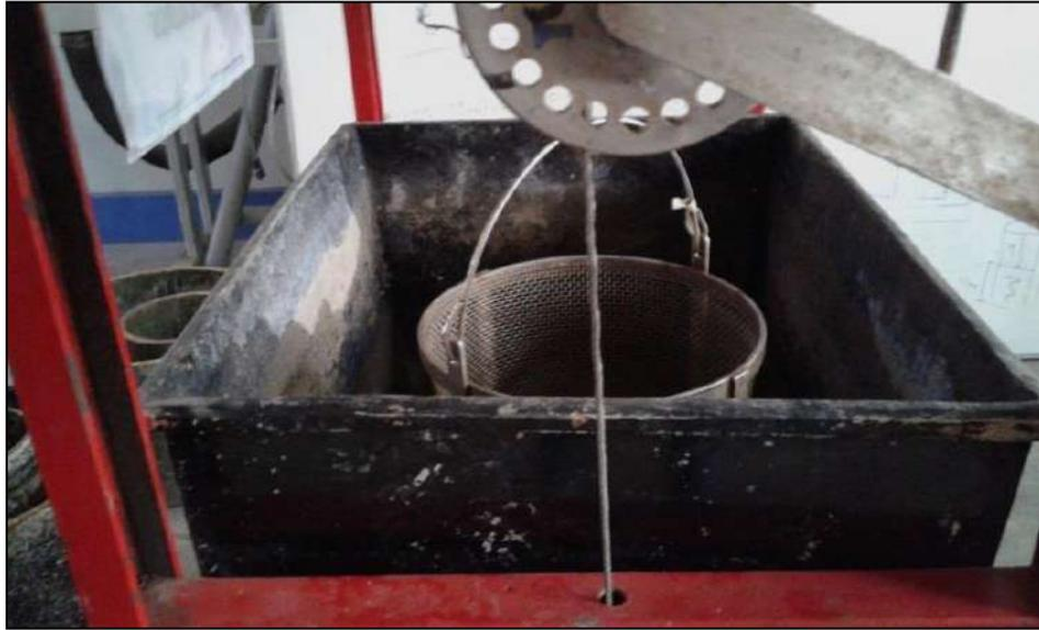
**Figura.** Luego del pesaje, llevaremos las taras al equipo de ensayos de pesos específicos de materiales, introduciremos cada tara de muestra al balde enmallado y sumergiremos en el estanque con agua.
