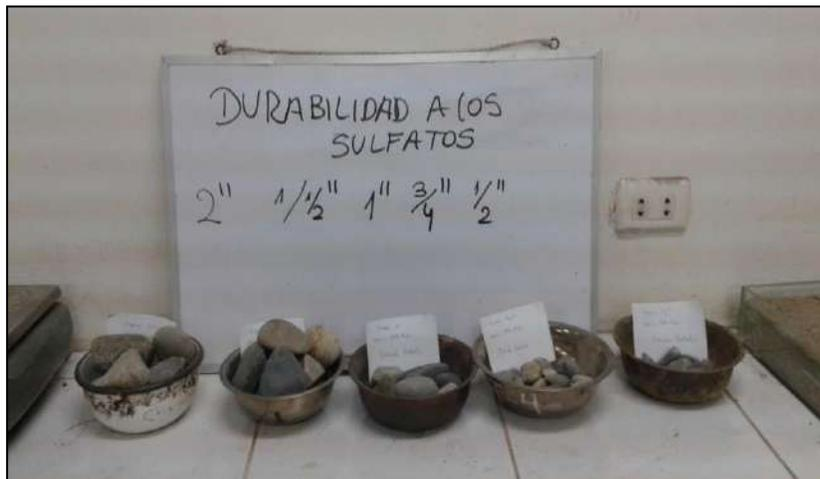
**Figura.** Para el ensayo de durabilidad al sulfato de magnesio, emplearemos las mallas y pesajes retenidos en los tamices: 2 1/2”, 2”, 1 1/2”, 1”, 3/4”, 1/2” los cuales se retuvieron en los tamices señalados en pizarra, luego se colocaron en taras respectivamente y se agregó el sulfato hasta cubrir la muestra por un tiempo de 4 días.
