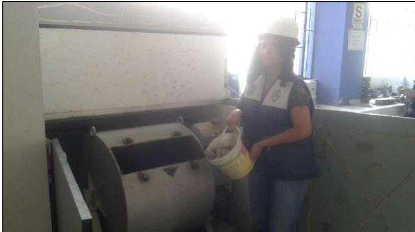
**Figura.** Insertamos la muestra ya pesada y tamizada dentro del tambor de máquina los Ángeles.
