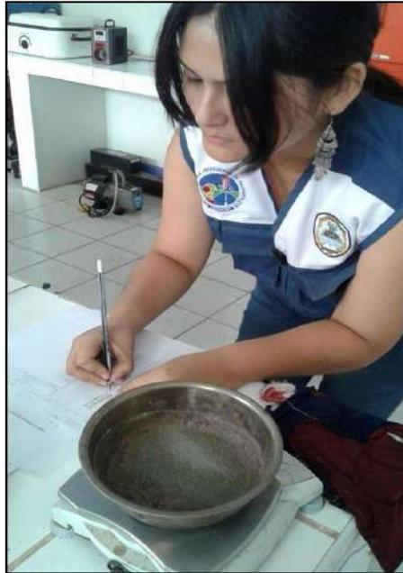
*Figura.* Para nuestro ensayo de análisis granulométrico, utilizaremos un peso de 700 g y lo colocaremos en taras.
