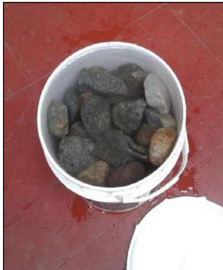
**Figura.** Para el ensayo de Gravedad Específica y Absorción de Roca Arenisca, utilizaremos un peso aproximado de 5 kg y reposaremos sumergido en un balde de agua, durante 24 horas.
