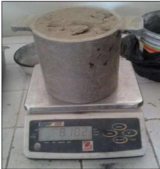
*Figura.* Ensayo de Pesos Máximos y Mínimos, el cual pesaremos la muestra en repeticiones de 5 moldes, luego extraeremos un promedio de estos 5 pesos, restando el peso del molde y dividiendo entre el volumen del molde.
