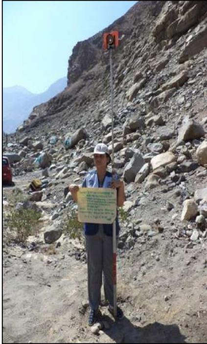
**Figura.** Toma de cota en calicata 1, profundidad 1.50 m.
