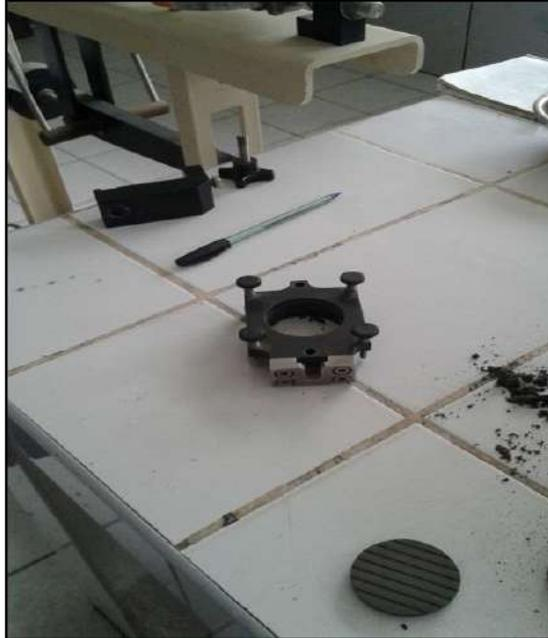
*Figura.* Vista de piedra porosa con la celda.
