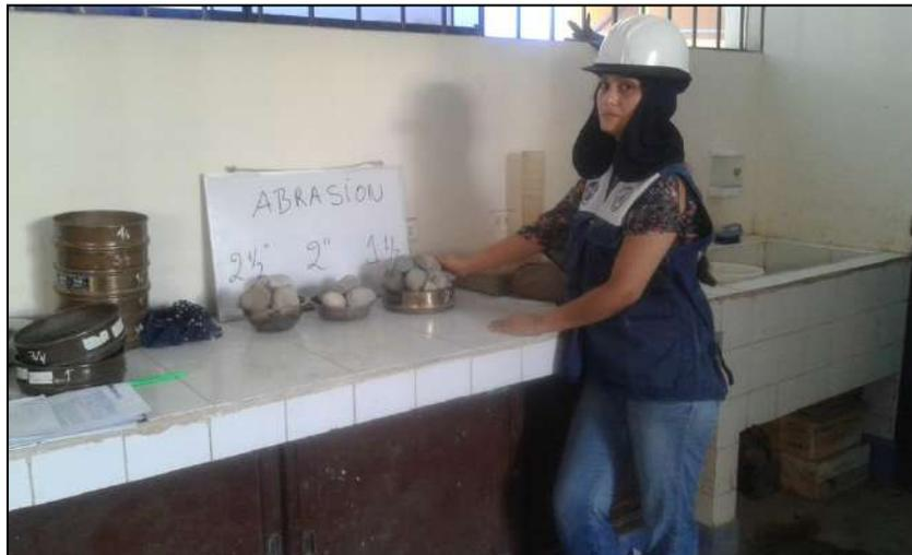
**Figura.** Para el ensayo de resistencia a la abrasión con máquina de los ángeles, emplearemos las mallas y pesajes retenidos en los tamices: 3", 2 1/2", 2", 1 1/2", los cuales se retuvieron en los tamices señalados en pizarra, luego se llevó un pesaje toda la muestra y se insertó en máquina de abrasión los Ángeles.
