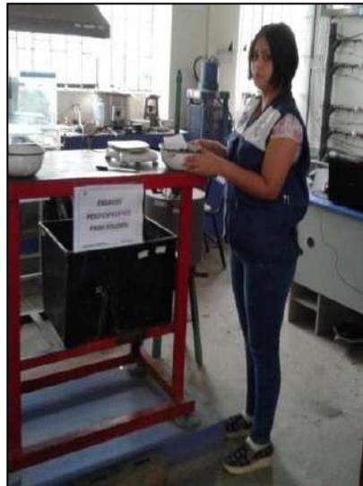
**Figura.** Retiramos la muestra de balde enmallado y pesamos, el cual será nuestro peso específico mojado.
