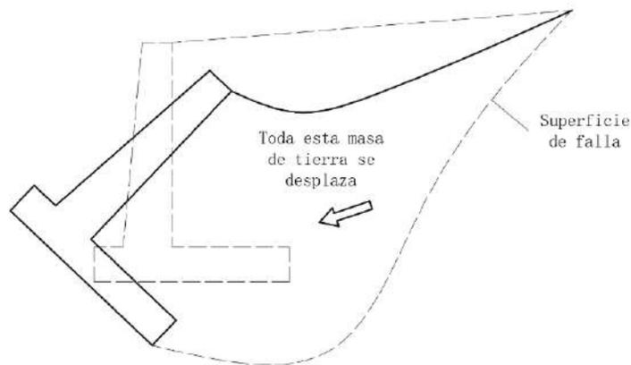
**Figura 11.** Falla generalizada en muro de contención.
