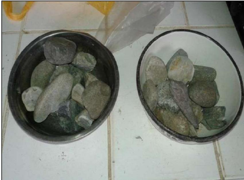
**Figura.** Ya transcurrido 24 horas, retiramos del horno las dos muestras secas para pesarlas en balanza electrónica.
