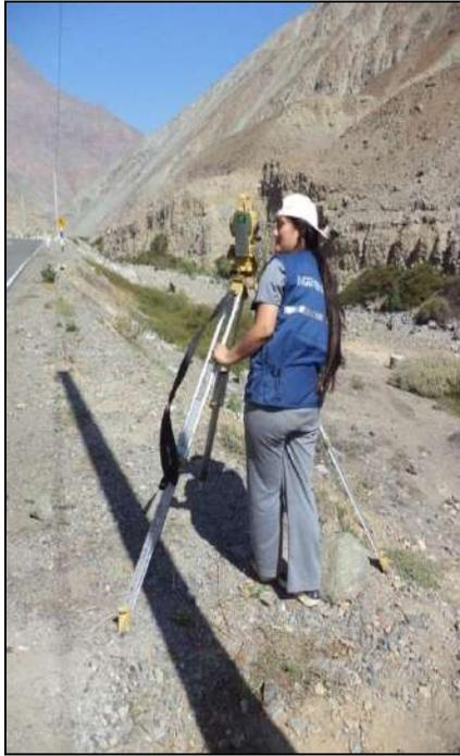
*Figura.* Segundo estacionamiento de trípode y estación total, para toma de puntos.
