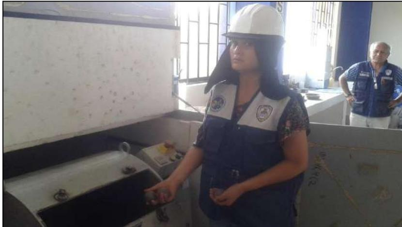
**Figura.** Insertaremos 12 esferas de acero que serán las cargas abrasivas, las cuales desgastaran el material y empezara a rotar el tambor a una velocidad de 30 r.p.m.– 33 r.p.m., el tiempo trabajado será de 32 min. Se retirara la muestra ya fragmentada, se pasara por malla 12” y lo retenido en malla se pesara, culminando así el ensayo.
