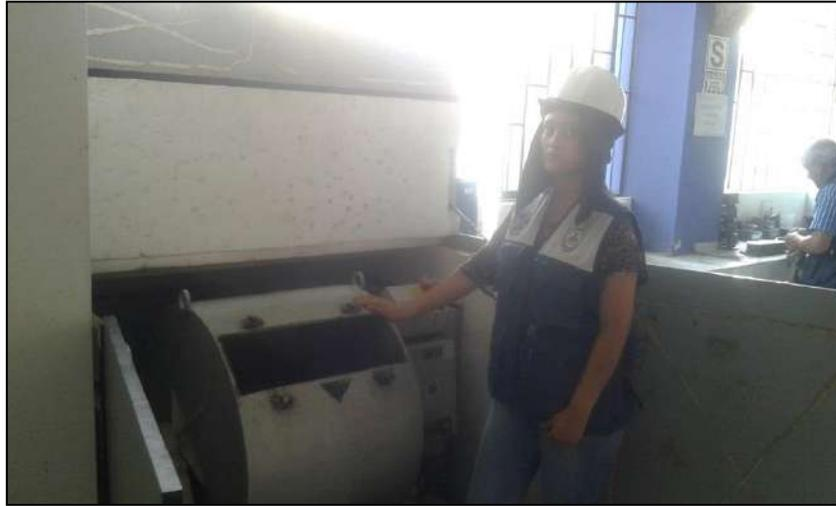
**Figura.** Máquina los Ángeles, el cual su función es determinar la resistencia de agregados a fragmentación, el equipo viene con un dispositivo electrónico contador de revoluciones, junto a un juego de esferas de acero (cargas abrasivas) de aproximadamente 47 mm de diámetro y un tambor de acero, el cual rota a una velocidad de 30 r.p.m. - 33 r.p.m.
