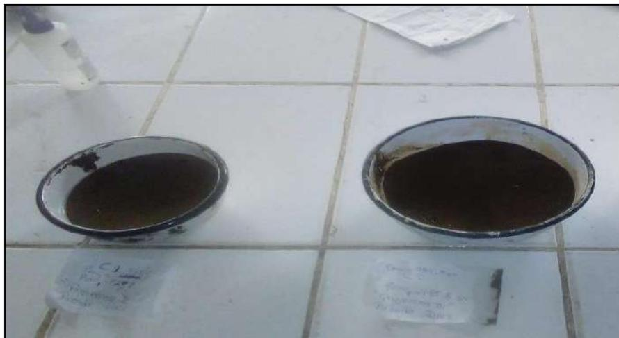
**Figura.** Teniendo ya lavadas las dos muestras, se llevaran al horno durante 24 horas para su secado y tamizado.
