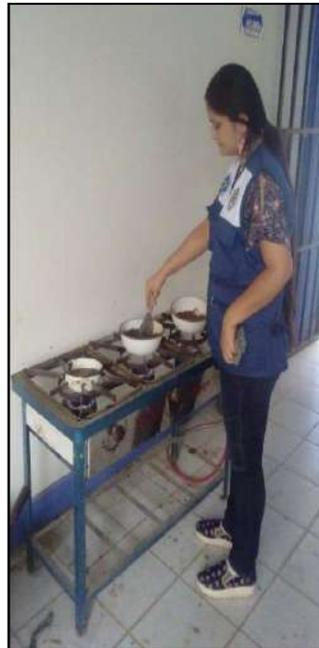
**Figura.** Luego se llevaron a la cocina para su debido secado en un tiempo aproximado de 20 min y se pesaron en balanza electrónica, culminando así el ensayo.
