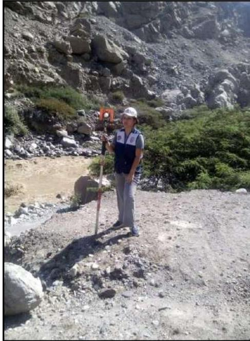
*Figura.* Toma de cotas en borde de río con jalón y prisma.
