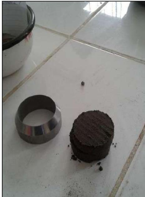
*Figura.* Corte de la muestra y finalización del ensayo corte directo.
