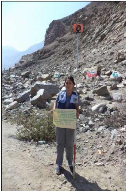
**Figura.** Toma de cota en calicata 2, profundidad 1.50 m.
