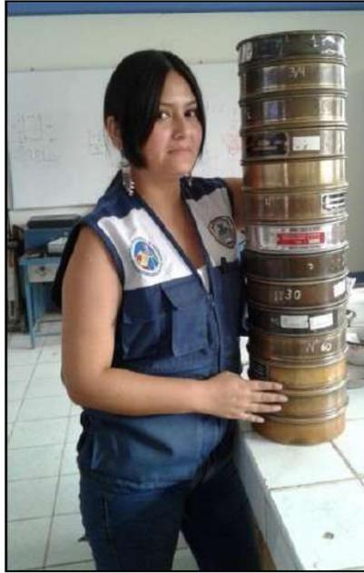
**Figura.** Luego ya secas las dos muestras, realizamos la granulometría en los tamices:  $\frac{3}{4}$ ",  $\frac{1}{2}$ ",  $\frac{3}{8}$ ",  $\frac{1}{4}$ ", N°04, N°10, N°20, N°30, N°40, N°60, N°100, N°200 y el plato (fondo).
