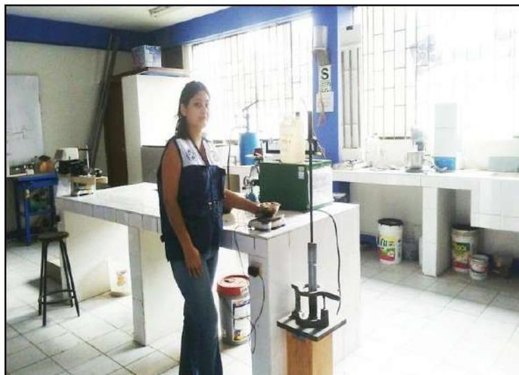
**Figura.** Al día siguiente pesamos en la balanza electrónica las dos muestras ya secas, culminando así el ensayo de contenido de humedad.
