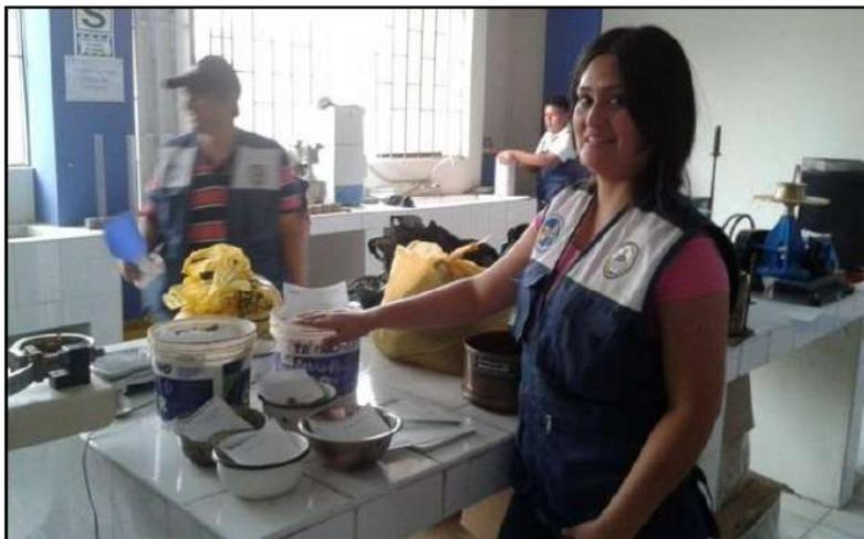
**Figura.** Extraemos de cada saco de muestra un peso aproximado de 900 g en taras, para el ensayo de contenido de humedad.
