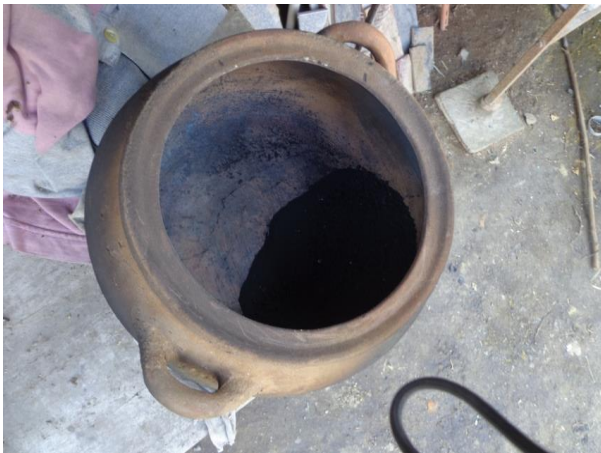
Figura 9. Pre calcinado de algas marinas en una olla de barro a fuego lento
