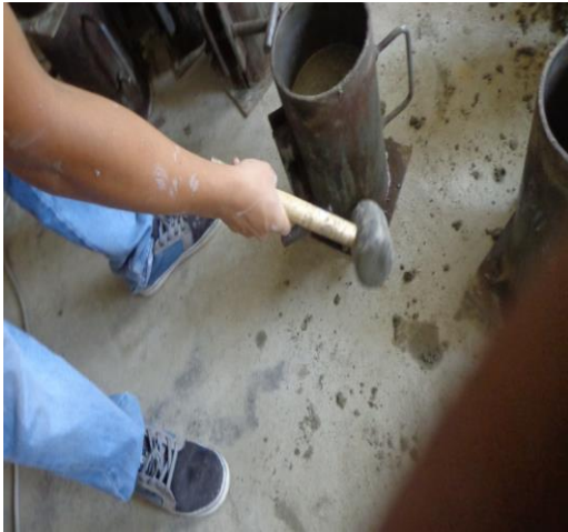
Figura 29. Golpeo con maso de hule para evitar los vacíos de aire en el concreto
