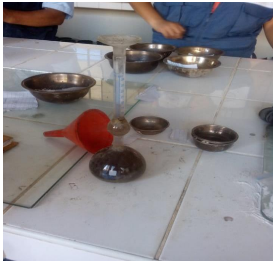
Figura 25. Peso específico del cemento más combinación de algas marinas
