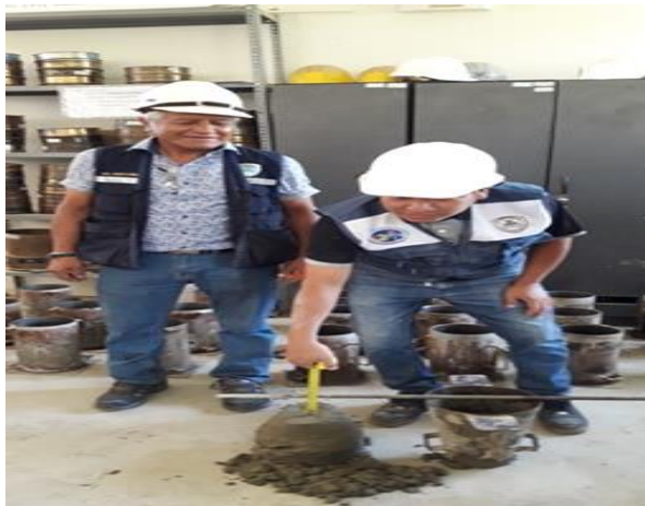
Figura 27. Hallando el slump de nuestro concreto.
