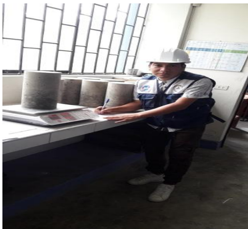
Figura 30. Tomando el peso de las probetas después del desencofrado
