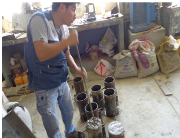
Figura 28. Varillado de las probetas (chuceada)
