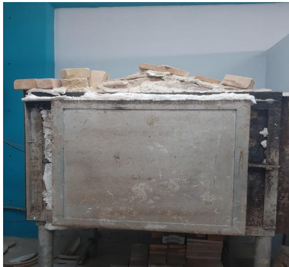
Figura 12. Horno para calcinación de nuestra muestra de la UNT
