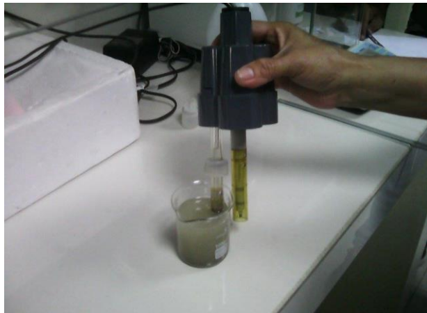
Figura 13. Hallando el pH del cemento tipo I
