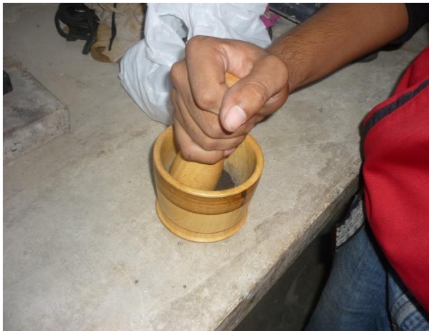
Figura 10. Uso del mortero para moler la muestra.
