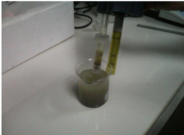
Figura 16. Hallando el pH del cemento más adición de 6% de algas marinas
