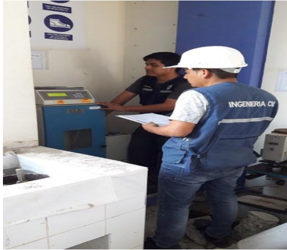
Figura 32. Ensayo de compresión de las probetas diseño patrón
