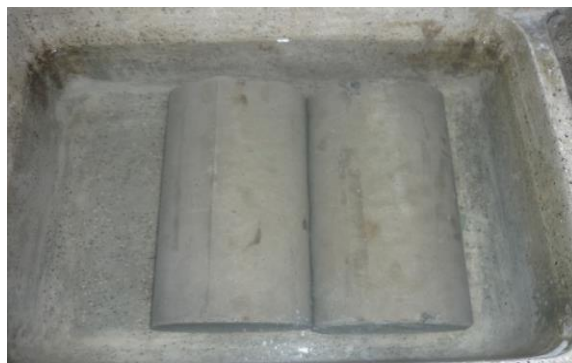
Figura 31. Curado de probetas sumergidos en agua
