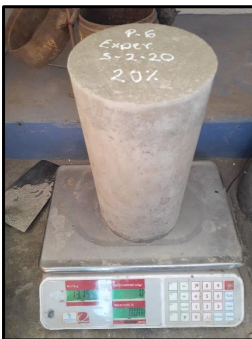
Figura N° 21: Pesos del concreto experimental al 20% de sustitución.
