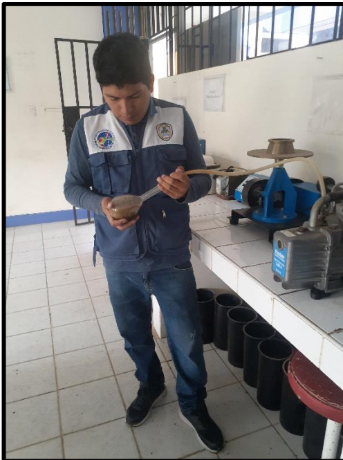
Figura N° 12: Usando el picnómetro para determinar el ensayo de absorción y gravedad específica del agregado fino.
