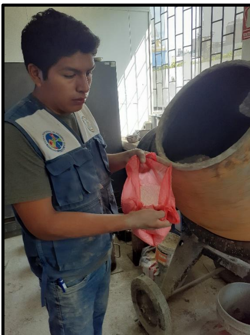
Figura N° 26: Aplicando las perlas de tecnopor en la mezcla de concreto experimental al 10% de sustitución.
