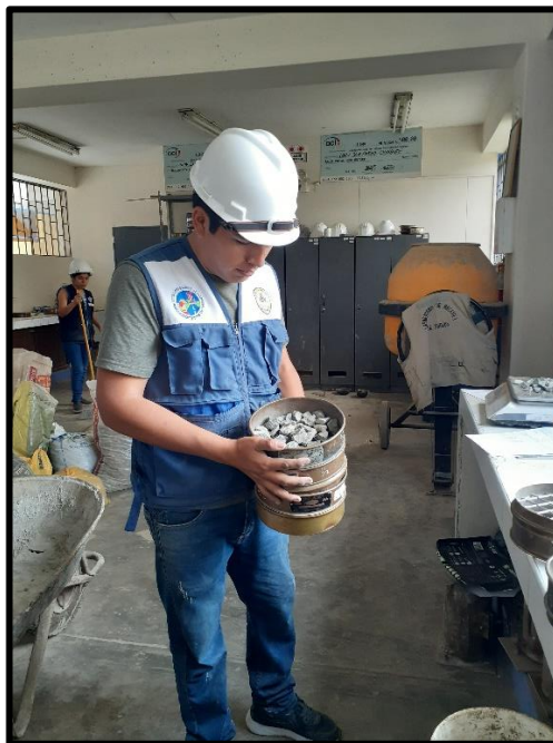
Figura N° 10: Realizando el ensayo de Granulometría al agregado grueso.
