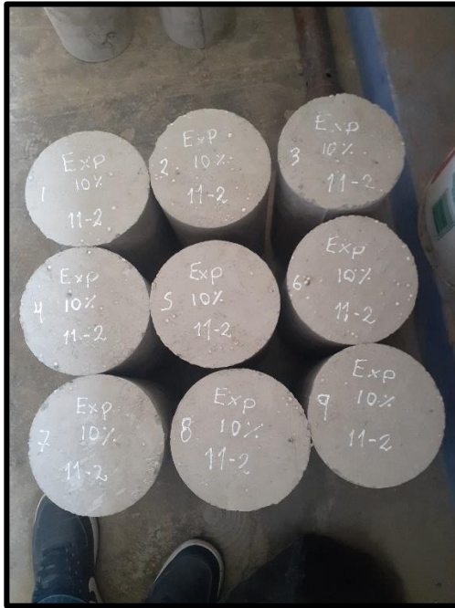
Figura N° 31: Probetas del Concreto experimental al 10% de sustitución.
