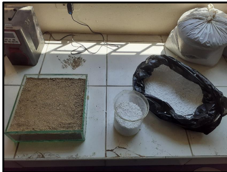
Figura N° 16: Hallando el volumen del agregado fino para sustituirlo por perlas de tecnopor.
