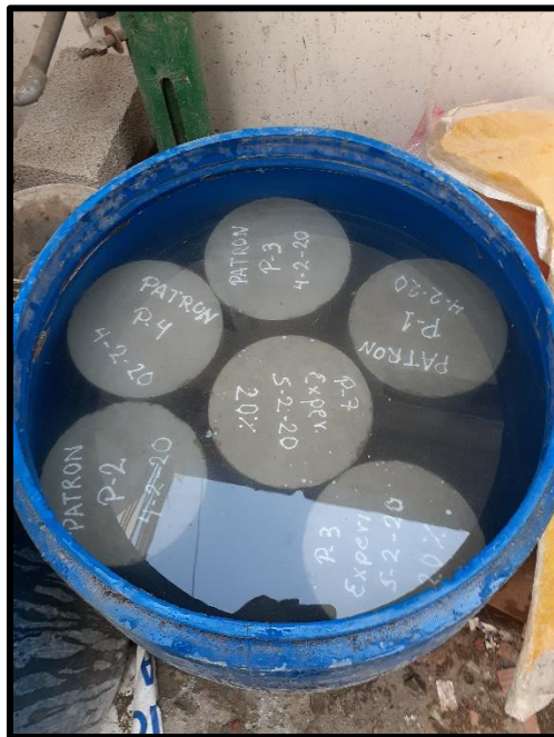
Figura N° 32: Curado de las probetas de concreto.
