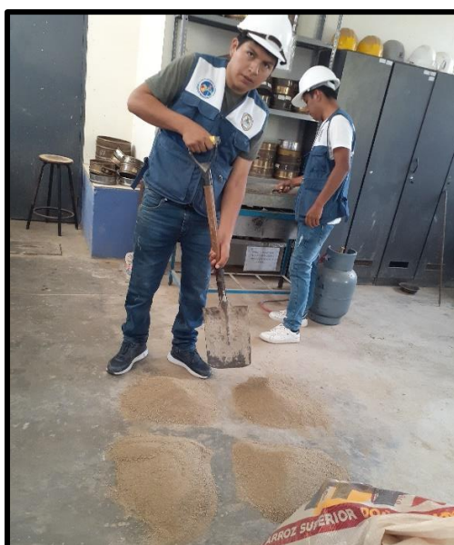
Figura N° 06: Cuarteo del agregado fino para realizar los ensayos de calidad en el laboratorio de mecánica de suelos UPS.
