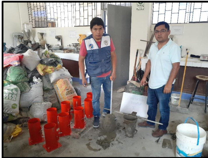
Figura N° 13: Realizando el slump al concreto patrón obteniendo 3”.
