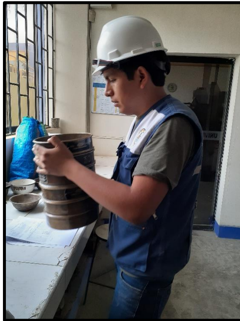
Figura N° 09: Realizando el ensayo de Granulometría al agregado fino.
