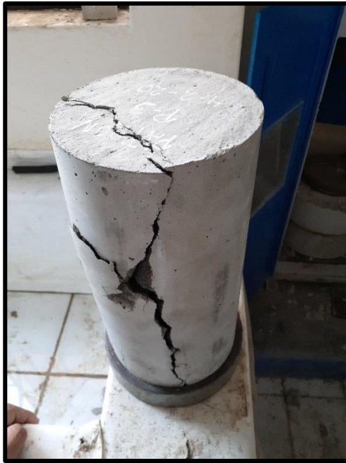
Figura N° 35: La fractura fue de tipo columnar a la probeta de concreto patrón.
