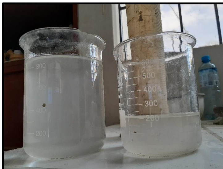
Figura N° 20: Agua sobrante del concreto experimental al 20% de sustitución.
