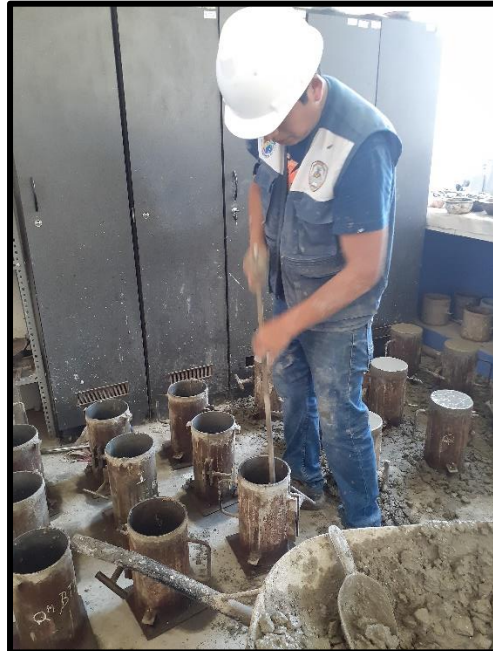
Figura N° 24: Preparación del concreto experimental al 15% de sustitución.
