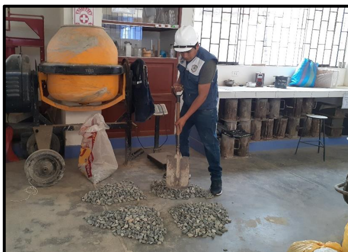
Figura N° 05: Cuarteo del agregado grueso para realizar los ensayos de calidad en el laboratorio de mecánica de suelos UPS.
