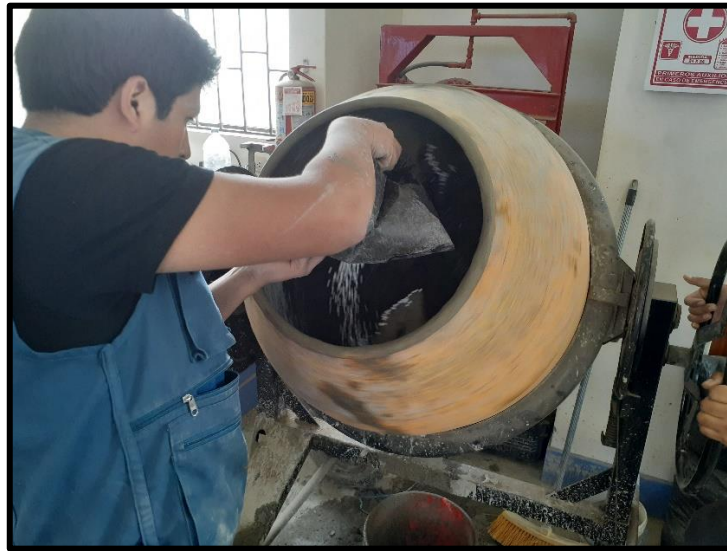
Figura N° 17: Aplicando las perlas de tecnopor en la mezcla de concreto experimental al 20% de sustitución.
