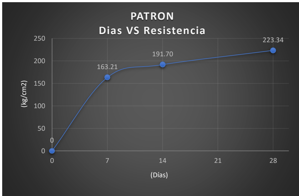
Figura 05. Curva del concreto patrón (Días vs Resistencia)
