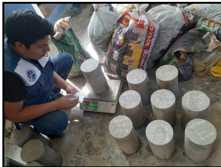
Figura N° 14: Pesando las probetas del concreto patrón.
