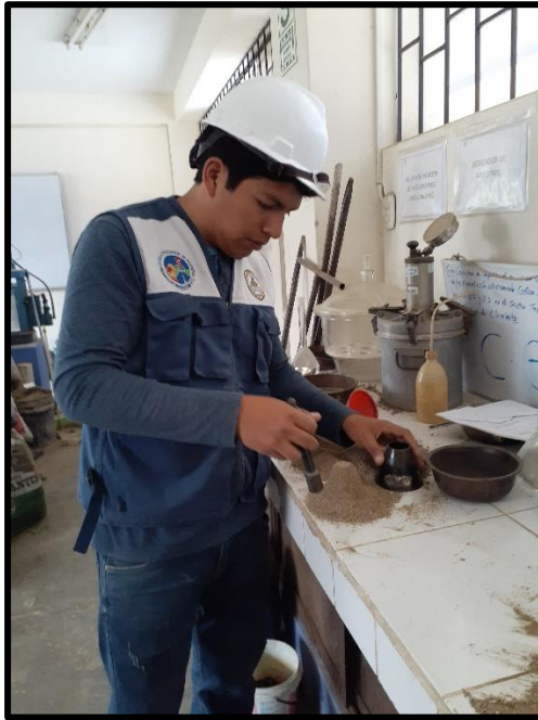
Figura N° 11: Realizando el ensayo de absorción y gravedad específica del agregado fino.
