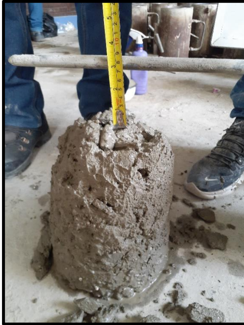
Figura N° 27: Realizando el slump al concreto experimental al 10% de sustitución obteniendo 3”.
