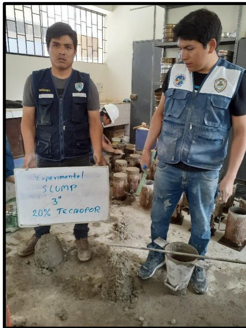
Figura N° 18: Realizando el slump al concreto experimental al 20% de sustitución obteniendo 3\"/>
