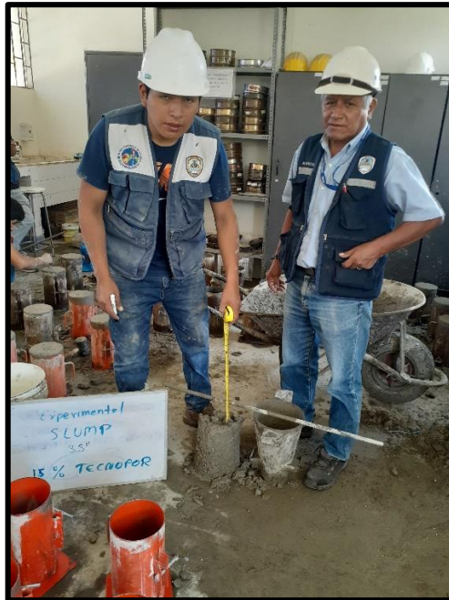
Figura N° 23: Slump al concreto experimental al 15% de sustitución obteniendo 3”.
