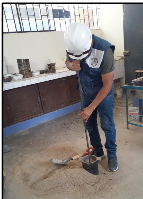
Figura N° 08: Realizando el ensayo de Peso Unitario suelto y compactado del agregado fino.
