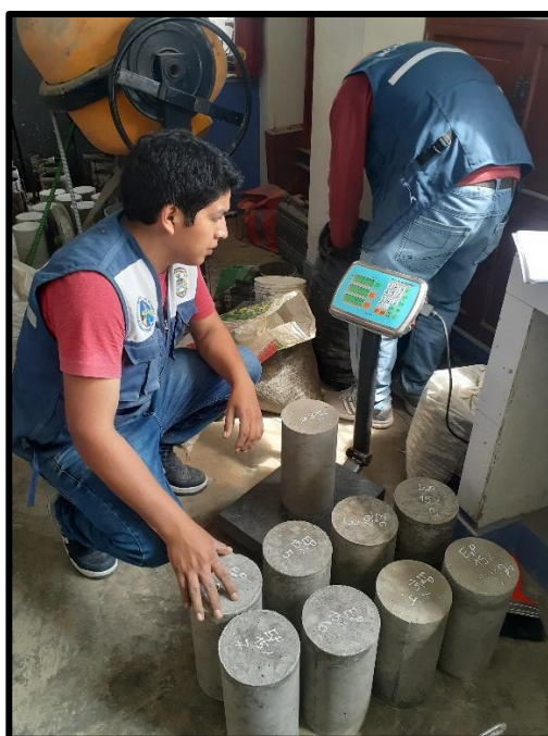
Figura N° 30: Pesos del concreto experimental al 10% de sustitución.
