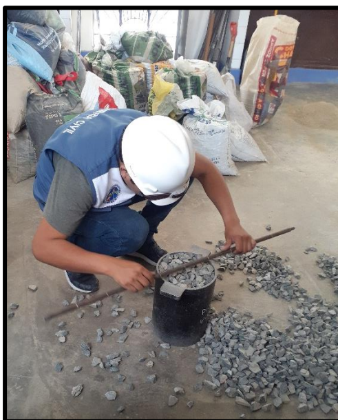
Figura N° 07: Realizando el ensayo de Peso Unitario suelto y compactado del agregado grueso.
