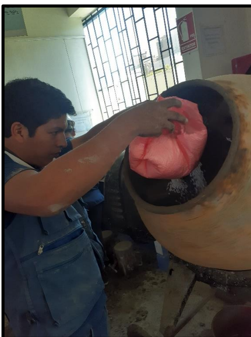
Figura N° 22: Aplicando las perlas de tecnopor en la mezcla de concreto experimental al 15% de sustitución.
