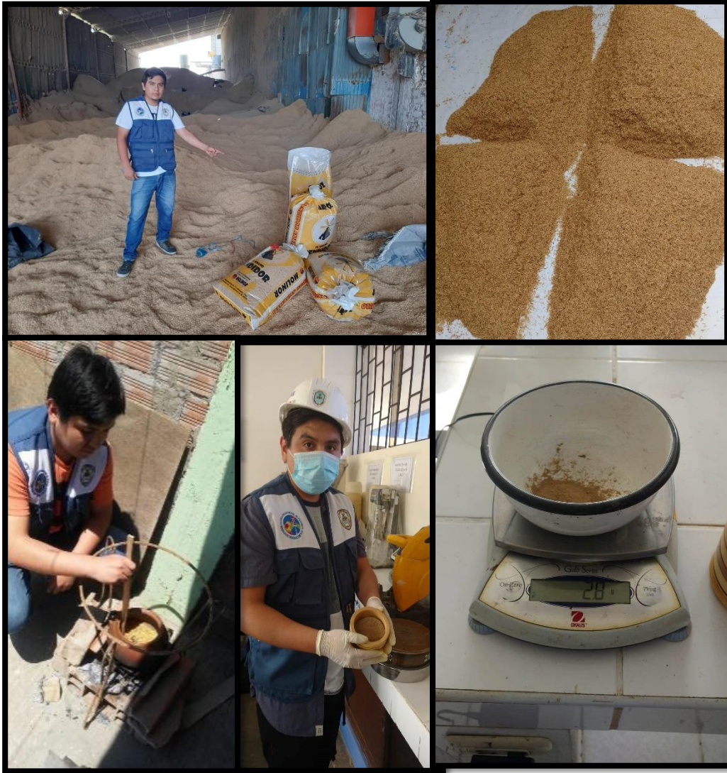
Figura 14. Proceso de obtención de muestra de cáscara de arroz para ensayo de ATD
