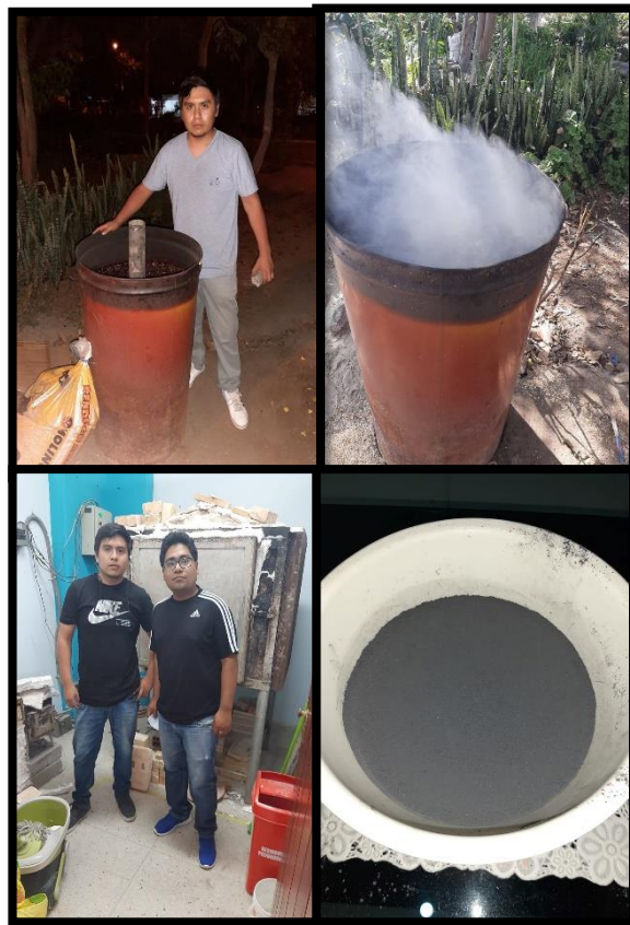
Figura 16. Pre calcinado de cáscara de arroz y calcinación a 420°C en laboratorio de cerámicos –UNT
