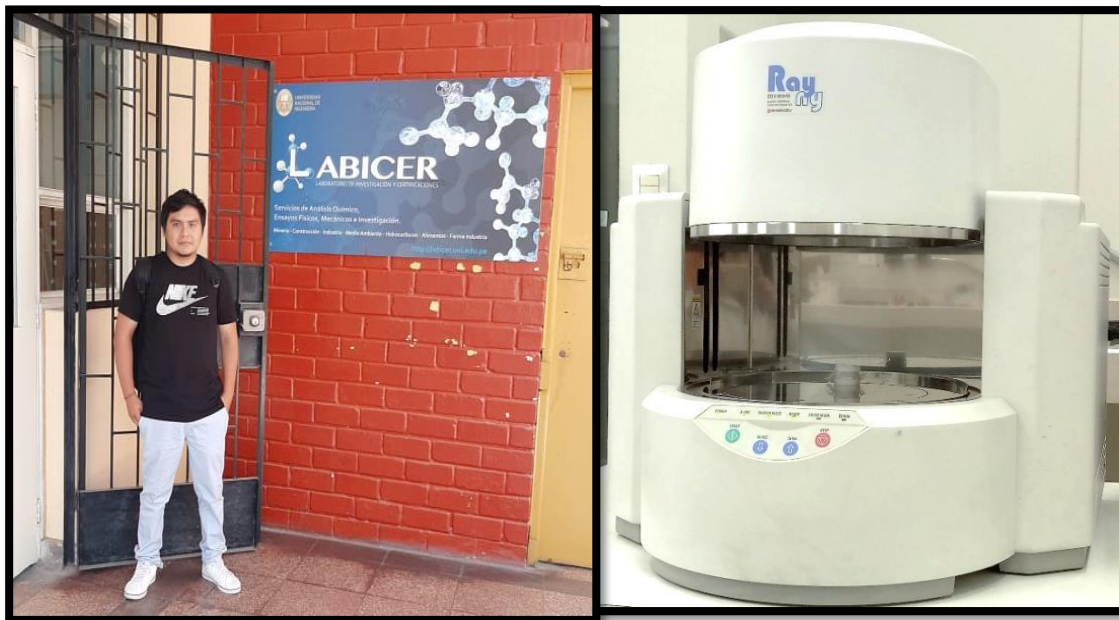
Figura 19. Espectrómetro de Fluorescencia de Rayos X de energía dispersiva, SHIMADZU, EDX 800HS. – Laboratorio LABICER - UNI
