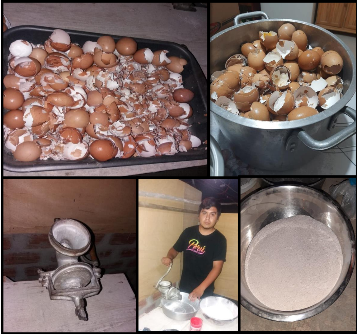
Figura 17. Pulverización de la cáscara de huevo
