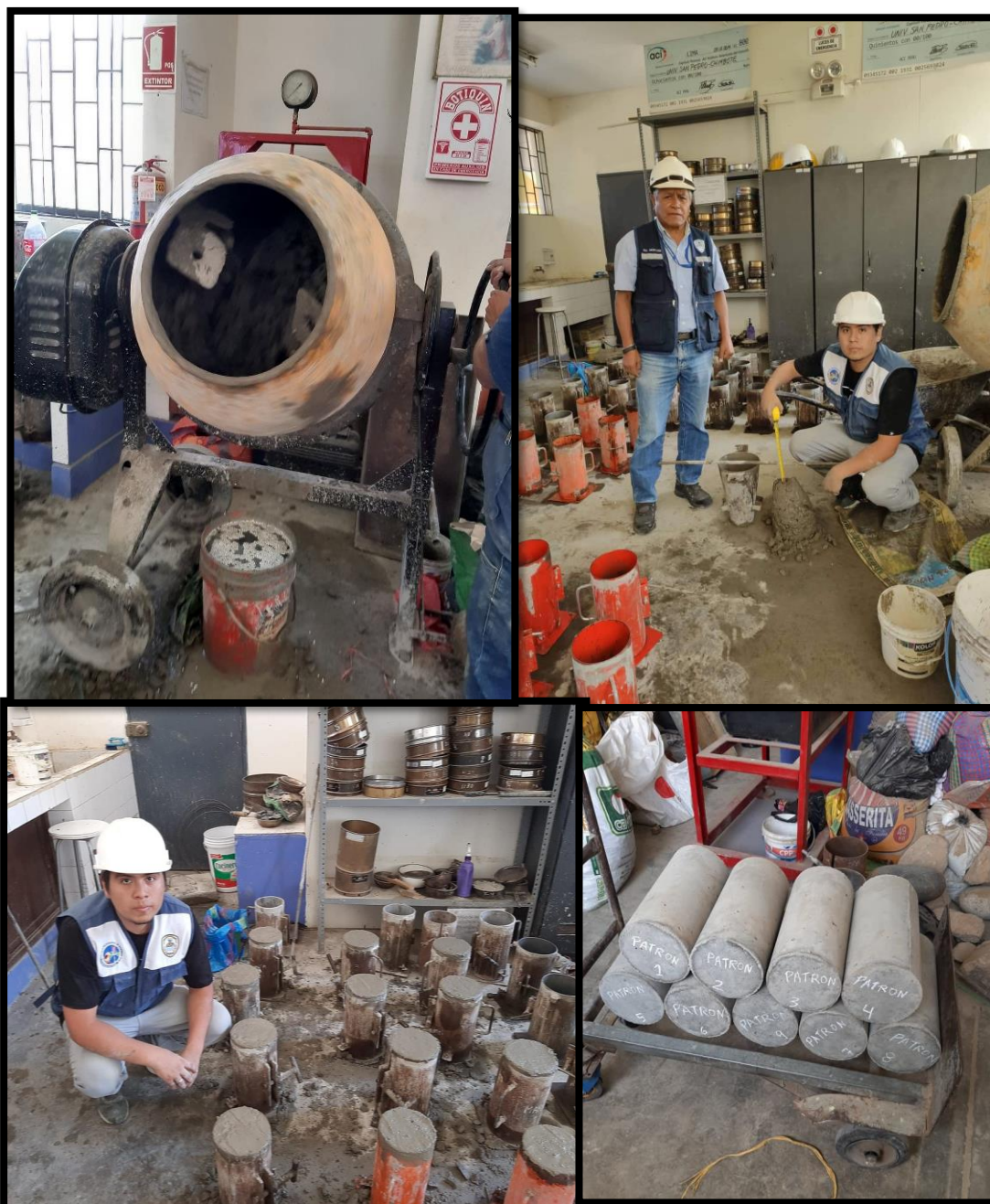
Figura 25. Elaboración de concreto patrón
