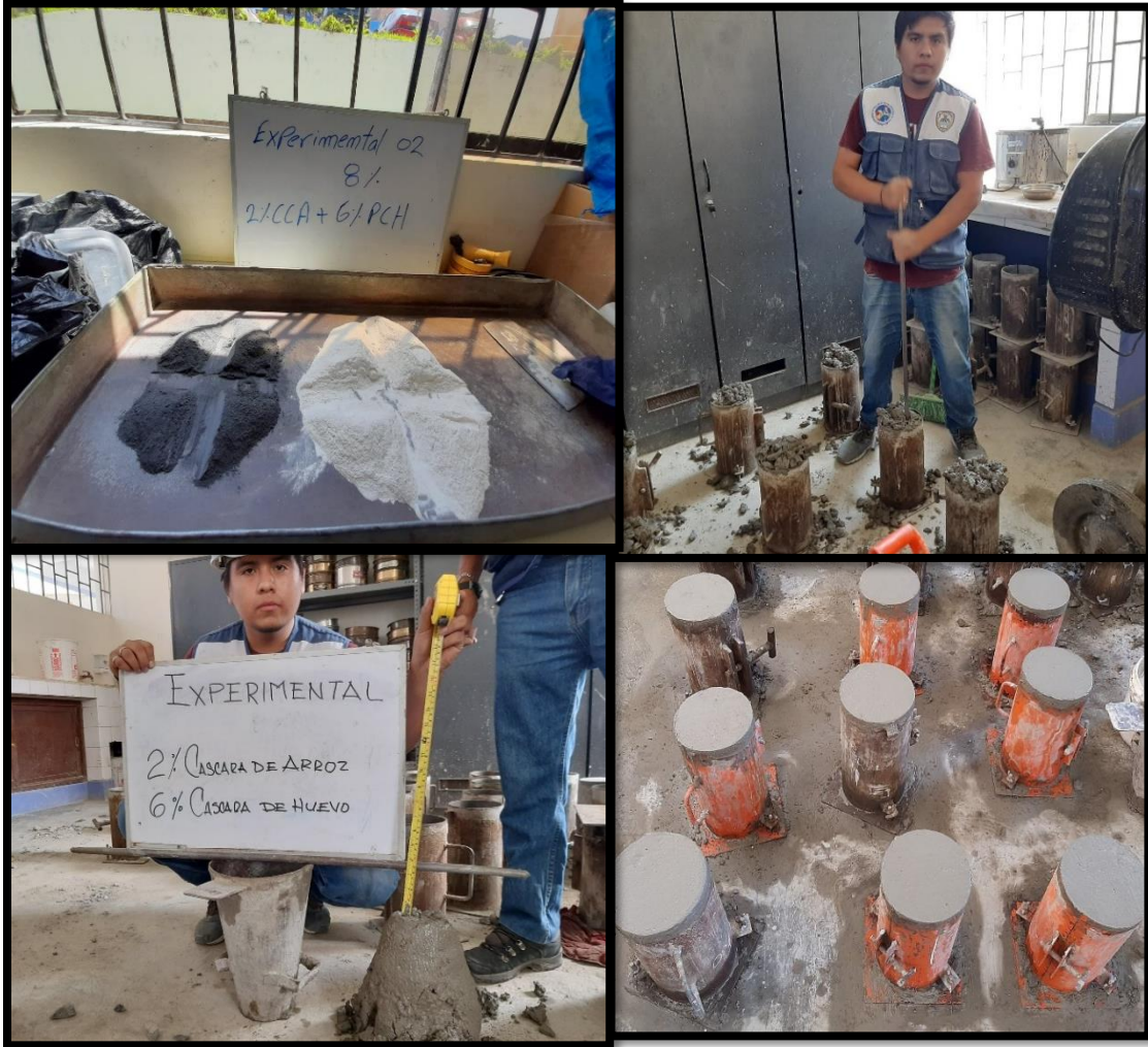
Figura 27. Elaboración de concreto experimental al 8%
