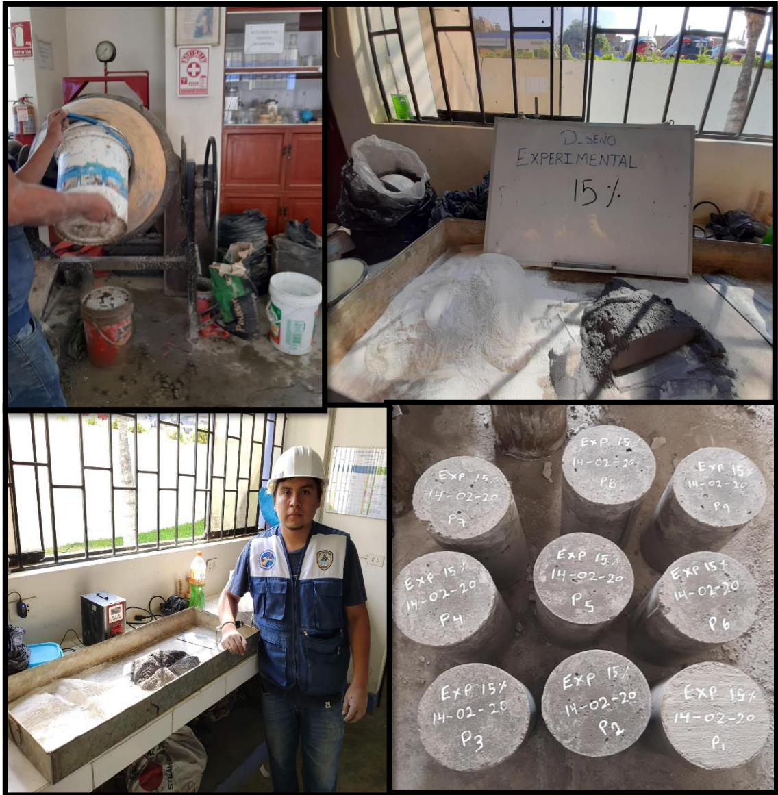
Figura 26. Elaboración de concreto experimental al 15%
