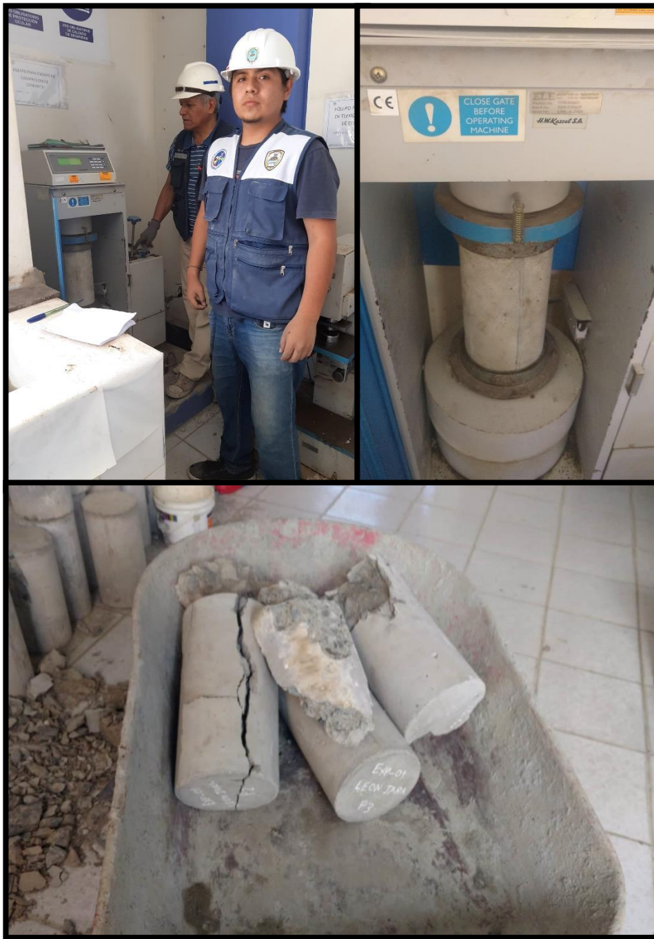
Figura 28. Ensayo de resistencia a la compresión a los 7, 14 y 28 días de curado
