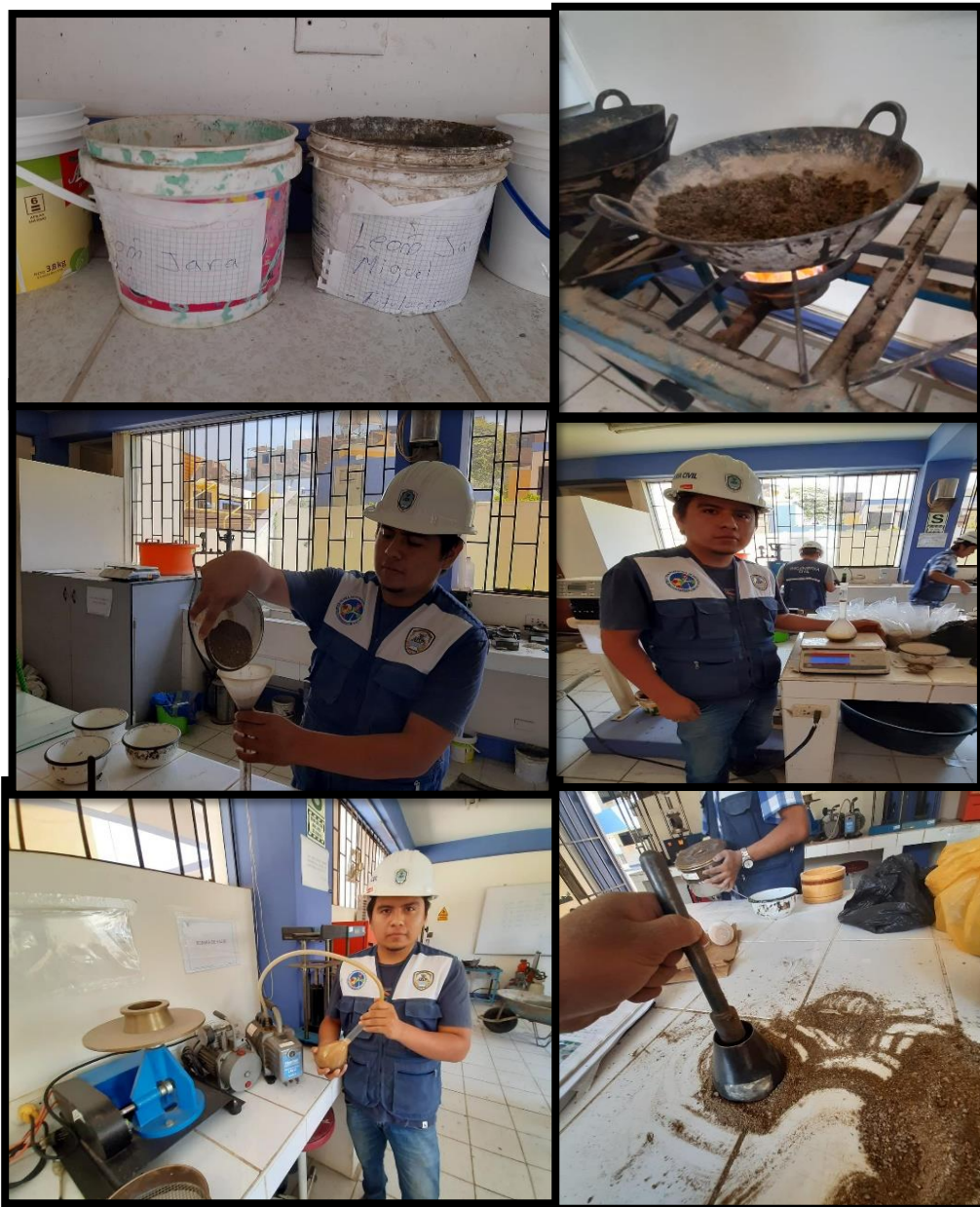
Figura 24. Gravedad específica y absorción de los agregados
