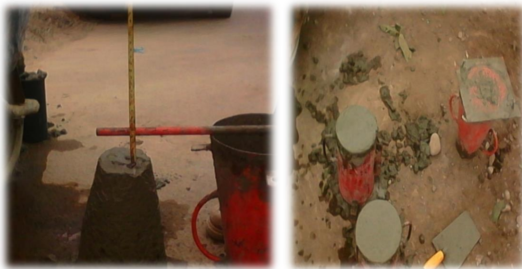
Figura N°61 (a), (b).- Ensayo SLUMP y Testigos.
