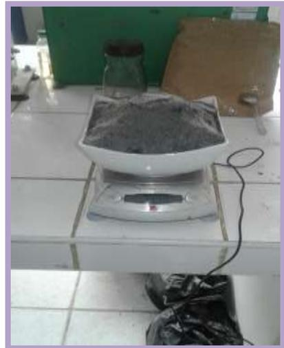
**Figura N°21 y 22:** Material calcinado pesado en la balanza electronica.
