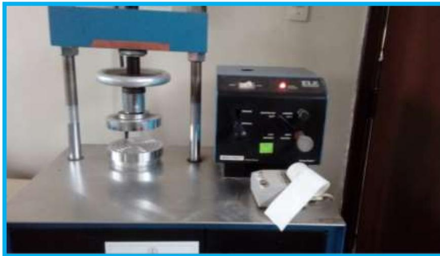
**Figura N°48:** Laboratorio N°1 de ensayo de materiales – UNI. Para el ensayo de Resistencia a Compresión de los morteros patrones y experimentales.
