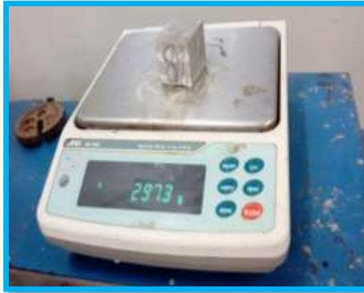
**Figura N°47:** Laboratorio N°1 de ensayo de materiales – UNI. Peso de los morteros patrones antes de la rotura.
