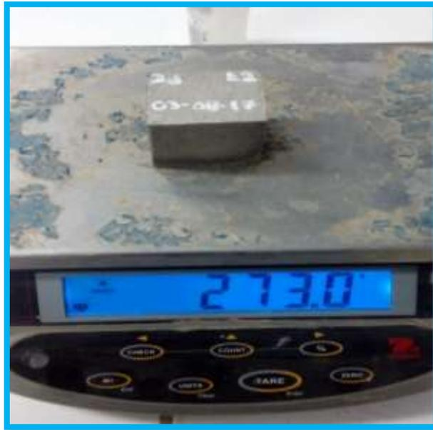
**Figura N°44:** Pesado de especímenes en el laboratorio de mecánica de Suelos-USP.
