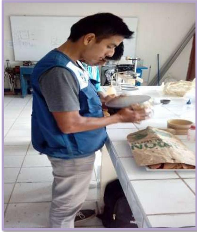
**Figura N°24:** Tamizado de material en malla N°200 a ensayar.
