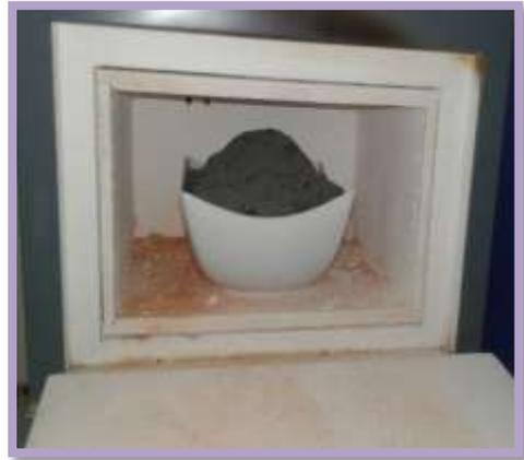
**Figura N°19 y 20:** Material prequemado ,colocado en la mufla para calcinacion 510°C.
