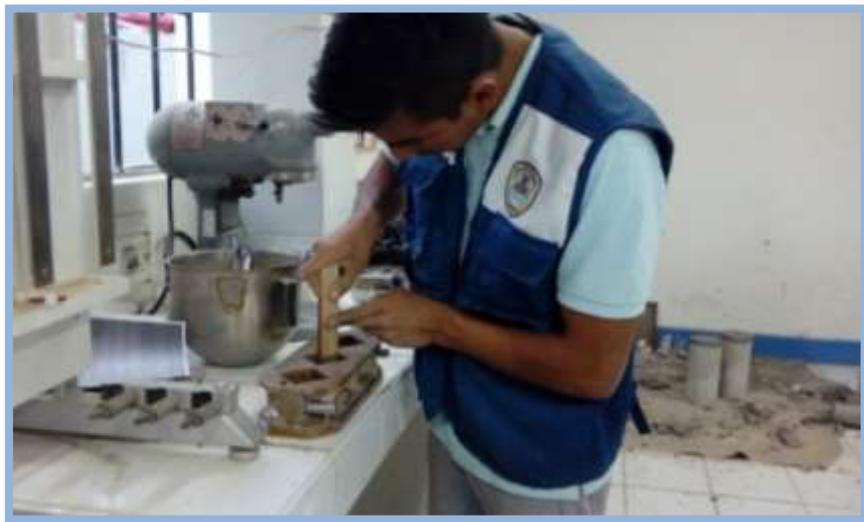
**Figura N°41:** Compactacion de especimenes en Laboratorio de Mecanica de Suelos-USP.
