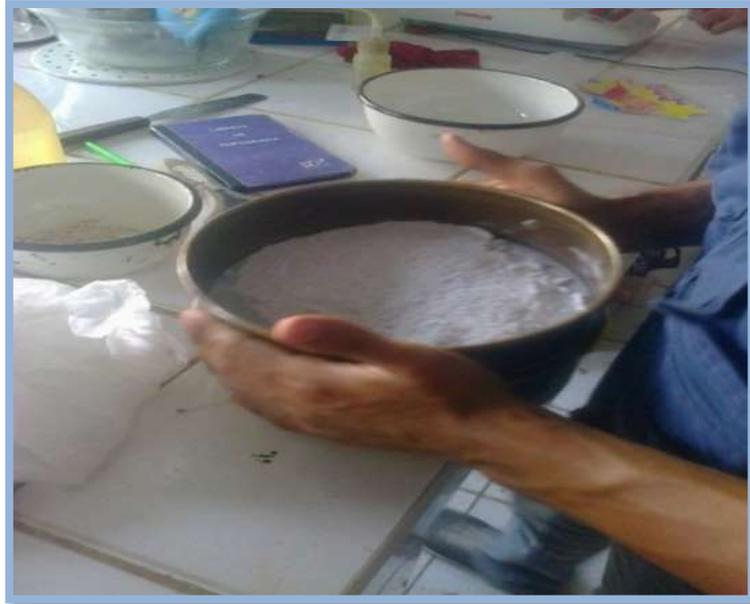
**Figura N°33:** Tamizado de ceniza de cascara de arroz por la malla n°200-
