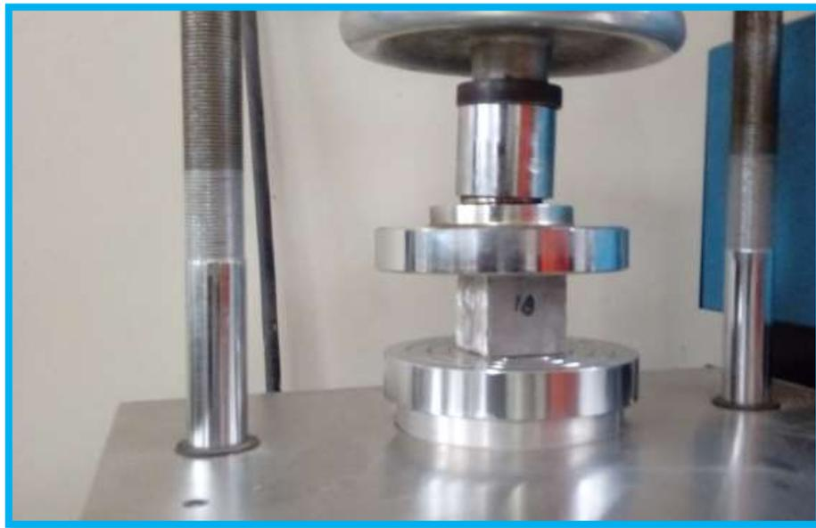
**Figura N°49 y 50:** Ensayo de Resistencia a Compresión de los morteros patrones y experimentales.
