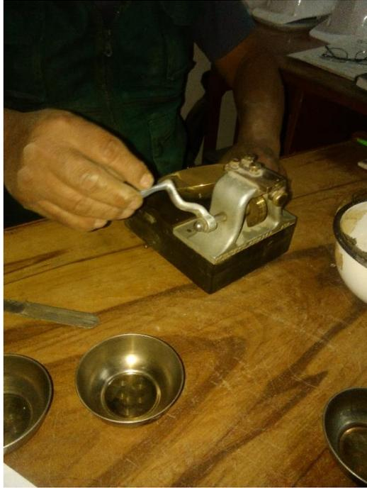
Figura N°06: Ensayo de limite líquido, en la copa de casa grande en el laboratorio de la universidad San Pedro.
