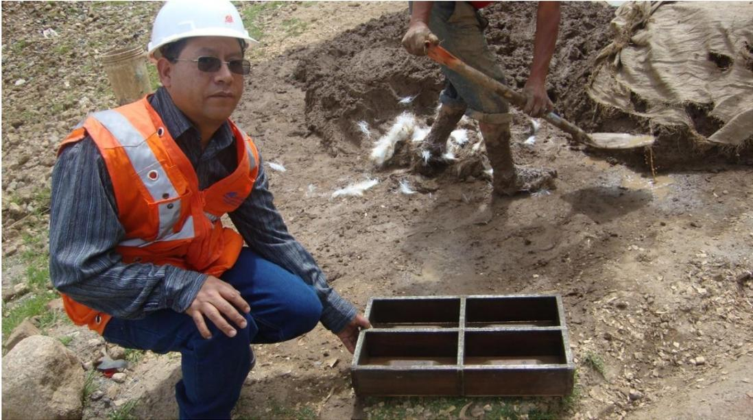
Figura N°03: Moldes para el moldeado de los ladrillos de arcilla.
