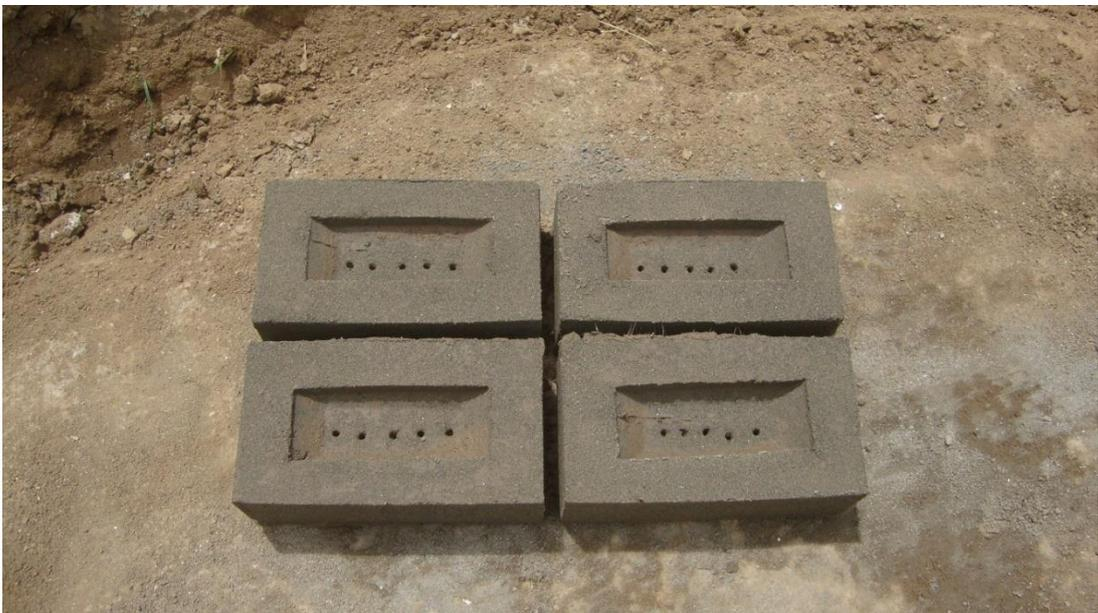
Figura N°13: Muestras con 1%, 1.7%, 2.2% y 2.8% de fibra de vidrio.
