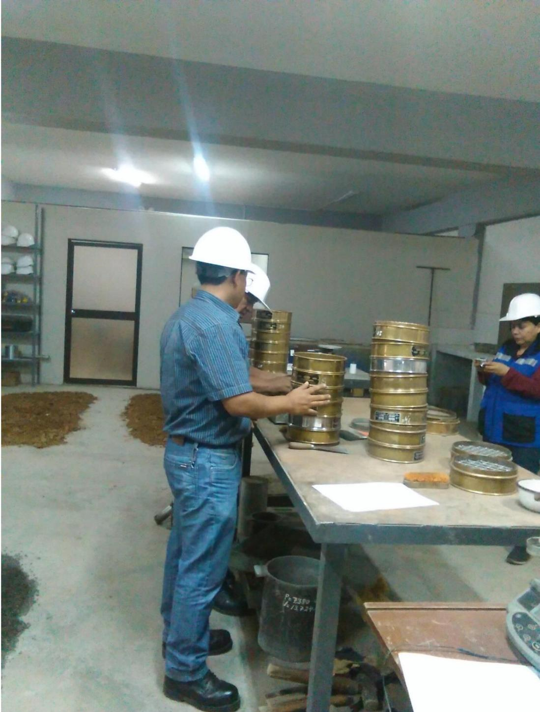
Figura N°05: Ensayo de la granulometría de la arcilla.
