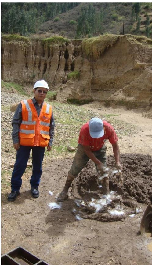
Figura N°10: Mesclado de la fibra de vidrio con la arcilla.
