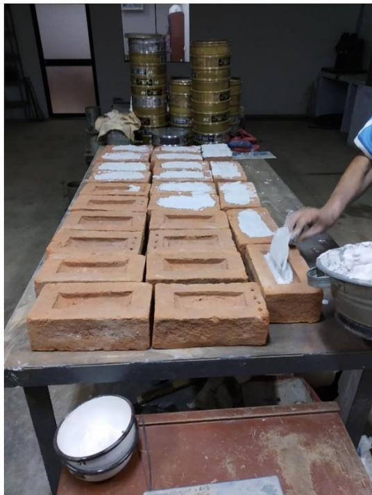
Figura N°21: Capiado o refrenado de las muestras.
