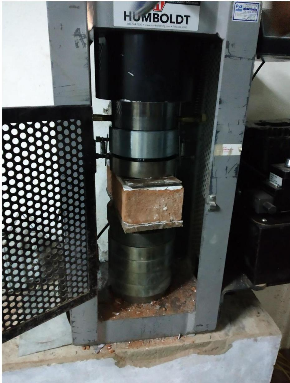
Figura N°23: Muestras sometidas al ensayo de rotura.
