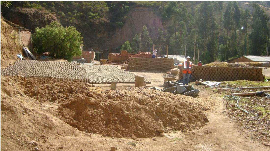
Figura N°02: Selección de material para la elaboración de ladrillos de arcilla.
