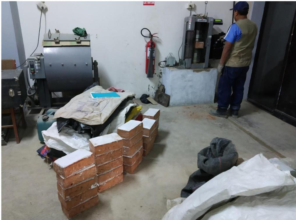
Figura N°22: Muestras apiladas para su rotura.
