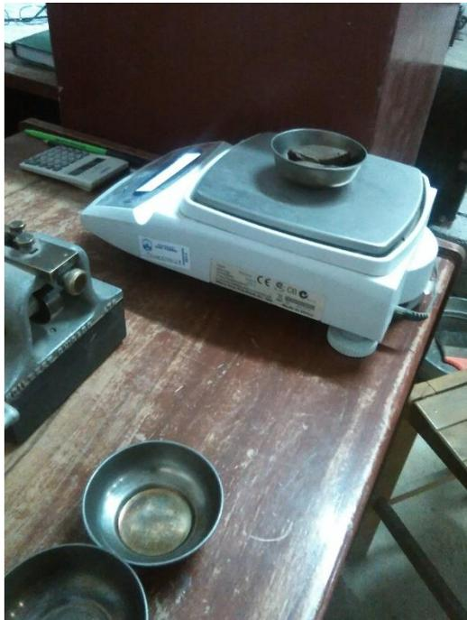
Figura N°07: Pesado de la muestra para el límite plástico.
