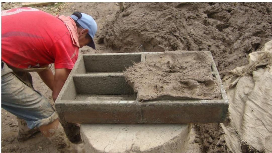
Figura N°11: Moldeado de la mezcla.
