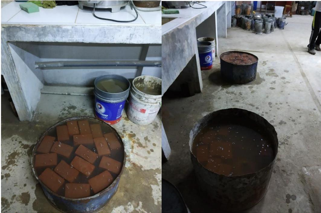
Figura N°20: Muestras sumergidas en el agua.
