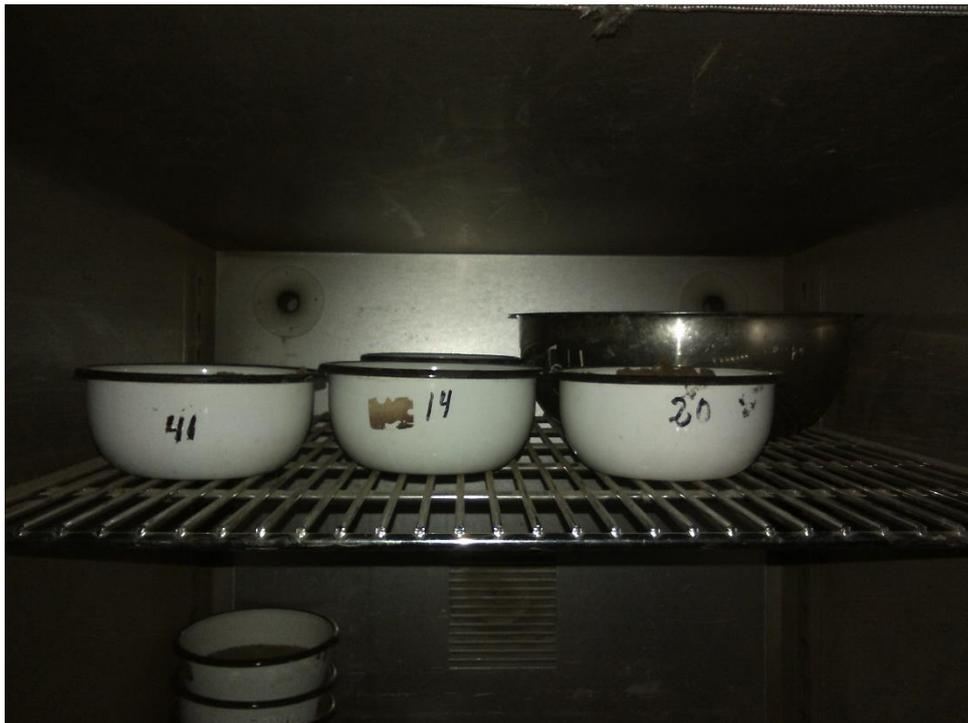
Figura N°04: Toma de muestras de arcilla en las taras para el contenido de humedad y secado en el horno por 24 horas.
